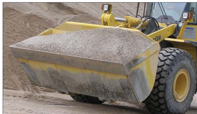
Maszyna wyposażona w tyłkę pryzmową doskonale spisuje się przy pracach polegających na przeładunku sypkich i stosunkowo lekkich materiałów
