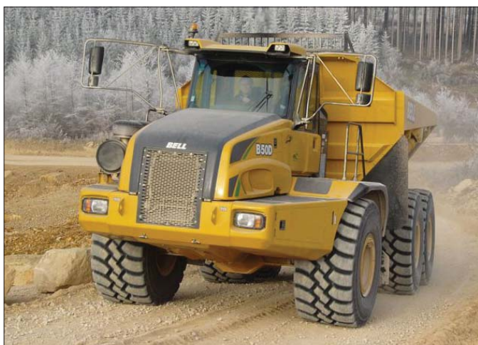
Wozidło przegubowe B50D posiadające ładowność 45 ton to największy model Bella, uznawany za swoisty okręt flagowy południowoafrykańskiej firmy
