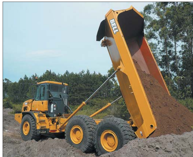
Kąt wyładunku w wozidłach serii D wynosi 70°, przy krótkim czasie podnoszenia i opuszczania wynoszącym odpowiednio około 12 i 6 sekund
