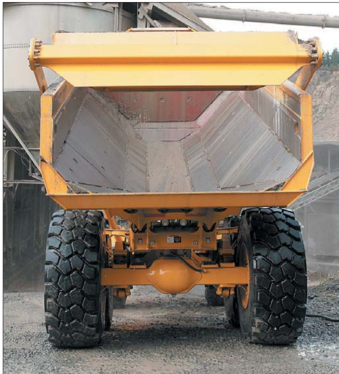
W celu ułatwienia wyładunku odpowiednio dobrana została geometria skrzyni ładunkowej. Zapobiega to przywieraniu przewożonego materiału zwiększając efektywność pracy wozidła
