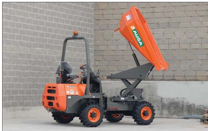
Nowe wozidło D250AHGA posiada opatentowany przez AUSA nożycowy system wysokiego wysypu z obrotnicą umożliwiającą wyładunek zarówno do przodu, jak i na boki
