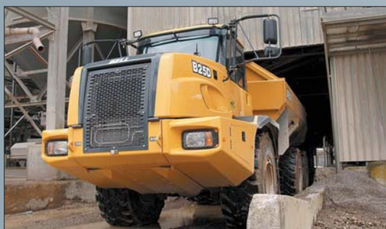
Bell B25D o specjalnej konstrukcji z obniżoną kabiną ▲
