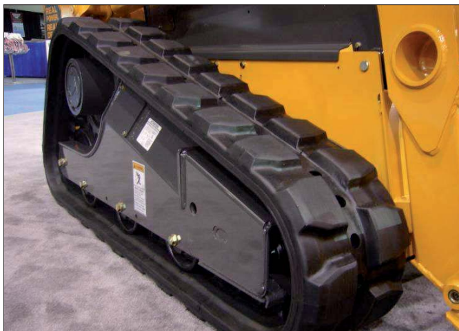
Gąsienica CTL z bieżnikiem „O” wytwarzana przez firmę Solideal zwiększa zarówno trakcyjność, jak i wyporność kompaktowych ładowarek gąsienicowych
