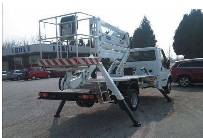
Podnośnik wyposażono w cztery hydraulicznie rozstawiane podpory typu A ze wskaźnikami diodowym sygnalizującym prawidłowość ich rozstawienia
