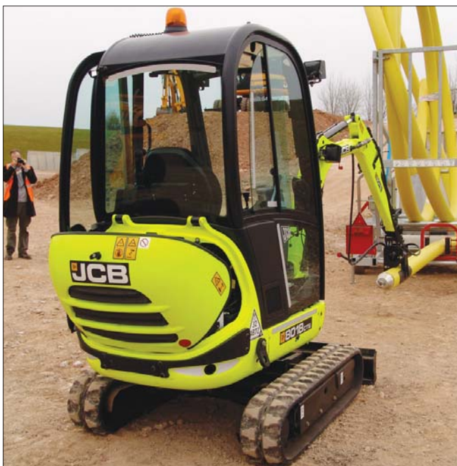
Jaskrawy żółty kolor, na jaki pomalowana została minikoparka JCB 8018 to jeszcze jeden sposób na zwiększenie bezpieczeństwa na placu budowy
