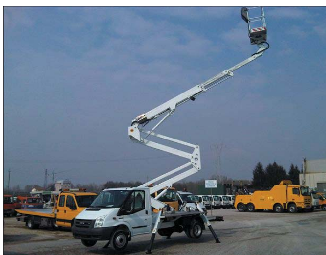
Nowoczesny podnośnik PNT205SR umożliwia pracę na wysokości 20,3 metra przy obciążeniu kosza 200 kg. Poziomy maksymalny zasięg pracy urządzenia wynosi 9 metrów
