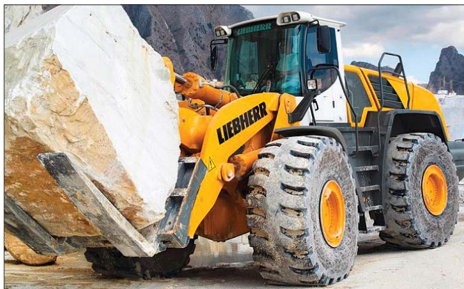
Liebherr L 586 2plus2 to największa na świecie ładowarka o napędzie hydrostatycznym
