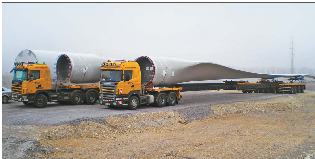
Całkowicie nowa trzyosiowa platforma typu SPZ-DL3 AAA może służyć do przewozu wyjątkowo długich śmigieł elektrowni wiatrowych
