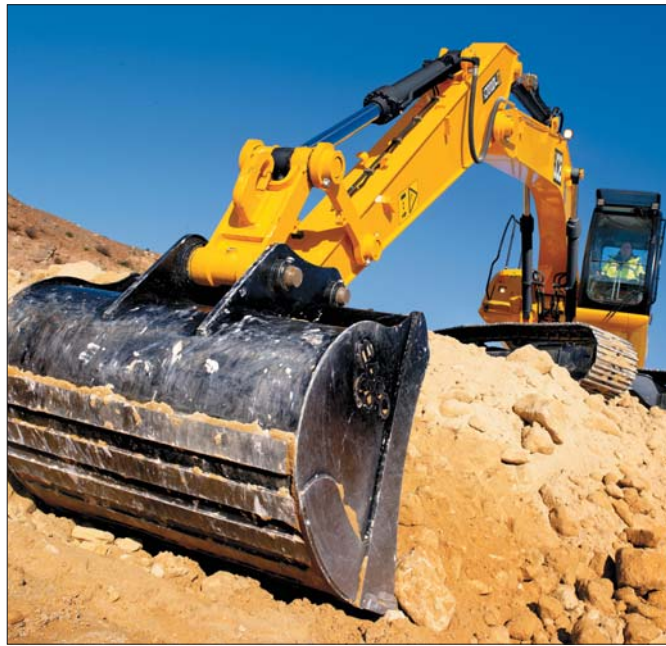
Testowaną maszyną była standardowa koparka JCB JS220LC wyposażona w łyżkę koparkową o szerokości 1.500 mm i pojemności 1,2 m 3
