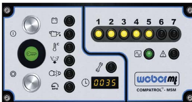
Weber MT jako pierwszy producent na świecie wprowadził do swoich zagęszczarek rewersyjnych system ciągłej kontroli stopnia zagęszczenia podłoża COMPATROL®
