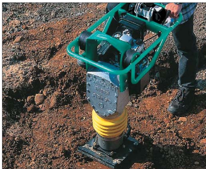
Największym z trójki nowych skoczków Ammanna jest model ADS 70. Ważące 83 kg urządzenie napędzane jest silnikiem Diesla marki Yanmar
