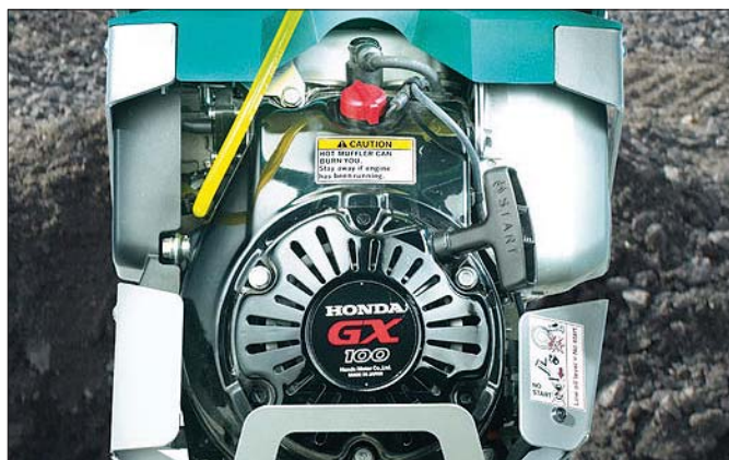
Stopy wibracyjne ACR 60 i ACR 68 napędzane są czterosuwową, benzynową jednostką marki Honda GX 100 wyposażoną w gaźnik ze zintegrowaną pompą przyspieszającą
