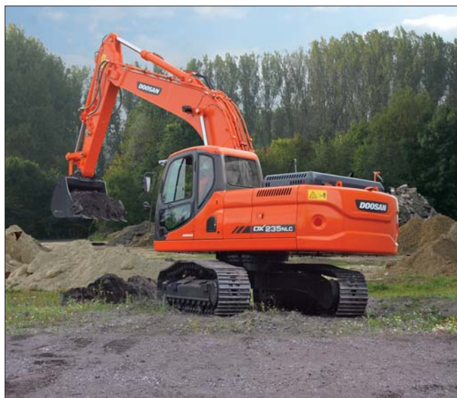
Maszyna wyposażona w wysięgnik typu monoblok posiada masę 22,5 tony. Szerokość podwozia wynosząca 2,54 metra pozwala jej na pracę na ograniczonej przestrzeni
