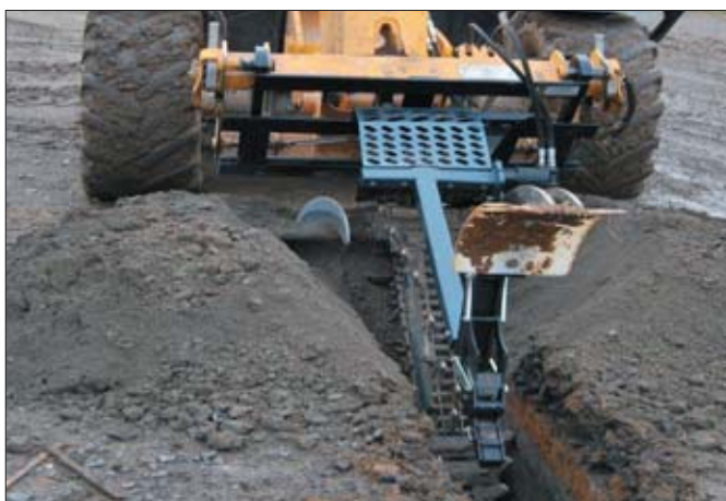
Koparki łańcuchowe DIGGA posiadają unikatowy system pozycjonowania układu napędowego
