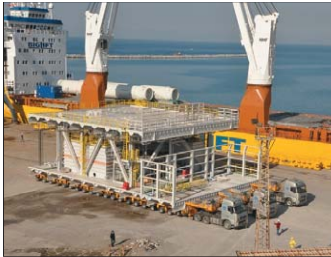
Zadanie tureckiej firmy Ultrans polegało na przewozie platformy wiertniczej o wadze 650 ton. Do jego realizacji wykorzystano zestawy naczepowe – wózki z łabędzimi szypkami i trzema ciągnikami...
