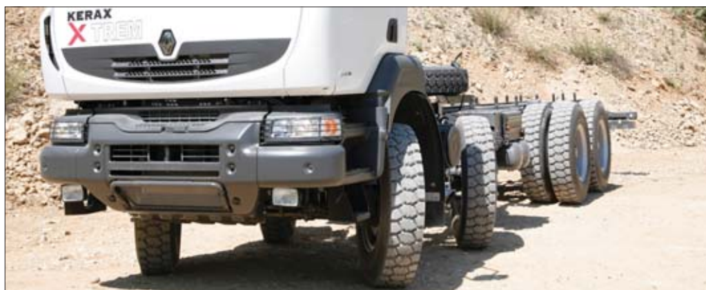
Kerax 8x4 XTREM ma wzmocnioną ramę podwozia od silnika aż do tylnego zwisu. Jego seryjne wyposażenie uwzględnia także wzmocnione resory tylnego zawieszenia, żeliwną obudowę koła zamachowego silnika, dwutarczowe sprzęgło oraz chłodnicę skrzyni biegów
