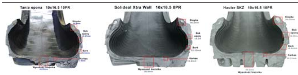
Przekrój dwóch opon w bieżniku trakcyjnym (kij hokejowy): „taniej opony” produkcji indyjskiej oraz opony Solideal SKS Xtra. Dla porównania dodatkowo pokazujemy przekrój opony Hauler SKZ
