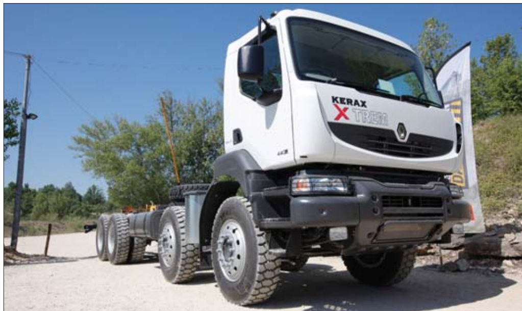
Renault Trucks przygotowali specjalną wersję Kerax XTREM w konfiguracji 8x4. Jak sama nazwa wskazuje jest to wersja o jeszcze bardziej wytrzymałej konstrukcji, przeznaczona do przewozu kruszywa i pracy w bardzo wymagających warunkach
