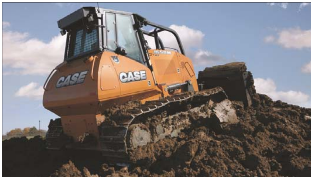
Nowa konstrukcja podwozia obniża środek ciężkości tych maszyn dając lepszą stabilność przy pracy na zboczach i lepszą sterowność podczas równania końcowego
