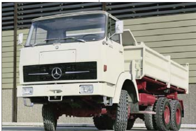
W roku 1971 zaprezentowano ciężarówkę V10 z nowymi osiami planetarnymi, odchylaną, prostopadłościenną kabiną oraz zsynchronizowaną przekładnią w standardzie
