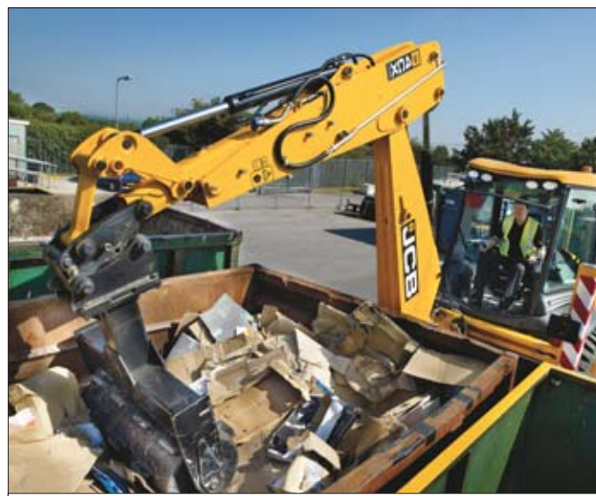
Operator zmodyfikowanej koparko-ładowarki nie musi pracować po omacku. Przez cały czas obserwować może cały obszar roboczy z przodu i po bokach maszyny
