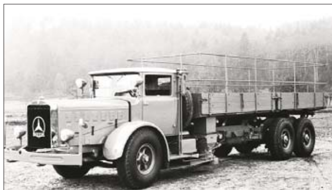
Model LK 10000 z 1937 roku wyposażony w podwójną oś tylną napędową (konfiguracja 6x4) miał ładowność 10 ton
