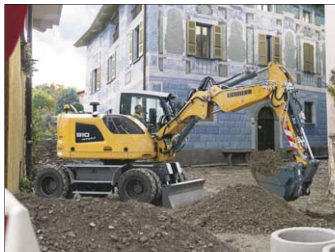
Standardowo koparka A 910 Compact wyposażona jest w regulowany wysięgnik ze zginanym przegubem i trzonem o długości 1,85 m
