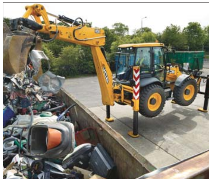
Zespół podpór stabilizujących sprawia, że koparko-ładowarka JCB 4CX Wastemaster potrafi „wspiąć się na palce”. Stanowi to duże udogodnienie dla jej operatora
