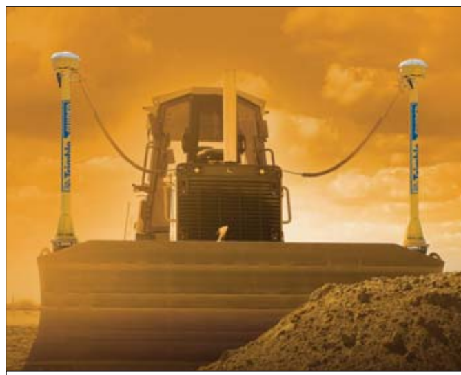
O efektywności systemu sterowania Trimble GCS 900 3D widać najlepiej na przykładzie spycharki, która jest w stanie wykonać pracę, do której trzeba byłoby użyć trzech maszyn nie posiadających takiego wyposażenia
