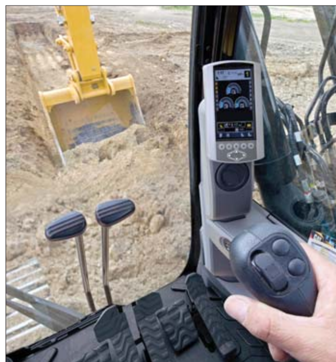
System Cat Grade Control 2D wykorzystuje standardowy monitor i joysticki koparki, co ułatwia sterowanie maszyną
