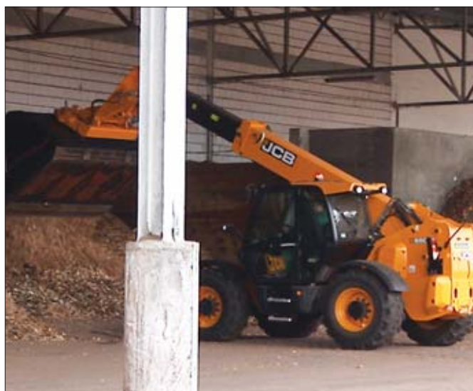
Szybka zmiana trybu sterowania wszystkimi kołami sprawia, że ładowarka bardzo dobrze radzi sobie podczas pracy w miejscach o ograniczonej przestrzeni
