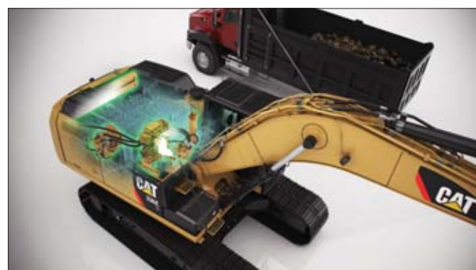
System hybrydowy koparki 336E H łączy trzy rozwiązania: pompę Cat ESP, zawór Cat ACS oraz układ obrotu współpracujący z akumulatorami hydraulicznymi
