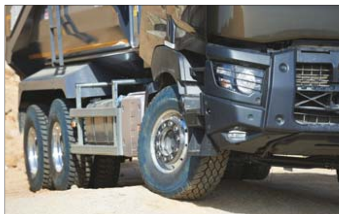
W pojazdach serii C, K i D możliwy jest również wybór miejsca montażu zbiorników paliwa: z lewej lub prawej strony ramy
