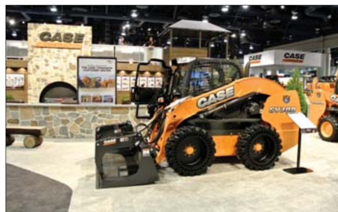
Miniładowarka kołowa „skid steer” Case SV300 wyposażona w łyżkę do odpadów oraz niepneumatyczne opony budziła zainteresowanie targowych gości
