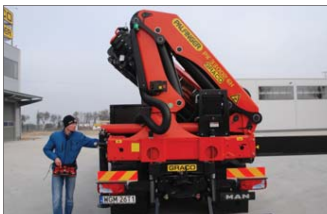
Zdalne sterowanie radiowe z sześcioma funkcjami proporcjonalnymi z dźwigniami liniearnymi podnosi bezpieczeństwo pracy operatora i osób znajdujących się w pobliżu
