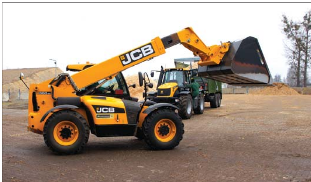
Dzięki zastosowaniu wysokowytrzymałego polietylenu zamiast blachy, w miejscach najbardziej narażonych na zarysowania, zminimalizowano możliwości uszkodzenia powłok lakierniczych
