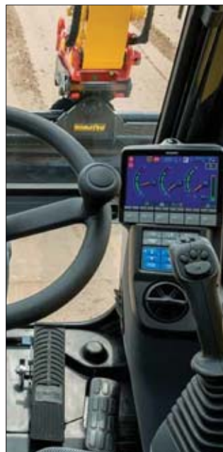
Na monitorze operator otrzymuje „podpowiedzi” pozwalające mu wykorzystywać pełnię możliwości maszyny
