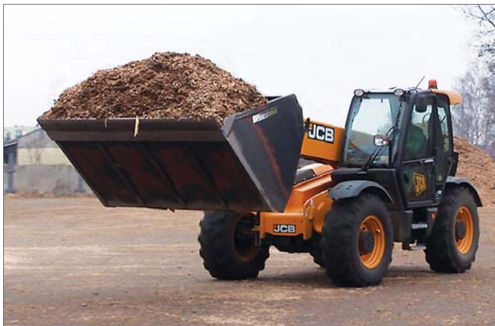
Niewątpliwą zaletą ładowarki JCB 550-80 są jej parametry robocze. Zasięg do przodu wynoszący 4,47 metra, udźwig 5 ton oraz wysokość podnoszenia 8,10 metra pozwalają wykonywać wydajnie i bezpiecznie nawet najtrudniejsze zadania
