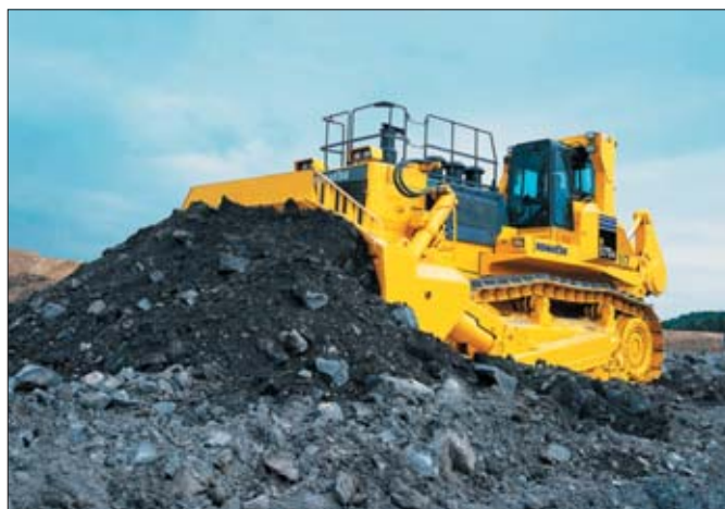
Największa na świecie spycharka Komatsu D575A-3 waży 105 ton, ma silnik rozwijający moc 640 kW, mierzy 10,4 metra długości i 4,6 metra wysokości
