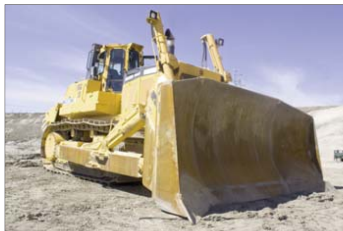
Największa spycharka gąsienicowa TD-40E marki Dressta o masie eksploatacyj- nej 68 ton podczas pracy na terenie kopalni węgla brunatnego w Belchatowie
