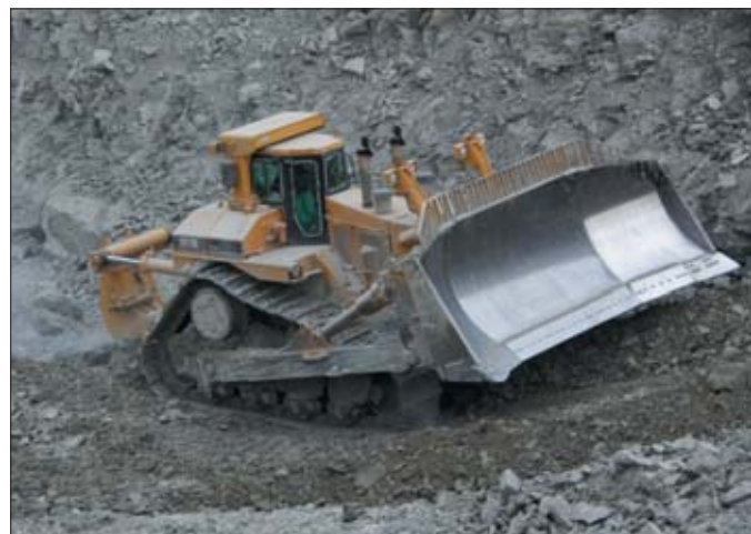
CAT D11R to największa amerykańska spycharka gąsienicowa. Maszyna wyposażona zo- stała w ośmiocylindrowy silnik o mocy 630 kW
