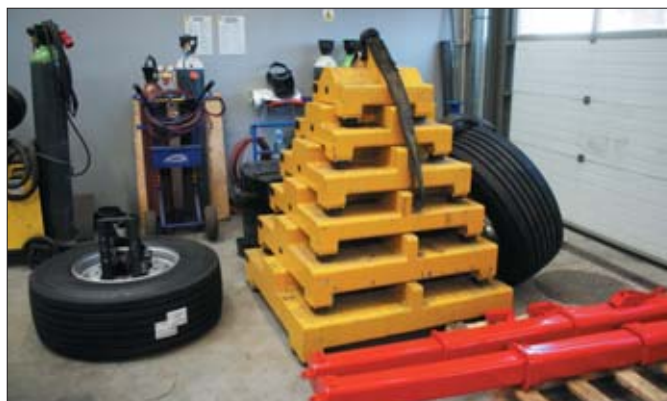
Charakterystyczna piramida obciążników służy do przeprowadzania wewnętrznych prób obciążeniowych żurawi, po których następuje kontrola UDT
