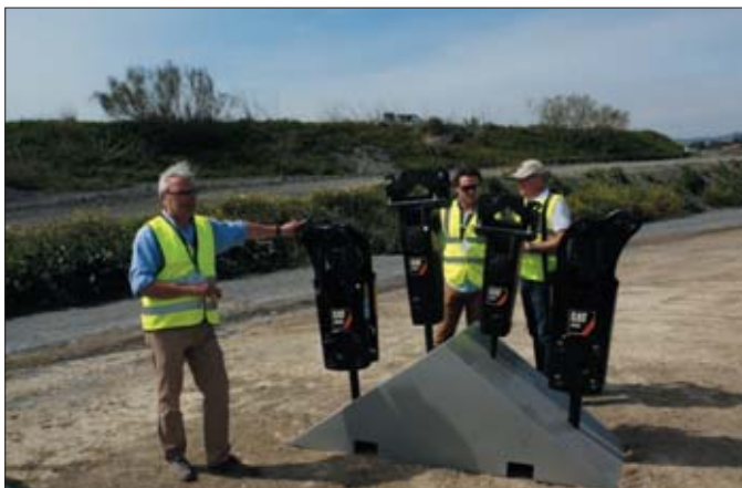
Młoty serii H oferowane są w dwóch konfiguracjach, co umożliwia wykorzystanie ich zarówno na maszynach firmy Caterpillar, jak i innych producentów
