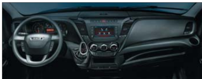
Drążek zmiany biegów nie wystaje poza obrys tablicy rozdzielczej, co zwiększa komfort dla środkowego pasażera i ułatwia przechodzenie na prawą stronę kabiny
