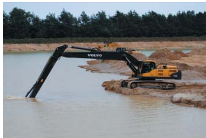
TokFrez produkuje wycięgi o wzmocnionej konstrukcji przeznaczone do zastosowań w nietypowych, trudnych warunkach
