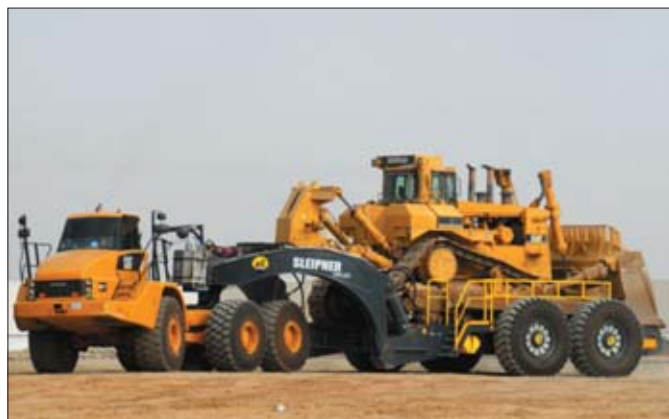
Transport gigantycznych maszyn przysparza wielu problemów. Jedną z fińskich firm znalazła na nie sposób zaprzęgnięciem do specjalnej przyczepy przegubowe wozidło
