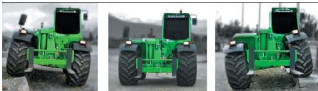
Nowe modele Multifarmer mają układ poziomowania ramy zwiększając bezpieczeństwo pracy na nierównych podłożach. Zasadniczą jego część stanowią dwa silowniki hydrauliczne zamontowane po lewej stronie maszyny
