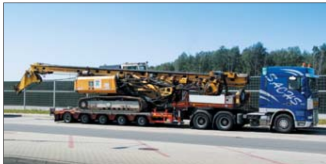
Niezależne zawieszenie Twin Axle II zapewnia niską wysokość pokładu ładunkowego, a jednocześnie duży skok kół ułatwiający pokonywanie nierówności
