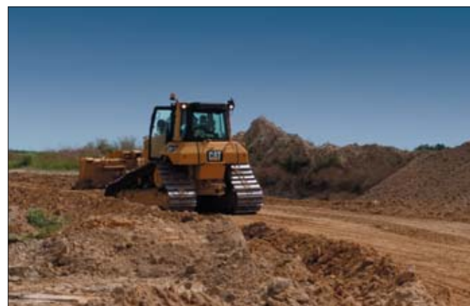
Operator maszyny bez zainstalowanego systemu potrzebował niemalże czterech godzin, w ciągu których wykonał aż 214 przejazdów spalając 71 litrów paliwa
