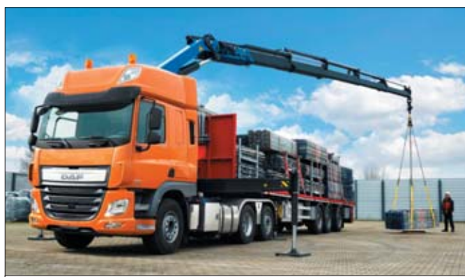
Ciągniki siodłowe DAF serii CF i XF z kierowaną osią wleczoną to idealne rozwiązanie np. przy konieczności umieszczenia za kabiną żurawia i manewrowania w ciasnych przestrzeniach
