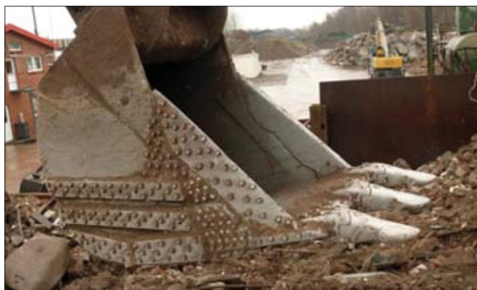
Łyżkę do gruzu wyposażono w trzy zęby systemu Fastkey, co pozwoliło ograniczyć stopień zużycia samej łyżki oraz zredukować zużycie paliwa
