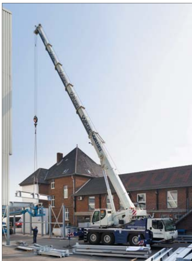
Sześcioczęściowy wysięgnik teleskopowy o długości 48 metrów jest komfortowo wysuwany i wsuwany za pomocą sprawdzonego systemu teleskopowego Telematik
