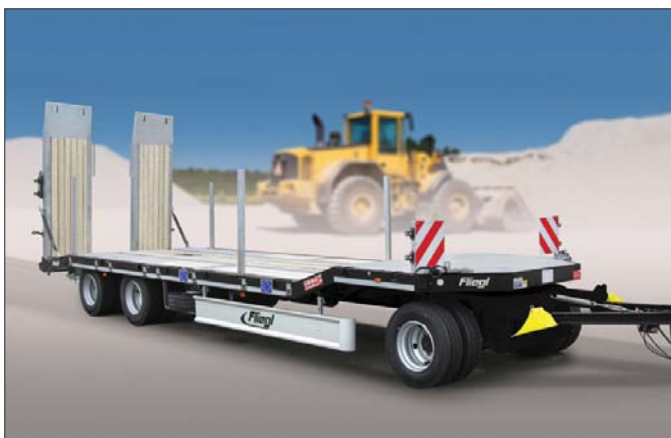
Ograniczenie wysokości dolnego pokładu w przyczepie Fliegl DTS 300 umożliwia bezproblemowe transportowanie wysokich maszyn lub urządzeń budowlanych
