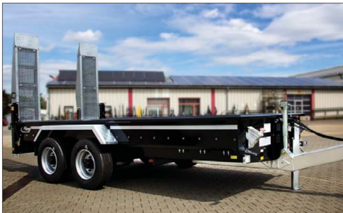
Dwuosiowa przyczepa obrotowa o szerokości 2,05 metra nadaje się do wielu zastosowań. Elastyczność zapewniają zdejmowane i przesuwane z boku szyny prowadzące
