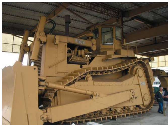
Konstrukcja monstrualnej spycharki Acco oparta została głównie na podzespołach Caterpillar, jednak wiele jej elementów powstało w warsztatach włoskiej firmy
