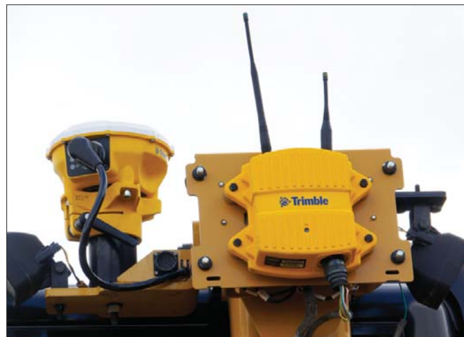
Trimble Earthworks umożliwia montaż odbiornika na dachu kabiny spycharki, a brak masztów na lemi-szu zwiększa pole widzenia operatora
