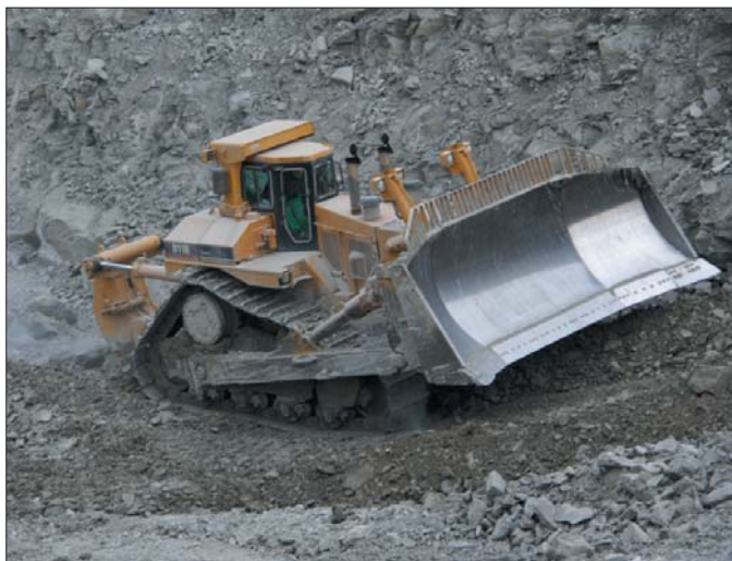
CAT D11R to największa amerykańska spycharka gąsienicowa. Maszyna wyposażona została w ośmiocylindrowy silnik o mocy 630 kW
