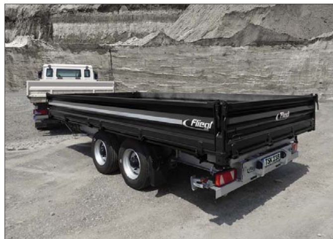
Wywrotka trójstronna Fliegl TSK 118 oprócz transportu kruszyw idealnie sprawdzi się w roli platformy do przewożenia maszyn i urządzeń budowlanych
