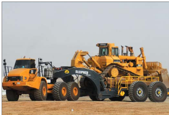
Transport gigantycznych maszyn przysparza wielu problemów. Jedną z fińskich firm znalazła na nie sposób zaprzęgając do specjalnej przyczepy przegubowe wozidło
