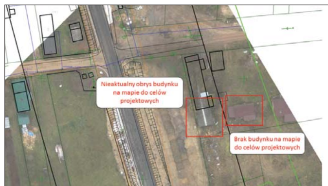
1. Wskazanie rozbieżności dzięki porównaniu mapy zasadniczej z aktualną ortofotomapą wykonaną ze zdjęć zrobionych z drona
