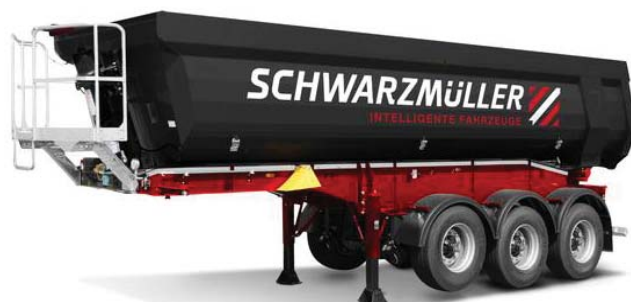
W konstrukcji muldy segmentowej zastosowano wzmocniony siłownik hydrauliczny i niezwykle odporną na działanie sił skręcających zoptymalizowaną ramę pomocniczą
