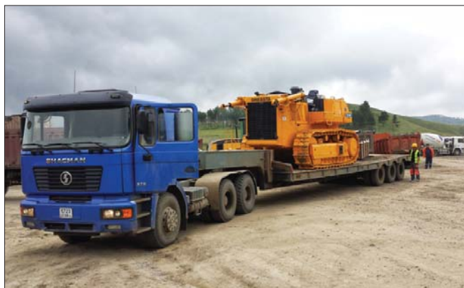
Wyprodukowana w Stalowej Woli spycharka TD-25M Extra ostatnią część podróży do mongolskiej kopalni odbyła na naczepie niskopodwozowej
