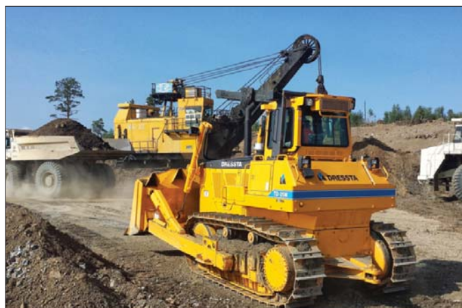
Jednym z zadań spycharki jest utrzymanie dróg technologicznych kopalni, po których przemieszczają się pojazdy i maszyny
