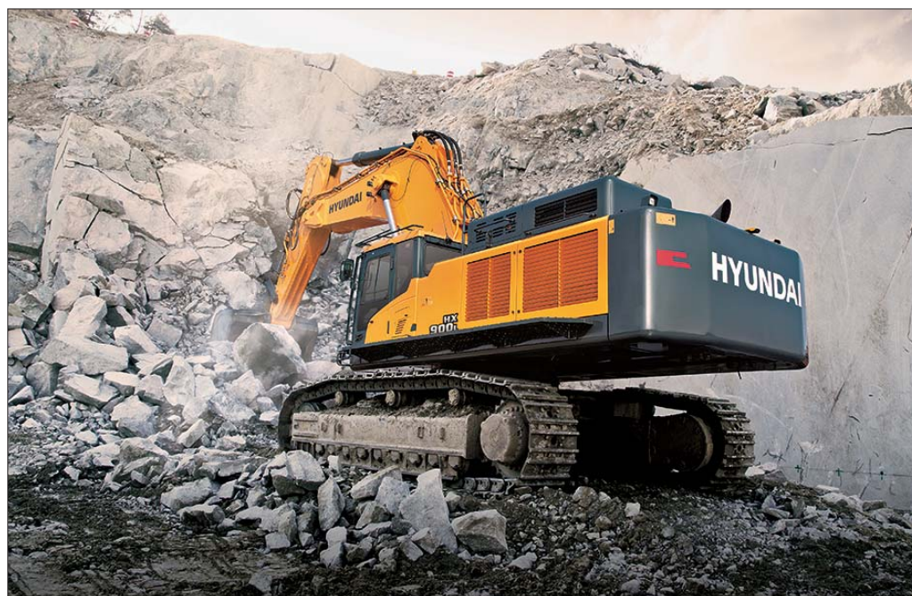
Niezwykle solidna konstrukcja koparki HX900 L sprawia, że sprawdza się ona doskonale podczas prac w kopalniach surowców skalnych, w robotach rozbiórkowych oraz przy realizacji skomplikowanych przedsięwzięć budowlanych
