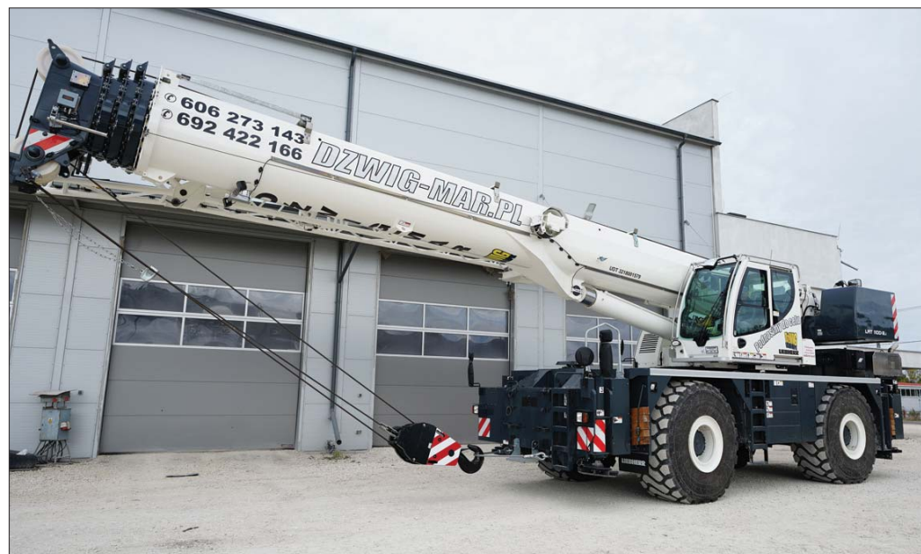
Dźwigi Mazowsze Marcin Zielonka planuje wykorzystanie żurawia LRT 1100-2.1 przede wszystkim przy budowie dróg oraz hal magazynowych, wszędzie tam, gdzie obsługa inwestycji wymaga pracy w trudnych warunkach terenowych
