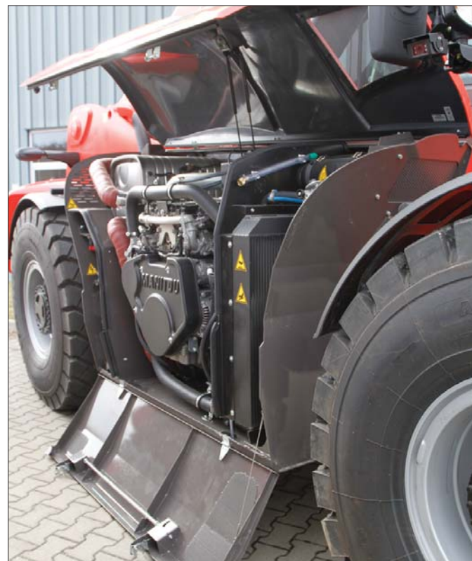
Do napędu maszyny konstruktorzy Manitou zastosowali najnowszej generacji silnik wysokoprężny Mercedes-Benz rozwijający imponującą moc 176 KM
