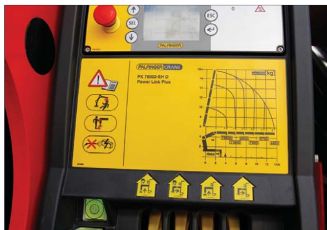
Wysięg żurawia określający jego wydajność i bezpieczeństwo użytkowania, można zoptymalizować w zależności od wielkości przenoszonego ładunku
