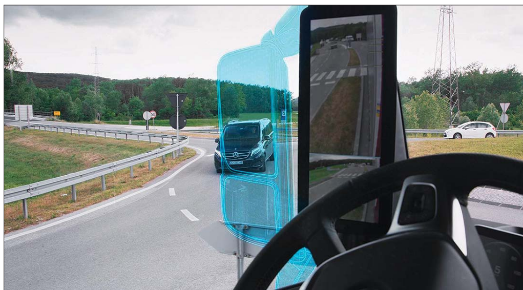
Kierowca nowego Actrosa wyposażonego w system MirrorCam ma znacznie lepszy widok przez szybę w drzwiach kabiny. Jeżeli korzystabymy z klasycznego lusterka bocznego zamieszczonego na przednim słupku, furgonetka byłaby dla niego ledwo widoczna
