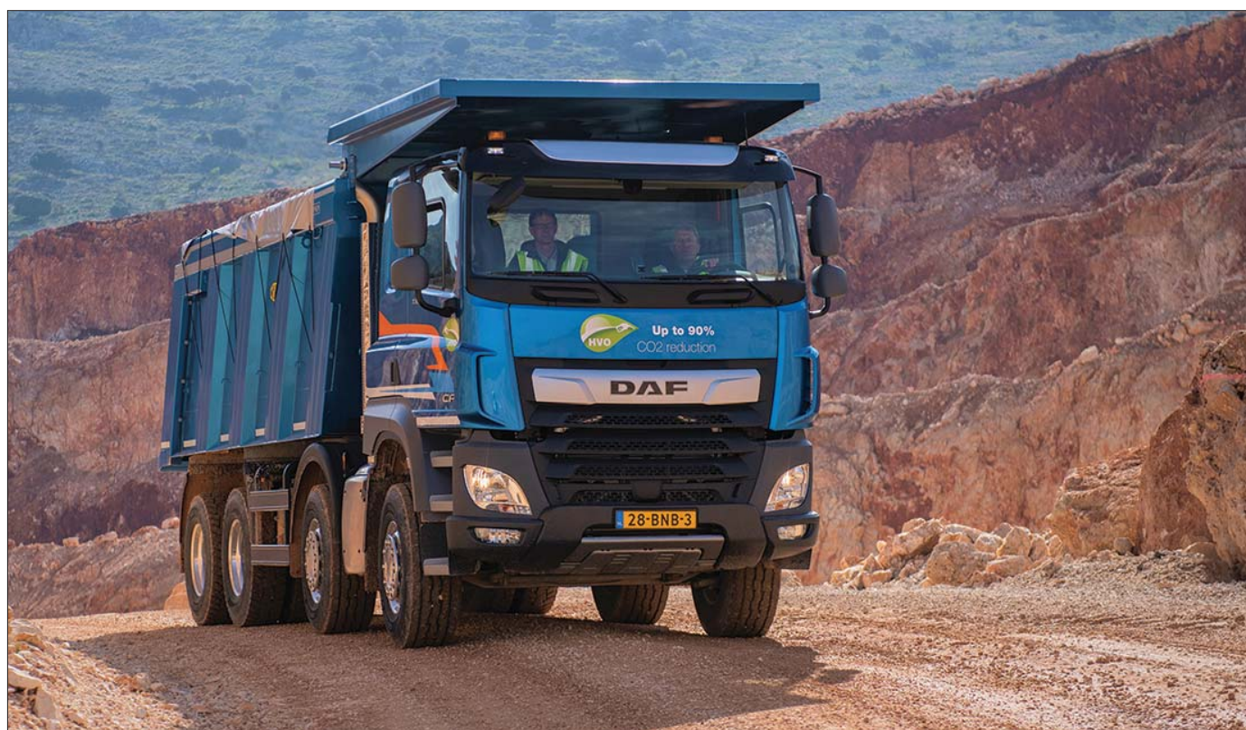
W nowych pojazdach 8x4 przeznaczonych do intensywnej eksploatacji w trudnym terenie montowane są zespoły dwóch osi napędzanych ze zwolnicą i hamulcami bębnowymi. Do wyboru pozostaje zawieszenie pneumatyczne lub mechaniczne na resorach piórowych
