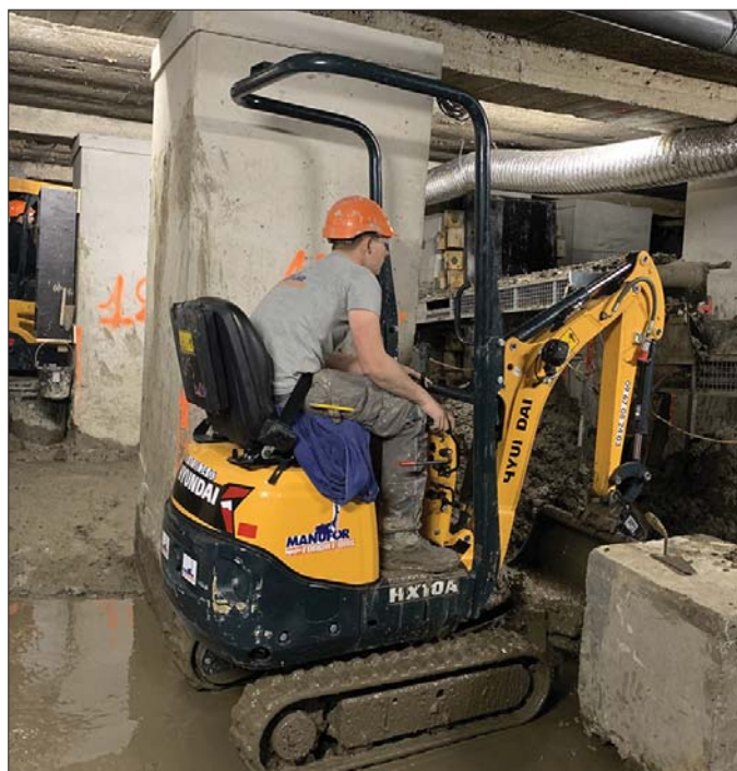
Niewielkie gabaryty nowej mikrokoparki Hyundai HX10A sprawiają, że imponuje ona zwrotnością, co ułatwia wykonywanie precyzyjnych manewrów
