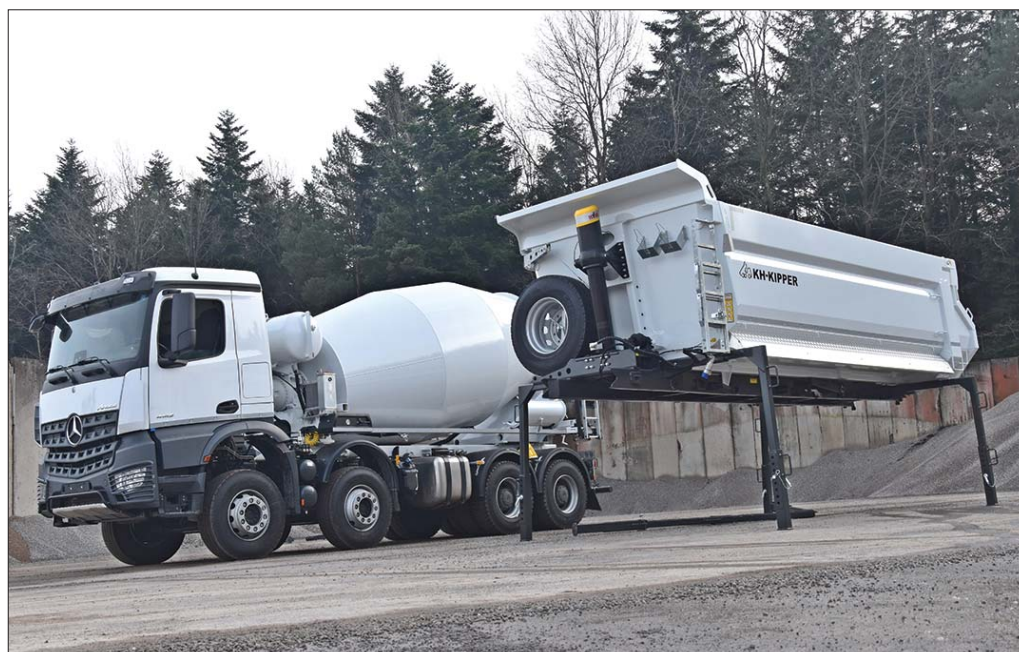
Oferowany przez KH-KIPPER tak zwany system wymienny jest rozwiązaniem zwiększającym funkcjonalność samochodu ciężarowego. Specjalny układ umożliwia wymienne stosowanie wszelkiego rodzaju zabudów montowanych na podwoziach ciężarowych
