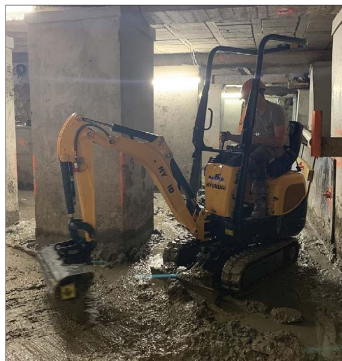
HX10A to najmniejsza koparka w aktualnej ofercie koreańskiego producenta, która ze względu na swe gabaryty sprawdza się w miejscach o ograniczonej przestrzeni
