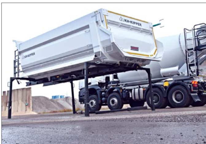
Całość operacji związanych z wymianą zabudowy może wykonać nawet jedna osoba, na przykład kierowca samochodu, w ciągu zaledwie 10-14 minut
