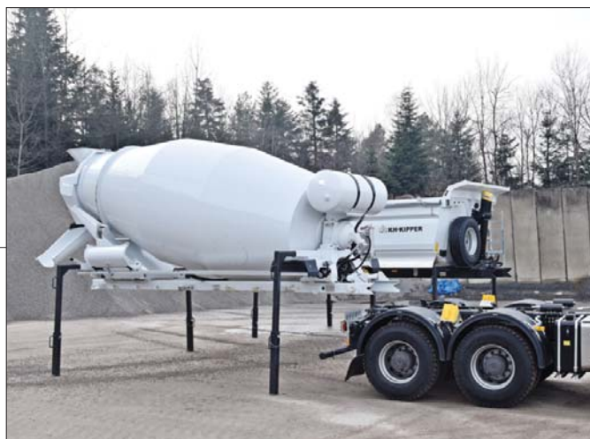
System wymienny KH-KIPPER to kompleksowe rozwiązanie przeznaczone dla betoniarni, kopalń surowców skalnych oraz żwirowni
