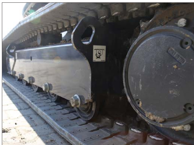
Układ automatycznego napinania gąsienic nie tylko zwiększa efektywność maszyny, ale także wydłuża żywotność wszystkich elementów jej podwozia
