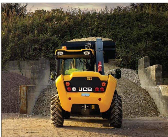
Tylne światła ładowarki teleskopowej Loadall zlicowane z nadwoziem, co ułatwia zachowanie ich w czystości i chroni przed uszkodzeniem
