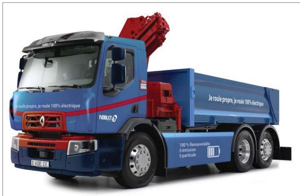
Dzięki niskiemu poziomowi hałasu oraz brakowi emisji spalin Renault Trucks D Wide Z.E. doskonale nadaje się do dystrybucji materiałów budowlanych, szczególnie na terenach miejskich
