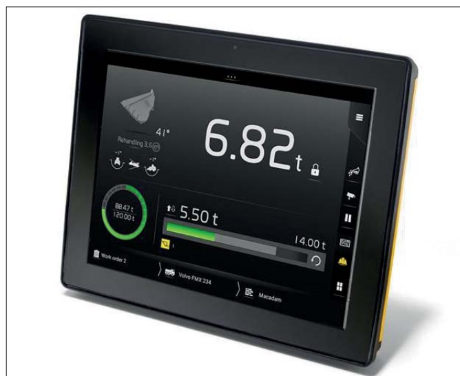
Wszystkie programy Volvo Assist wykorzystują wyświetlacz pokładowy Volvo Co-Pilot, który umożliwia operatorowi bardziej precyzyjne wykonywanie zadań
