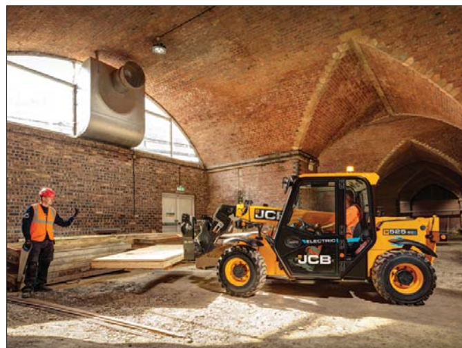
Maszynę 525-60E zaprojektowano tak, by mogła być wykorzystywana we wnętrzach budynków, w tunelach czy ścisłych centrach miast
