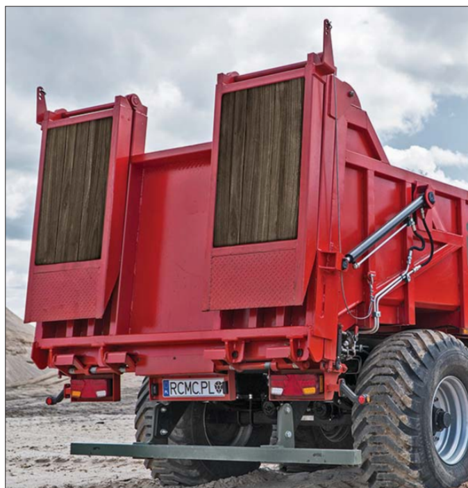
Tajemnica innowacyjności kryje się w tylnej części pojazdu. Uważny obserwator natychmiast zauważy siłowniki hydrauliczne i najazdy
