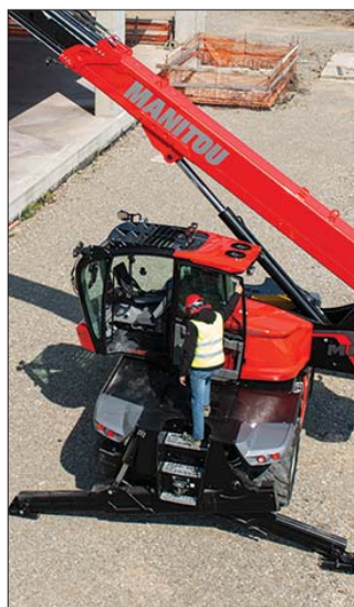
Do kabiny wchodzić można z każdej strony, także od przodu maszyny
