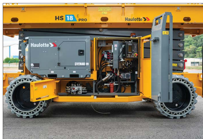
Zapewnienie nieskrępowanego dostępu do wszystkich niewralgicznych podzespołów i punktów serwisowych ułatwia codzienną obsługę podnośników
