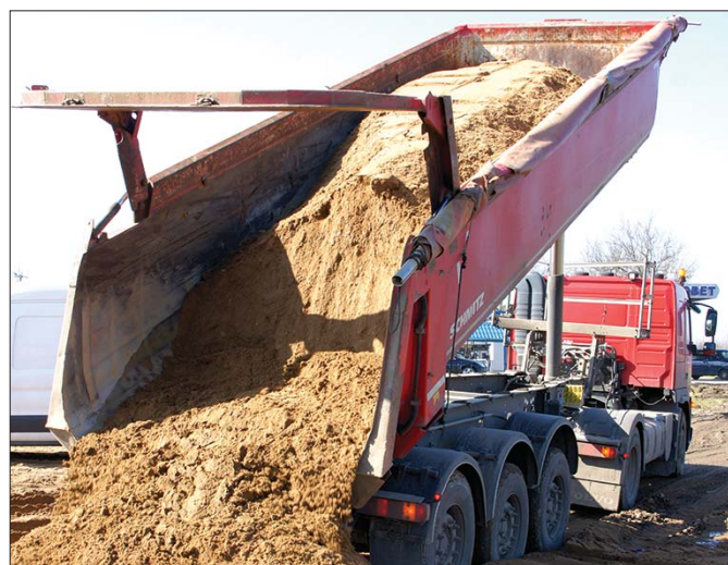
Dostępna opcjonalnie hydraulicznie unoszona kłapa umożliwia nie tylko efektywny, bezpieczny transport, ale przede wszystkim wyładunek
