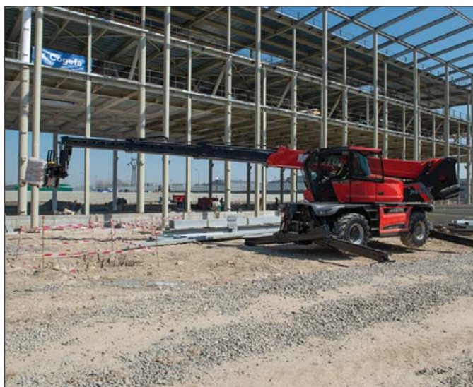
Starannie wykonany wysięgnik o specjalnie wzmocnionej konstrukcji umożliwia precyzyjne manipulowanie osprzętem nawet z ciężkim ładunkiem
