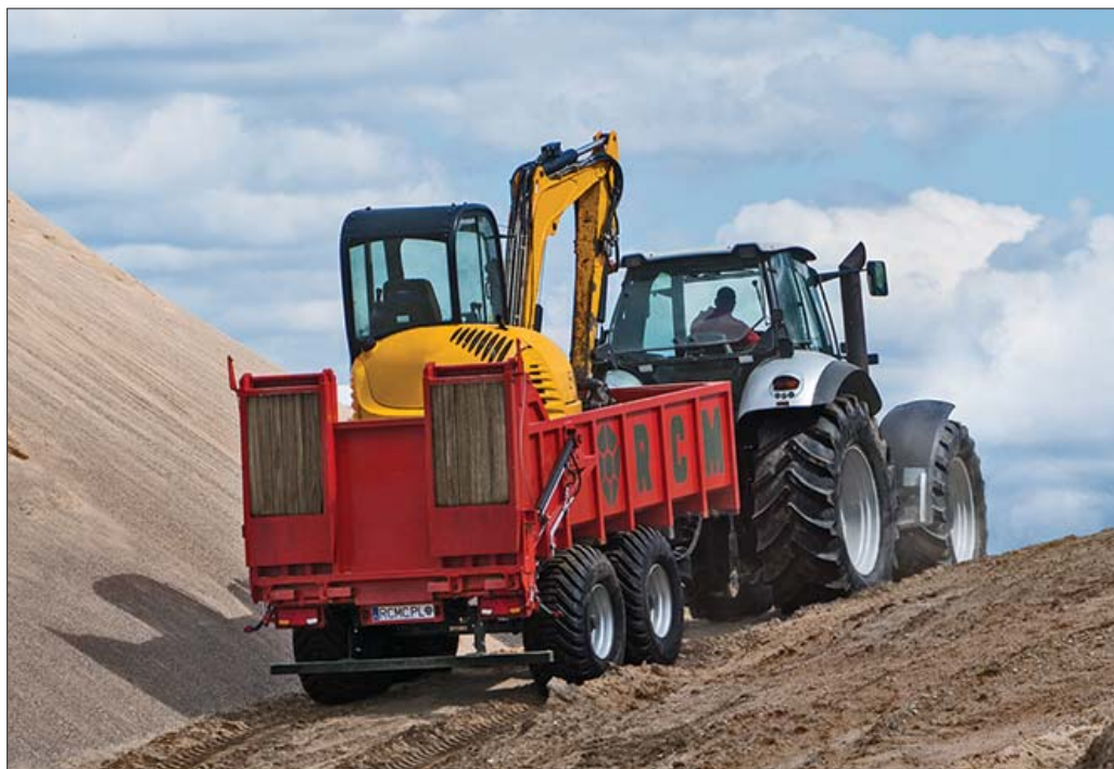
Clever Turtle CT1 o dopuszczalnej masie całkowitej 21 ton umożliwia sprawne przetransportowanie na plac budowy większości kompaktowego sprzętu budowlanego, począwszy od minikoparek, a na walcach drogowych skończywszy
