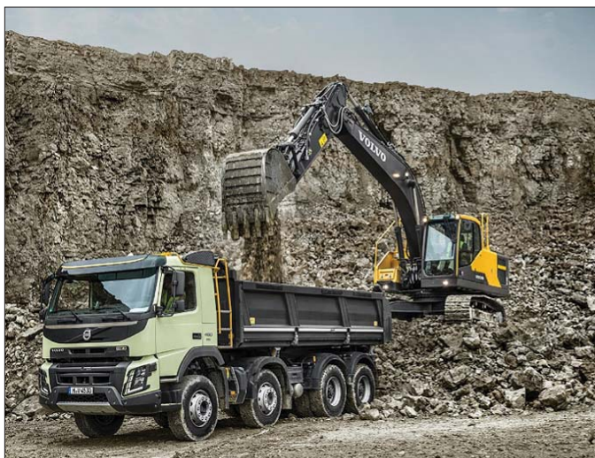
W module Dig Assist zintegrowano zaawansowane funkcje pokładowego systemu ważenia, które opracowane zostały z myślą o optymalizacji załadunku pojazdów
