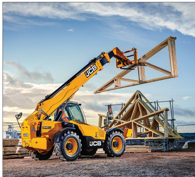
W maszynach Loadall wysięgnik montowany jest nisko na podwoziu. Takie rozwiązanie przydaje dodatkowej sztywności jego konstrukcji
