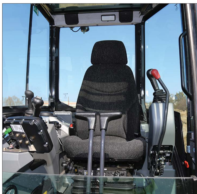
Widoczność z kabiny jest doskonała. Wąskie, ale mimo to niezwykle solidne słupki nie przesłaniają widoku na cały obszar roboczy wokół maszyny
