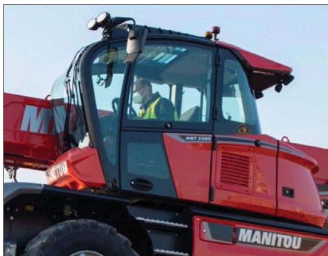
Klatka nowej kabiny wspólnej dla wszystkich modeli MRT została skonstruowana tak, aby żaden z elementów nie przesłaniał operatorowi widoku na obszar roboczy
