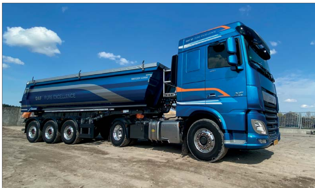
Zestaw tworzony przez pomalowane na kolor „Jamaica Blue” ciągnik DAF XF 480 FT XP i trzyosiową naczepę-wywrotkę Meiller prezentował się okazale. Bardzo szybko przekonał się do jego walorów związanych z wydajnością, ekonomiczną eksploatacją i bezpieczeństwem
