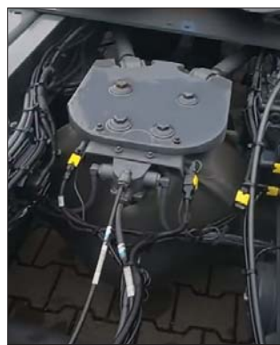
Moduł sterowania układem zawieszenia przeniesiono nad tylną oś ciągnika
