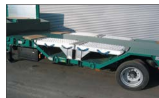
Muldy na koła ze zdejmowaną pokrywą aluminiową, dzielone i przesuwane
