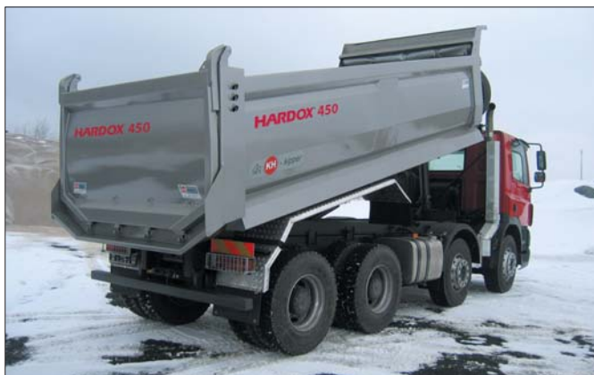
Unikatowe zestawienie udarności z wytrzymałością na ścieranie czyni blachę HARDOX® 450 optymalnym materiałem do produkcji nacze
