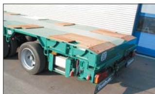
Tył naczepy z uchwytem przeznaczonym do ramp aluminiowych
