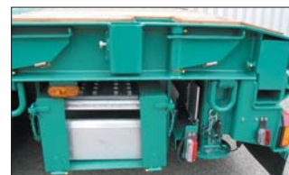
Tył naczepy z koszem na rampy i podporami mechanicznymi
