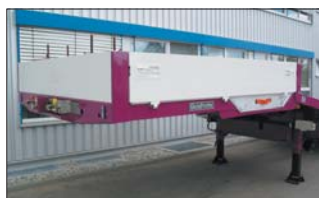
Łabędzia szyja z burtami aluminiowymi i z muldami na koła z pokrywami
