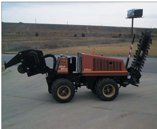
Maszyna 410SX wyposażona w 41-konny silnik wysokoprężny Lister Petter LPW4, niezależnie od plugoukładacza, może być wyposażona w koparkę łyżkową lub łańcuchową, co w znacznym stopniu zwiększa jej funkcjonalność...
