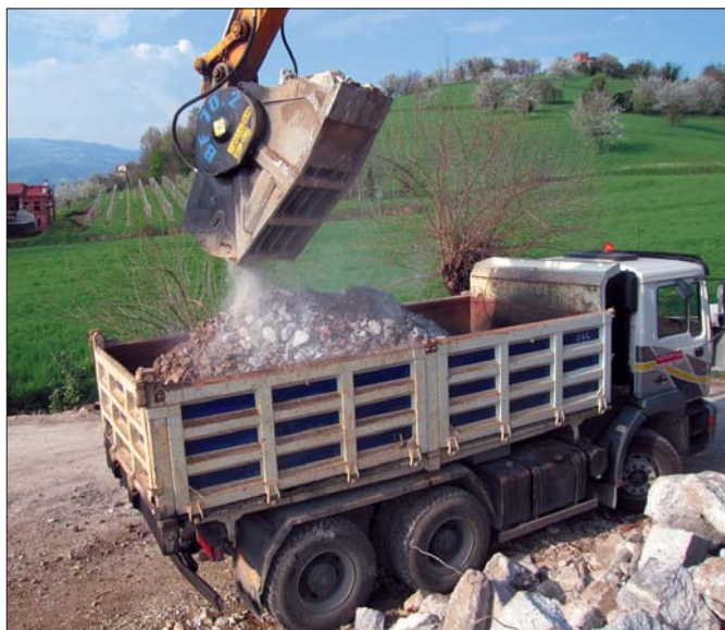
Czerpak kruszący BEFRA pozwala na opłacalne kruszenie nawet niewielkiej ilości gruzu bezpośrednio w miejscu jego powstania
