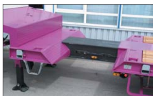
Muldy na koła wykonane przez zukosowanie rozsuwanych elementów platformy
