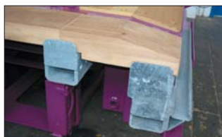
Tył naczepy z przykładem poszerzenia wysuwanego i przesuwanych szynami do ramp
