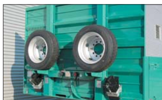
Stalowa burta przednia- czołownica o wysokości 1.600 mm
