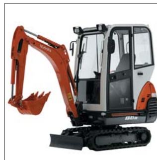
Dzięki długiemu ramieniu łyżki KX41-3 ma największą głębokość wykopu w swojej klasie wagowej
