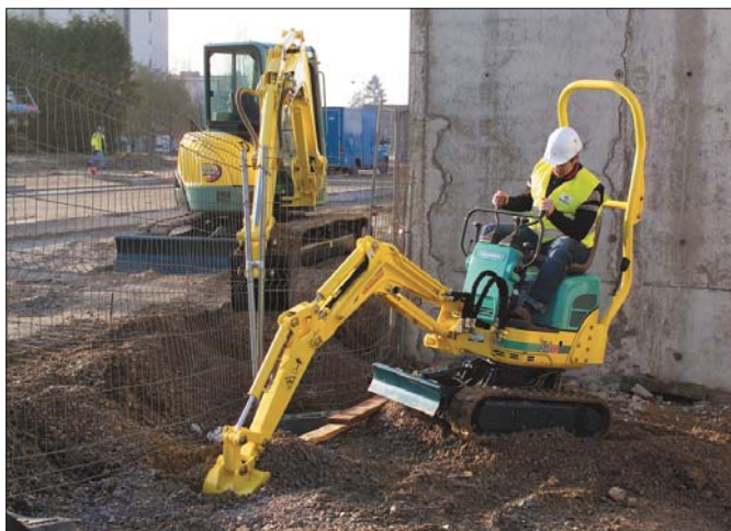
Mikrokoparka SV 08-1 to jedyna tego typu maszyna z powodzeniem łącząca minimalny, bo wynoszący tylko 750 mm promień skrętu wieży z siłą penetracji wynoszącą 1.100 kgf i siłą kopania 650 kgf
