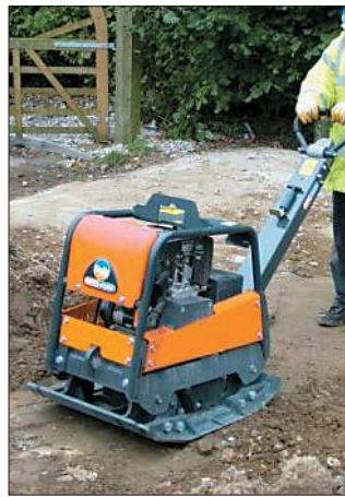
W skład serii RPC wchodzi zagęszczarki rewersyjne o wadze od 154 do 522 kg
