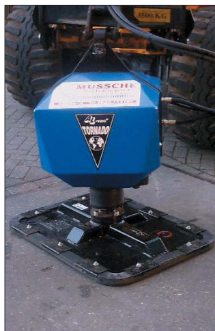
Ciekawą pozycję w ofercie firmy Lifton Polska stanowią próżniowe chwytaki do materiałów budowlanych AL-VAC. Urządzenia te w znacznym stopniu ułatwiają prace transportowe na bliskie odległości
