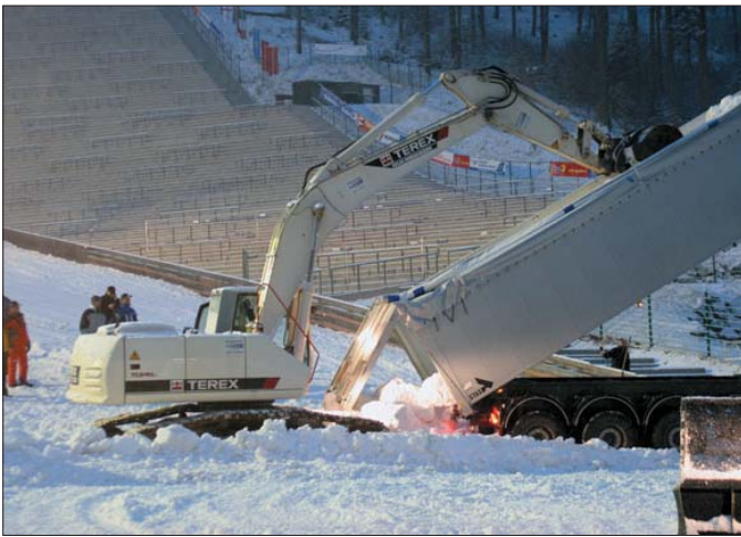
Przy rozładunku wywrotek ze śniegiem Terex TC 240 LC dzięki zasięgowi wynoszącemu 10,55 metra (wysięgnik monoblok z łamanym ramieniem) bez problemów sięgał do najdalszych zakamarków skrzyni ładunkowej
