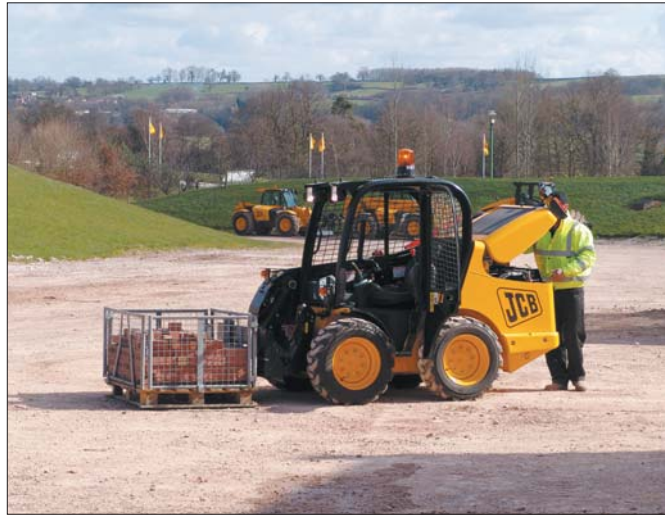
Ładowarka kołowa Robot 190 o udźwigu 950 kg
