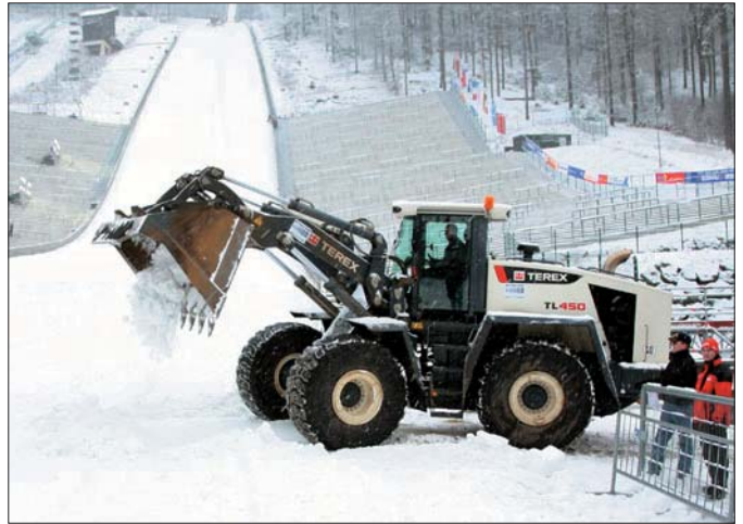
Ladowarka kołowa TL 450 przejęła zadania rozścielenia mas śniegu na liczącym ponad 3.500 m 2 zeskoku. Pokrycie tej części skoczni dzięki wykorzystaniu maszyny Terex zostało przeprowadzone zaledwie w ciągu trzech dni
