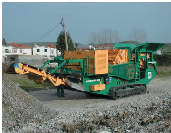
Dzięki możliwości zastosowania podwozia gaśienicowego kruszarka R-CI 100-100/T może łatwo przemieszczać się po placu budowy
