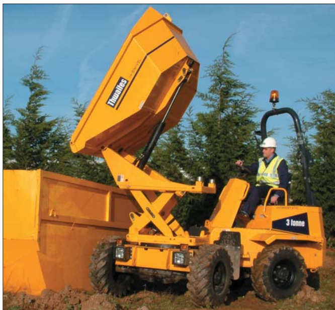
Wózki z obracalnym pojemnikiem pozwalają na bezpośrednie napelnianie kontenerów
