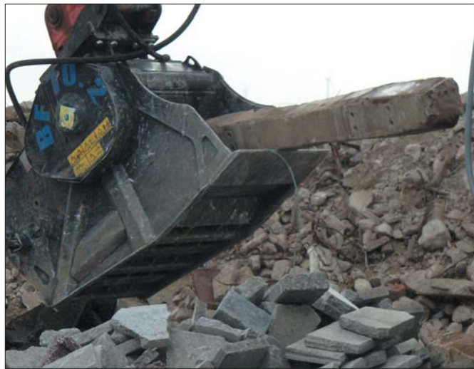
Czerpak BEFRA jest kruszarką szczękową zawieszoną na ramieniu koparki
