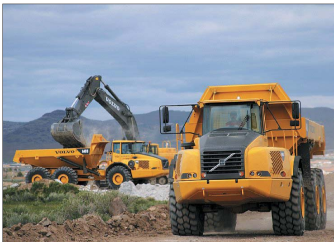
W wozidłach Volvo E FS mamy do czynienia z najistotniejszą technologiczną zmianą na przestrzeni ostatnich dziesięcioleci polegającą na zastosowaniu automatycznej stabilizacji i kontroli zawieszenia wszystkich kół
