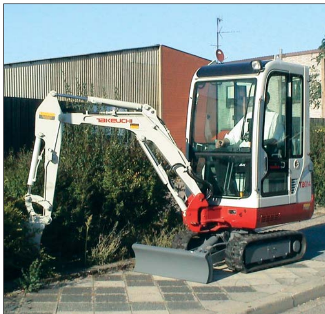
Minikoparka TB 014 ma wiele zalet. W seryjnym wyposażeniu posiada między innymi: zabezpieczenie przed pęknięciem rury, zawory podtrzymywania obciążenia oraz alarm przeciążenia ostrzegający operatora, że transportowany ciężar przekracza dopuszczalną wartość
