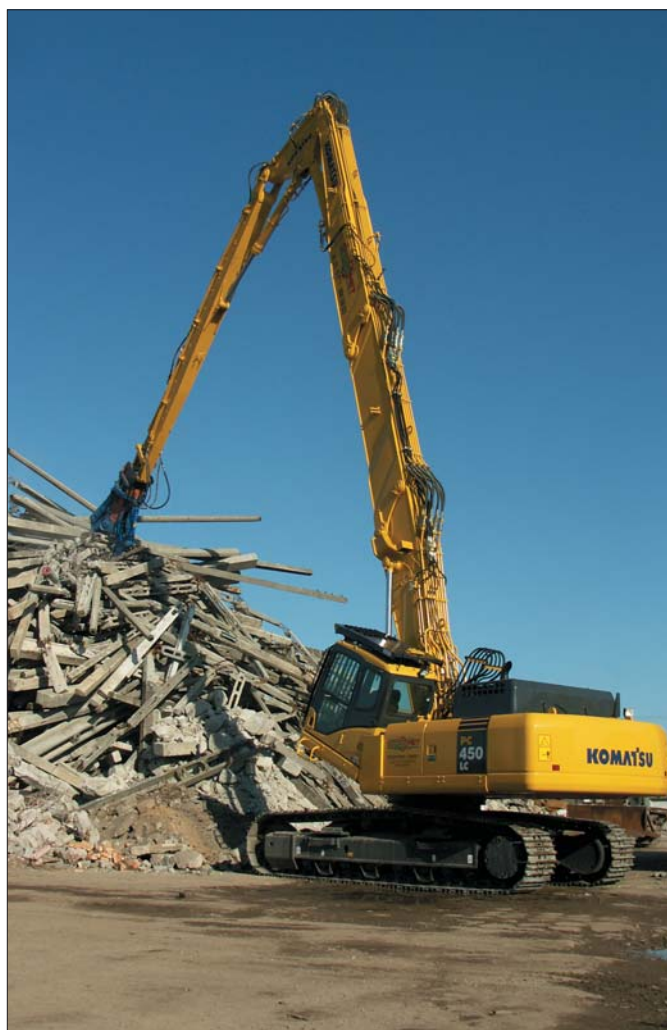
Opcjonalnie koparka PC450L może być wyposażona w odchylaną kabinę. Rozwiązanie to zapewnia operatorowi doskonałą widoczność szczególnie podczas prac wyburzeniowych
