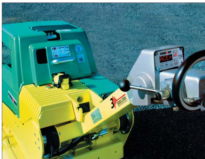
Płyty zagęszczające firmy Ammann wyposażone są w technikę 3W i system ACE gwarantujące optymalną całopowierzchniową kontrolę zagęszczania
