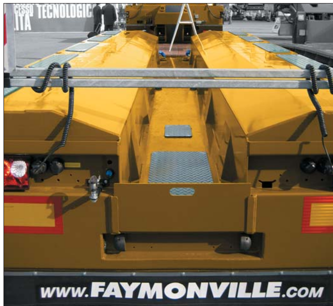
Dzięki specjalnemu wyprofilowaniu rynny Pendelmax doskonale nadaje się zarówno do transportu ciężkich maszyn budowlanych, jak i elementów o ponadprzeciętnych gabarytach
