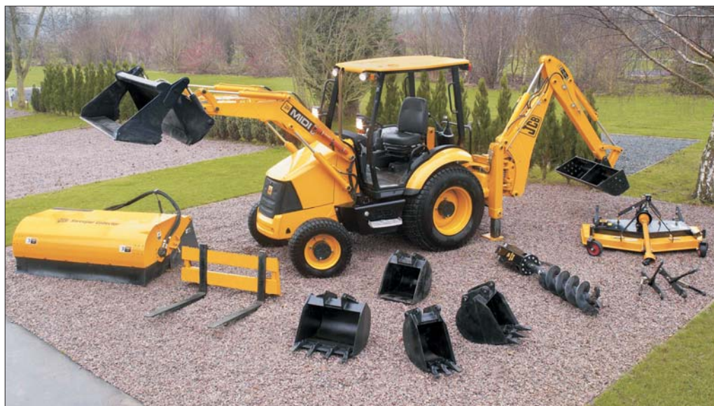
Możliwość zastosowania szerokiej gamy osprzętu roboczego czyni z JCB Midi CX naprawdę uniwersalną maszyną doskonale sprawdzającą się nie tylko na placach budowy, ale także podczas konserwacji terenów zielonych oraz prac rolniczych...
