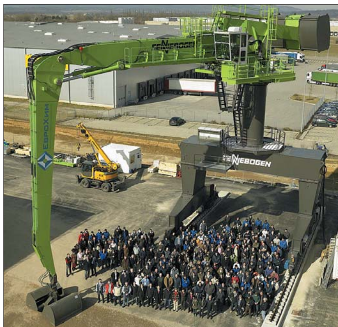
Ważący 270 ton Sennebogen 880 EQ jest najcięższą maszyną, jaka kiedykolwiek została skonstruowana i wyprodukowana przez firmę Sennebogen
