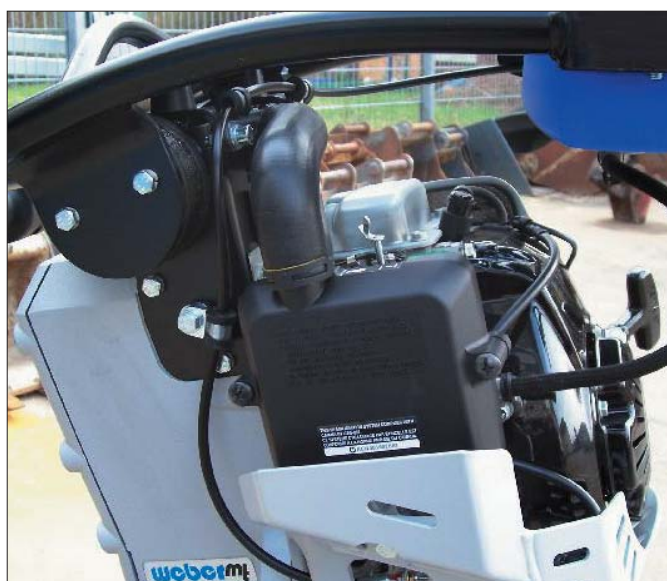
Udoskonalony system filtrowania powietrza z oddzielnikiem cyklonowym
