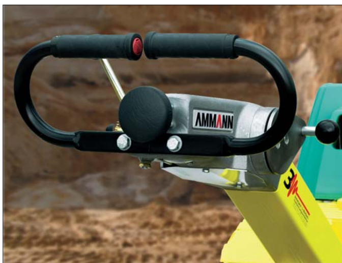
Uchwyty z sensorami elektronicznymi na pałąku prowadzącym reagując na dotyk operatora załączają hydraulikę maszyny
