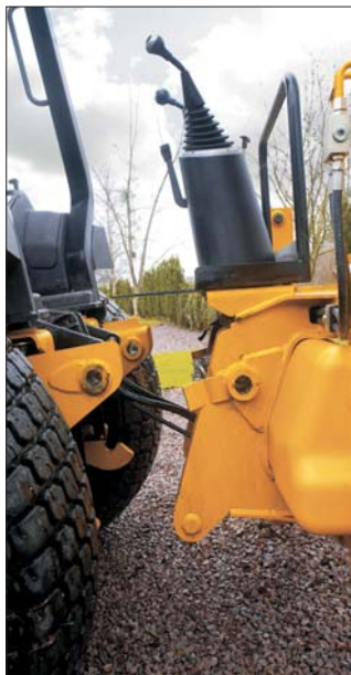
Demontowalna część koparkowa pozwala na błyskawiczne przekształcenie JCB Midi CX w ciągnik
