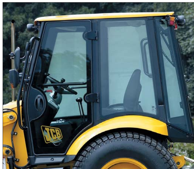
Obszerna, ergonomiczna kabina ROPS/FOPS zapewnia operatorowi maszyny nie tylko pełne bezpieczeństwo, ale także doskonały komfort pracy
