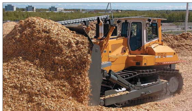
PR 764 – największy spychacz na świecie z napędem hydrostatycznym
