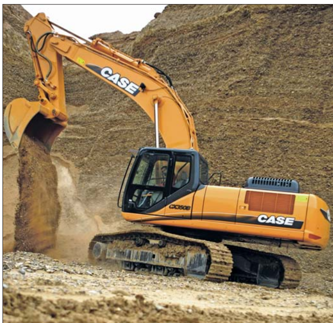
Koparka gąsienicowa Case CX350 o ciężarze roboczym 35 ton cieszy się dużym powodzeniem polskich firm budowlanych
