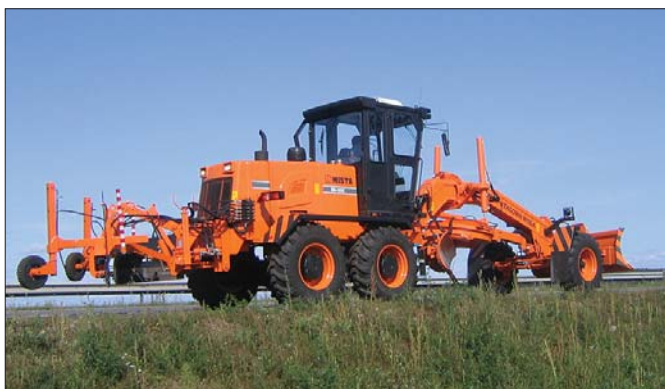
Równiarki MISTA posiadają wszelkie składowe badania certyfikacyjne i są oznaczone znakiem CE dopuszczającym do obrotu na terenie Unii Europejskiej. Na zdjęciu wyposażona w lemiesz zgarniający tylny równiarka RD165C pracująca na rynku litewskim
