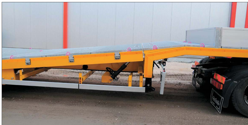
Semi-naczepa OSDS firmy Nootboom do przewozu wózków widłowych i podnośników teleskopowych
