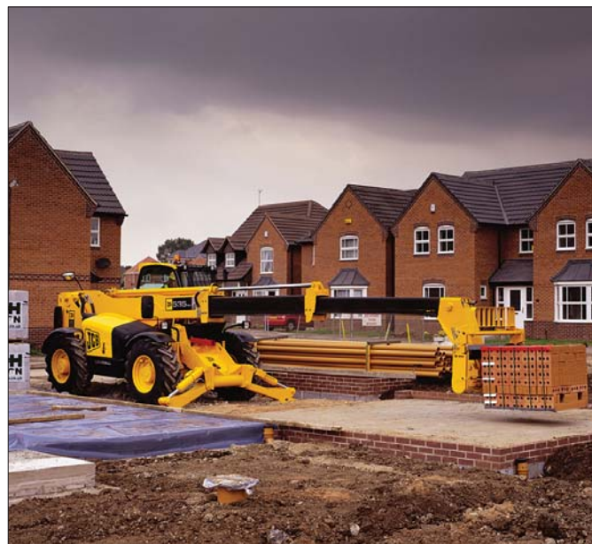
Nośnik JCB 535-140 przy pełnym rozsunięciu wysięgnika jest w stanie podać w przód na odległość 5,85 metra ładunek o wadze jednej tony
