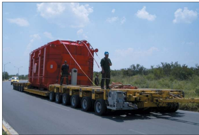
Wózki THP w układzie 1+1/2 szerokości z pomostem super-płaskim pozwalają na sprawną realizację ciężkiego transportu
