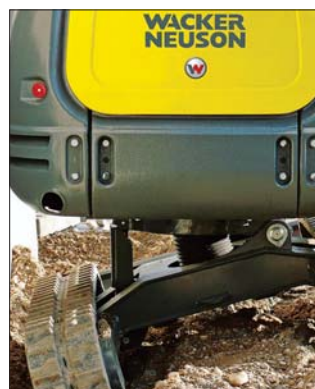
Układ VDS pozwala na poziomowanie nadwozia koparki do 15 stopni na oba boki
