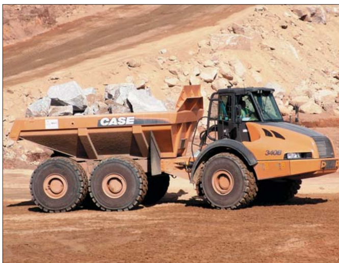
Wozidło przegubowe CASE 330B o ładowności 28 ton
