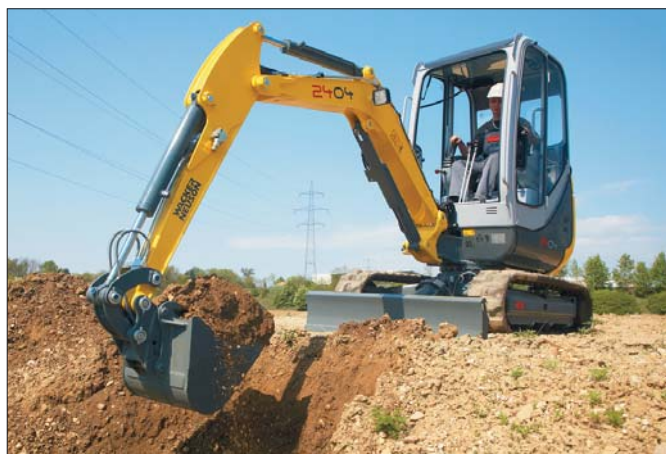
Napędzana trzycylindrowym silnikiem Yanmar 3TNV76 minikoparka Wacker-Neuson 2404 może kopać na maksymalną głębokość 2.720 mm
