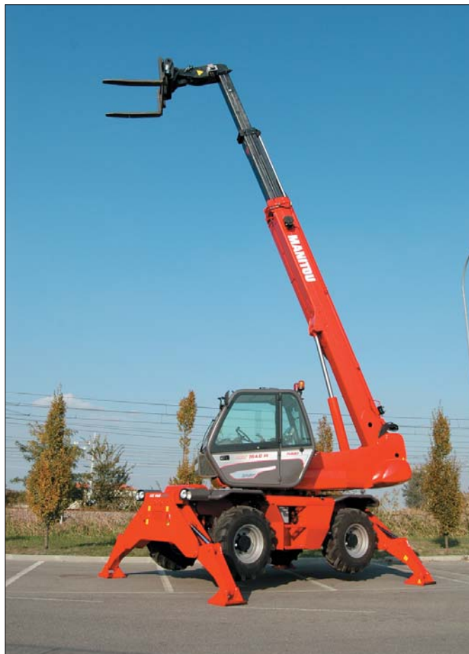
Maszyny Manitou z serii Easy wyposażone są w cztery niezależnie sterowane podpory przypominające te, jakie można spotkać w koparkach kołowych
