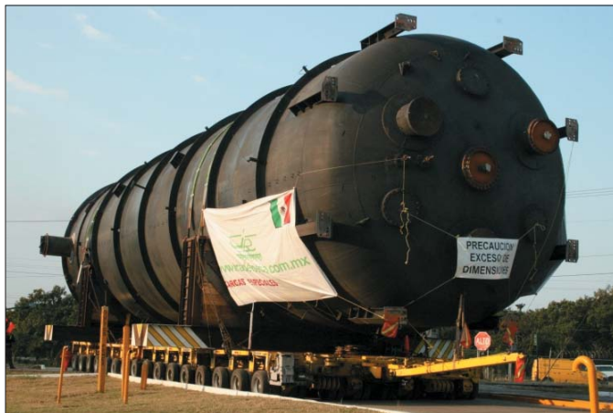
Do przewozu blisko trzystutonowego zbiornika Tradelossa wykorzystano połączone równoległe wózki modułowe THP/SL (2x16 osi)
