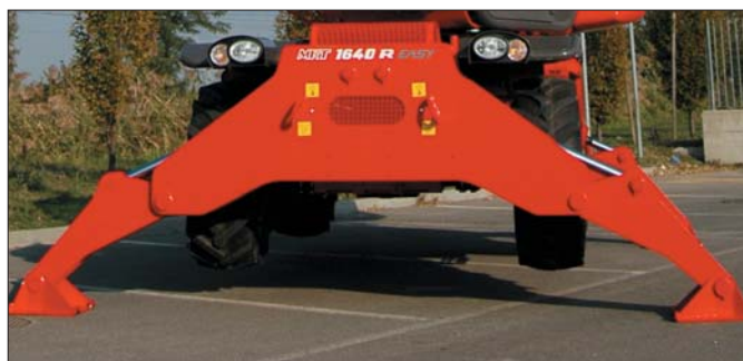
Komputer na bieżąco dokonuje odczytu z czujników ciśnienia na podporach, co zapewnia operatorowi maszyny pełne bezpieczeństwo pracy
