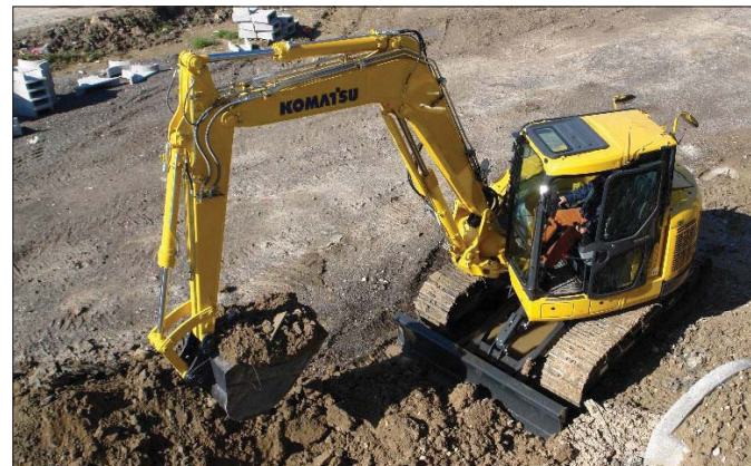
Komatsu PC118MR-8 napędzana silnikiem o mocy 72 kW to mocna maszyna o zwartych gabarytach. Gwarantuje to wysoką wydajność przy umiarkowanym zużyciu paliwa
