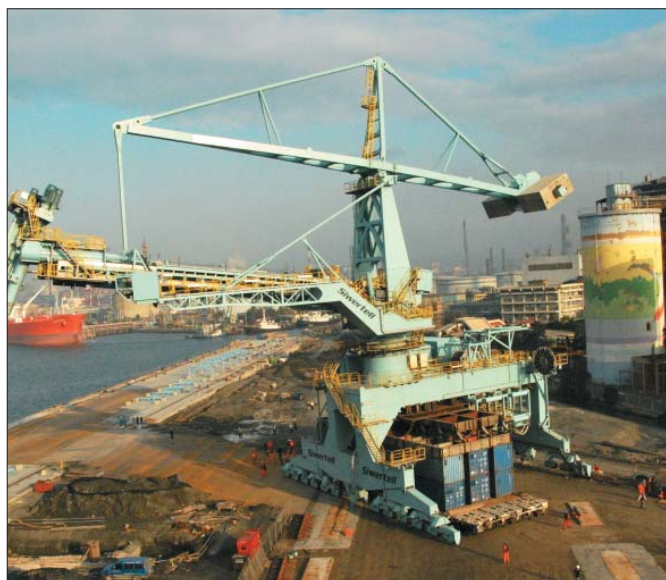
Goldhofer AG jest znany ze spektakularnych dokonań transportowych. Niemiecka firma z wielkim powodzeniem uczestniczyła ostatnio w operacji przewiezienia gigantycznej, ważącej blisko 1.050 ton portowej stacji przeładunkowej
