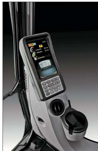
Czytelny wyświetlacz informuje operatora na bieżąco o parametrach roboczych
