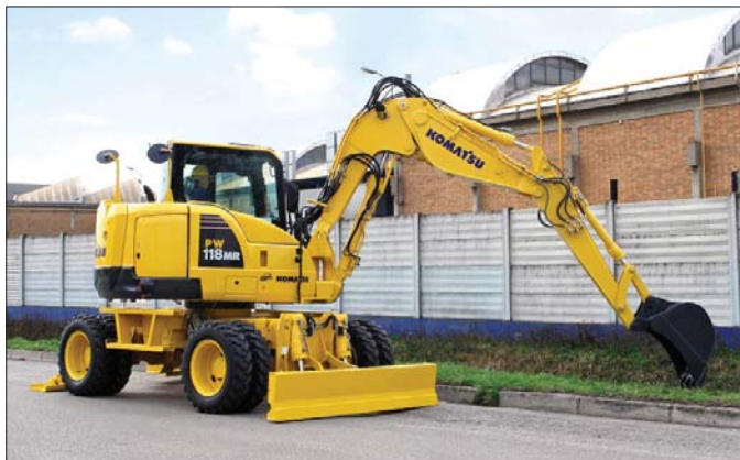
Ważąca 11.800 kilogramów koparka kołowa Komatsu PW118MR-8 sprawdza się doskonale na placach budowy o ograniczonej przestrzeni
