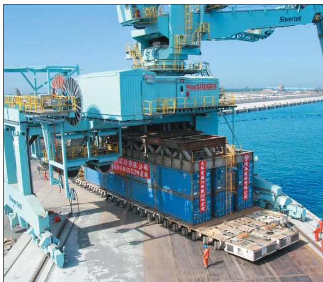
Do przeciągnięcia dźwigu przez nabrzeże i posadowienia go na torach użyto trzech połączonych równolegle, samojezdnych, 22-osiowych zestawów wózków typu PST/SL 22 (1+1+1) z dwoma jednostkami napędowymi Goldhofer-Powerpacks, każda o mocy 430 KM
