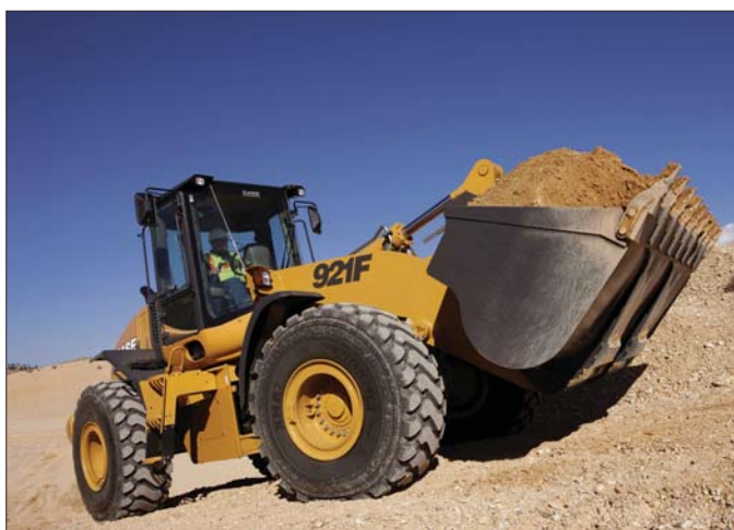
Zwiększona powierzchnia przeszkleń kabin nowych ładowarek kompaktowych Case oraz zmodernizowane ramiona wysięgnika poprawiają widoczność a tym samym komfort pracy operatora
