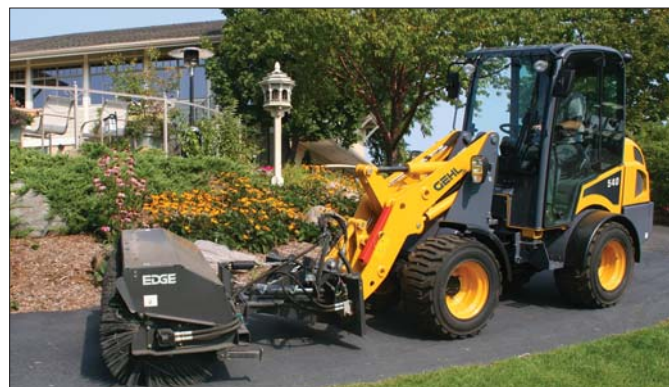
„Gaz ręczny” pozwala operatorowi na regulację prędkości jazdy całkowicie niezależnie od obrotów silnika. Daje to doskonałe efekty, na przykład podczas pracy z zmiataarką
