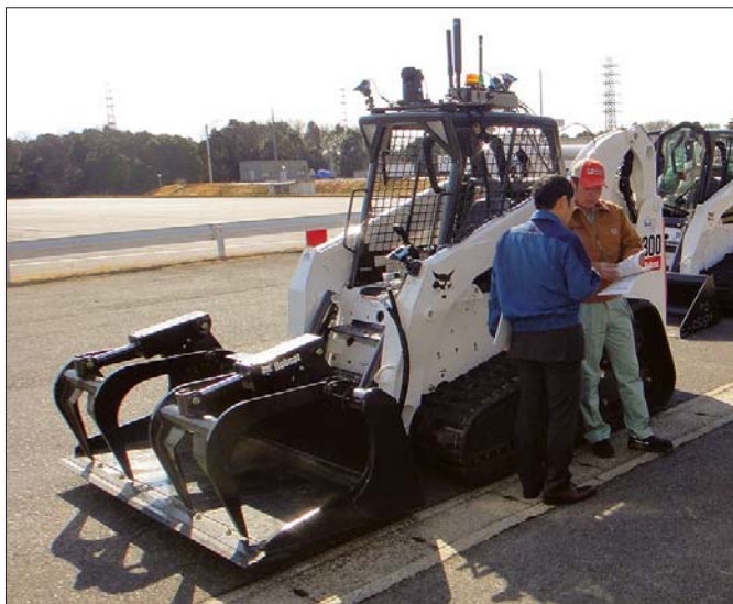
Miniladowarka gaśnicowa Bobcat wyposażona w osprzęt roboczy i układ zdalnego sterowania amerykańskiej firmy QinetiQ North America
