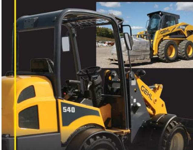
„Gaz ręczny” pozwala operatorowi na regulację prędkości jazdy całkowicie niezależnie od obrotów silnika. Daje to doskonałe efekty, na przykład podczas pracy z zmiataarką
