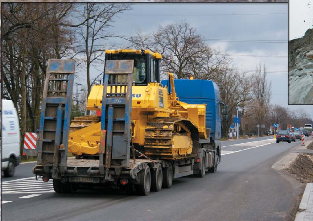
▼ W nowej spycharce KOMATSU D65PX-16 składany lemiesz prowadzony jest wewnątrz gąsienic (po raz pierwszy w tej klasie spycharek), dzięki czemu maszynę można bezproblemowo transportować.
