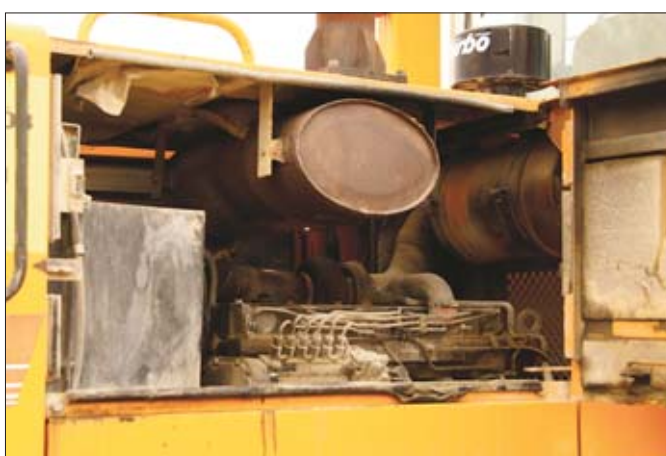
Maszyna przepracowała na jednym silniku 23 tysiące godzin. Mimo to jednostka napędowa znajduje się w doskonałym stanie. W komorze silnika nie widać żadnych wycieków
