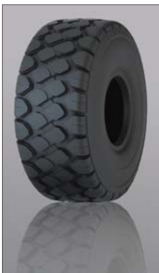
Opony radialne Solideal SRGP przeznaczone są do pracy w ładowarkach, równiarkach drogowych oraz wozidlach. Zaawansowany projekt konstrukcji, mieszanka gumowa oraz zoptymalizowany wskaźnik wypełnienia bieżnika znacząco wydłużają ich żywotność
