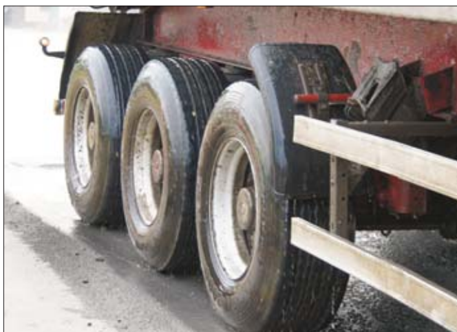
W kopalni „Żąbkowice” cykl mycia pojedynczego pojazdu trwa 20-30 sekund. Jeżeli kierowca zachowuje prędkość od 5 do 10 km/h, to efekty mycia są w pełni zadowalające
