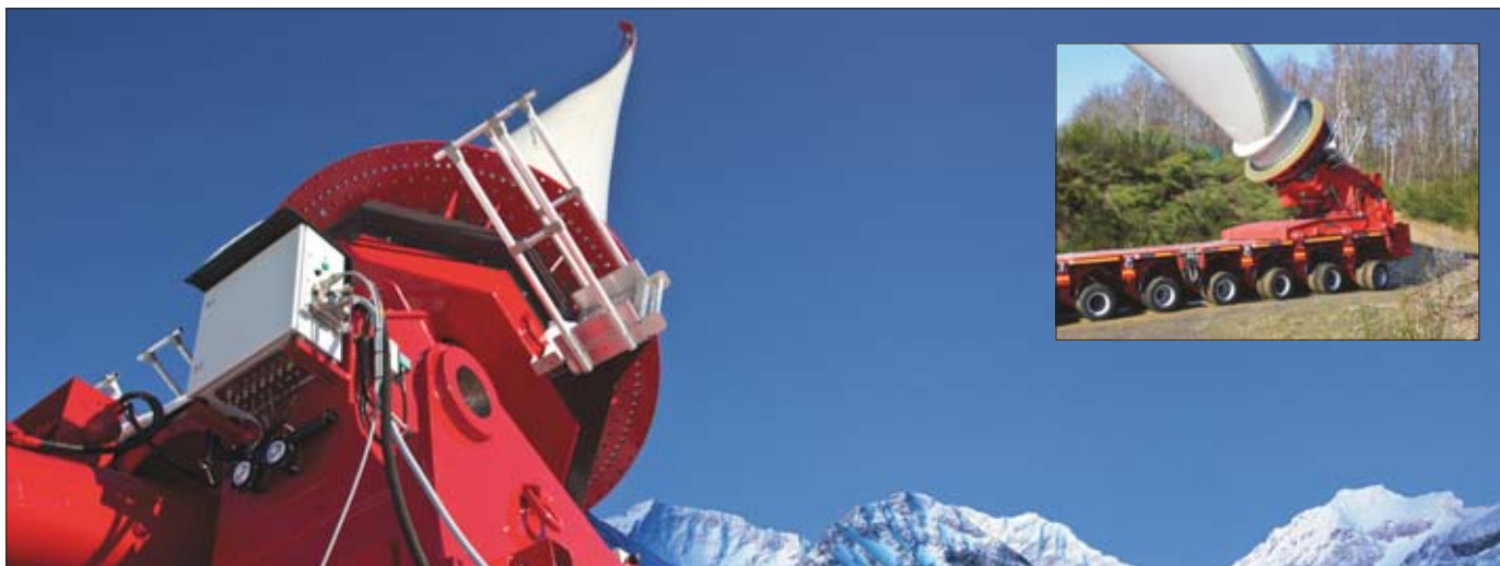
Śmigło można unieść maksymalnie pod kątem 60°. Może ono obracać się wokół własnej osi bez ograniczeń, tak aby jak najkorzystniej ustawić się do wiatru
