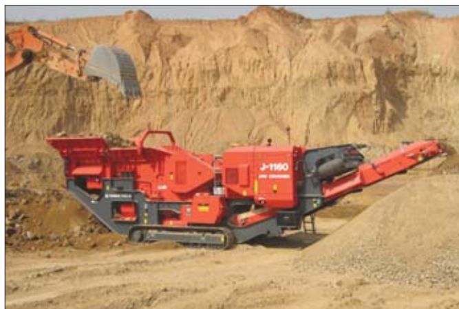
Kruszarka szczękowa Finlay J-1160 znajduje zastosowanie w kamieniołomach, kopalniach, przy rozbiórkach i pracach recyklingowych
