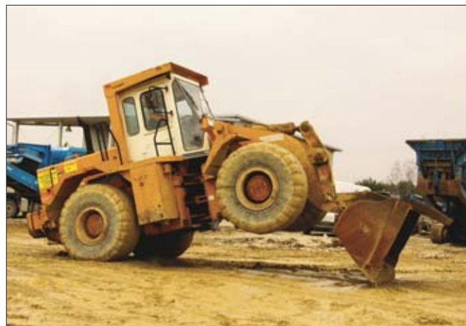
Stójka na tyłce. W ten sposób operator PGS udowodnił, że układ hydrauliczny mimo przepracowania 23 tysięcy godzin pozostaje w pełnej sprawności
