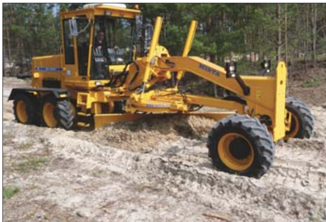
RD130FHD jest zdecydowanie lepiej dostosowana do wykonywania dokładnych robót ziemnych, odśnieżania oraz prac z osprzętem wymagającym bardzo niskich prędkości jazdy
