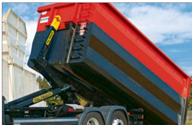
Zginane ramie hakowca (pochylana „wieża”) zmniejsza kąt załadunku umożliwiając jednocześnie zwiększenie zakresu długości kontenera
