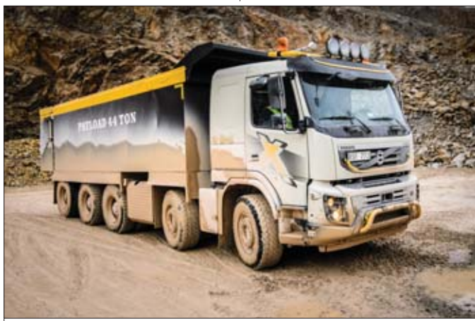
Volvo FMX 10x4 w trudnych warunkach kopalnianych spisywało się doskonale. Jednorazowo przewoziło o połowę ładunku więcej niż ciężarówka czteroosiowa
