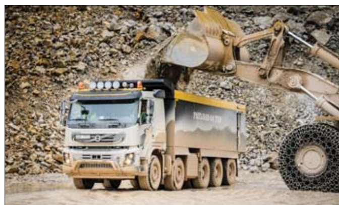
Ładowność pięciosiowego Volvo FMX wynosi aż 44 tony, dzięki czemu pojazd stanowić może alternatywę również dla wozideł budowlanych
