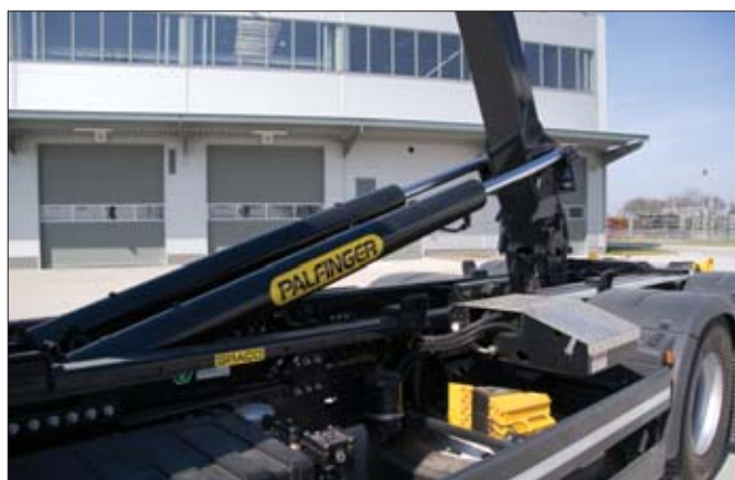
Teleskopowane ramie hakowca pozwala na używanie kontenerów o dużym zakresie długości i tym samym zwiększa zakres zastosowań urządzenia
