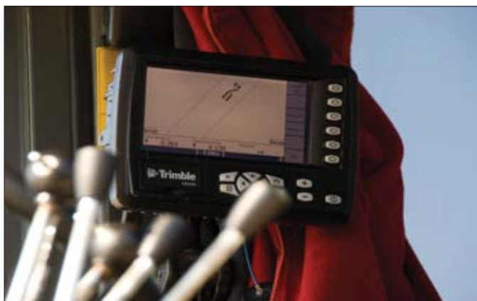
Dane wyświetlane na panelu operatora dostępne są w trzech widokach: planu, profilu oraz przekroju poprzecznego
