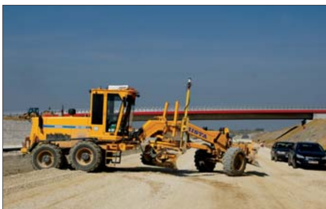
Kąt łamania \pm 27^\circ zapewnia doskonałą sterowność i zwrotność. Na uwagę zasługuje niewielki promień zawracania mierzony po linii kół zewnętrznych
