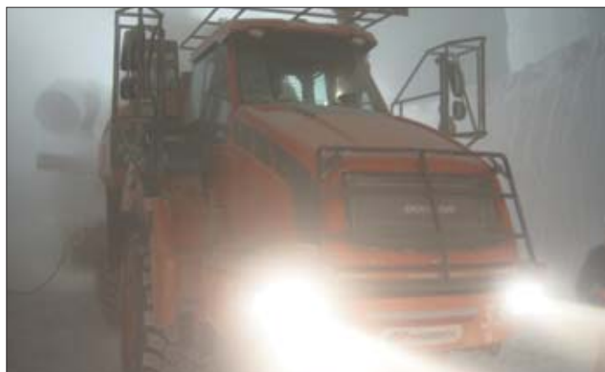
Wozidła Doosan pracują pod ziemią nawet przez piętnaście godzin na dobę. Z reguły narażone są na bardzo wysoką temperaturę i ogromne zapylenie
