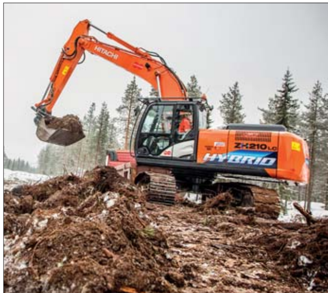
W porównaniu z maszynami konwencjonalnymi tej samej klasy eksploatowanymi w porównywalnych warunkach, hybryda Hitachi zużywa zdecydowanie mniej paliwa. Średnia oszczędność w tym zakresie sięgają może nawet trzydziestu procent
