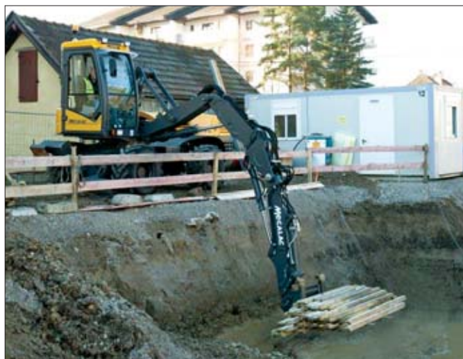
Podnoszenie najcięższych ładunków i precyzyjne ich umieszczanie nawet trzy metry poniżej poziomu, na którym stoi maszyna, to żaden problem dla Mecalaca
