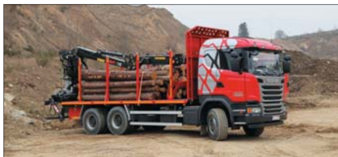
Jeszcze do niedawna leśnicy niemal zawsze zamawiali podwozia z układem napędowym 6x6. Teraz dominują odmiany 6x4, bo w większym stopniu zwracają uwagę na masę własną pojazdu i zużycie paliwa
