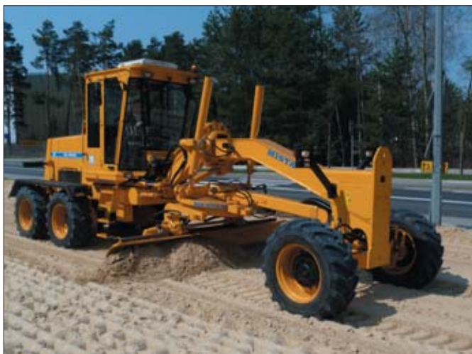
Równiarka drogowa RD10FHD z pełnym napędem hydrostatycznym 6x6 potwierdza kompetencje konstruktorów stalowowolskiej Misty
