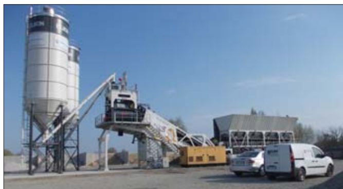
Urządzenia marki Elkon odznaczają się zwartą budową, co zdecydowanie ułatwia transport i ma wpływ na ograniczenie powierzchni instalacji
