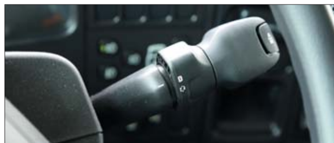
W pojazdach budowlanych system zmiany biegów Scania Opticruise ma dodatkowy tryb pracy (Off-road), ułatwiający jazdę w trudnym terenie
