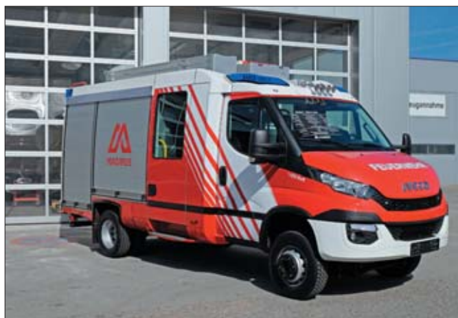
Pomysł na wprowadzenie dołączanego napędu na przednią oś wziął się z branży pożarniczej. Daily w wersji All-Road ma wyżej umieszczone podwozie, co ułatwia przejazd po bardziej wymagającej nawierzchni
