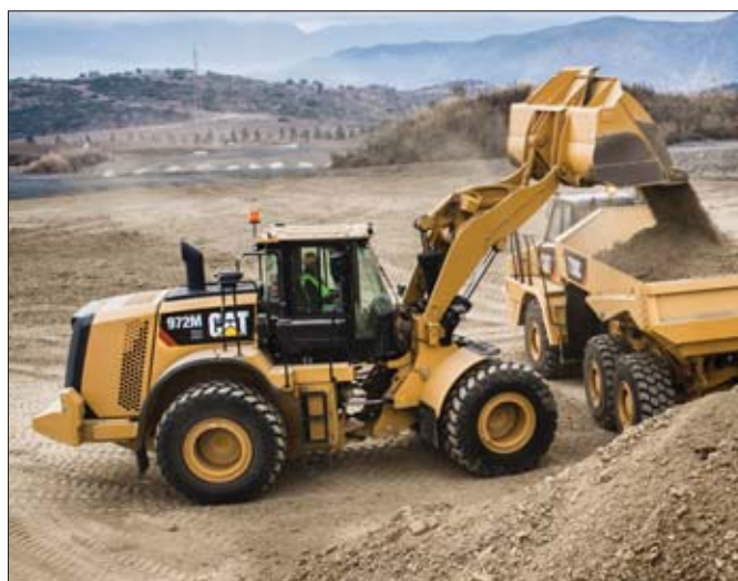
Sterowanie ładowarką 972M XE jest bardzo łatwe, bo ma ona tylko dwa pedały, tj. „gaz” i hamulec, którego wciśnięcie do pewnego momentu powoduje odłączenie napędu, a dopiero później hamowanie
