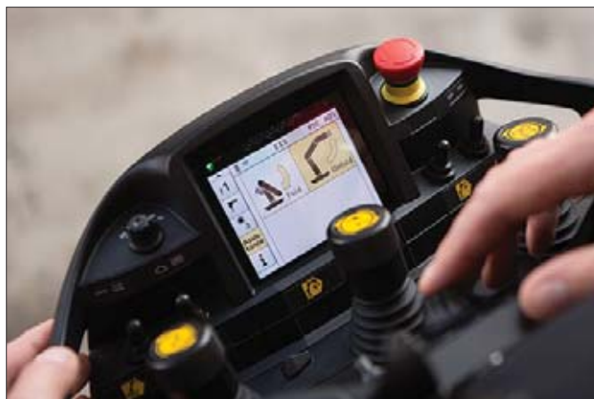
W nowym PALcom P7 zastosowano wyświetlacz o wielkości 4,1 cala z powłoką transflektywną gwarantującą bardzo dobrą czytelność nawet przy silnym nasłonecznieniu
