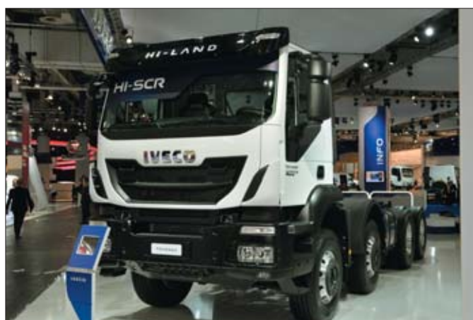
Iveco Trakker w wersji super lekkiej pod betonomieszarkę jest dostępny w wersji 6x4 lub 8x4. Zależnie od potrzeb można też wybrać tylny wózek z pojedynczą redukcją lub osiami wyposażonymi w zwolnice
