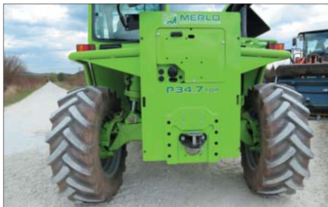
Podczas pracy z „koszem” ładowarka Merlo stabilizowana jest sitownikiem hydraulicznym zamontowanym przy tylnej osi. Zarówno ona, jak i oś przednia mają konstrukcję portalową, co zapewnia większy prześwit
