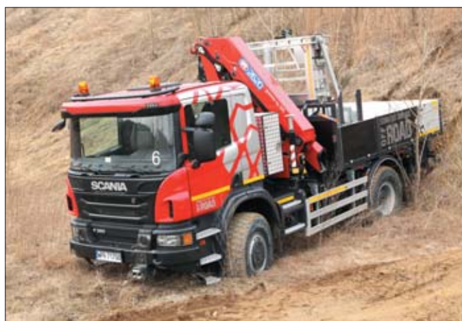
Dzięki uterenowionemu podwoziu z napędem 4x4, pojedynczymi tylnymi kołami i krótkiemu rozstawowi osi, taki pojazd trudno zakopać, a jeśli już do tego dojdzie można się wydostać z opresji przy wykorzystaniu zamontowanej z przodu wyciągarki
