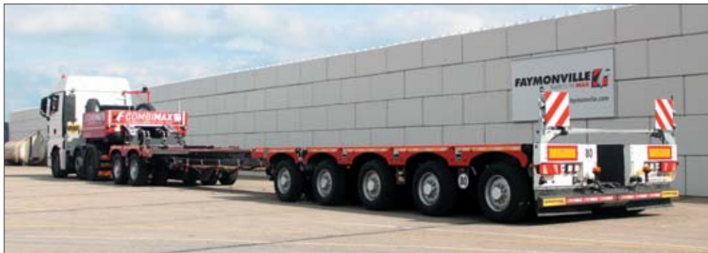
Naczepa Faymonville CombiMax pozwala na precyzyjne dobranie liczby osi i długości pojazdu pod konkretny ładunek, w znaczący sposób obniżając koszty ponadnormatywnego transportu
