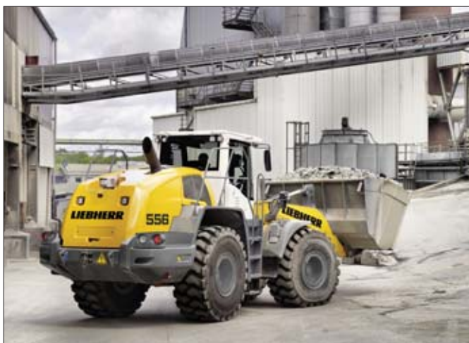
W modelu L 556 zaprojektowano na nowo komorę silnika i zabudowano poprzecznie silnik wysokoprężny. Dzięki temu maszyna jest bardziej kompaktowa, a wszystkie punkty codziennej obsługi serwisowej stały się dostępne z poziomu podłoża
