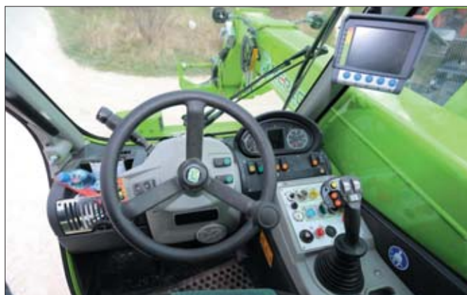
W kabine Merlo wszystkie wskaźniki są dobrze widoczne, a obsługa przyrządów nie wymaga odrywania pleców od oparcia fotela. Z lewej strony kolumny kierownicy wygospodarowano miejsce na praktyczną półkę
