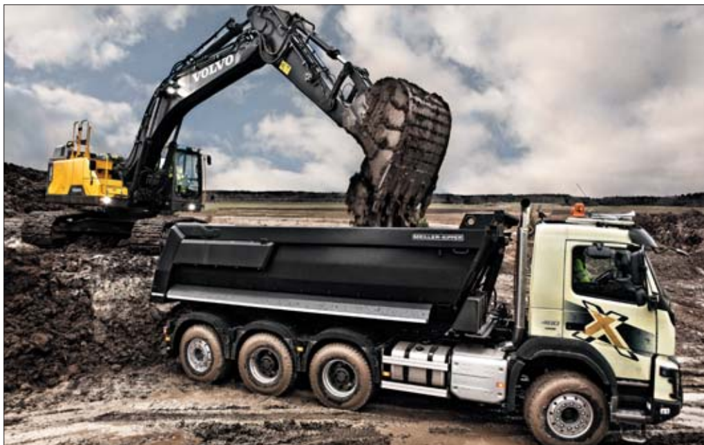
Ponieważ w transporcie budowlanym co najmniej połowa czasu upływa na jeździe bez ładunku, możliwość podniesienia osi w istotny sposób przekłada się na ograniczenia zużycia paliwa i ogumienia
