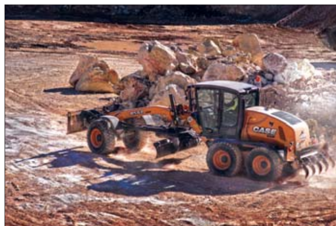
Przekładnia ze zmiennikiem momentu obrotowego zapewnia płynną zmianę biegów oraz idealne dopasowanie prędkości i mocy do warunków panujących na danym placu budowy
