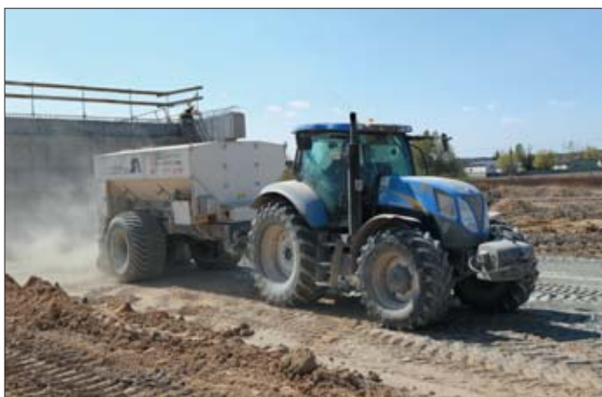
Przy robotach związanych z przygotowaniem gruntu pod drogę optymalnym rozwiązaniem są ciągniki oferujące wyższą moc rzędu 250-350 KM. Praca, którą wykonują nie jest skomplikowana, dlatego są zamawiane prostych kompletacjach
