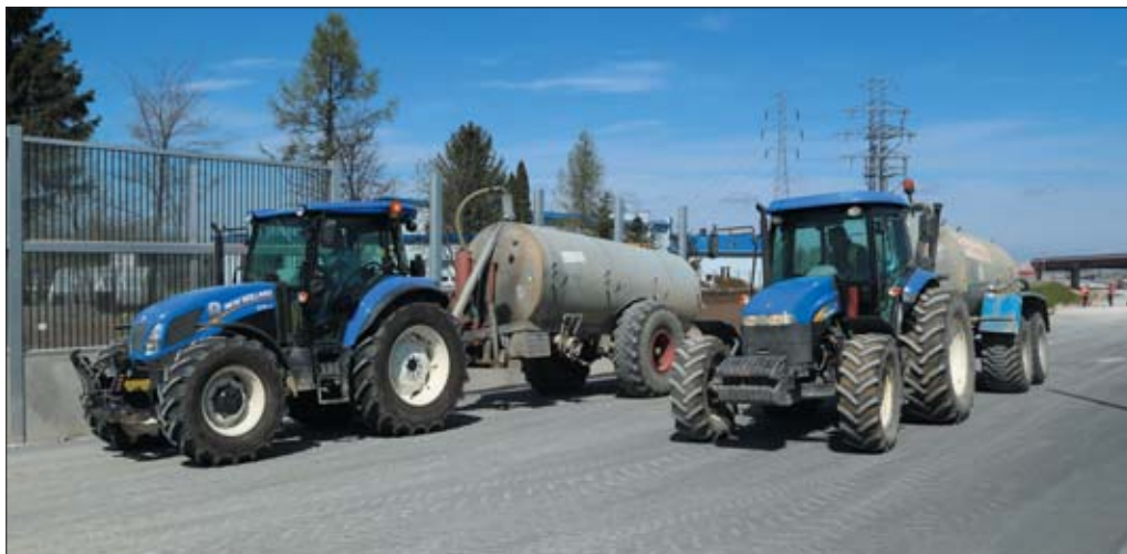
Mniejsze ciągniki o mocy w przedziale 80-120 KM najczęściej znajdują zastosowanie przy pracach pomocniczych, takich jak zmywanie nawierzchni czy zraszanie dróg gruntowych w celu ograniczenia wzniesienia kurzu przez samochody ciężarowe
