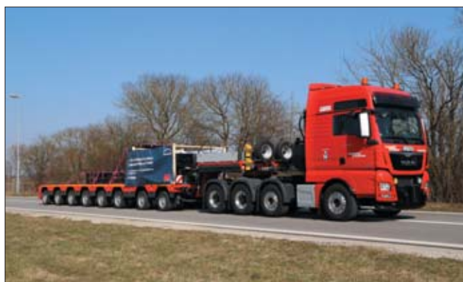
Flagowy MAN TGX D38 w topowej wersji o mocy 640 KM znakomicie nadaje się do transportu ładunków ponadnormatywnych. Pozwala na tworzenie zestawów drogowych o masie całkowitej 250 ton
