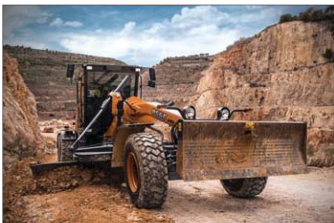
Wyjątkowa konstrukcja lemiesza zmniejsza wymagania w zakresie siły uciążu podnosząc efektywność maszyny przy zadaniach wymagających precyzyjnego równiania
