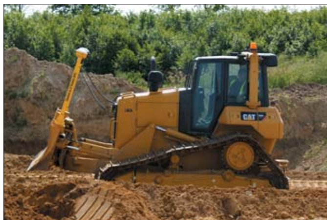
Kontrola dokładności wykonania prac wykazała niezbicie, że spycharka z systemem GCS900 pracowała nie tylko szybciej, ale także ekonomiczniej i dokładniej
