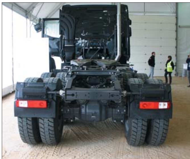
Wzmocniony karkas opon Michelin X Works zapewnia nośność osi równą 8 ton przy pojedynczym montażu ogumienia oraz 13,4 tony dla montażu bliźniaczego
