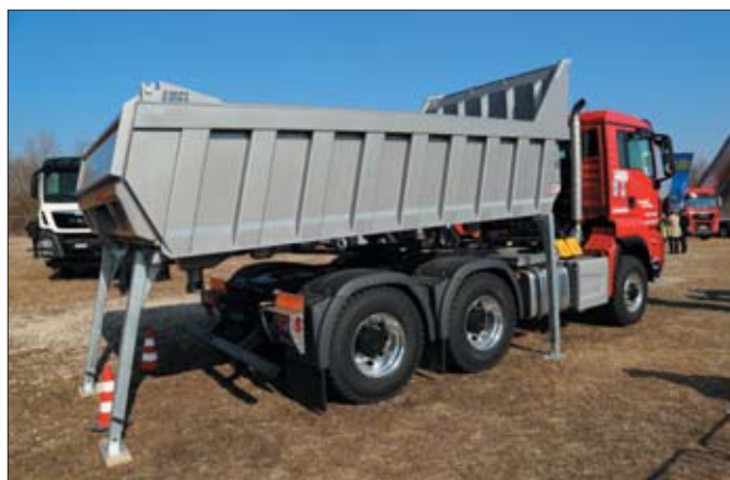
Przy ograniczonej flocie pojazdów warto inwestować w rozwiązania uniwersalne, jak np. ciągnik siodłowy MAN TGS 6x4, który bardzo łatwo przekształcić w wywrotkę tylnozsypową
