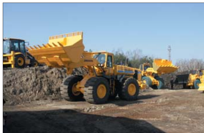
Podczas pokazów zaprezentowano całą gamę ładowarek kołowych produkowanych w Stalowej Woli w tym też najnowszą konstrukcję – maszynę 565E o wadze 44 ton, mocy netto 515 KM i pojemności łyżki 6,7 m 3
