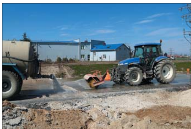
Przedni TUZ i WOM zwiększają możliwości zastosowań ciągnika, który pełnić może funkcję praktycznej zamiatarki, a nawet zmywarki w tandemie z traktorem ciągnącym beczkę z wodą
