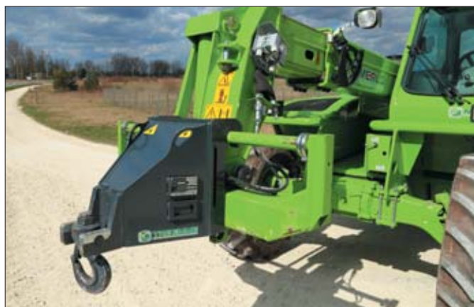
Osprzęt hakowy to jedno z czterech narzędzi roboczych zakupionych razem z nową ładowarką Merlo. Doskonale sprawdza się przy obsłudze big-bagów, przeładunku materiałów o nieregularnych kształtach i pracach budowlanych
