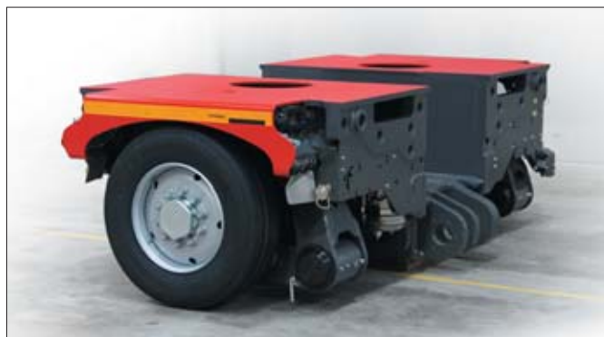
Przy konfigurowaniu naczepy CombiMax można stosować wózki jezdne z dowolną liczbą osi w przedziale 1-6. Moduł z pojedynczą osią został nazwany Jokerem
