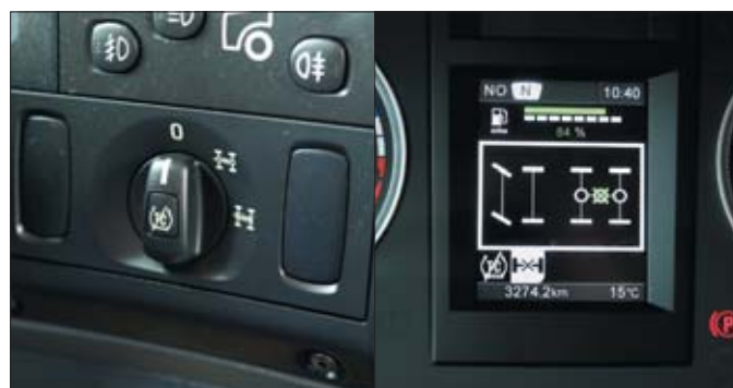
Uruchamianie blokad mechanizmów różnicowych odbywa się za pomocą pokrętła, narzucającego prawidłową kolejność ich załączania.
