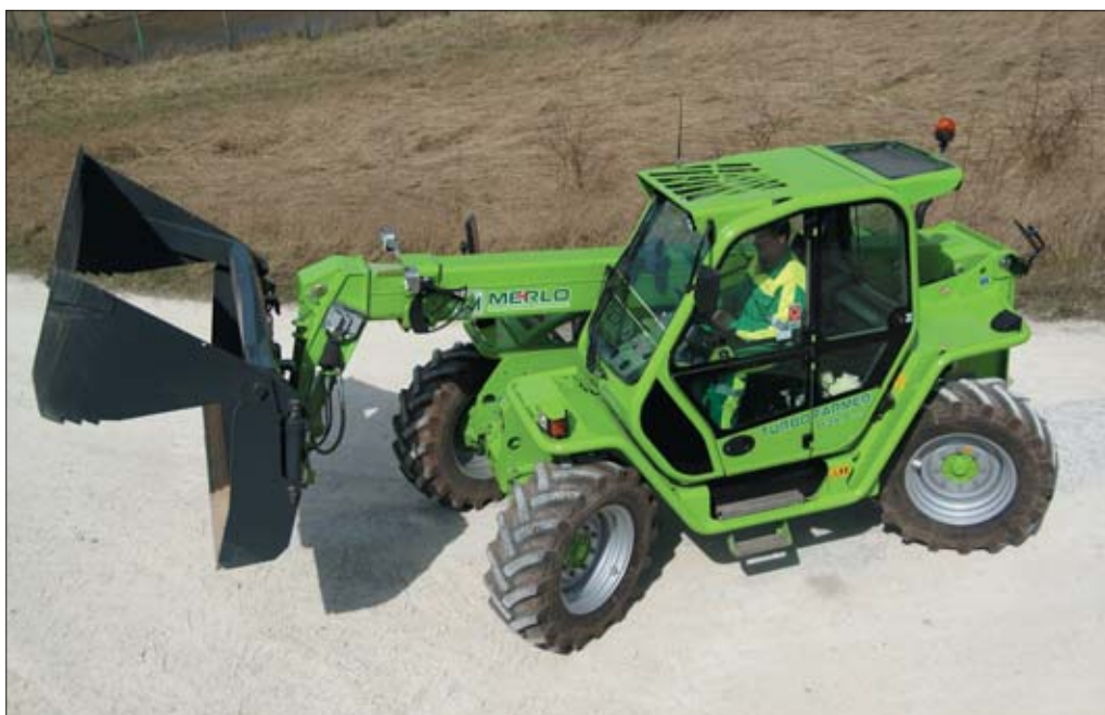
Ładowarka Merlo Turbofarmer P34.7 TOP każdego dnia wykonuje wiele różnych prac na terenie cementowni, ale do głównych jej zadań należy obsługa młyna i przeładunek paliwa alternatywnego
