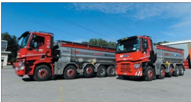
Pięćosiowe Renault Trucks C 10x4 wykorzystywane przez szwajcarską firmę MST SA mają masę własną 16 ton i pojemność 17 m 3
