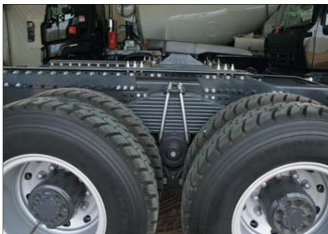
Szerokie rowki między zewnętrznymi blokami bieżnika ułatwiają odprowadzanie wody i zwiększają trakcję na drogach o gorszej jakości
