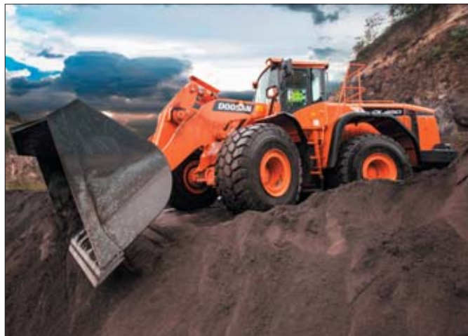
Układ Z-bar ułatwia podnoszenie ciężkich ładunków. Stabilizuje maszynę, pozwala na szybkie ruchy łyżki przez cały czas utrzymując ją pod odpowiednim kątem
