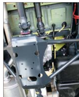
Oprócz podzespołów niezbędnych do przeniesienia napędu na przednią oś, firma Achleitner montuje w modyfikowanych podwoziach solidne osłony, które chronią skrzynię rozdzielczą i przedni most przed uszkodzeniem
