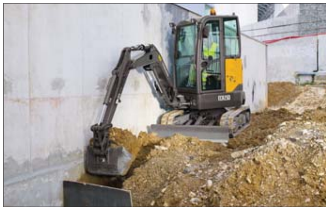
Wszystkie minikoparki posiadają funkcję obrotu wysięgnika względem kabiny, pozwalając na wygodne prowadzenie wykopów tuż przy budynkach czy ogrodzeniach
