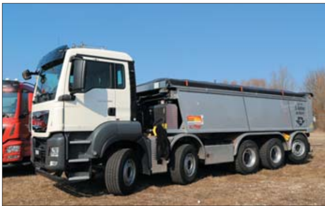
Na MAN Trucknology Days nie brakuje ciekawych pojazdów. Jednym z nich był z pewnością 5-osiowy TGS 50.480 z kierowaną, podnoszoną osią wleczoną i skrzynią z płytą spychającą. Został przygotowany na rynek szwajcarski
