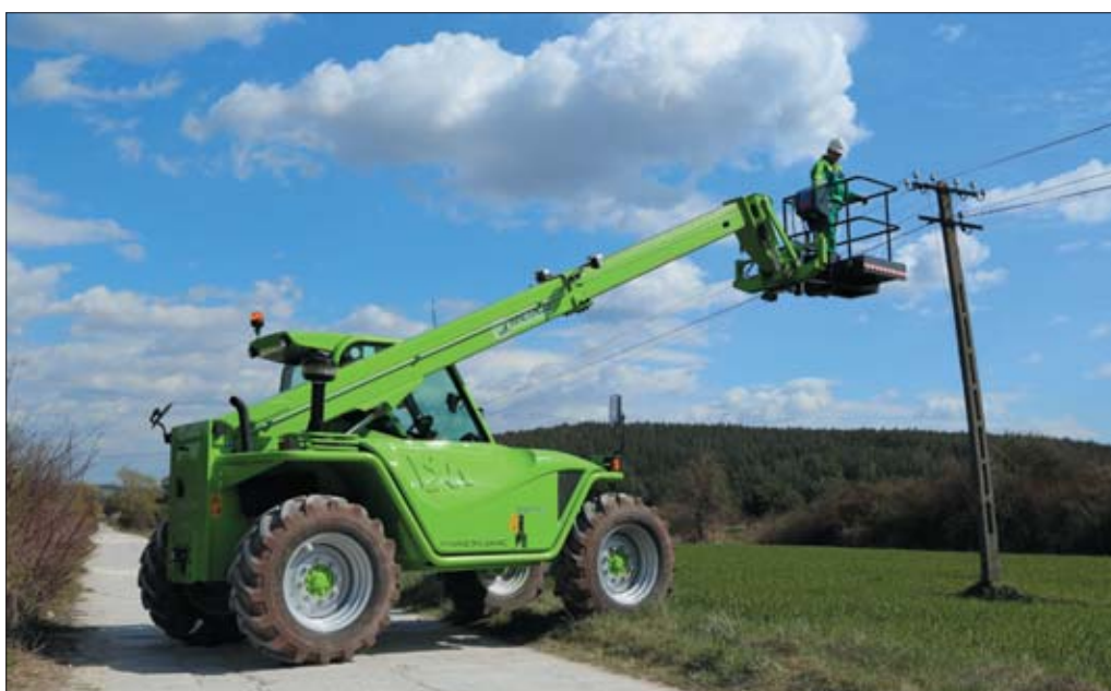
Niezwykle istotną zaletą ładowarki teleskopowej Merlo Turbofarmer P34.7 TOP jest możliwość pracy z platformą roboczą, mimo że maszyna nie jest wyposażona w hydraulicznie rozstawiane podpory
