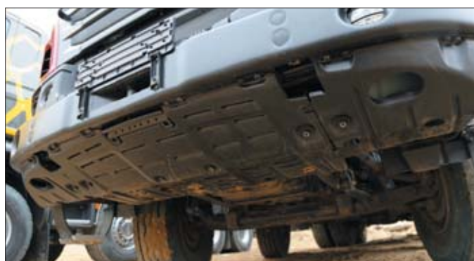
Pojazdy budowlane Scania serii P i G są wyposażane w solidną płytę osłaniającą spód silnika. W tym przypadku uciąż zacze- pu wynosi 35 ton
