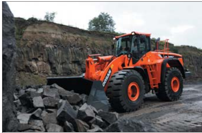
Duże ładowarki kołowe Doosan nowej generacji wyposażono w układ hydrauliczny, w którym osiowa pompa tłokowa dostosowuje przepływ do konkretnych potrzeb
