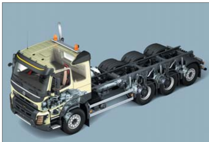
Nośność osi zespolonej Tridem jest równa 36 ton. Każda para kół współpracuje z czterema miedziami powietrznymi, dzięki czemu jazda nieobciążoną ciężarówką na drogach kieszkielnej jakości jest zdecydowanie mniej męcząca
