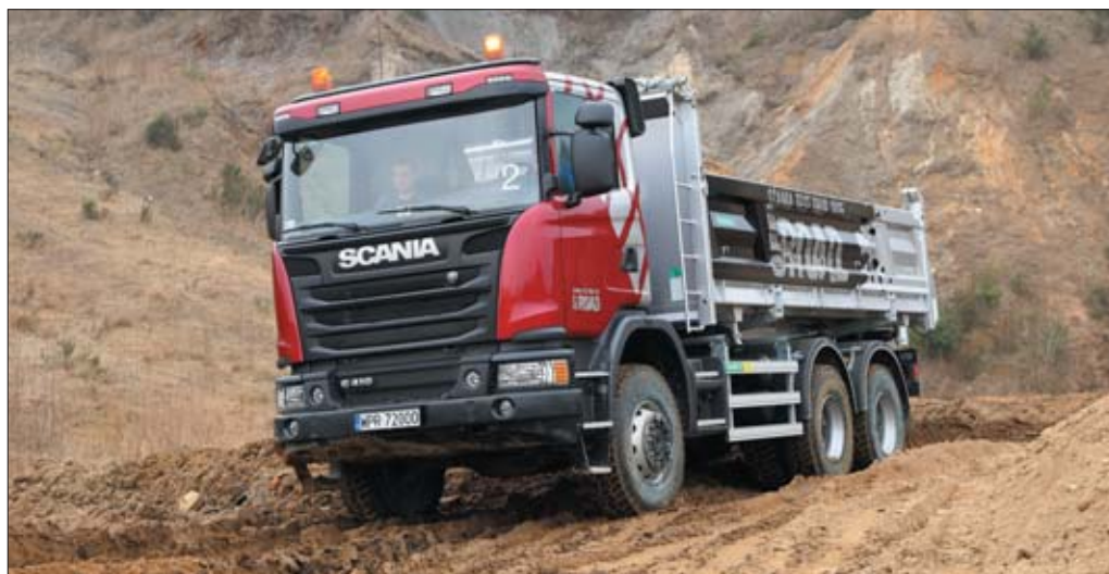
Ważną cechą nowych pojazdów budowlanych Scania są bardzo solidne zwolnice ze zwiększonym o 10% przelozeniem i współpracujące z nimi półosie, które w najnowszym wydaniu są grubsze i charakteryzują się większą wytrzymałością na skręcanie
