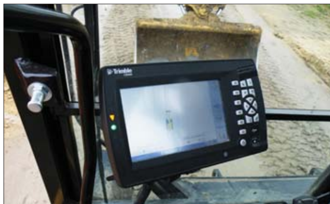
Projekt 3D jest wgrany do komputera sterującego, dzięki temu operator na ekranie obserwować może w trzech wymiarach obraz zadania do wykonania
