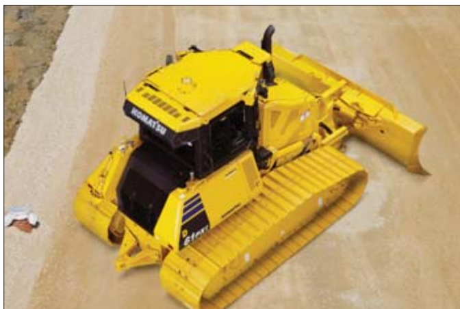
Już na pierwszy rzut oka dostrzec można umieszczoną na stałe na dachu inteligentnej spycharki antenę GNSS. Dzięki temu na leśmieszu nie trzeba montować masztów
