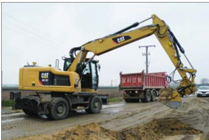
System wymaga zamontowania na maszynie dwóch anten satelitarnych oraz czujników grawitacyjnych umieszczonych na ramieniu oraz łyżce koparki
