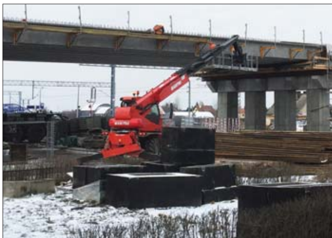
Manitou MRT 2150 Privilege to nie tylko ładowarka teleskopowa. Maszyna może być z powodzeniem wykorzystywana jako podnośnik koszowy
