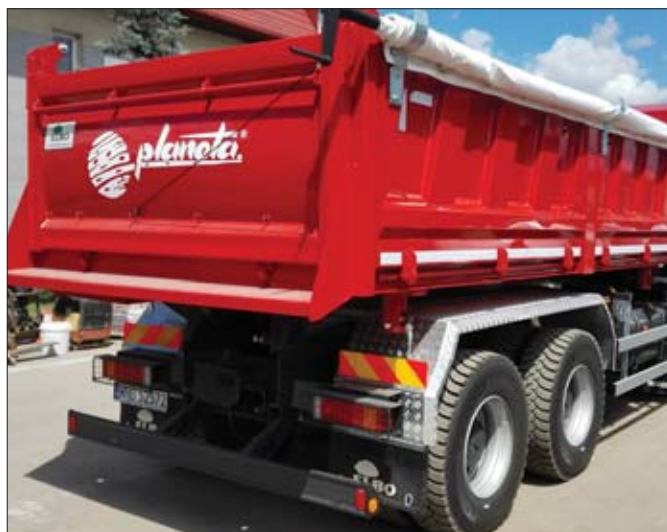
Zabudowa trójstronna Elbo 3WH z lewą burtą otwieraną hydraulicznie o kąt 167° znakomicie sprawdza się w transporcie materiałów sypkich
