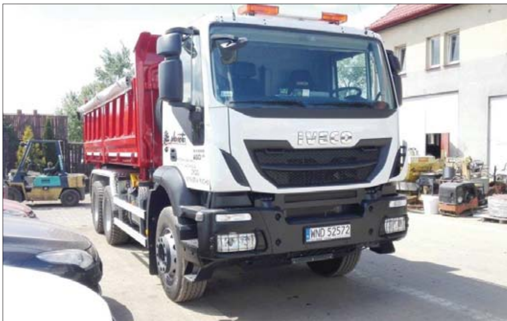
Eksplloatowany przez firmę „Planeta” Iveco Trakker t to napędzany sześciocylinowym silnikiem rzędowym Cursor 13 o pojemności 12,9 dm 3 model AD380T45 z układem napędowym 6x4 i rozstawem osi 3.500 mm
