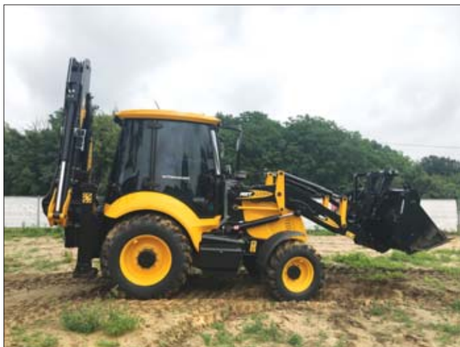
Nabywca koparko-ładowarki MST otrzymuje w standardzie dodatkowy obwód hydrauliczny do zasilania młota oraz teleskopowane ramie koparkowe
