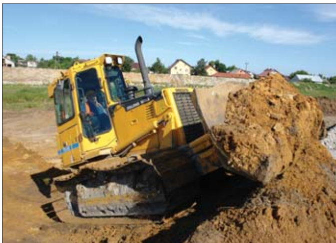
Spycharki wyposażono w lemiesz uniwersalne, dzięki czemu maszyny sprawdzają się doskonale podczas profilowania skarp
