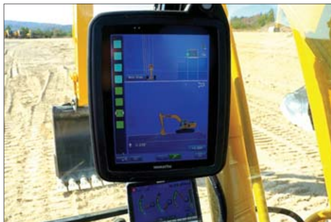
Koparka PC210LCi wyposażona została w największy spośród dostępnych na rynku wyświetlacz o rozmiarze 12,1 cala, co zwiększa komfort pracy operatora
