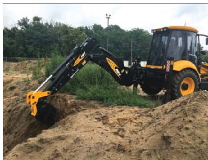
Ramie wysięgnika koparkowego imponuje solidnością wykonania. Zastosowanie wzmocnień profili bocznych zwiększyło jego odporność na działanie sił skręcających i udary
