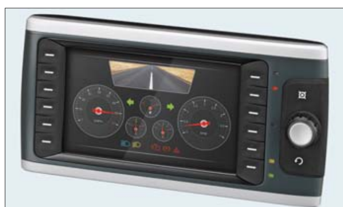
BODAS DI4 to uniwersalny panel sterowania do mobilnych maszyn roboczych, specjalnie zoptymalizowany do zastosowań związanych z komunikacją siecią
