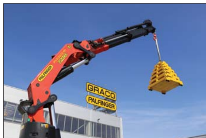
Stanowiący integralną część zabudowy żuraw Palfinger PK 63002 EH na maksymalnym wysięgu wynoszącym 11,4 metra ma udźwig aż 4.750 kilogramów
