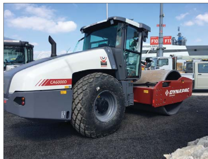
Walce Dynapac szóstej generacji system Seismic. Za jego pomocą automatycznie określić można optymalną częstotliwość zagęszczania dla dowolnego materiału
