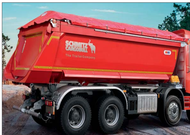
Zabudowa samowyładowcza typu M. KI z elektrycznie zasuwaną plandeką, która może być łatwo i szybko otwierana lub zamykana za pomocą zdalnego sterowania
