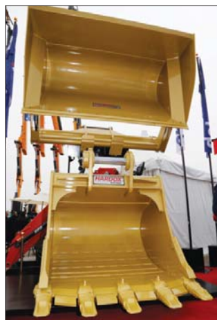
Łyżka koparkowa podsiębierne skalna (na dole) oraz łyżka ładowarkowa wysokiego wysypu
