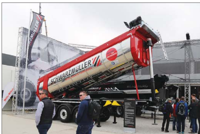
Izolowana termicznie wywrotka do transportu asfaltu, która przeszła pełną procedurę certyfikacyjną TÜV po raz pierwszy została pokazana tak szerokiej publiczności na Baumie
