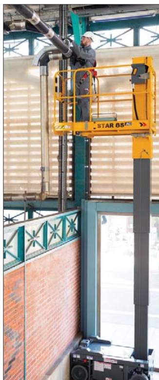
Opcjonalnie podest STAR 8S wyposażony można w wysuwana platformę
