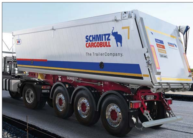
W przypadku naczepy wywrotki S.KI z izolacją termiczną konstruktorzy Schmitz Cargobull dołożyli wszelkich starań, by zmniejszyć masę zabudowy
