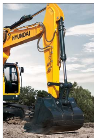
Wysięgnik i łyżka koparki zostały wzmocnione, co wydłużyło ich żywotność
