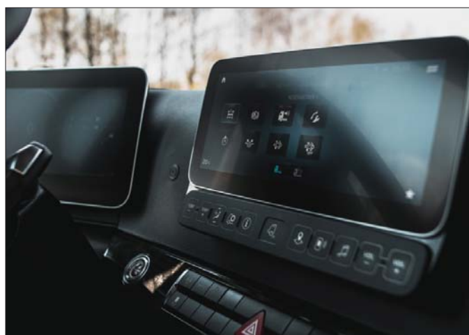
Wyświetlacze Multimedia Cockpit wizualizują funkcje zabudowy, a wirtualne przełączniki służą jako uzupełniające elementy obsługowe
