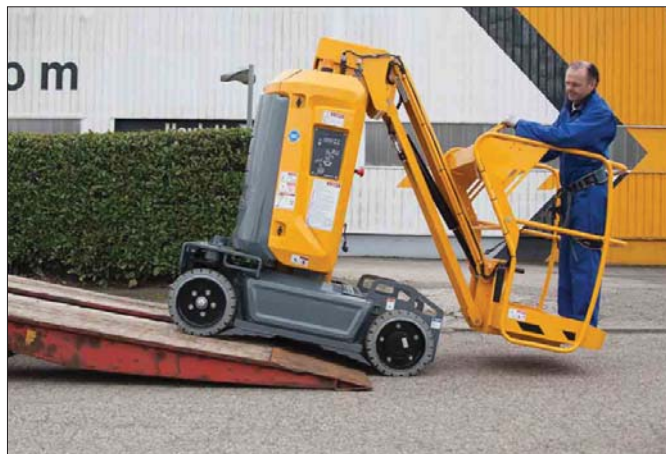
Transport podestów STAR na kolejne miejsce nie nastręcza większych problemów. Urządzenie łatwo wjeżdża na przyczepę po pomostach załadowniczych
