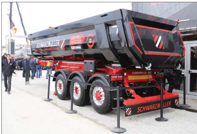
Jednym z ciekawszych eksponatów zaprezentowanych przez firmę Schwarzmüller na tegorocznej Baumie była trzyosiowa, stalowa naczepa-wywrotka z osią napędową
