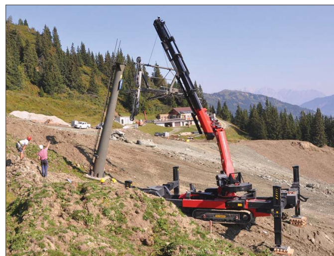
Najmocniejszy wśród żurawii gąsienicowych PCC jest model 115.002, którego maksymalny wycięg wynosi 33,3 metra, a udźwig nawet 30.000 kilogramów
