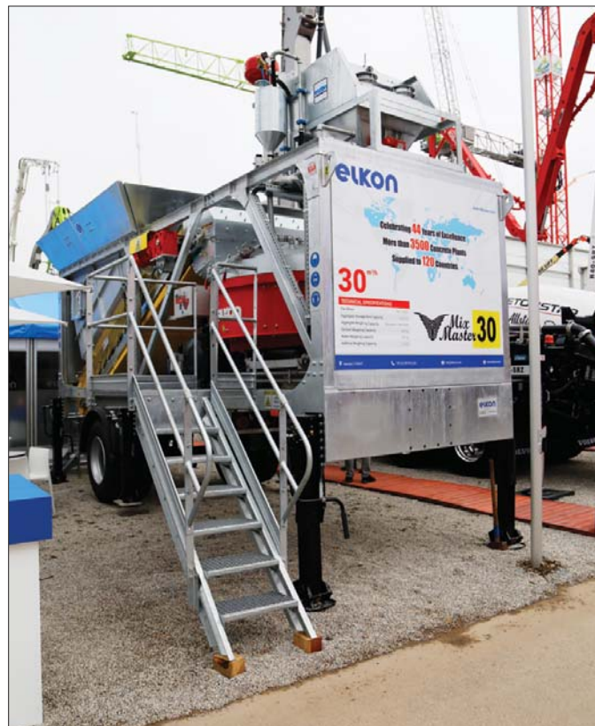
Olbrzymim atutem betoniarni Mix Master-30 jest szybkość uruchamiania. Urządzenie jest gotowe do pracy w ciągu godziny od momentu dotarcia na miejsce przeznaczenia
