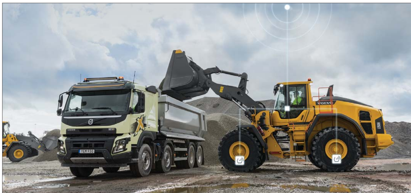
Każdy, nawet mniej doświadczony operator ładowarki doskonale wie, jak trudno jest nie zakopać maszyny podczas ładowania piasku czy ilów. Możliwość kontrolowania siły trakcji chroni przed ryzykiem występowania tego rodzaju problemów
