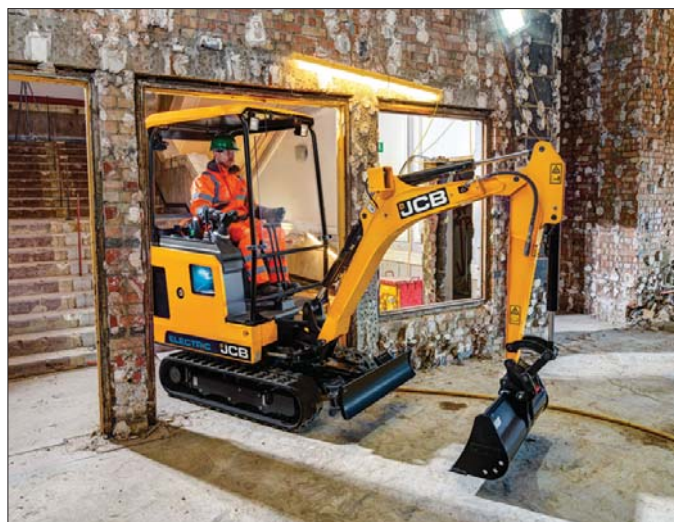
Maszyna wyposażona jest w trzy akumulatory litowo-jonowe o pojemności 312 Ah, a wygodna ładowarka pokładowa pozwala na ich naładowanie w ciągu 5-8 godzin
