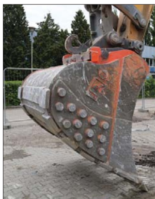
Na bokach zamocowano osłony w postaci krążków ze stali trudnościeralnej
