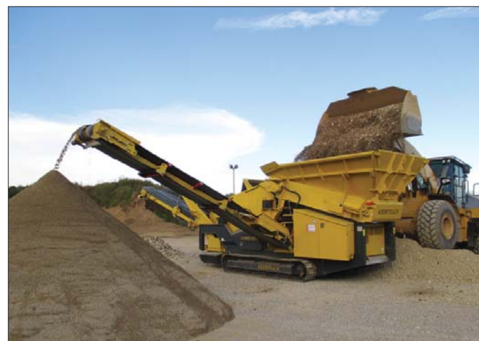
Duża powierzchnia wlotu i pojemność kosza przesiewacza sprawia, że może on być zasypywany przez przenośnik taśmowy, kruszarkę, koparkę lub ładowarkę kołową
