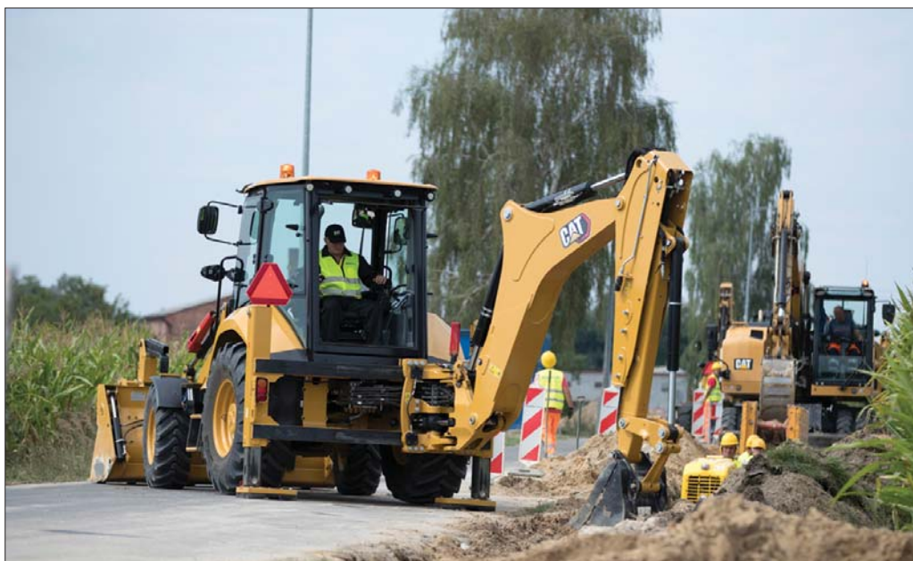
Dzięki połączeniu wszechstronności i dużych sił odpajania, układu wykrywania obciążenia i układu hydraulicznego z podziałem wydatku, każda z nowych koparko-ładowarek Cat osiąga bardzo wysoką efektywność kopania
