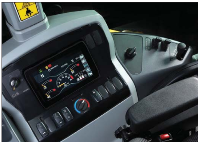
Po raz pierwszy koparko-ładowarki Cat opcjonalnie doposażyć można w dotykowy ekran LCD, który pozwala bardzo szybko zmieniać parametry funkcji roboczych
