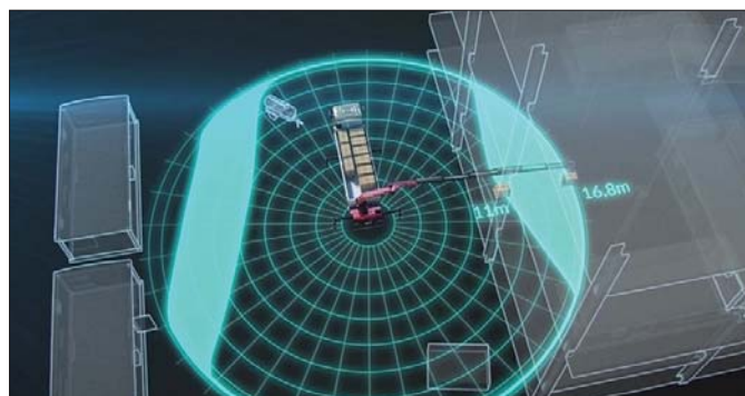
Systemy HPSC oraz LOAD doskonale się uzupełniają umożliwiając żurawowi osiągnięcie optymalnych osiągnięć przy zachowaniu pełnej stabilności
