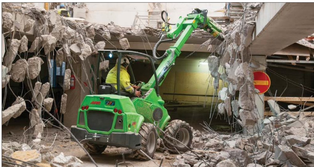
Cechą wspólną i zarazem jedną z najważniejszych zalet maszyn Avant Serii 600 jest bezstopniowo regulowany teleskopowy wysięgnik, który pozwala na niezwykle sprawne, i szybkie i efektywne przemieszczanie ładunków
