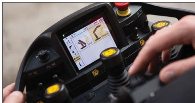
Warunkiem stosowania modułu jest korzystanie przez użytkownika ze zdalnego sterowania Paltronic 150 lub PALcom P7. Aktualny stan systemu widoczny jest na wyświetlaczu pilota
