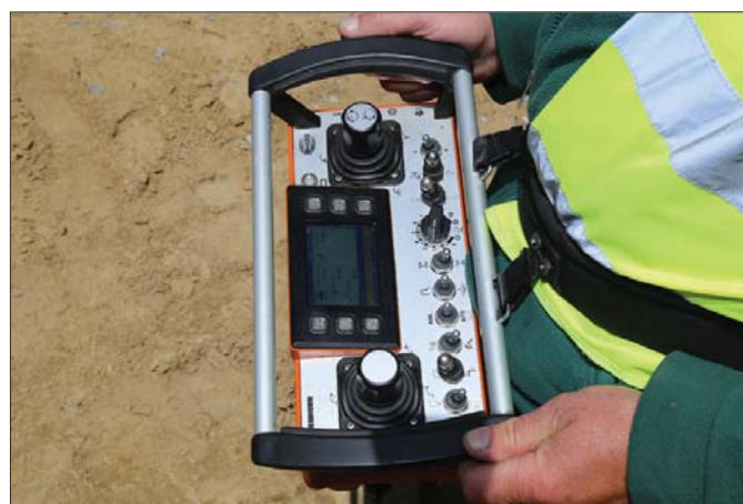
Zdalne sterowanie podnosi bezpieczeństwo użytkownika. Operator korzysta ze specjalnego panelu, który pozwala mu sterować wszystkimi funkcjami urządzenia
