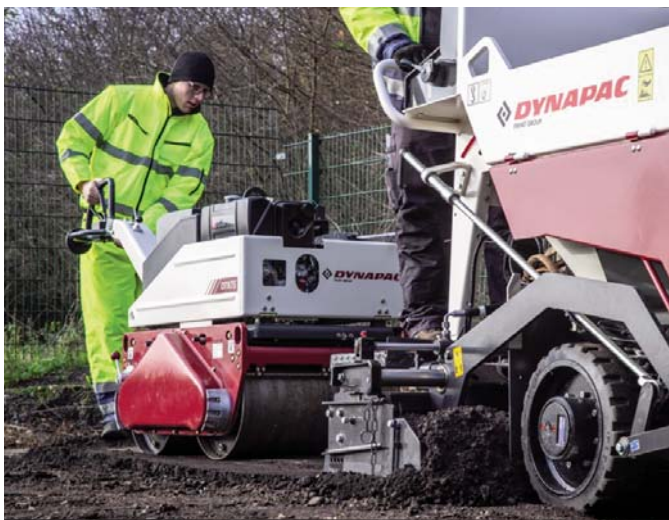
Dwubębnowy walec Dynapac z bezstopniową regulacją prędkości nadaje się idealnie do wykańczania powierzchni gruntu lub asfaltu
