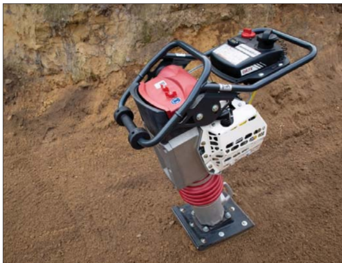
Ubijaki Dynapac wyposażone zostały w licznik motogodzin i tachometr, które pozwalają zaplanować przeglądy i zoptymalizować wykorzystanie urządzeń
