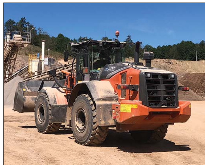
Dzięki zastosowaniu wentylatora ze zmiennym kierunkiem obrotów chłodnica maszyny jest wydajna i łatwa w utrzymaniu nawet w trudnych warunkach panujących w kopalni
