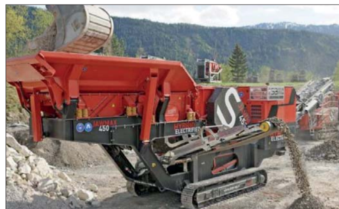
Okładziny szczęk kruszarki zostały wykonane z wysoko stopowego odlewu manganu i mogą być obracane o 180°, co podwaja ich żywotność
