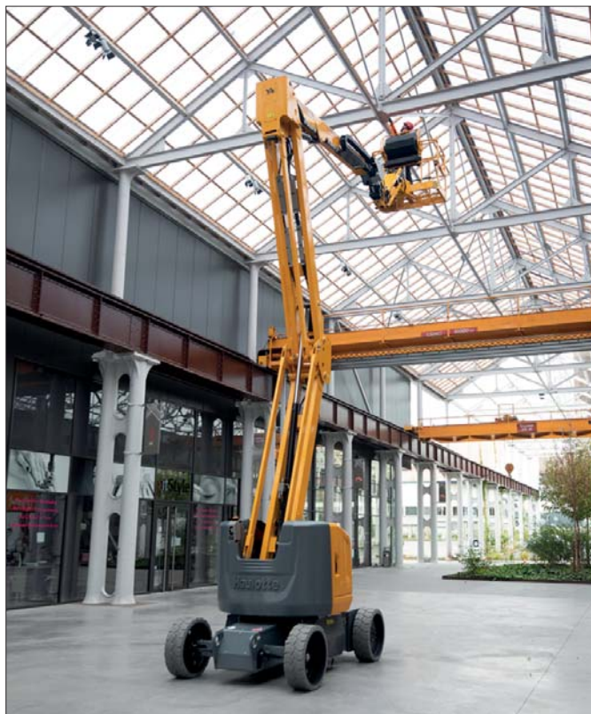
SIGMA 16 to podest ruchomy o napędzie elektrycznym nadający się idealnie do efektywnego wykonywania prac na wysokości sięgającej szesnastu metrów
