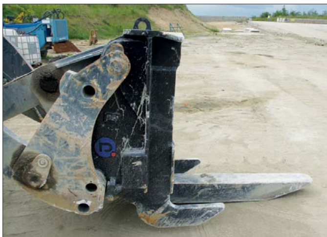
Do produkcji zrywaka Dekpol Steel wykorzystuje najwyższej jakości materiały. Przede wszystkim jest to stal o podwyższonej wytrzymałości
