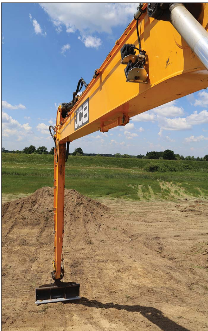
Operator koparki wyposażonej w wysięgnik Long Reach prostując całkowicie ramię może precyzyjnie operować osprzętem nawet szesnaście metrów od maszyny
