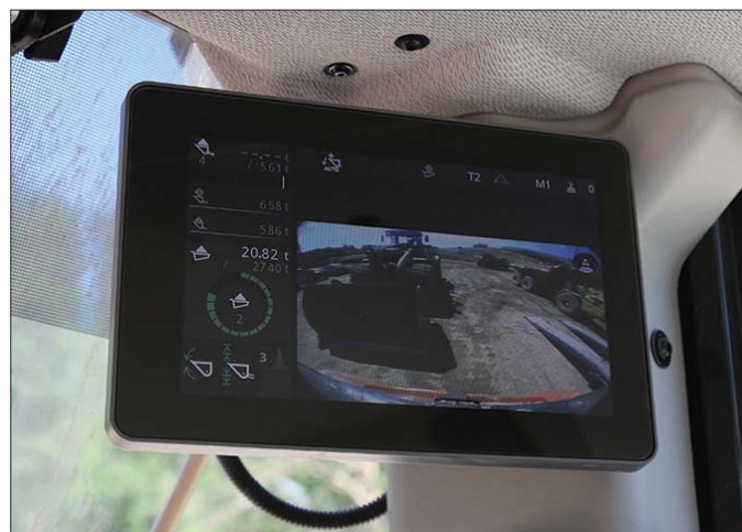
Na wielofunkcyjnym monitorze LCD pojawia się nie tylko obraz z kamer dookólnych, ale także dane o parametrach pracy i stanie technicznym maszyny
