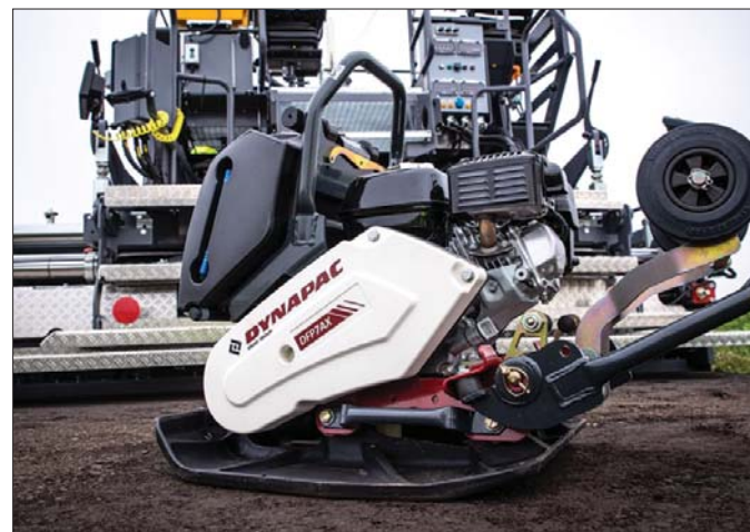
Zagęszczarki Dynapac DFP wyróżniają się solidną konstrukcją oraz super wygodnymi uchwytami tłumiącymi szkodliwe dla zdrowia operatora wibracje
