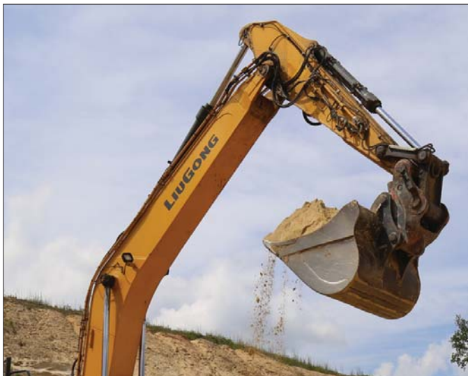
Odlewy i okucia wzmacniające wysięgnik i ramię w miejscach narażonych na największe obciążenia pozwalają na pełne wykorzystanie możliwości koparki podczas ciężkich prac
