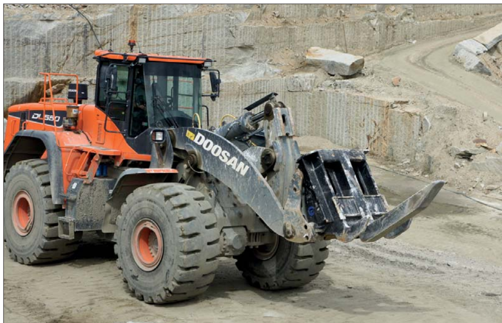
Operator ładowarki wykorzystuje specjalny zrywak, który znacznie ułatwia odspajanie granitowych bloków ze ściany na wyrobisku, pozwala je kruszyć, a następnie transportować odłamy w celu dalszej obróbki
