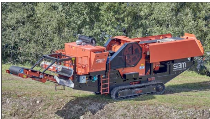
Operator jest wspierany przez konfigurator i sterowanie Crush Control. Dodatkowo SBM oferuje różne tryby robocze na przykład w pełni automatyczną pracę maszyny
