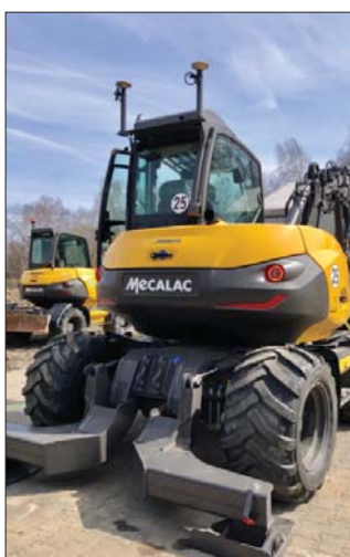
Podwójny odbiornik GNSS zapewnia dokładność pozycjonowania
