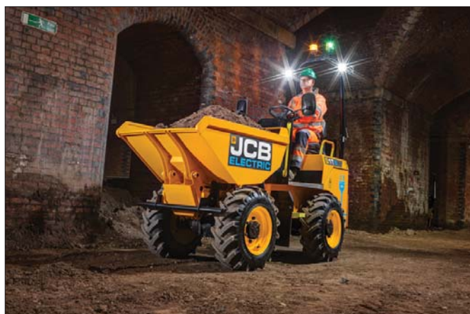
Pojazd wyposażony jest standardowo w mocne reflektory robocze LED, które zapewniają optymalną widoczność przy słabym oświetleniu
