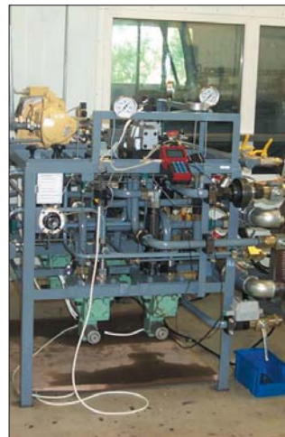
Stanowisko do weryfikacji pomp i silników z zakresu NG 16-250 ccm/obr
