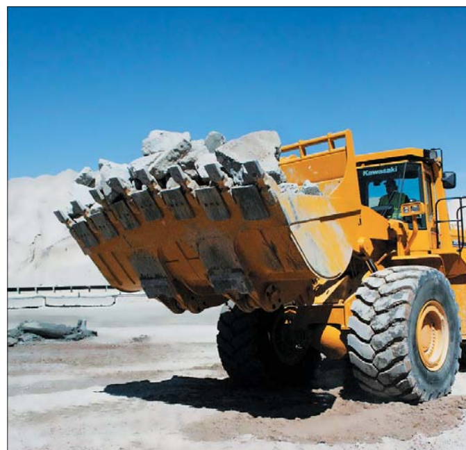
W ładowarkach Kawasaki zastosowano kinematykę wysięgnika typu „Z”, który gwarantuje ponadprzeciętną wydajność maszyn
