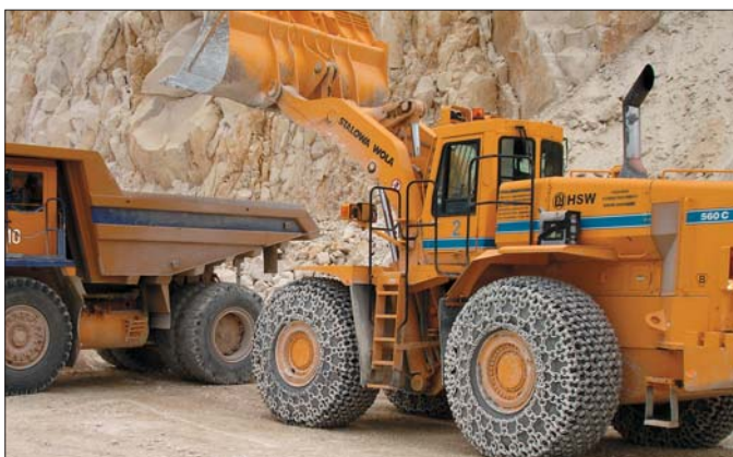
Łańcuchy PEWAG Square Duplex Plus 18, wapień, HSW 560C, 29,5x29
