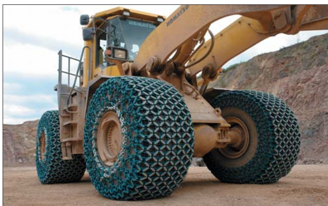
Łańcuchy PEWAG Square Granite 16, dolomit, KOMATSU WA 500, 29,5x25
