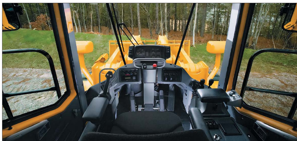
Zaletą ładowarek Kawasaki jest ich nowoczesna kabina operatora z doskonałą widocznością we wszystkich kierunkach
