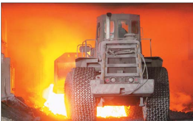
Łańcuchy PEWAG Square Multistep 16/18, gorący żużel, HSW 560B, 29,5x29
