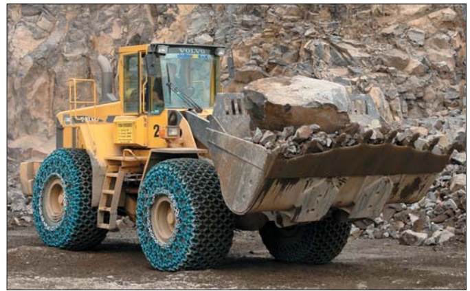
Łańcuchy PEWAG Square Granite 16, bazalt, VOLVO L 180, 26,5x25
