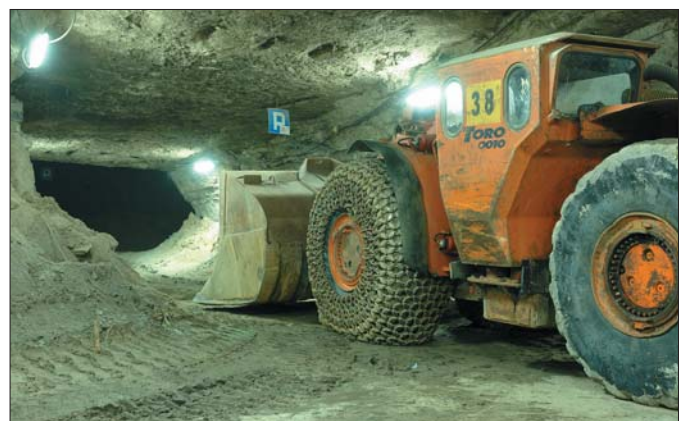
Łańcuchy PEWAG Square Multistep 16/18, piaskowiec, TORO 0010, 29,5x25
