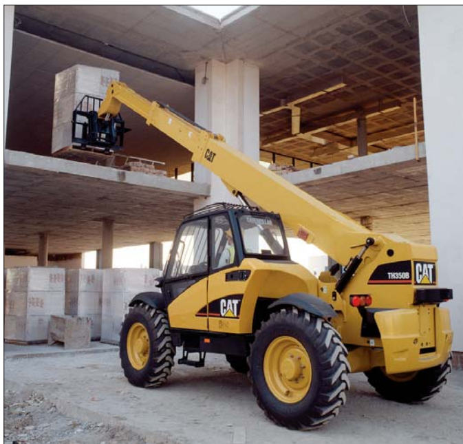
Widły do palet stanowią standardowe wyposażenie ładowarek teleskopowych serii B
