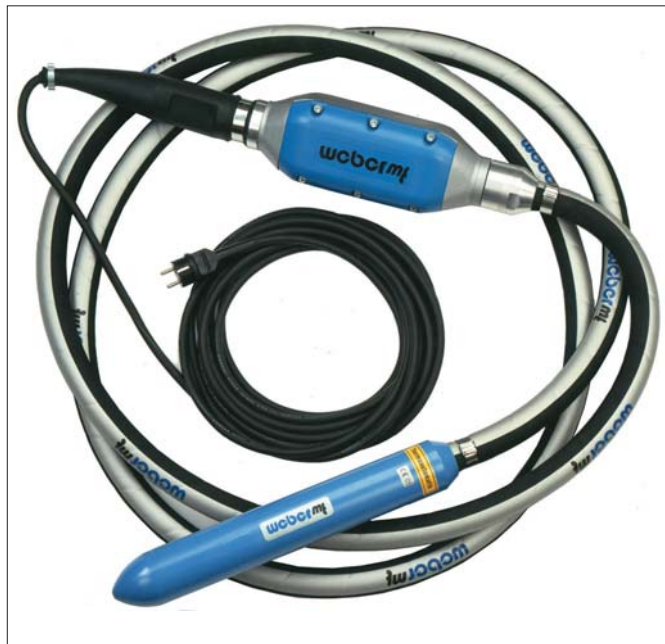
Urządzenia Weber MT składają się z dwóch kompatybilnych podzespołów – buławy wibracyjnej IVU o średnicy 40, 50 lub 58 mm i przetwornicy UR 1,6, które łączone są poprzez wtyczkę i gwintowane złącze
