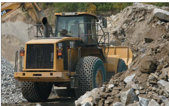
Łańcuchy PEWAG Square Multistep 16, granit, CAT 980G, 29,5x25
