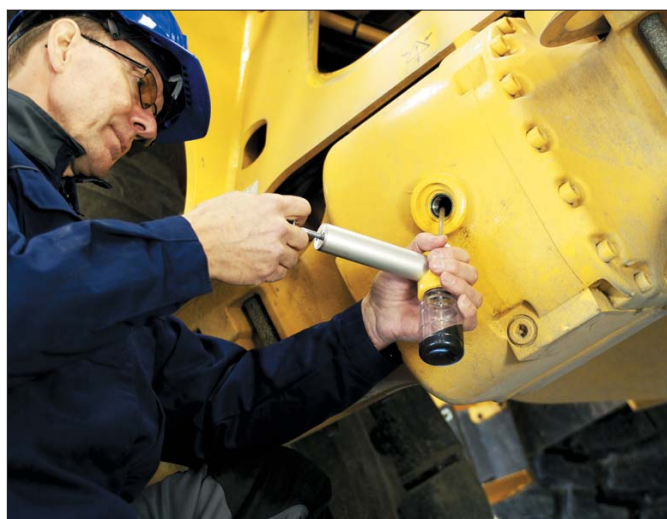
Program analiz oleju Volvo pozwala na sprawdzenie stanu istotnych zespołów maszyny poprzez szczegółową analizę stanu oleju w silniku, skrzyni przekładniowej, układzie hydraulicznym, mostach i hamulcach jak również, na życzenie, płynu chłodzącego i paliwa
