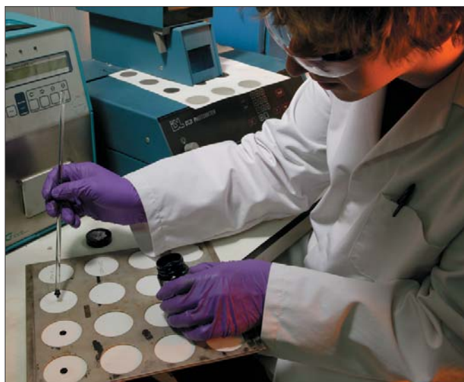
Doświadczeni i wykwalifikowani fachowcy, wyposażeni w najwyższej jakości urządzenia diagnostyczne przeprowadzają bardzo szczegółowe analizy próbek w zakresie: zawartości wody/płynu chłodzącego, lepkości, paliwa, zanieczyszczeń, ilości cząstek metalu i wielu innych
