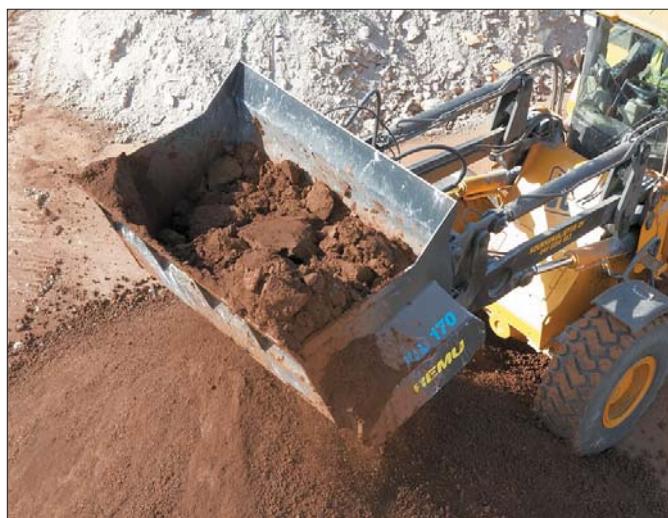
Łyżka przesiewająca REMU pozwala na efektywną utylizację różnego rodzaju materiałów
