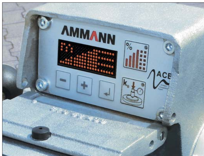
Obsługa systemu ACE okazuje się być niezwykle prosta. Operator maszyny może śledzić parametry jej pracy na czytelnym ekranie...
