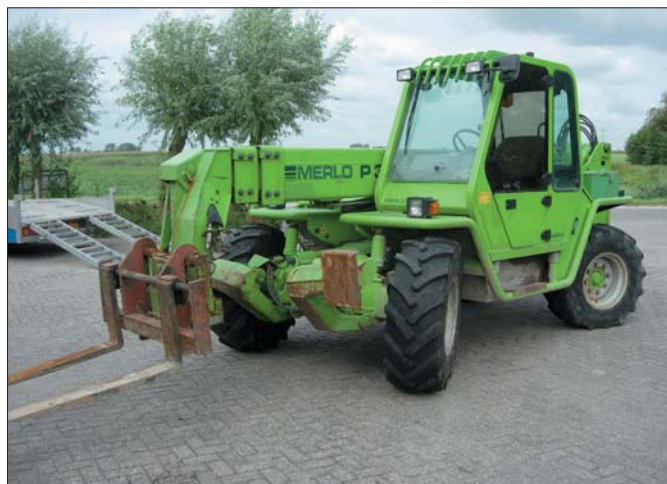
Widły do palet są najczęściej spotykanym rodzajem osprzętu. Nic dziwnego, skoro teleskopy wykorzystywane są z reguły do prac przeładunkowych i transportu na niewielkie odległości...
