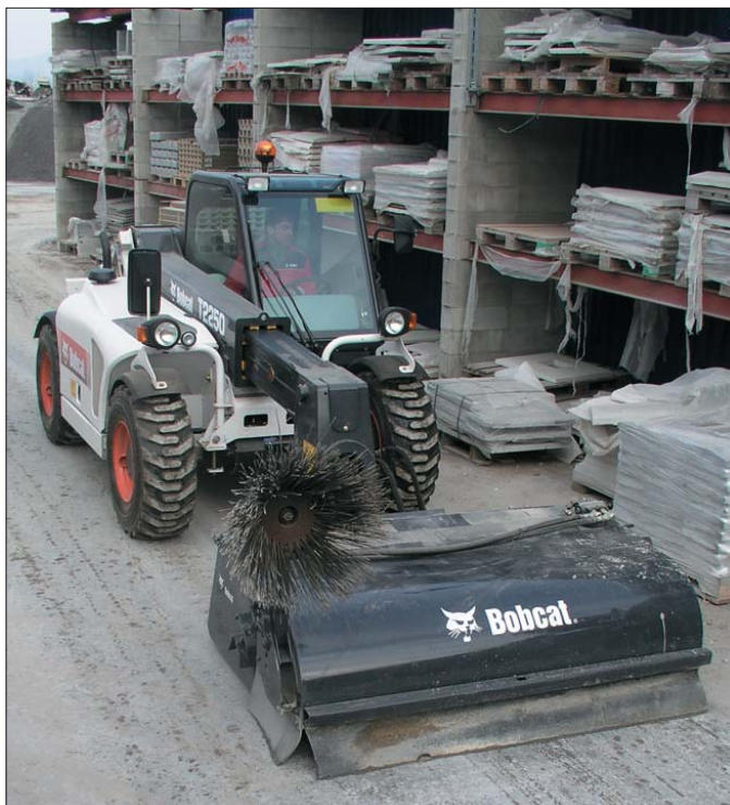
Dzięki możliwości wyposażenia maszyny w jeden z dwóch systemów szybkiego mocowania osprzętu – konwencjonalny wózek lub znany z kompaktowych ładowarek marki Bobcat system BobTach, nośnik T2250 określić można śmiało mianem urządzenia wielozadaniowego
