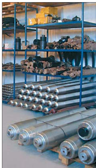
Firma Hercu Pneumatic jest największym w Polsce dystrybutorem maszyn pneumatycznych typu „kret”. Urządzenia te zezwalają na bezzropkową instalację rur osłonowych pod drogami, szlakami kolejowymi itp.
