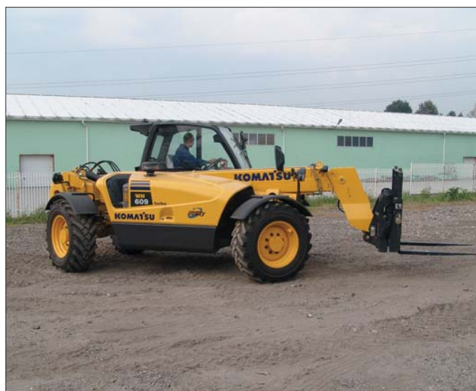
Dzięki wszystkim kołom skrętnym „teleskop” Komatsu imponują zwrotnością. Jest to niezwykle ważna cecha podczas prac wykonywanych na ograniczonej przestrzeni...
