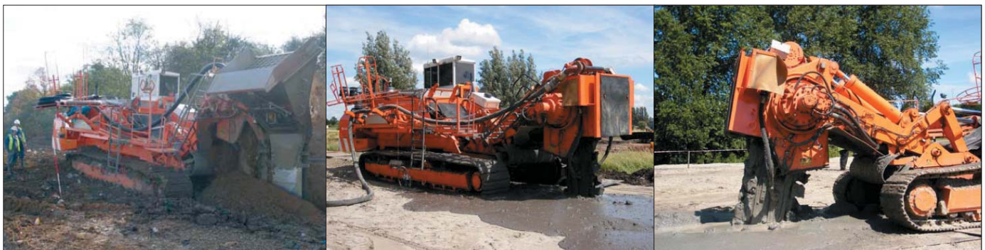
Opracowana wspólnie z firmą Bachy Soletanche technologia TRENCHMIX® umożliwia przy wykorzystaniu ciężkich maszyn Mastenbroek 50/60 lub 70/90 głębokie mieszanie gruntu, nawet do dwunastu metrów głębokości wraz z materiałami wiążącymi – takimi jak bentonit i cement a tym samym jego utwardzanie
