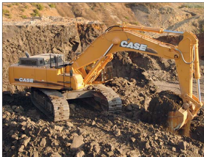
Koparka CX800B dostępna w wersji ze wzmocnionym wysięgnikiem i łyżką o dużej pojemności umożliwia kopanie w najtrudniejszych warunkach oraz przemieszczanie olbrzymich mas urobku
