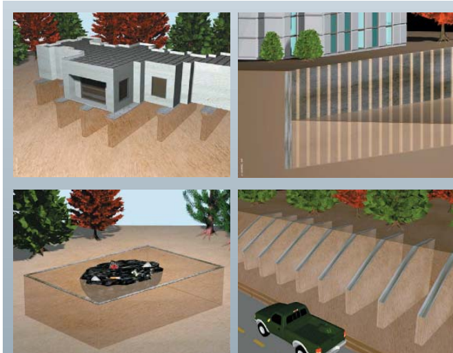
Typowymi zastosowaniami maszyn do głębokiego mieszania firmy Mastenbroek są: wzmocnienie gruntów ścisłalnych pod budownictwo przemysłowe, nasypów pod drogi i tory kolejowe, tymczasowe wzmocnienie gruntów połączone z instalacją pionowych elementów nośnych takich jak pręty stalowe, rury i pale, budowa grodzi odcinających np. grunty zanieczyszczone lub wody podziemne oraz wzmocniane pochyłości gruntów i nasypów wzdłuż dróg i torów oraz brzegów rzek.
