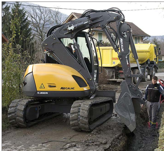
Mecalac 8MCR łączy w sobie zalety ładowarki burtowej i średniej wielkości koparki
