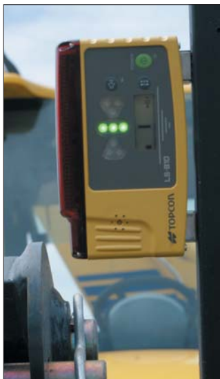
Koparko-ładowarka Komatsu WB93R „uzbrojona” we wskaźnikowy system sterowania 1D
