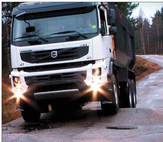
W stosunku do modelu FM zmieniono również reflektory główne. Są one teraz bardziej odporne na uszkodzenia mechaniczne, do których często dochodzi na placu budowy
