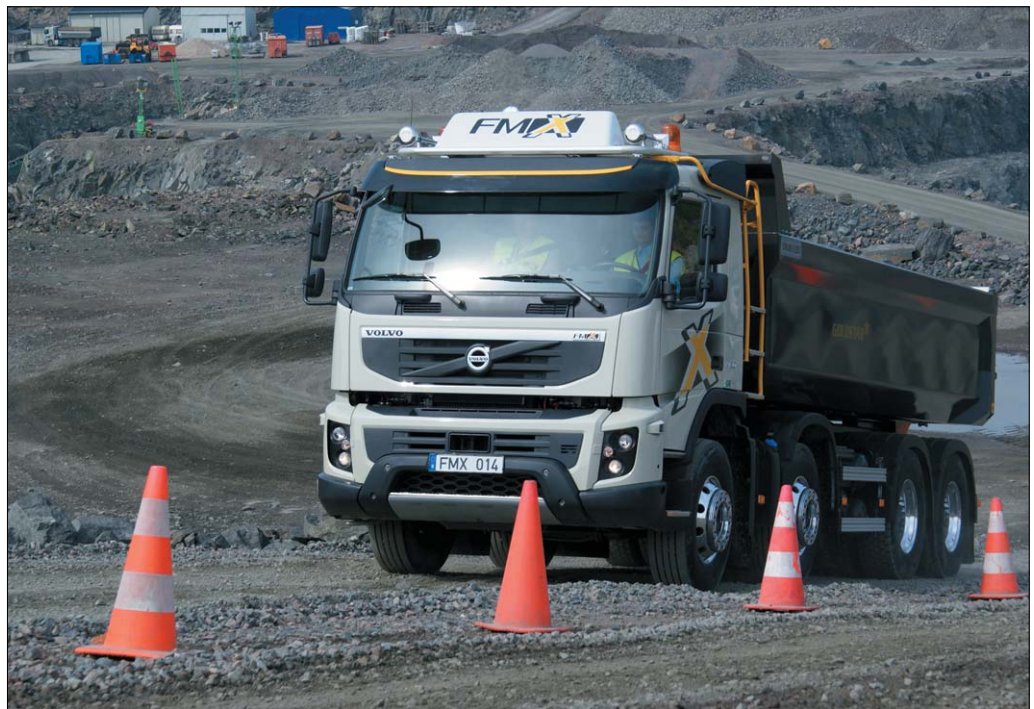
W celu optymalizacji procesu zmiany biegów i płynnego ruszania z miejsca czujnik obciążenia przesyła dane o masie pojazdu do zmodernizowanej przekładni I-Shift
