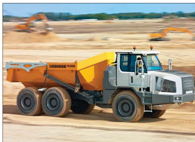
Wozidło TA 230 łączy zwarte gabaryty z ładownością typową dla większych pojazdów tego typu. Jego szerokość transportowa wynosi poniżej trzech metrów
