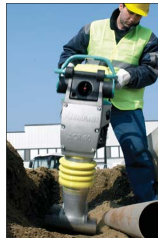
Dzięki niskiemu posadowieniu silnika nowa generacja ubijaków Ammann odznacza się doskonałą stabilnością
