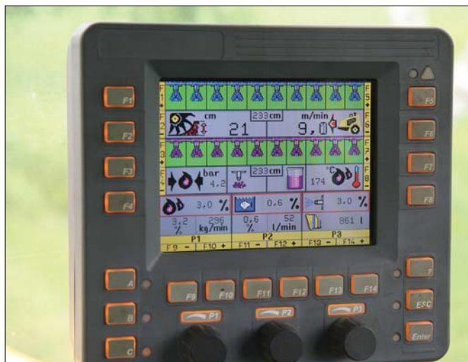
Parametry dozowania, takie jak gęstość granulatu, wymagany procentowy udział bitumu oraz wady operator śledzić może na wyświetlaczu terminala BOP (BOMAG Operation Panel)
