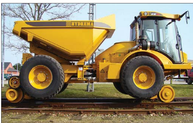
Hydrema może doposażyć wozidło 912D w koła kolejowe, co umożliwia jazdę po torach
