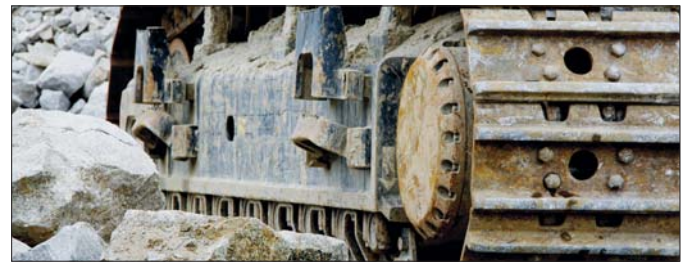
Koparka wyposażona została w wzmocnione podwozie wraz z osłonami gąsienic chroniącymi ich ogniwa i dolne rolki przed uszkodzeniami mechanicznymi
