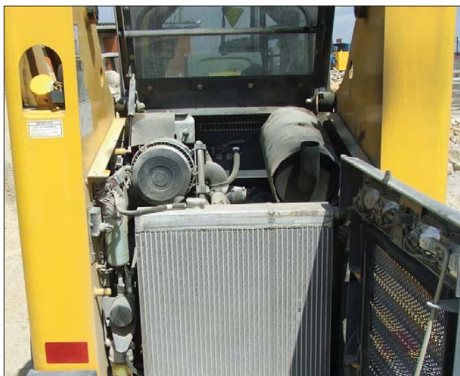
Łatwy dostęp do komory silnika i wszystkich niewralgicznych podzespołów stanowi jedną z całego szeregu niewątpliwych zalet ładowarki GEHL SL6640
