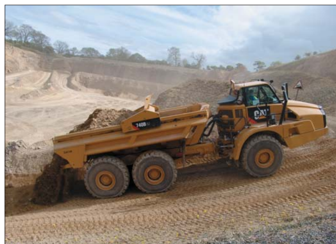
Czujniki mierzą szybkość na wszystkich sześciu kołach. Operator nie musi zastanawiać się, jak dobrać moc do pokonania wzniesienia w pełni załadowanym wozidłem
