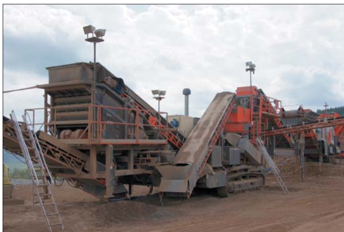
W pierwszej fazie eksploatacji pokładów melafiru kamieniołom w Tłumaczowie wyposażono w mobilny zakład krusząco-przesiewający składający się z kruszarki i przesiewaczy dostarczonych przez firmę Sandvik
