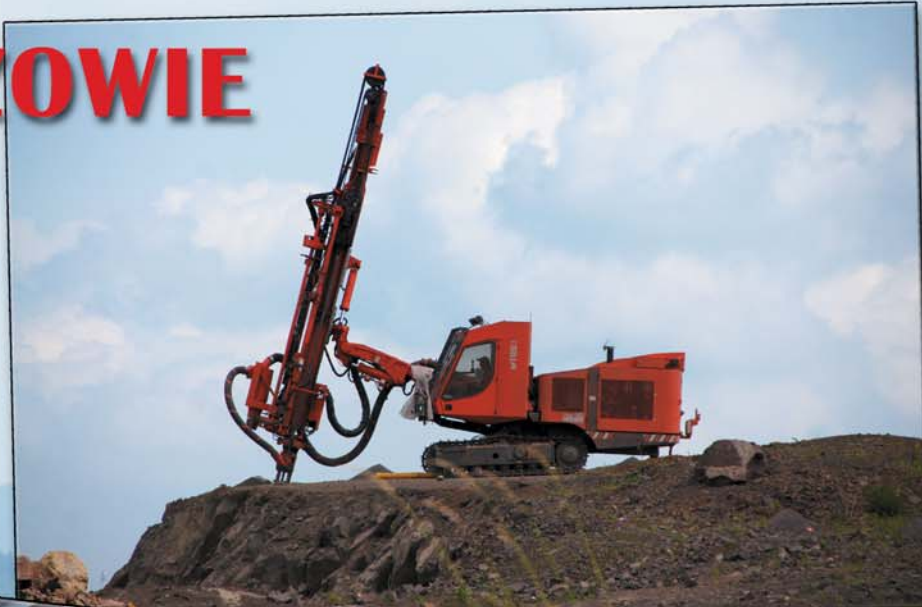
▲ Przy wierceniu otworów strzałowych doskonale sprawdza się samobieżna, gąsienicowa wiertnica Sandvik DP1100
