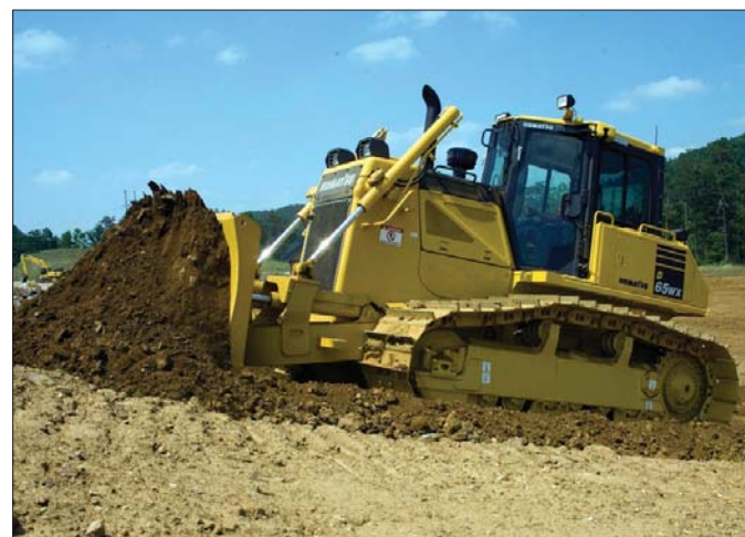
Opcjonalnie, w zależności od warunków eksploatacyjnych spycharkę wyposażać można w podwozie typu WX. Stosowane w nim są gąsienice o większej szerokości
