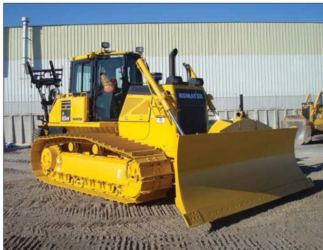
Podwozie PX idealnie sprawdza się w czasie pracy na miękkim podłożu. Nakładki ogniwo gąsienic zapewniają dużą powierzchnię styku z nawierzchnią
