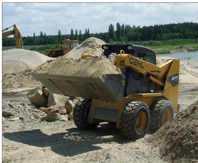
Do podstawowych zadań ładowarki GEHL SL6640 użytkowanej przez Zakład Betoniarski Pasoń należy załadunek mieszalnika betonu piaskiem i żwirem
