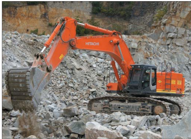
Podsiębierna koparka gąsienicowa Hitachi 670 pełni kluczową rolę w procesie wydobycia kopalni Rogoźnica II
