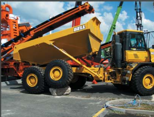
Wozidło Bell B30 po generalnym remoncie
