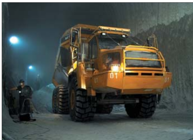
Modyfikacje konstrukcji i całkowicie nowatorskie rozwiązania pozwalają zwiększyć zakres zastosowań wozideł przegubowych. Pracują one nawet pod ziemią...
