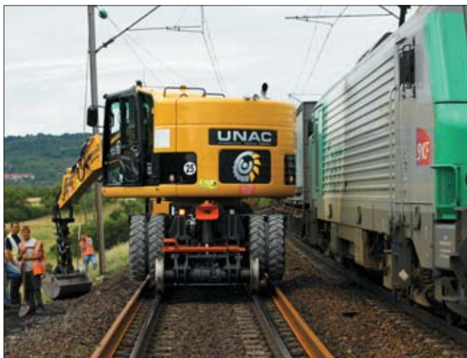
Koparkę dwudrogową UNAC 22TRR wyposażono w liczne systemy bezpieczeństwa, m.in. blokadę obrotu wieżyczki oraz ograniczniki wysięgu
