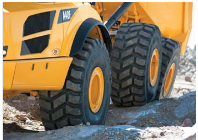
Dzięki zastosowaniu wahliwego przegubu dzielone podwozie doskonale dopasowuje się do nierówności terenu sprawiając, że żadne z kół nie traci kontaktu z podłożem
