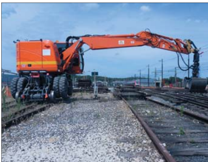
Niezależny napęd hydrostatyczny obu osi szynowych eliminuje zużycie ogumienia i gwarantuje wysoką przyczepność
