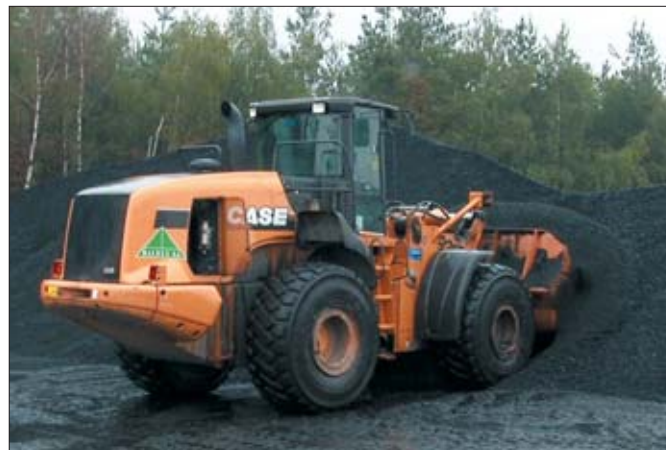
Ładowarka kołowa Case 921E eksploatowana jest niezwykle intensywnie. Służy nie tylko do typowych prac przeładunkowych, ale także do całego szeregu czynności pomocniczych
