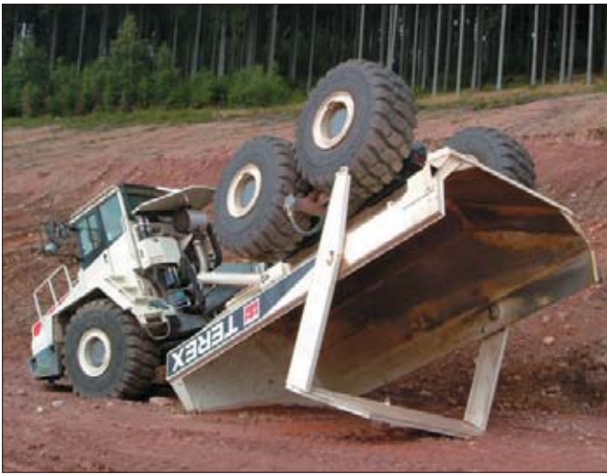
Operator wozidła pozostaje bezpieczny nawet w ekstremalnych sytuacjach. Nawet w przypadku przewrócenia skrzyni ładunkowej kabina stoi na kołach
