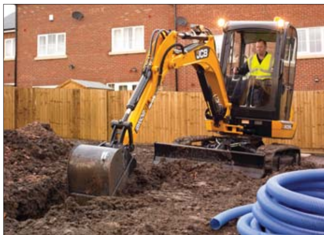
Jedną z nowości JCB - minikoparka 8026 CTS wyposażoną w specjalnej konstrukcji wysięgnik i ramię łyżki, co sprawia, że odznacza się lepszymi parametrami kopania
