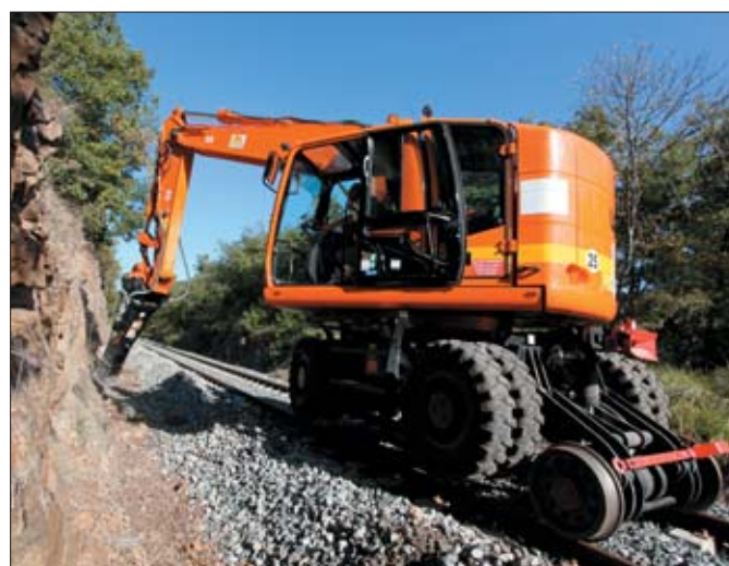
UNAC 22TRR może współpracować ze wszystkim narzędziami stosowanymi w klasycznych koparkach
