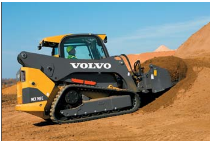
W maszynach Serii C zastosowano unikatową konstrukcję opartą na pojedynczym ramieniu
