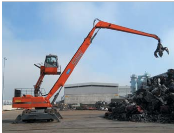
Podwozie z dodatkowymi przeciwwagami, wieniec obrotu o zwiększonej średnicy oraz akumulatory hydrauliczne na siłownikach to cechy wszystkich modeli SOLMEC
