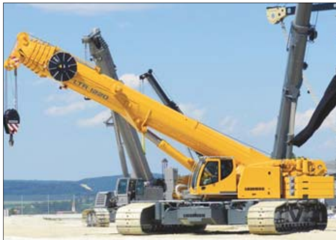
Głównymi zaletami żurawia teleskopowego LTR1220 są krótki czas przygotowania do pracy, ułatwiony transport i różnicowane systemy wysięgników
