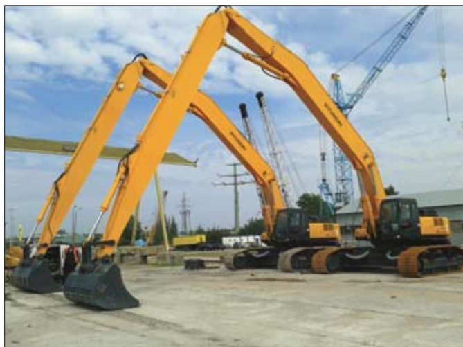
Dwie sześćdziesięcotonowe koparki gąsienicowe będą pracować na pontonach. Ich zadaniem będzie rozładunek granitowego kruszywa z barek i przemieszczenie go na dno zbiornika wodnego celem jego umocnienia
