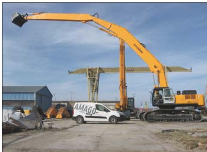
Każdy element maszyny został dokładnie zaplanowany i sprawdzony. Ramiona i wysięgnik wykonano z bardzo wytrzymałej stali. Całość została dodatkowo uszczelniona, co pozwala na pracę na głębokości piętnastu metrów pod lustrem wody
