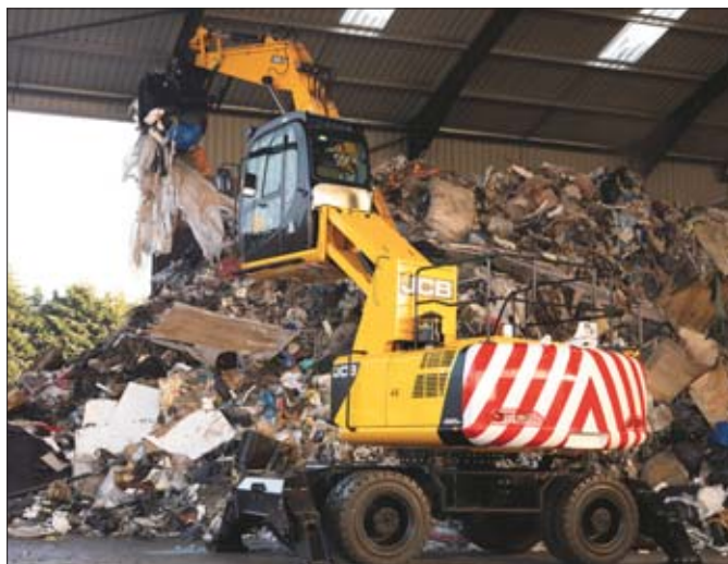
JS20MH to pierwsza koparka przeładunkowa JCB zaprojektowana specjalnie do pracy na wysypiskach. Zastosowano w niej podwozie o całkiem nowej konstrukcji
