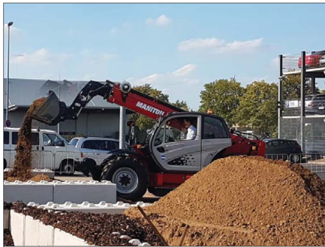
Prototypowa ładowarka teleskopowa o zmodyfikowanym napędzie poddana została szeregowi testów w rzeczywistych warunkach panujących na placu budowy
