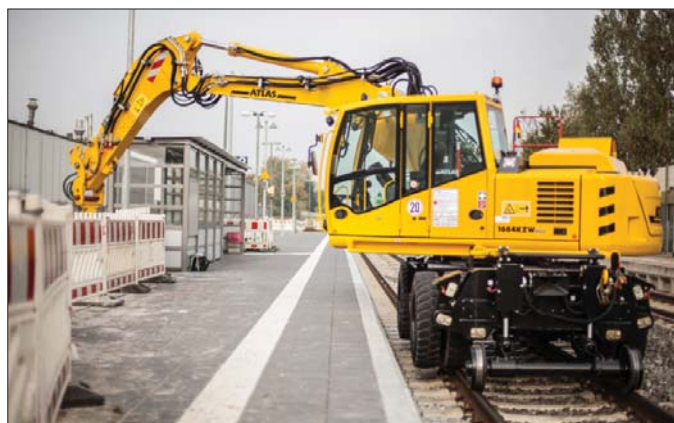
System docisku Carsy stabilizuje maszynę w trybie ciągłym, dzięki czemu koparka jadąc po torze może przenosić ładunek z jednej strony na drugą
