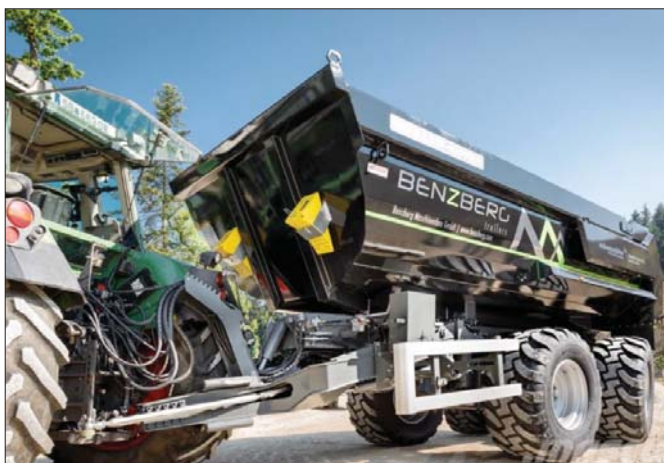
Ciężka mulda do skal i kamieni została wykonana w całości z bardzo wytrzymałej stali Hardox, co sprawia, że poradzi sobie z najtrudniejszym nawet ładunkiem
