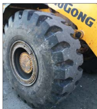
Opony do maszyn i pojazdów kopalnianych muszą mieć solidny bieżnik i dużą powierzchnię nośną
