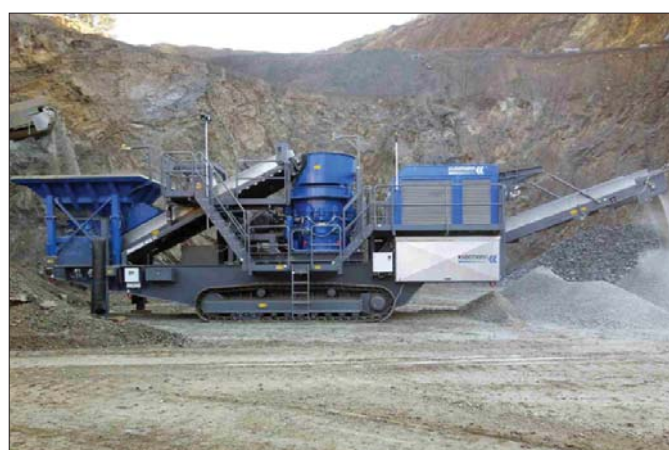
Przeznaczona do kruszenia wtórnego mobilna kruszarka stożkowa Mobicone MCO 11 sprawdza się doskonale nawet w najtrudniejszych warunkach roboczych
