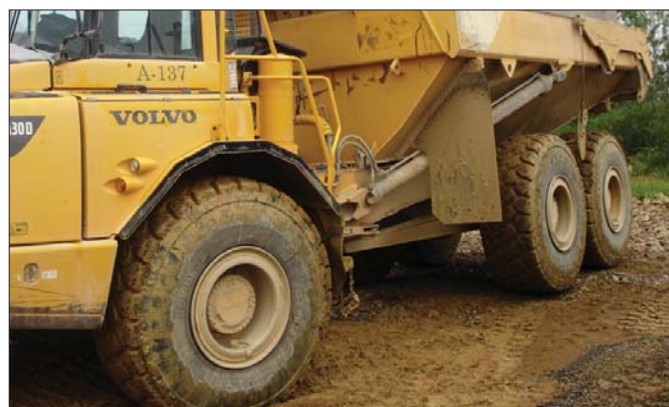
Stosowana w wozidłach przegubowych opona radialna Camso ADT 753R ma karkas przystosowany do pracy przy dużych obciążeniach
