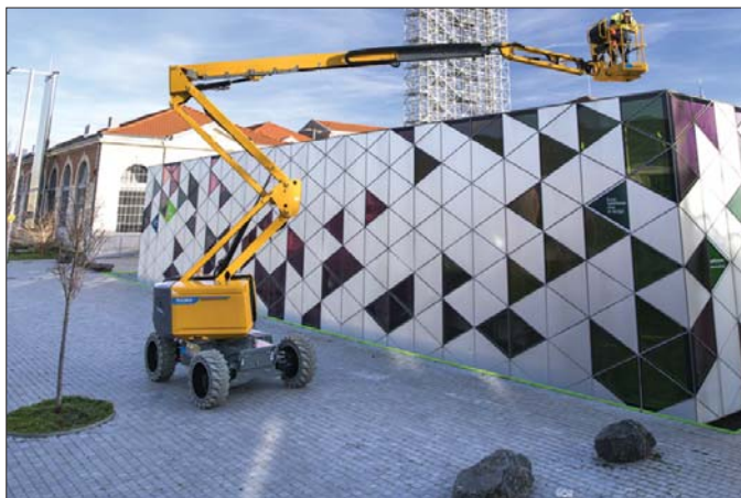
Cztery niezależne koła napędowe o wysokim momencie obrotowym wraz z osią wahlową pozwalają zachować ich stały kontakt z podłożem zapewniając optymalne bezpieczeństwo pracy
