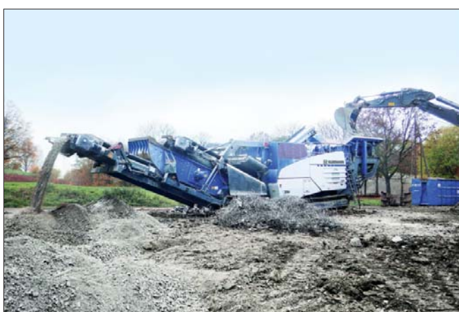
Kruszarka udarowa Kleemann MR110Z EVO z podwieszonym przesiewaczem doskonale sprawdzi się zarówno w kamieniołomie jak i na placu recyklingowym
