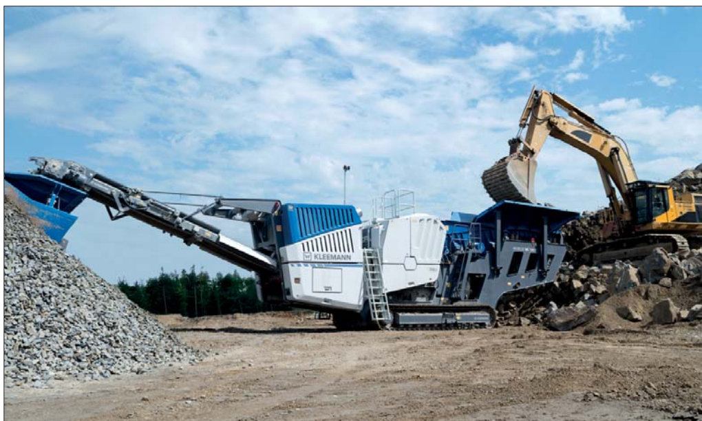
Mobicat MC 120 Z PRO ma imponującą wydajność nawet do 650 ton na godzinę i działa praktycznie w sposób bezobsługowy. Pomimo okazałych gabarytów oraz masy wynoszącej 72 tony jest łatwy w transporcie
