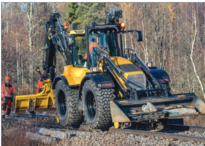
W razie potrzeby użytkownik zamontować może przednie i tylne wózki kolejowe i przeobrazić Huddiga we w pełni funkcjonalną maszynę dwudrogową typu Rail
