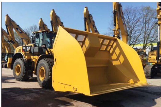
Fabryka Reschke jest w stanie zrealizować najbardziej nietypowe zamówienia, choćby takie jak gigantyczna łyżka wysokiego wysypu do ładowarki Caterpillar 972
