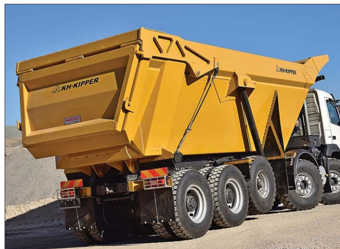
Dzięki ograniczeniu do niezbędnego minimum liczby elementów konstrukcyjnych udało się uzyskać efekt sprężystości istotnie zwiększający trwałość skrzyni
