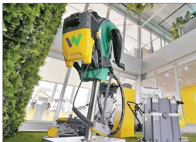
Innowacyjność nowego wibratora wynika nie tylko z akumulatorowego zasilania, ale faktu, że ogniwo przez cały czas noszone jest przez operatora w specjalnym plecaku
