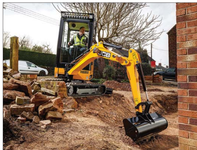
Konstruktorzy minikoparek JCB wzmocnili podstawę mechanizmu obrotu oraz wysięgnik, który zyskał teraz wydatnie na sztywności
