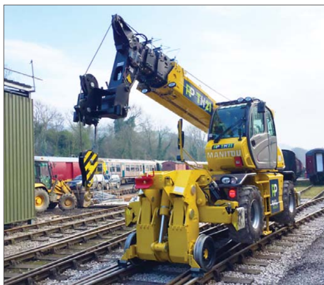
Żuraw drogowo-szynowy TH21 powstał na bazie cieszącej się powszechnym uznaniem użytkownikom ładowarki obrotowej Manitou MRT 2150
