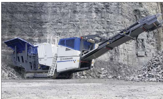
Gąsienicowa kruszarka Mobicat MC 120 Z PRO znajduje zastosowanie w kopalniach surowców skalnych przy wstępnym rozdrabnianiu kamienia
