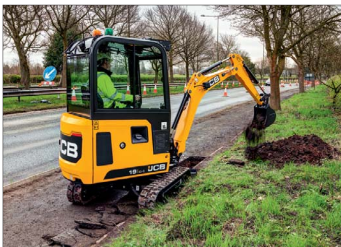
Do napędu minikoparek obecnej generacji zastosowano silnik wysokoprężny Perkins, który spełnia nie tylko aktualnie obowiązujące, ale i przyszłe normy emisji spalin
