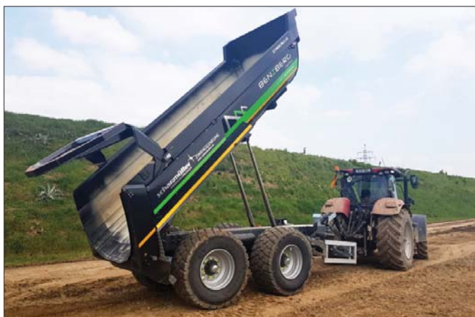
Oba siłowniki systemu podnoszenia muldy obsadzone po lewej i prawej stronie na ramie pojazdu zapewniają wyjątkową stabilność wywrotu
