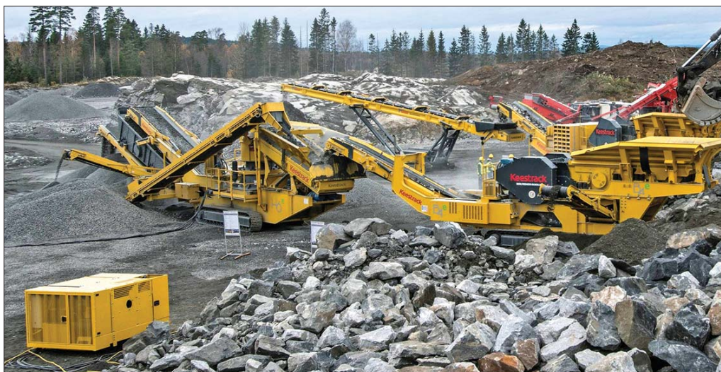
Zespół napędowy może być umieszczony z dala od pracującej kruszarki, co jest o tyle korzystne, że zmniejsza obciążenie pyłem i wibracjami oraz ułatwia dostęp do komponentów w przypadku przeprowadzenia konserwacji
