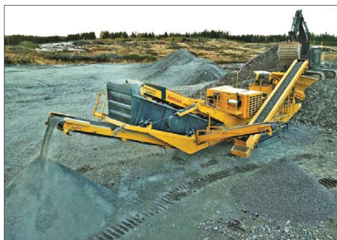
Maszyna Keestrack H6e wykorzystywana na drugim etapie kruszenia w norweskiej kopalni granitu pracując w cyklu zamkniętym osiągała wydajność do 200 t/h
