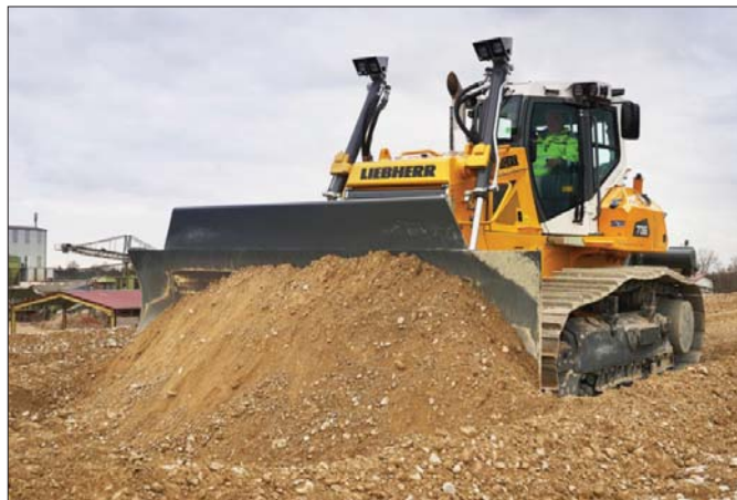
Spycharki PR 736 ósmej generacji zostały fabrycznie przystosowane do instalacji systemu sterowania pracą Trimble Earthworks
