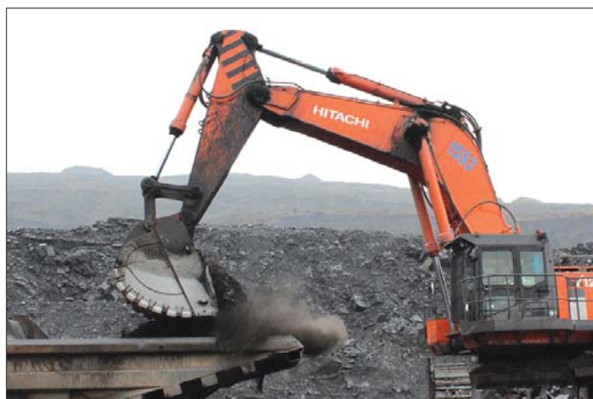
Jedna z wielu specjalistycznych łyżek Reschke sprawdza się doskonale przy urabianiu i załadunku twardego materiału w kopalni surowców skalnych
