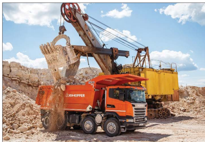
Konstruktorzy zabudowy zadbali o to, by energia kinetyczna uderzenia, nawet podczas załadunku odłamków skalnych o dużej frakcji, była doskonale rozpraszana
