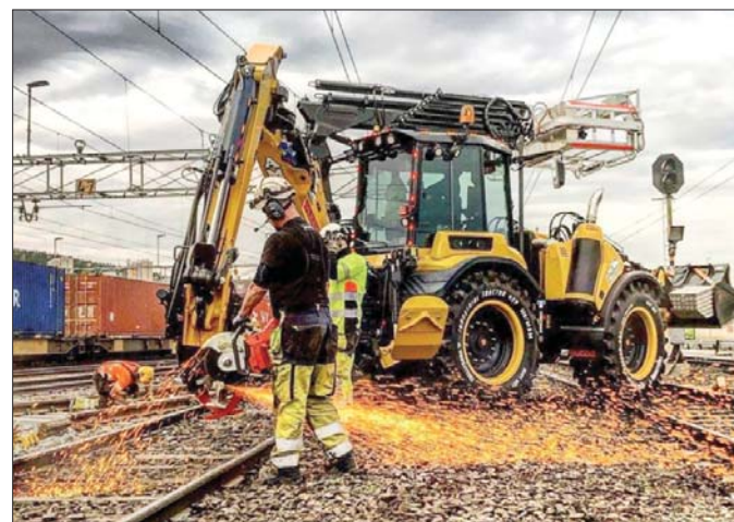
Budowa podwozia gwarantuje większą niż poprzednio stateczność, co jest istotne szczególnie podczas pracy z podnośnikiem koszowym
