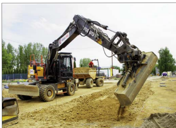
Łyżka skarpowa z obracaną głowicą pozwala operatorowi maszyny pracować nie tylko zdecydowanie szybciej, ale także bardziej precyzyjnie
