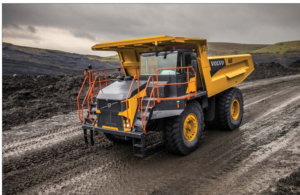
Wozidło R70D skonstruowane zostało z przeznaczeniem do ciężkich zastosowań. Pojazd wyposażono fabrycznie w kabinę ROPS ze znakomitą widocznością i swobodnym dostępem do wszystkich najważniejszych punktów obsługowych
