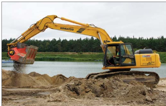
Łyżka kupiona przez firmę MC-Trans przeznaczona jest do koparek segmentu 21-35 ton oraz ładowarek kołowych o masie 10-22 ton
