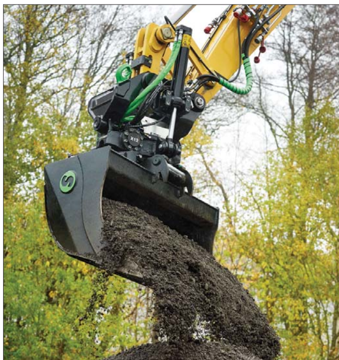
Tiltrotator Steelwrist X20, przeznaczony do stosowania na koparkach z przedziału wagowego 16-20 ton, imponuje precyzją działania i wytrzymałością
