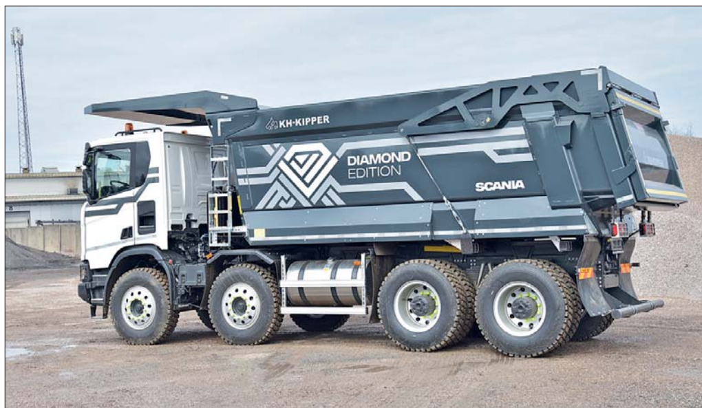
Duży daszek w wywrotkach skalnych zakrywa praktycznie całą powierzchnię górą kabiny tym samym chroniąc ją oraz kierowcę przed spadającymi w trakcie załadunku bryłami skalnymi i kamieniami
