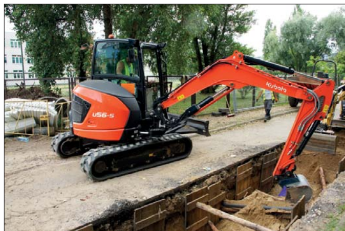
Kubota U 56-5 napędzana silnikiem o mocy 47,6 KM bez problemu może kopać na głębokość przekraczającą nawet 3,6 metra
