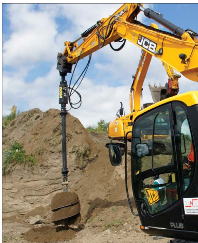
Jednym z ostatnich nabytków firmy JANSZ jest wiertnica hydrauliczna umożliwiającą wykonywanie dużej średnicy odwiertów głębokich nawet na siedem metrów
