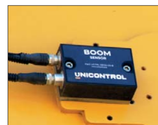
Czujniki systemu umożliwiają kontrolę całego ramienia koparkowego
