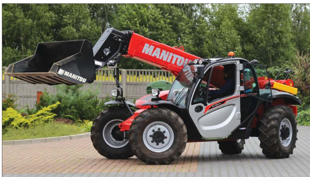
Ładowarka teleskopowa Manitou 930H łączy w sobie wiele zalet. Maszyna może dźwignąć maksymalnie trzy tony na pełną wysokość i aż czterysta pięćdziesiąt kilogramów przy całkowitym wysunięciu do przodu ramienia wysięgnika
