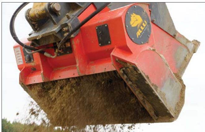
Łyżki przesiewająco-kruszące ALLU dają możliwość jednoczesnego przesiewania, kruszenia, mieszania i rozdrabniania różnego rodzaju odpadów
