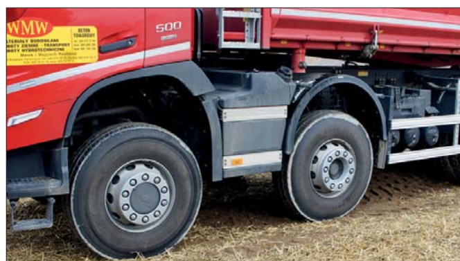
Zawieszenie, dzięki szerszemu niż ma to miejsce u innych producentów, rozstawowi przednich osi lepiej tłumi wstrząsy na nierównym terenie
