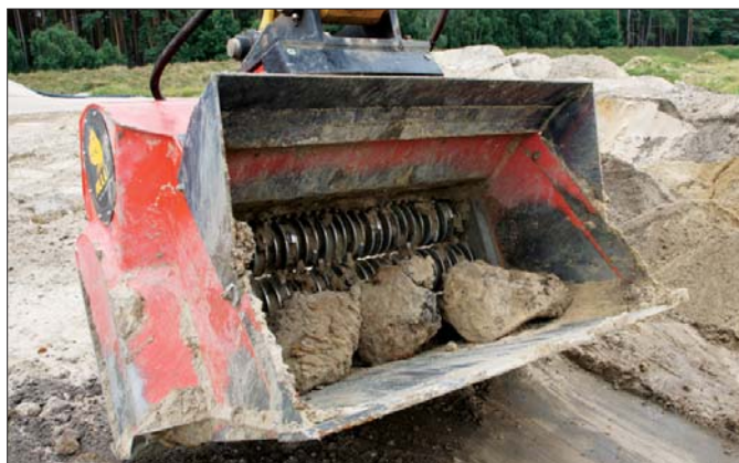
Po rozdrobnieniu nieprzydatny do tej pory do użycia zbrylony grunt staje się pełnowartościowym składnikiem podłoża terenów zielonych
