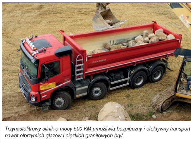
Firma WMW zakupiła Volvo FMX 500 wersji 8x4 z kabiną dzienną, które zostało zabudowane dwustronną wywrotką z hydroburtą. Podwozie bazuje na platformie FM, która doskonale sprawdziła się w trudnych zastosowaniach budowlanych
