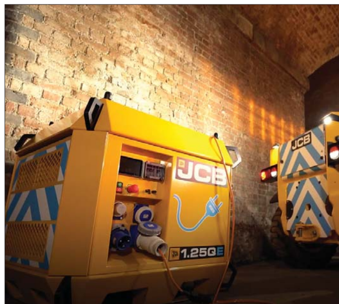
Gdy w elektrycznej ładowarce teleskopowej wyczerpie się akumulator, wystarczy podłączyć ją do magazynu energii, aby szybko powrócić do pracy
