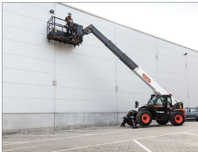
Wykorzystywane do prac konserwacyjnych i remontowych ładowarki teleskopowe mogą być wyposażone w bezpieczny kosz
