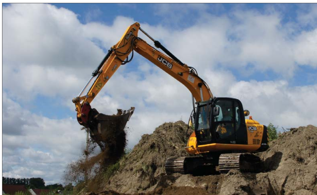
Poza standardowymi łyżkami podsiepiernymi i skarpowymi, koparkę gąsienicową JCB JS130L C w celu zwiększenia produktywności wyposażać można także w młot hydrauliczny wraz z nożycami wyburzeniowymi oraz łyżką kruszącą
