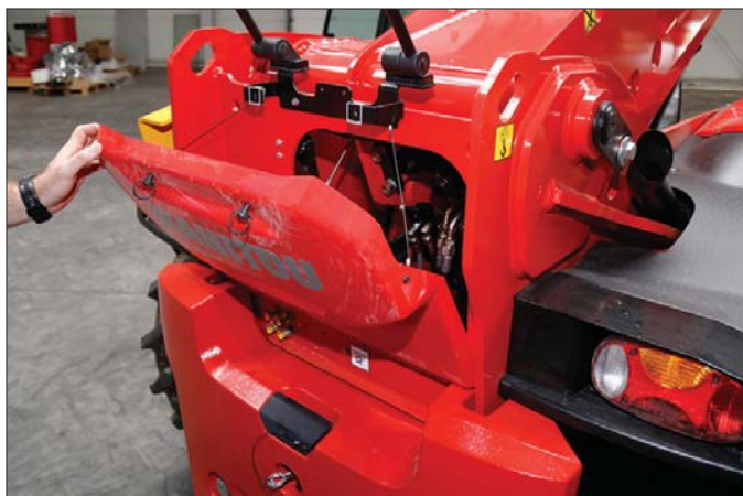
Dzięki ułatwieniu dostępu do niewralgicznych podzespołów i punktów serwisowych codzienna obsługa serwisowa ładowarki nie sprawia najmniejszych problemów
