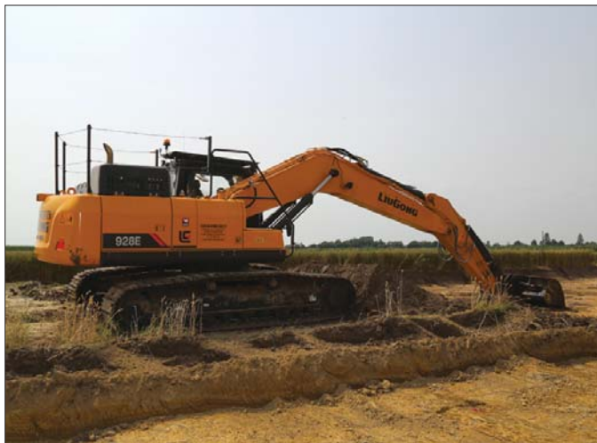
Napędzana silnikiem Cummins o mocy 129 kW koparka 928E radzi sobie nawet w najtrudniejszych warunkach roboczych
