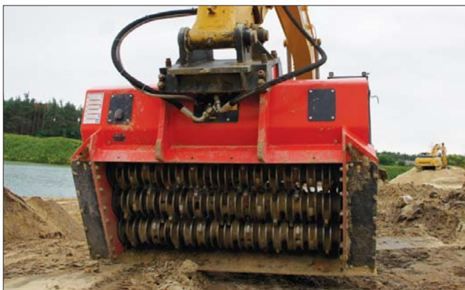
Wały rozdrabniające łyżek ALLU są łatwe w konserwacji, a rozwiązania konstrukcyjne zapewniają bezawaryjną pracę z różnorodnym materiałem
