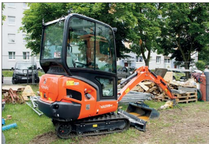
Mimo niepozornych wymiarów minikoparka KX019-4 wyróżnia się osiąganymi. Można prowadzić nią prace ziemne do głębokości przekraczającej 2,5 metra
