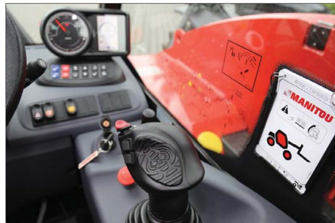
Precyzję wykonywania manewrów osprzętem zapewnia joystick o specjalnej formie. Został on tak wyprofilowany, że leży wygodnie w dłoni obsługującego maszynę
