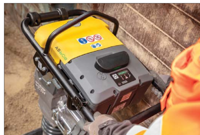
Dzięki możliwości zastosowania identycznego akumulatora do sprzętu różnych marek zarządzanie placem budowy staje się znacznie łatwiejsze
