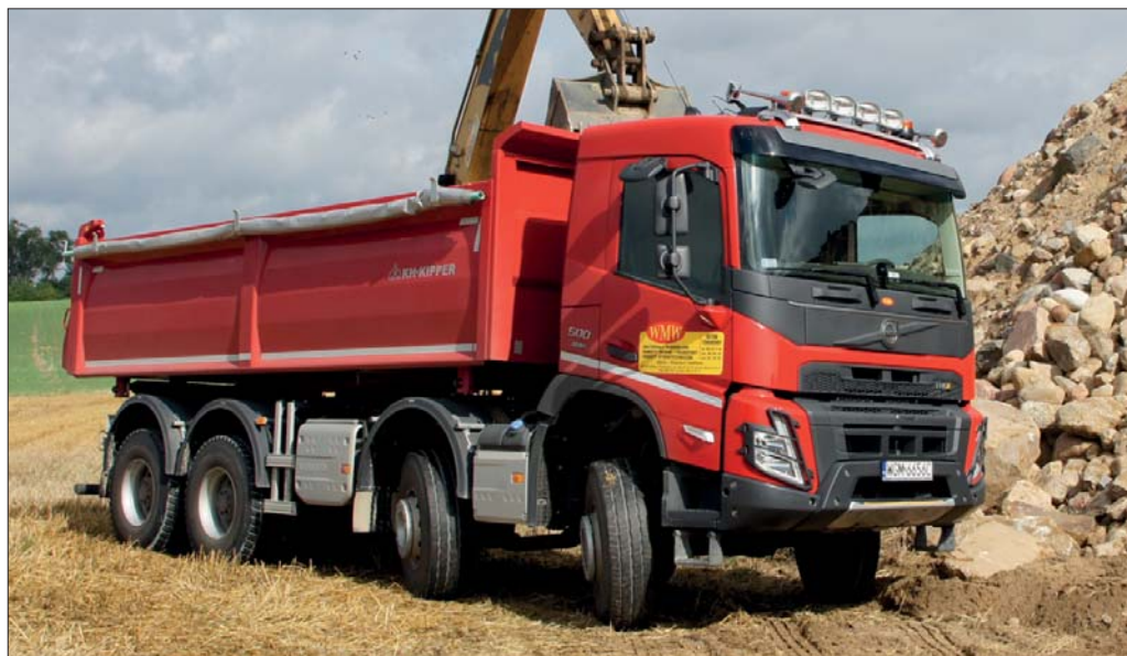
Firma WMW zakupiła Volvo FMX 500 wersji 8x4 z kabiną dzienną, które zostało zabudowane dwustronną wywrotką z hydroburtą. Podwozie bazuje na platformie FM, która doskonale sprawdziła się w trudnych zastosowaniach budowlanych
