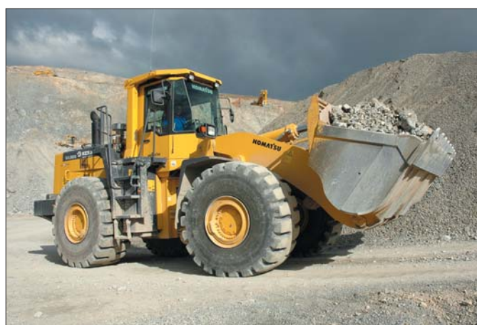
Z chwilą wyposażenia ładowarki WA500 w łyżkę KOMATSU oraz system zębów K VX skończyły się problemy z wpadającymi do kruszarek zębami
