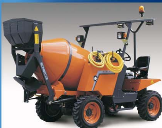
Betoniarka z samozaładunkiem i instalacją wodną
