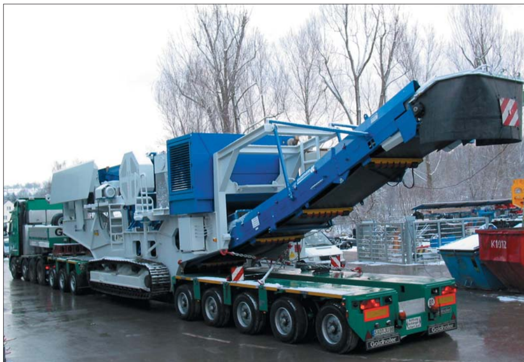
Dzięki kompaktowej konstrukcji, bardzo małej masie własnej, dużym naciskom na osie, a także wyjątkowej możliwości rozsuwania pomostu oraz głębokiej i szerokiej niecce koparkowej na wózku, naczepa STHP/XLE staje się ozdobą każdej floty pojazdów ponadgabarytowych
