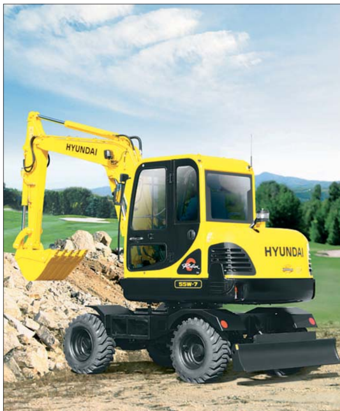
Robex R55W-7 jest napędzany najmocniejszym w swej klasie silnikiem o mocy 57 KM. Uwagę zwracają boczne osłony chroniące maskę silnika przed uszkodzeniami
