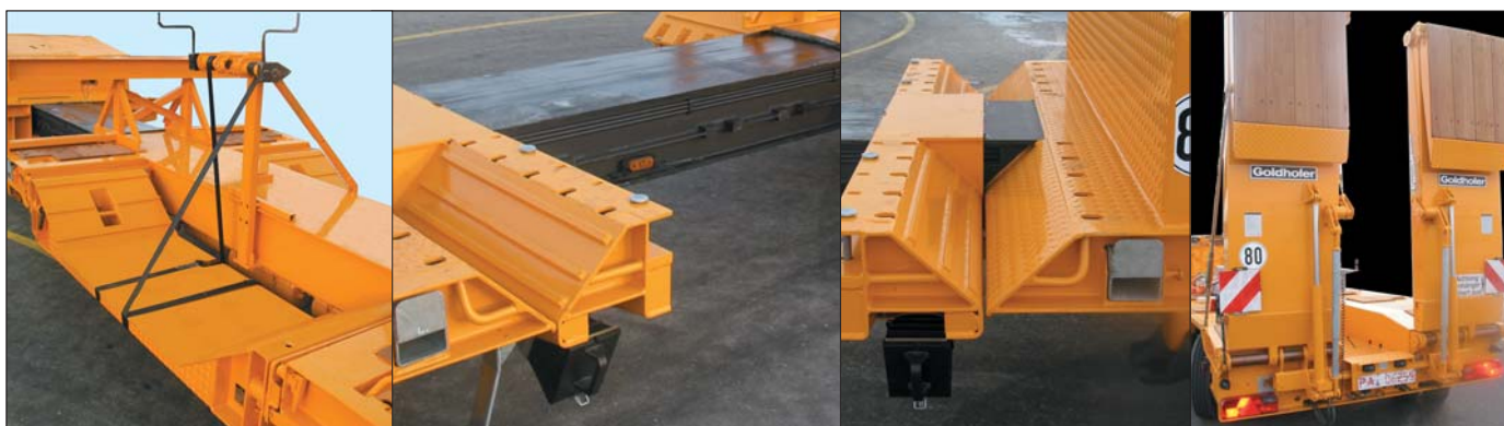
Naczepa może przewozić różne rodzaje maszyn budowlanych, a zastosowanie zagłębień na koła pozwala na powóz wysokich maszyn, Przednie koła ładowarki mogą być umieszczone w zagłębieniu powstałym po rozsunięciu pomostu, tylne w obracanej muldzie na koła
