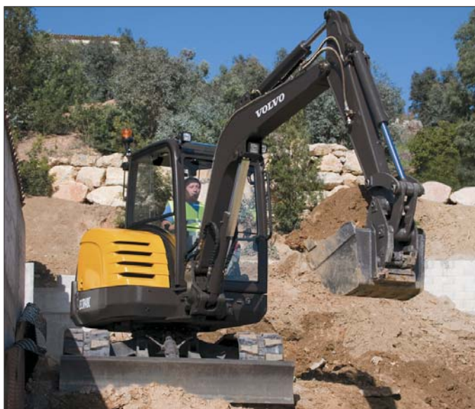
ECR 48C należy do maszyn z zerowym promieniem obrotu. Umieszczenie silnika z prawej strony kabiny znacznie uprościło dostęp do silnika i układu hydraulicznego
