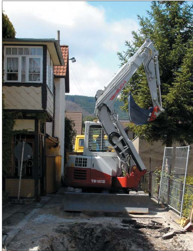
Koparka TB 180 FR potrzebuje jedynie 2,79 m do wykonania pełnego obrotu, co sprawia, że doskonale spisuje się podczas prac prowadzonych na ograniczonej przestrzeni
