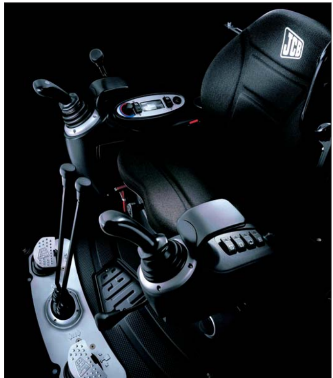
Przestronna kabina operatora jest izolowana od ramy obrotowej, co redukuje hałas i wibracje przenoszone z silnika i zasadniczo podnosi komfort pracy operatora
