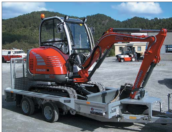
Austriacki Neuson zaczął umieszczać silnik z boku kabiny. Po jej odchyleniu jednostka napędowa jest dzięki temu łatwo dostępna
