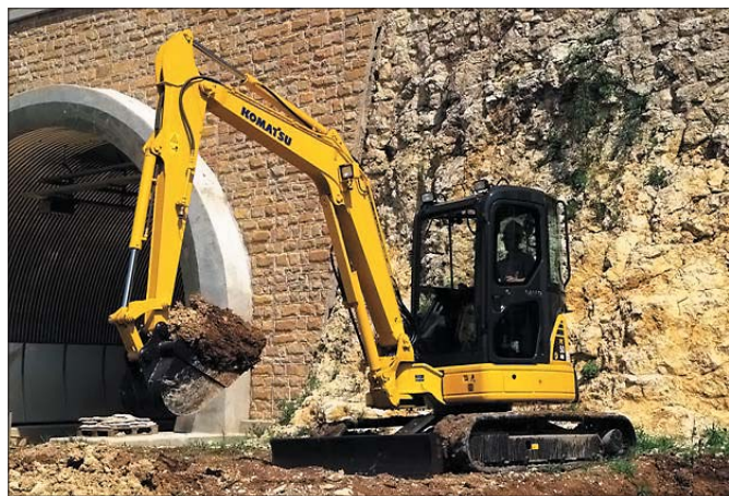
Minikoparka PC50MR-2 to największa maszyna z grupy MINI. Dzięki swym parametrom może w niedalekiej przyszłości zagrozić dominacji koparko-ladowarek na polskich placach budowy
