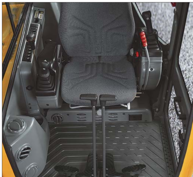
Specjaliści medycyny pracy wyliczyli, że podczas przeciętnej dniówki operator minikoparki kilka tysięcy razy manipuluje dźwigniami i przełącznikami. Dlatego właśnie ich ergonomiczne rozmieszczenie i odizolowanie od wibracji staje się sprawą priorytetową
