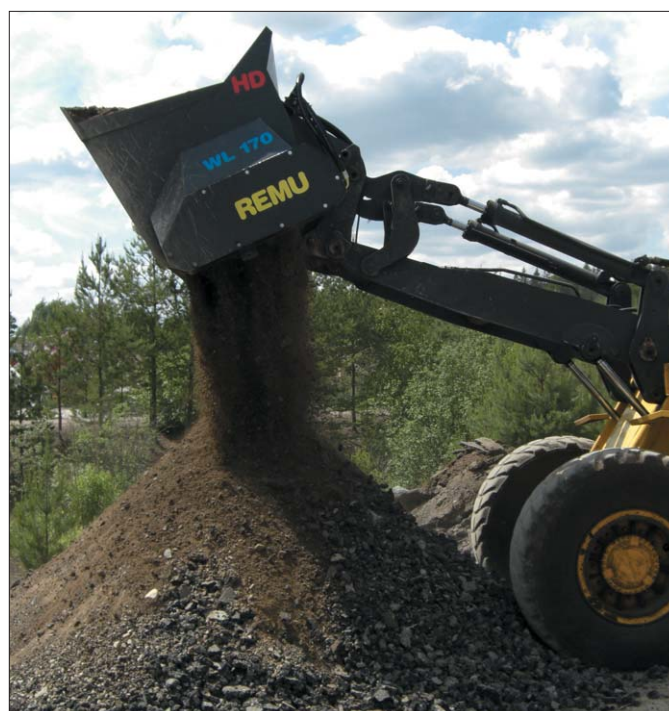
Skruszony za pomocą łyżki REMU HDMIX asfalt to doskonały materiał na podbudowę...
