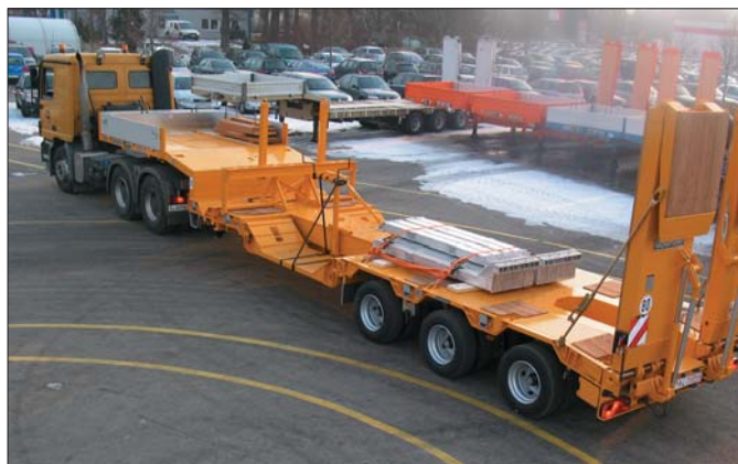
Zdalne sterowanie skrętem osi w znacznym stopniu podnosi zwrotność naczepy
