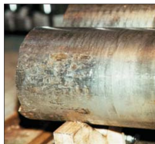
Wyrwane fragmenty materiału na skutek miejscowego zgrzania
