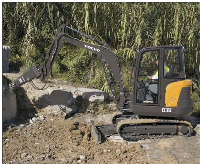
W minikoparce EC35C zastosowano ramę typu X. Jej kształt sprawia, że jest ona w stanie przenosić ekstremalne obciążenia, dzięki czemu wydawnie zwiększona została żywotność całej maszyny...
