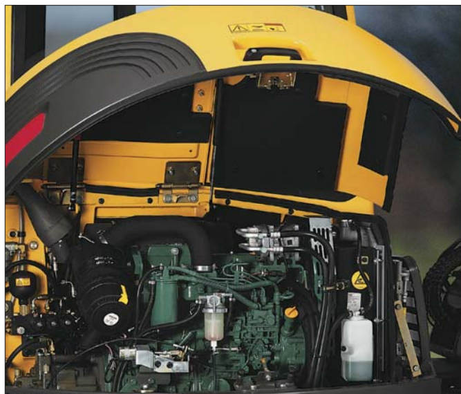
Konstruktorzy maszyn kompaktowych muszą zmierzyć się z problemem takiego upakowania podzespołów na ograniczonej gabarytach przestrzeni, by dostęp do nich w przypadku konieczności usunięcia usterki lub wykonania czynności obsługowych był jak najłatwiejszy...
