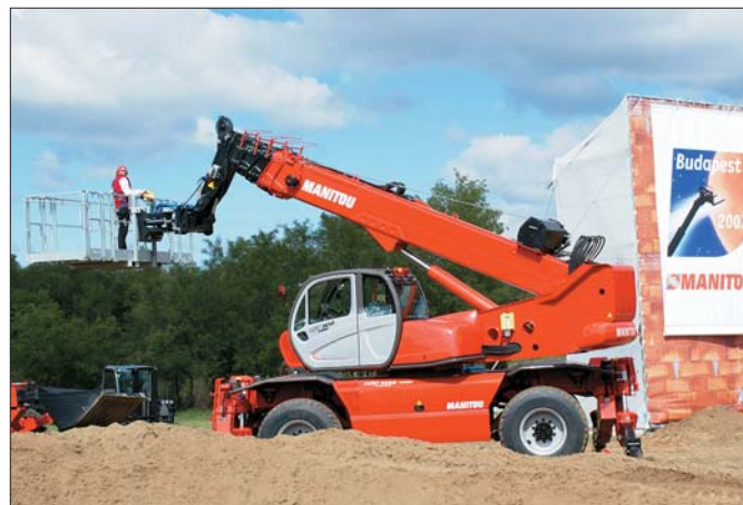
Po zamontowaniu specjalnej gondoli służyć może także do bezpiecznego transportu osób i materiałów nawet na wysokość czterdziestu metrów
