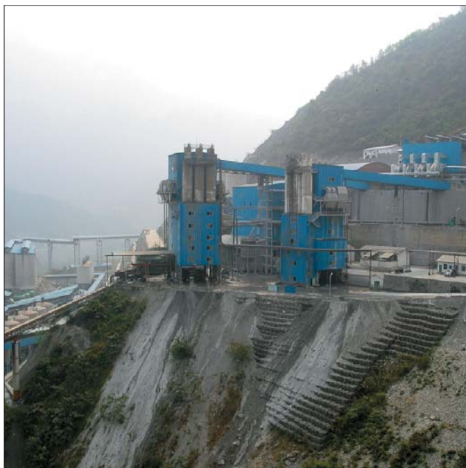
Przy budowie zapory Longtan wykorzystano dwa dwuwałowe mieszalniki BHSSonthofen typu DKX 7,0. Stosując te urządzenia w krótkim czasie uzyskać można jednorodną najwyższej jakości mieszankę z materiału o ziarnistości do 160 mm
