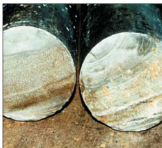
Przełom uszkodzenia zmęczeniowego
