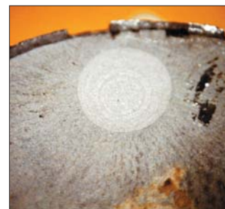
Uszkodzenie powstałe na skutek wady materiału
