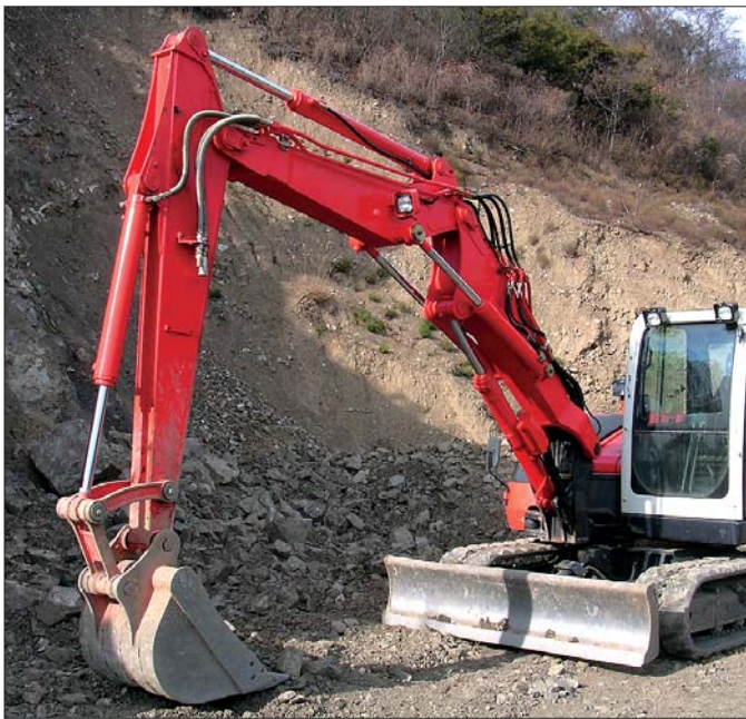
Osadzony na siłowniku hydraulicznym lemiesz służy do zagarniania urobku i wyrównywania powierzchni terenu po zakończeniu prac ziemnych. Stanowi także dodatkowy stabilizator podczas wykonywania wykopu
