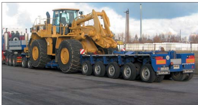
Naczepa Goldhofer XLE 7 wykorzystywana do transportu ładowarki kołowej o ciężarze roboczym pięćdziesięciu ton
