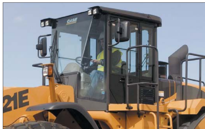
Operator ładowarki CASE 1221E pracuje w komfortowej, przestronnej kabinie wykonanej w standardzie ROPS. Duża powierzchnia przedniej szyby poprawia zdecydowanie widoczność
