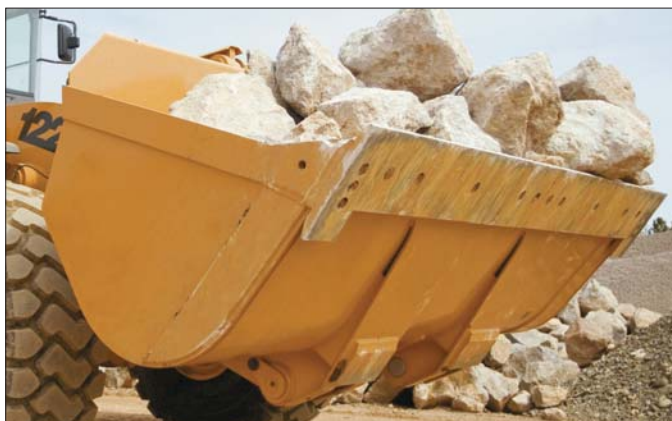
W ładowarce CASE 1221E zastosować można łyżkę o pojemności nawet 7 m 3 . Maszyna ta doskonale uzupełnia ofertę marki CASE...
