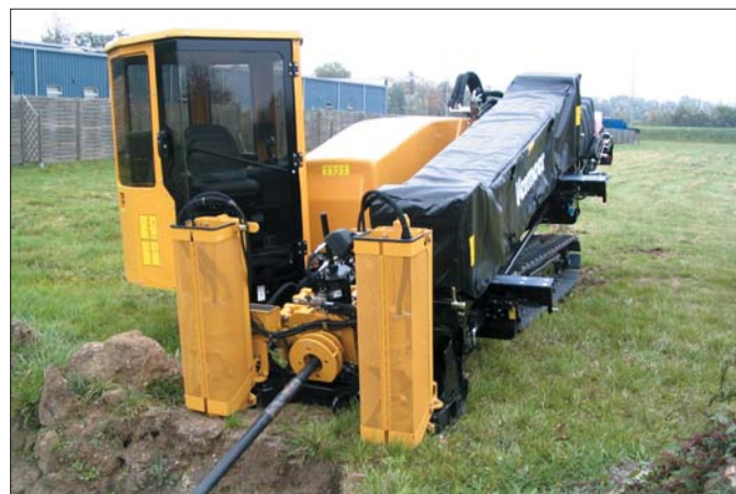
Sterowane wiercenia horyzontalne wydłużają czas wykonania nowych instalacji, zwiększają bezpieczeństwo pracy oraz nie naruszają istniejącej infrastruktury
