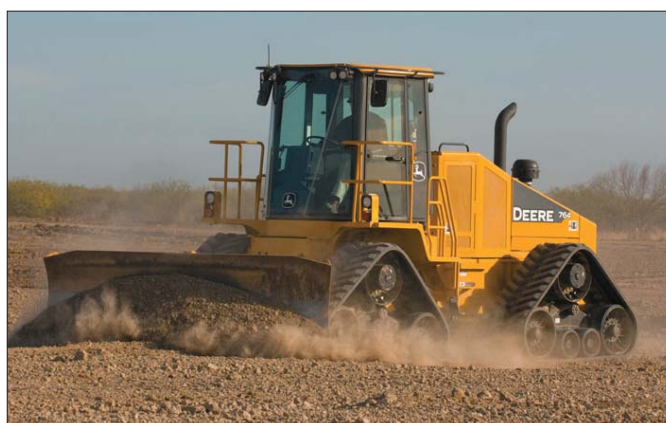
Równiarka to, czy może raczej spycharka? Konstruktorom firmy John Deere udało się połączyć zalety obu tych maszyn...
