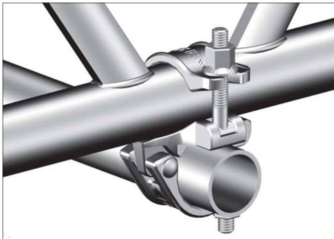
Pas górny i pas dolny, jak i pionowe pręty mają średnicę zewnętrzną 48,3 mm i są odpowiednio zaprojektowane do połączenia złączami rusztowaniowymi
