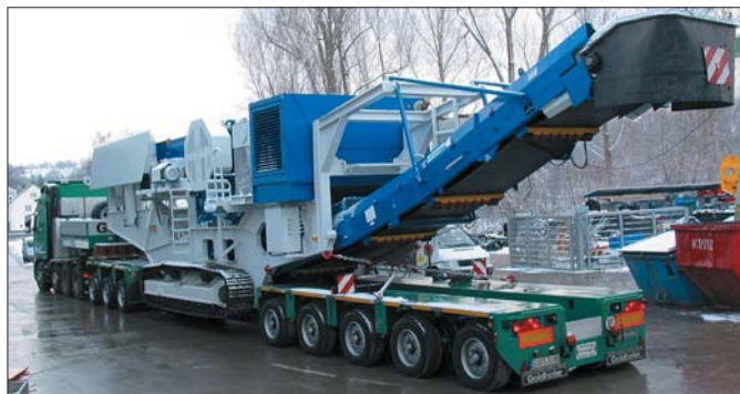
Naczepa XLE w wersji ośmioosiowej transportująca kruszarkę ważącą około 75 ton i mierzącą osiemnaście metrów
