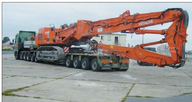
Zastosowanie naczepy XLE 6 pozwoliło na bezpieczny transport 48-tonowej koparki z ekstremalnie długim wysięgnikiem do wyburzeń
