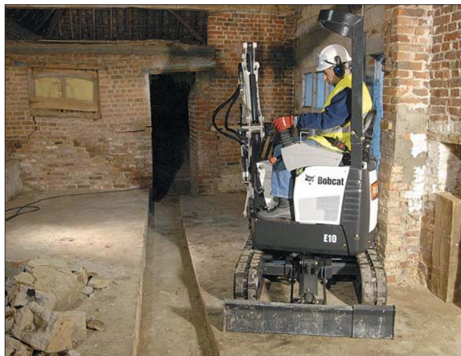
Mikrokoparkę E10 wyposażono w rozsuwane podwozie pozwalające na łatwy przejazd przez drzwi w celu wykonania prac wewnątrz budynków
