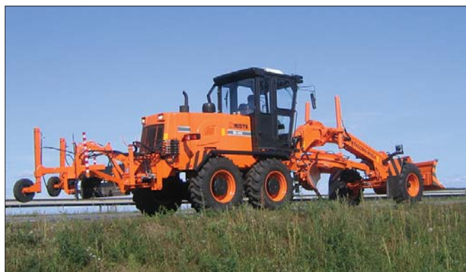
Równiarki MISTA posiadają wszelkie składowe badania certyfikacyjne i są oznaczane znakiem CE dopuszczającym do obrotu na terenie Unii Europejskiej. Na zdjęciu wyposażona w lemiesz zgarniający tylny równiarka RD165C pracująca na rynku litewskim
