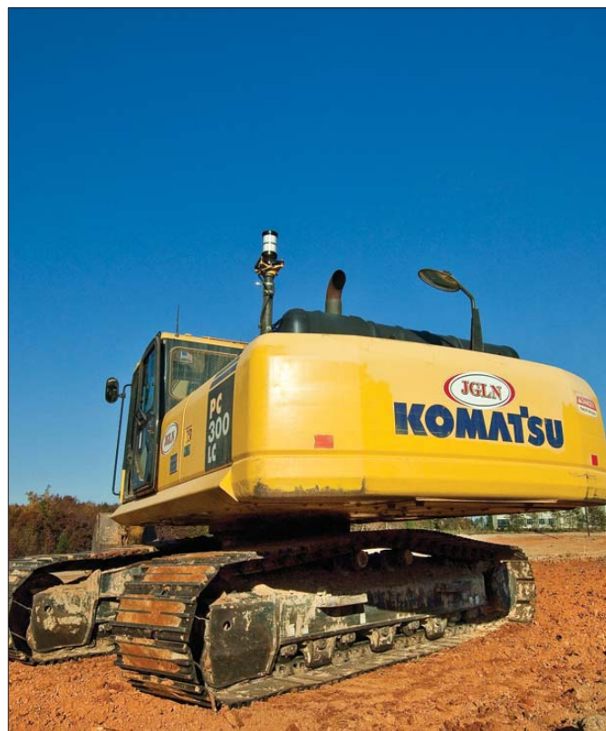
Z myślą o zastosowaniu w koparkach firma Trimble wprowadziła przydatną opcję Single GPS (pojedynczy odbiornik GPS), umożliwiającą sterowanie ich pracą w trybie 3D
