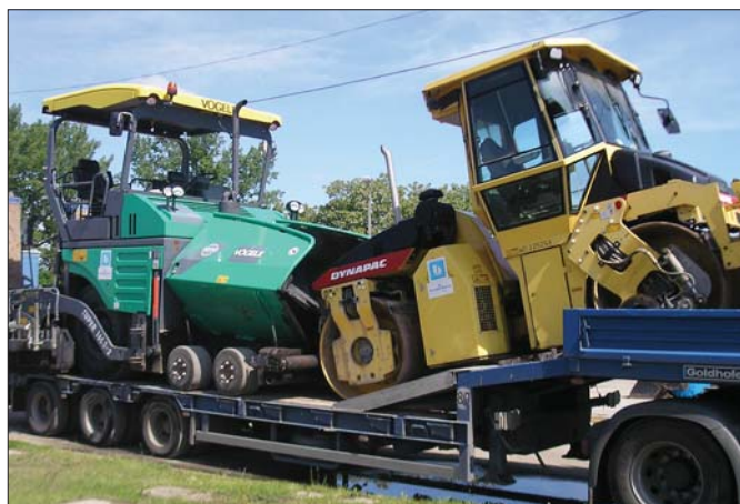
Rozścielacz asfaltu i walec mogą być transportowane jednocześnie...
