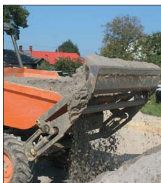
Wozidło wyposażone jest w łyżkę umożliwiającą samodzielny załadunek materiału
