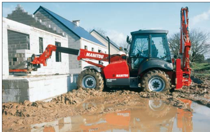
Charakterystyczny dla Manitou układ teleskopowy umożliwia podniesienie ładunku na wysokość o około dwa metry wyższą niż typowe koparko-ładowarki
