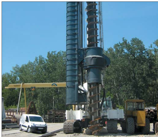
Największą maszyną Soilmec pracującą aktualnie w Polsce jest palownica SR-100 w konfiguracji CSP z podwójną głowicą
