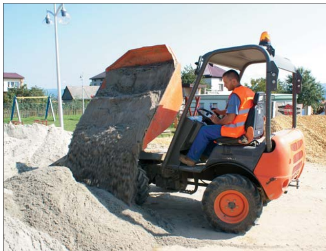
W wozidle D201 RHGS zastosowano obrotnicę umożliwiającą opróżnianie skrzyni zasypowej zarówno do przodu, jak i na boki
