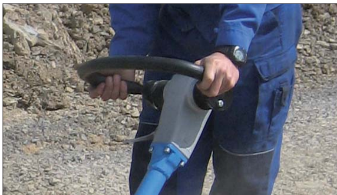
Konstruktorzy zagęszczarki CR 5 zadbała o optymalne wytłumienie drgań na rękojeści, co zapewnia operatorowi pełen komfort obsługi
