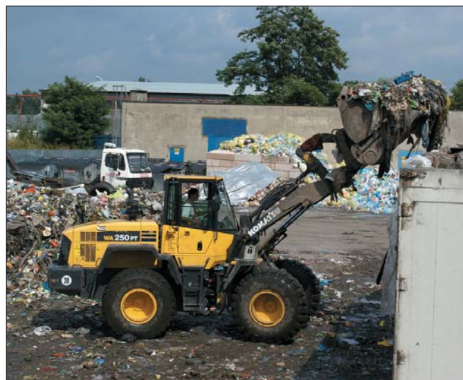
Długie ramię ładowarki zapewnia największą w tej klasie maszyn wysokość zrzutu – aż 2,96 metra
