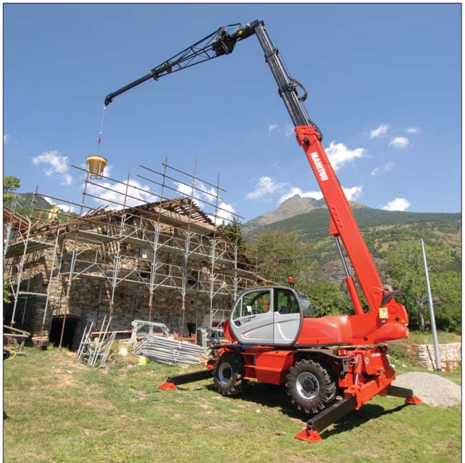
Maszyny serii MRT wyposażone w funkcję obrotu wokół własnej osi łączą cechy ładowarki teleskopowej i małego żurawia samojezdnego
