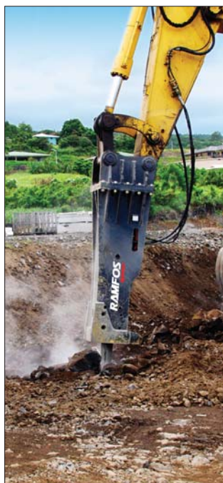
Nowoczesna konstrukcja młotów hydraulicznych RAMFOS gwarantuje najwyższą efektywność ich działania
