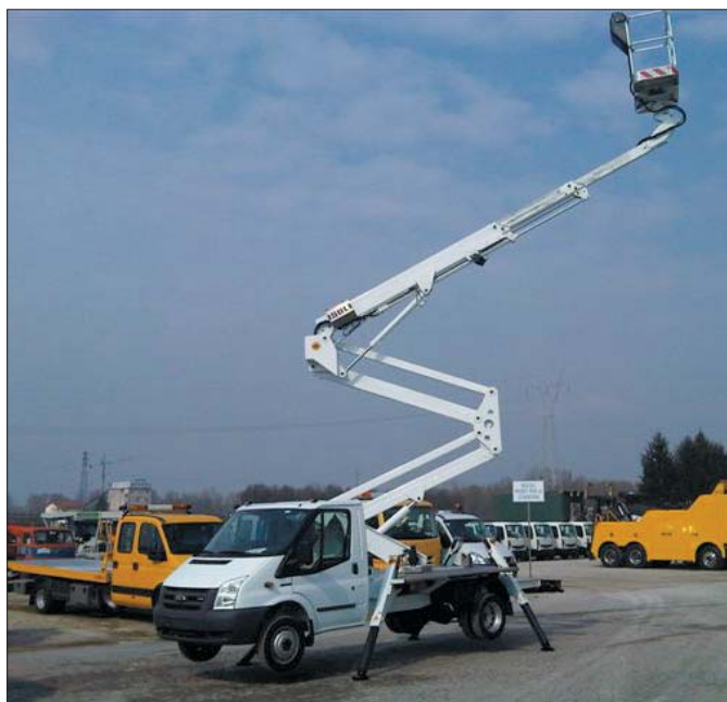
Nowoczesny podnośnik PNT205SR zamontowany na podwoziu Ford Transit umożliwia pracę na wysokości 20,3 metra przy obciążeniu kosza 200 kg
