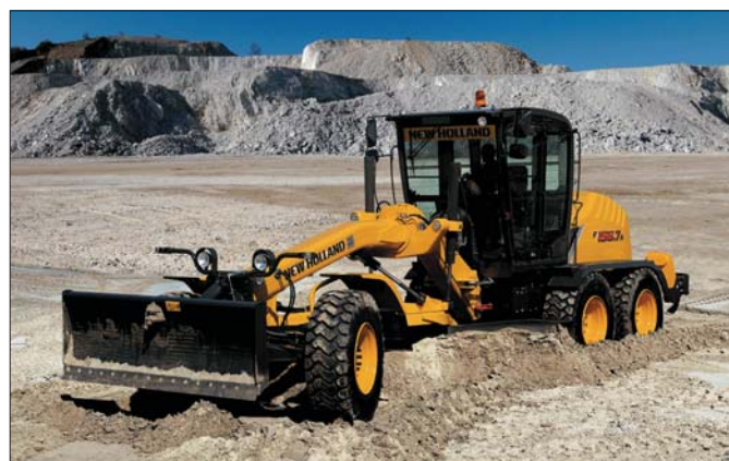
W równiarce F156.7A zastosowano sześciobiegową przekładnię Zahnrad Fabrik. Pozwala to na precyzyjną pracę wykonywanie manewrów przy niskiej prędkości jazdy
