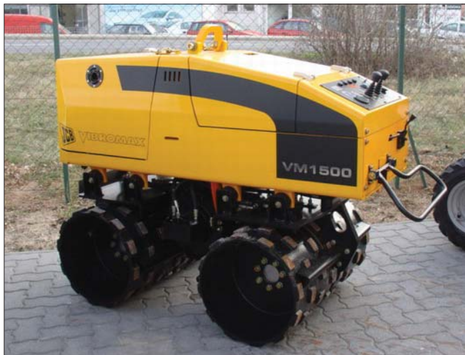
Sterowany manualnie walec Vibromax VM 1500 M ze względów bezpieczeństwa stosowany jest z reguły do zagęszczania nawierzchni, a nie w wykopach
