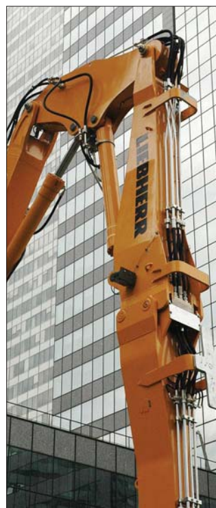
Liebherr Likufix – hydrauliczne gniazdo szybkozłącza na ramieniu wysięgnika
