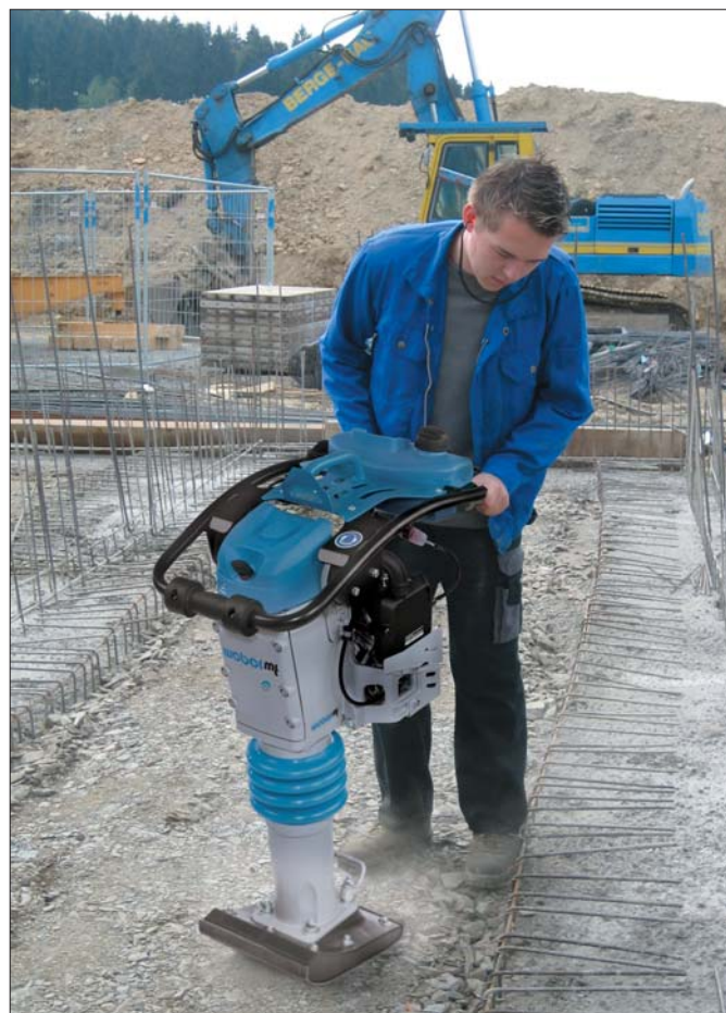
Stopa wibracyjna SRV 620 jest jednym z dwóch modeli, w których zastosowano czterosuwowy silnik benzynowy
