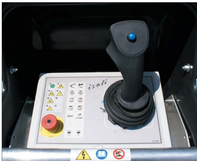
Podnośnik wyposażony jest w podwójny układ sterowania, jeden w koszu, drugi na podwoziu z zabezpieczeniem przed równoczesnym użyciem
