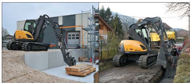
Mecalac 8MCR jest w stanie zastąpić midikoparkę, ładowarkę burtową lub wózek widłowy. Może również pracować jako nośnik osprzętu
