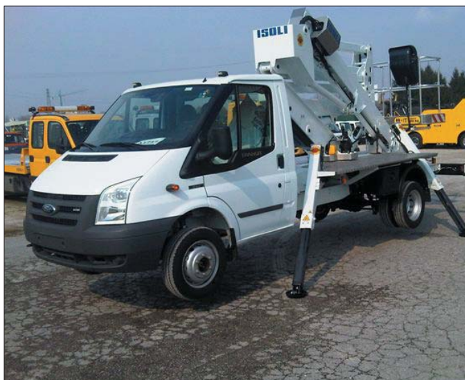
Podnośnik wyposażono w układ zabezpieczający przed ruchami podnośnika w przypadku nieprawidłowo rozstawionych podpór, w układ antykolizyjny z kabiną podwozia
