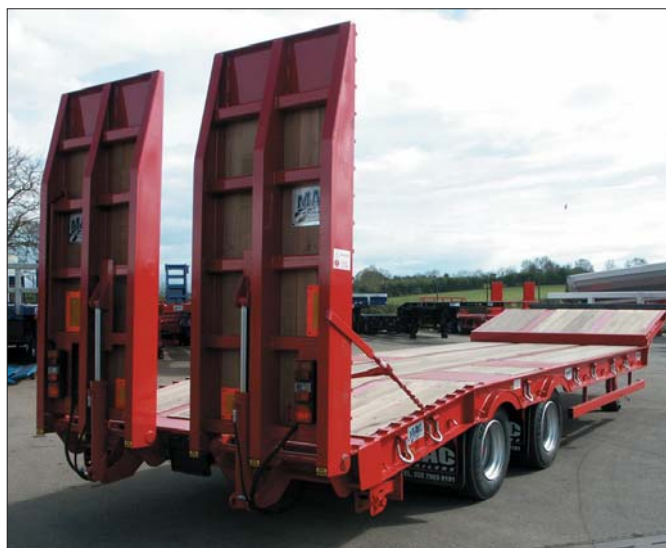
Schodkowe naczepy niskopodłogowe zostały zaprojektowane z uwzględnieniem potrzeb operatora, łącząc wytrzymałość i niski ciężar bez ładunku
