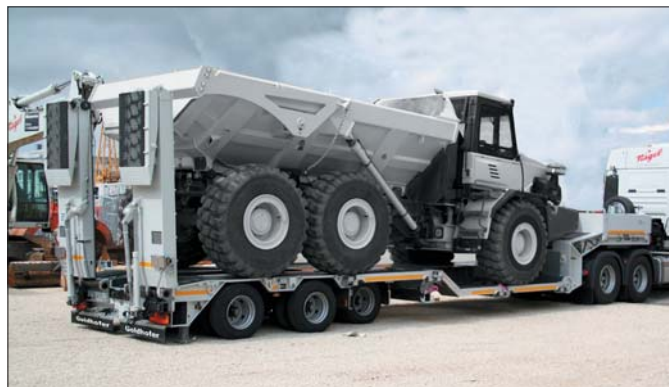
Naczepa niskopodwoziowa STZ-L 3 doskonale nadaje się do przewozu maszyn budowlanych
