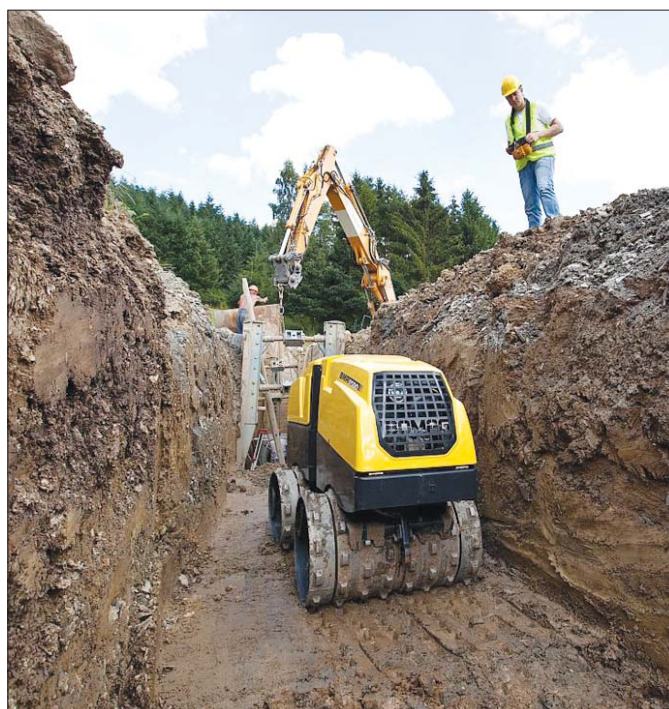
W walcu Bomag BMP 8500 zastosowano kombinowane zdalne sterowanie. Może być ono drogą kablową lub, tak jak w tym przypadku, za pośrednictwem fal radiowych
