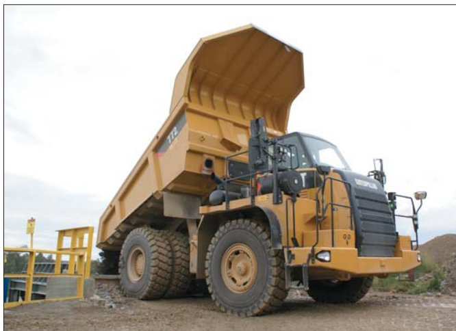
Elektronicznie sterowany układ wywrotu zapewnia operatorowi lepszą kontrolę nad zrzucanym ładunkiem
