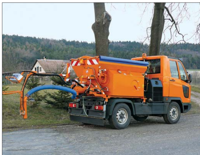
Kompaktowy Multicar FUMO z zabudową umożliwiającą szybkie naprawy nawierzchni
