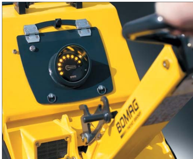
Za pomocą systemu Economizer dokonywana jest analiza oddziaływania podłoża na będącą w ruchu płytę podstawy wibratora. Mierzona wartość ukazuje się na wyświetlaczu LED
