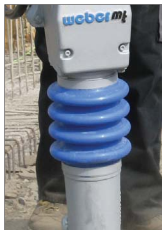
Zabezpieczenie bloku uderzeniowego zapewnia układ sprężyn, co jest w stopach wibracyjnych Weber MT standardem
