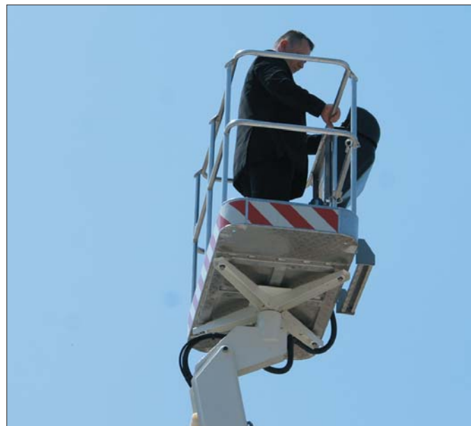
Kosz jest samopoziomowany i wyposażony w ogranicznik przeciążenia. Zainstalowano w nim gniazdko elektryczne 230V umożliwiające zasilanie narzędzi elektrycznych
