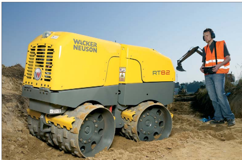
Zastosowany w walcu RT 82 SC opatentowany system Smart Control dodatkowo podnosi bezpieczeństwo pracy. Działa on w ten sposób, że pracująca maszyna musi „widzieć” kierującego nią człowieka. Każda utrata kontaktu powoduje automatyczne wyłączenie walcu
