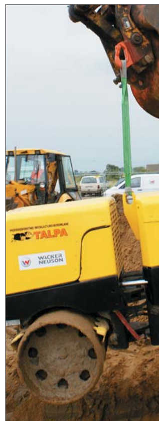
Oczko zintegrowane z górnym poszyciem walcu Wacker Neuson ułatwia jego transport
