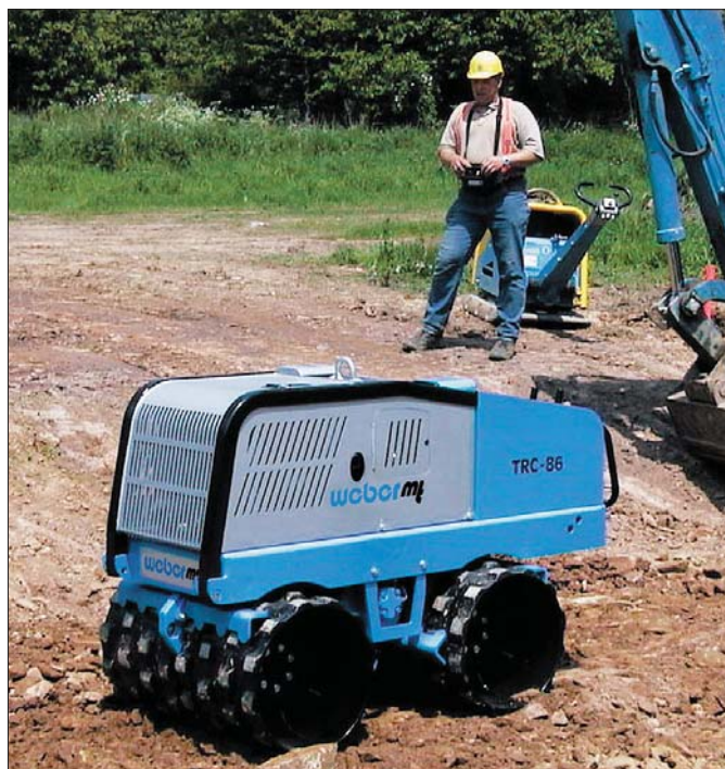
Opcjonalnie walce Weber TRC wyposażone być mogą w układ zdalnego sterowania, który zapewnia większe bezpieczeństwo operatorowi podczas prac w wykopach
