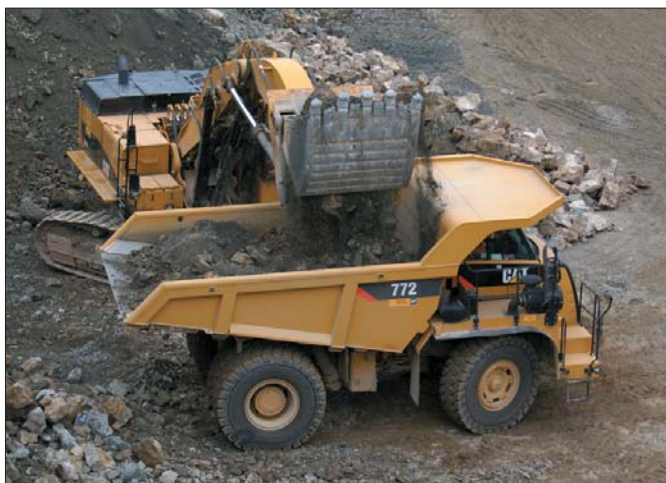
Powierzchnie skrzyni ładunkowej mające kontakt z transportowanym materiałem wykonano ze stali o twardości 400 HB o dużej odporności na ścieranie i obciążenia uderowe
