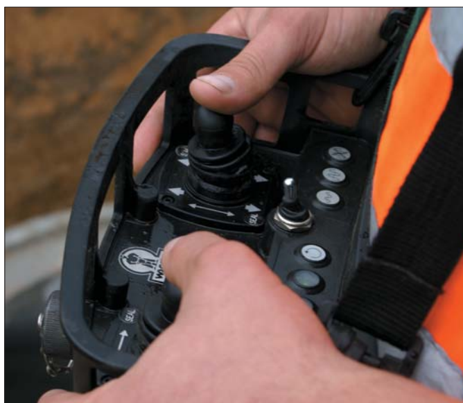
Konstruktorzy Wacker Neuson od lat stosują system zdalnego sterowania na podczerwień. Wychodzą bowiem z założenia, że jest on mniej podatny na zakłócenia zewnętrzne
