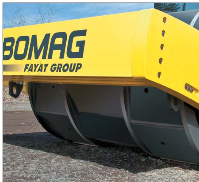
W maszynie zastosowano bęben o nowatorskiej konstrukcji. Dzięki odpowiednio dobranemu kształtowi płyt i krawędzi, siły zagęszczania wnikają do podłoża pionowo
