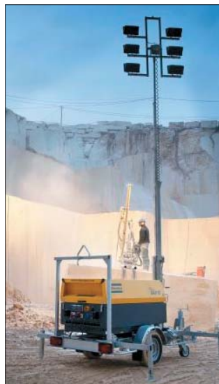
Wieża oświetleniowa QAS/QAX wyposażona jest w sześć reflektorów halogenowych emitujących światło o mocy 1.500 W
