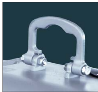
Załadunek i transport zagęszczarki znacznie ułatwia składany uchwyt do podłączenia haka dźwigowego
