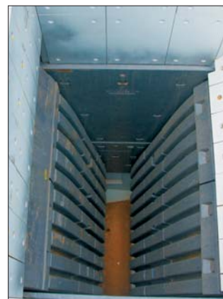
Optymalny kształt otworu zsykowego zapewnia maksymalną wydajność kruszenia
