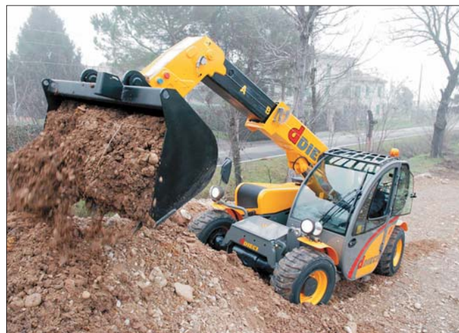
Podstawowy osprzęt podnośników teleskopowych stanowi łyżka
