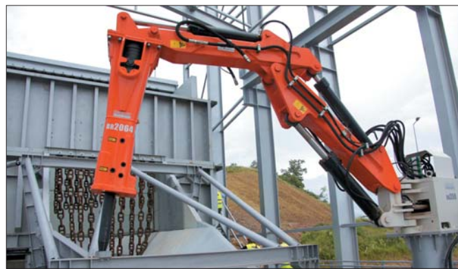
Nad największą w Polsce kruszarką szczękową zamontowano młot hydrauliczny Sandvik z wysięgnikiem, za pomocą którego rozbijane są nadgabaryty
