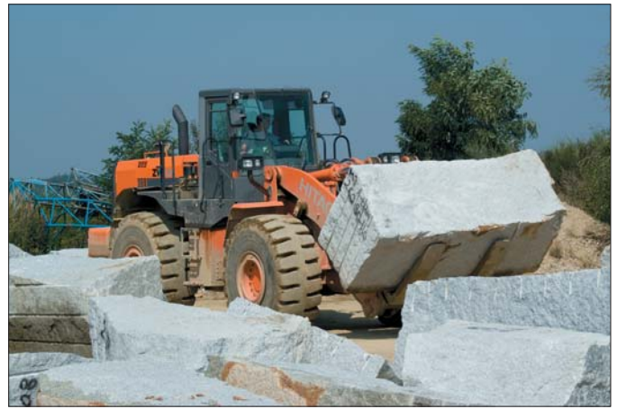
Ładowarka ZW 330 wykorzystywana jest najczęściej, jako nośnik bloków. Tygodniowo przemieszcza 150 bloków granitowych, każdy z nich o wadze co najmniej 15 ton
