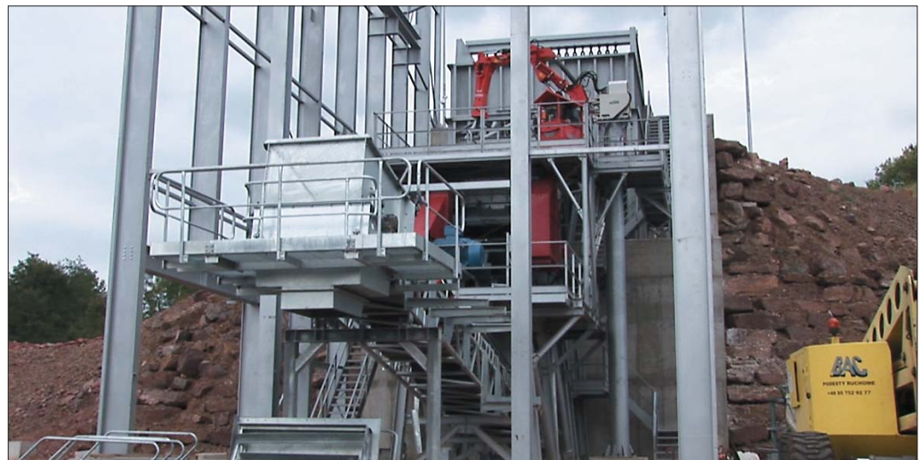
Serce najnowszej kopalni odkrywkowej w Polsce stanowi kruszarka szczękowa Sandvik CJ615 będąca największą tego typu maszyną pracującą w naszym kraju
