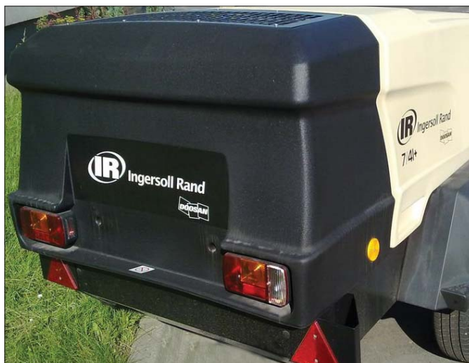
Sprężarka przewoźna 7/41+ jest idealna do pracy z wszelkiego rodzaju narzędziami pneumatycznymi
