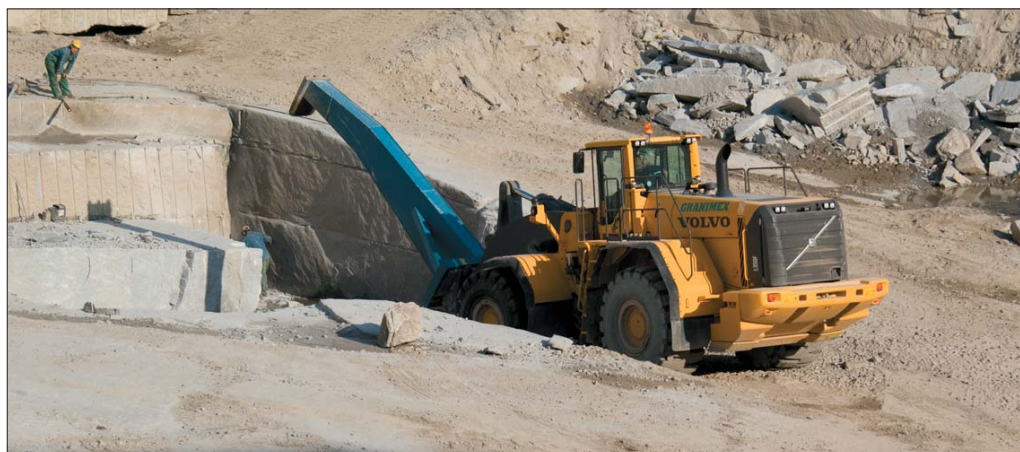
Ładowarka wykorzystywana jest nie tylko do transportu bloków skalnych, ale także do ich odspajania przy użyciu zrywaka
