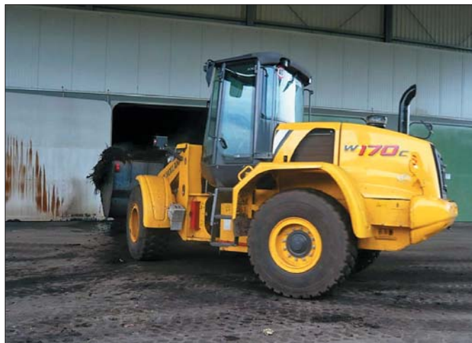
Ładowarka W170C osiąga maksymalną prędkość wynoszącą 38 km/h na odcinku niespełna stu metrów, co pozwala znacznie przyspieszyć wykonanie zadania
