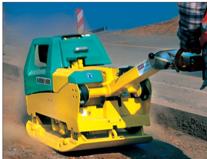
We wszystkich zagęszczarkach serii AVH Ammann zrezygnował ze sprzęgła odśrodkowego wprowadzając sterowanie poprzez elektrozawory
