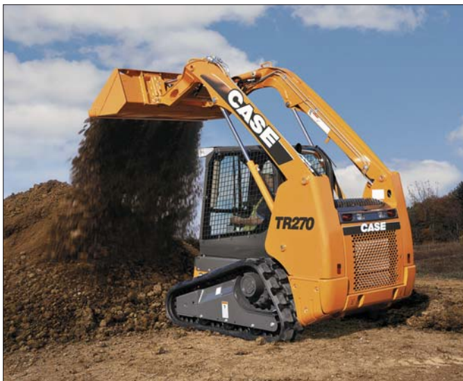
Ładowarki na gąsienicach przeznaczone są na trudny teren i znakomicie sobie tam dają radę. Wszystkie modele wyposażone są w szybkozłączce ułatwiające wymianę osprzętu
