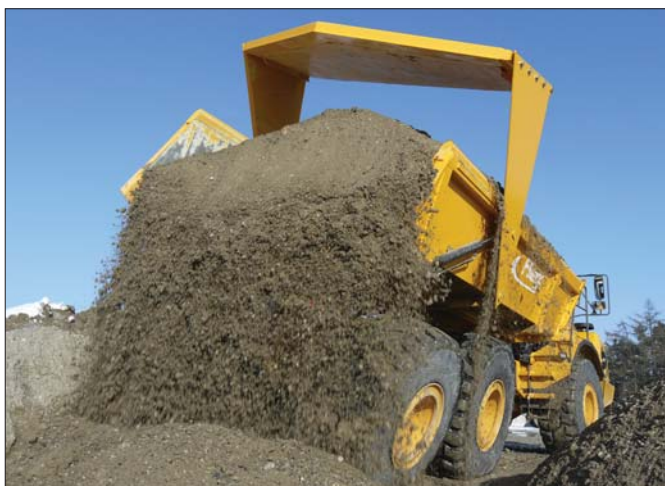
Cechą charakterystyczną muldy „Fliegl ASW Stone Dumper” jest układ zsuwający ładunek
