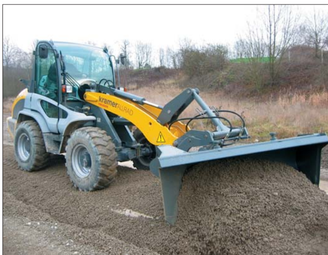
Popularny szczególnie jako maszyna wynajmowa Kramer 680 przy wadze nieco ponad 5,5 tony jest w stanie unieść ładunek 2,5 ton
