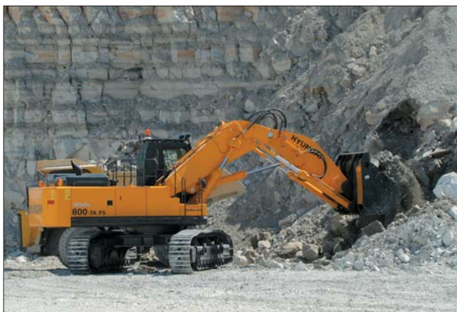
Koparka R800-7A FS skonstruowana z myślą o wykorzystaniu w kopalniach surowców skalnych poddana została czterotygodniowym testom w kopalni „Folwark”
