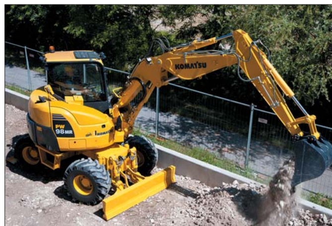
Dużą mobilność najnowszej kolowej midikoparki Komatsu zapewnia zwarta budowa maszyny i zastosowanie czterech kół skrętnych
