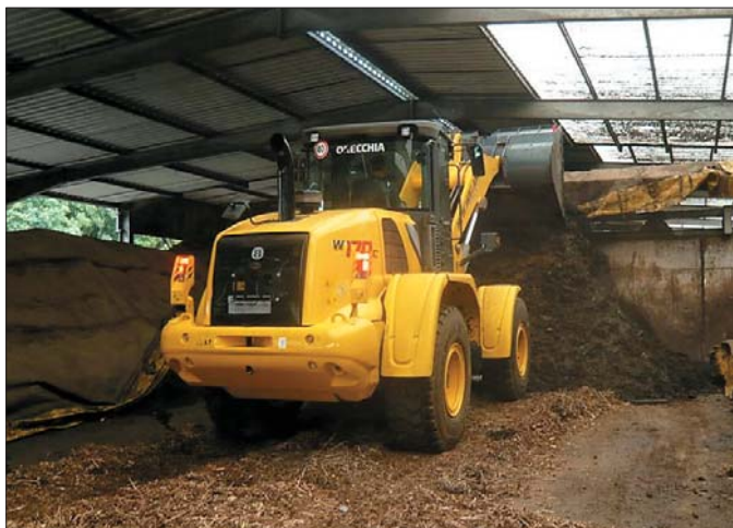
Ładowarka W 170C wykorzystywana jest głównie do przeładunku materiału kompostowego oraz opróżniania fermentatora
