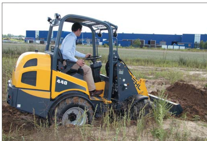
Efektywność spychania urobku podnosiła blokada mechanizmu różnicowego
