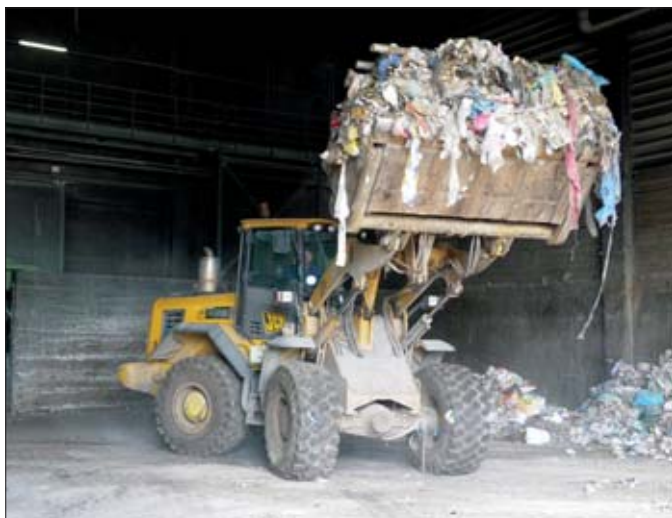
Ładowarka kołowa JCB 426 ZX przy przeładunku odpadów
