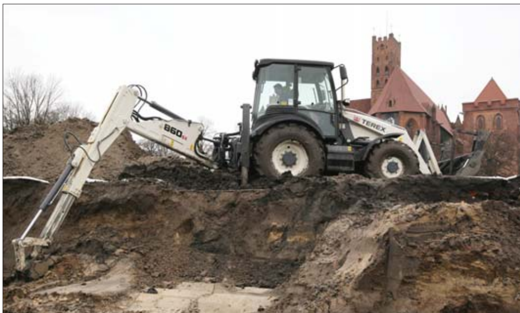
Koparko-ładowarka Terex 860 SX ma wyjątkowo duży zasięg łyżki koparki, a to oznacza, że można nią sięgnąć miejsc trudno dostępnych lub wręcz niedostępnych dla innych maszyn
