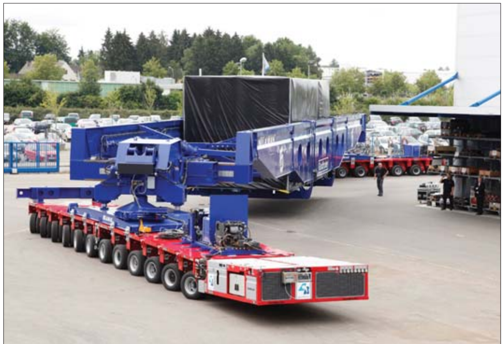
Nowa generacja przęsłowych pomostów oferowana jest w różnych wykonaniach – od 70 do 130 ton masy własnej, co przekłada się na ładowność w zakresie od 350 do 650 ton
