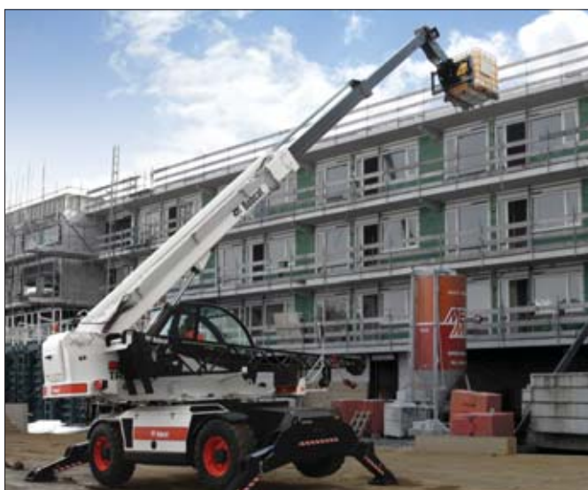
Ładowarka teleskopowa Bobcat TR38160 jest standardowo przystosowana do współpracy z dziesięcioma różnymi modelami platform roboczych
