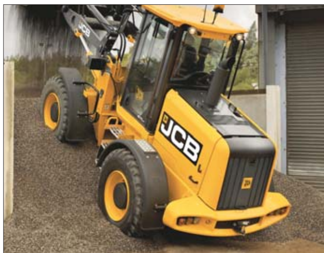
Przebudowa tylnej części maszyn w głównej mierze wynikała z konieczności wygospodarowanie dodatkowego miejsca w komorze silnika
