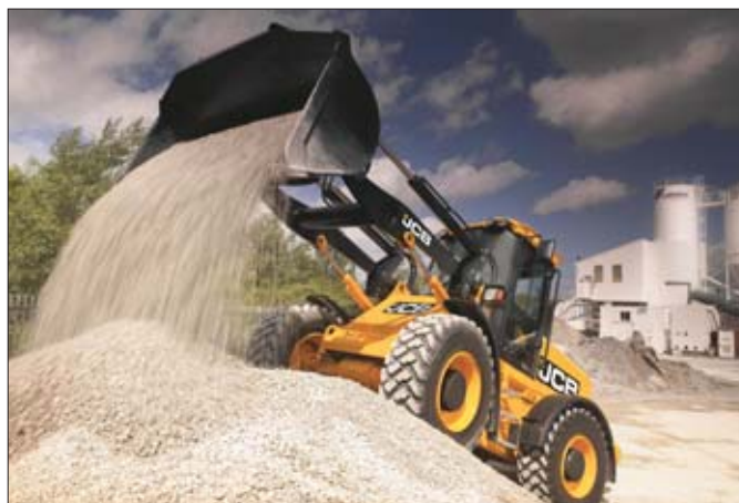
Kinematyka wysięgnika ładowarki typu „Z” skraca cykle robocze, optymalizuje kąty zamknięcia i wysypu łyżki oraz daje wysoką siłę skrawania
