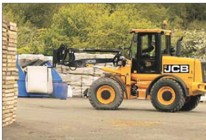
Oferowane w standardzie równoległe prowadzenie ramion wysięgnika zapewniają zarówno krótkie cykle robocze, jak i bezpieczny i precyzyjny transport palet
