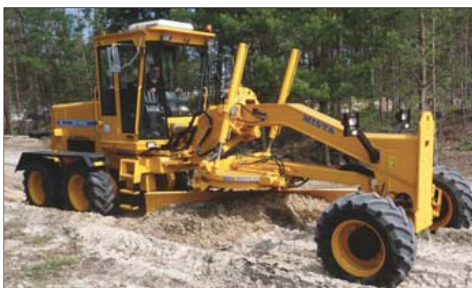
Dzięki wyeliminowaniu emitujących hałas skrzyni przekładniowej, wałów napędowych i tradycyjnego mostu napędowego równiarka RD130FHD jest wyjątkowo cicha
