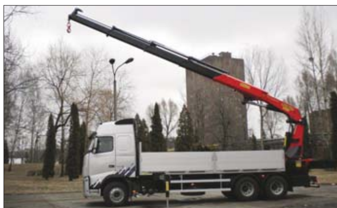
Jednym z zastosowań żurawia PK50002-EH z serii High Performance jest transport i instalacja szamb betonowych o pojemności do 20 m 3
