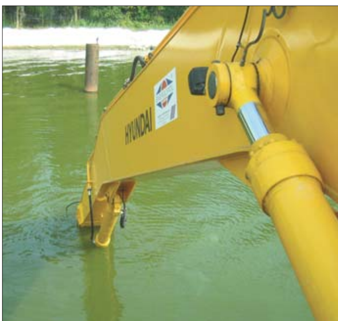
Ramiona i wysięgnik poddano zmianom konstrukcyjnym. Całość została dodatkowo uszczelniona, co pozwala na pracę koparek na głębokości piętnastu metrów pod lustrem wody
