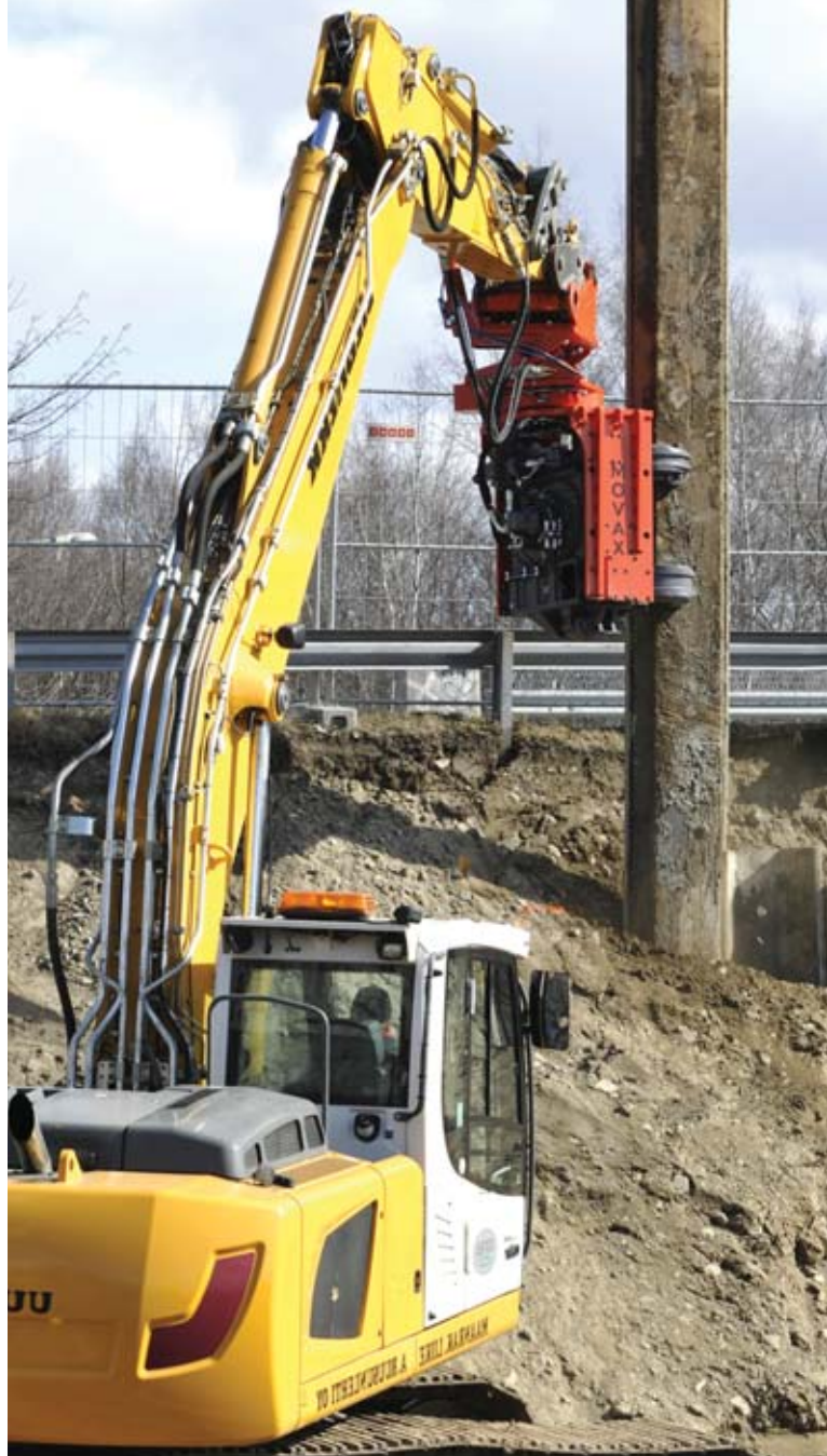
Typowy dla wibromłotów MOVAX uchwyt boczny pozwala trzymać wbijany element w odpowiedniej pozycji, dzięki czemu znika ograniczenie maksymalnej długości wbijanej grodzicy, profilu lub rury
