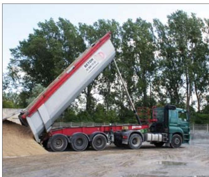
Na niezawodność naczep Schwarzmüller zakupionych przez MD-Beton mają wpływ osie SAF z hamulcami bębnowymi, które są lepiej odporne na zanieczyszczenia
