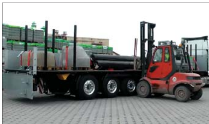
Naczepa Kögel Multi ma wzmocnione podwozie, co umożliwia jej zastosowanie zarówno w trudnych warunkach placu budowy, jak i do przewozu kontenerów
