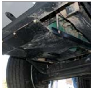
Przednia część podwozia jest wyposażona w solidną osłonę stalową, zabezpieczającą przed uszkodzeniem osprzęt silnika.
