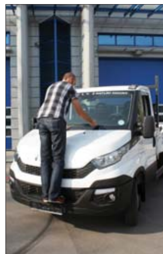
Szeroki stopień w zderzaku ułatwia czyszczenie szyby czołowej i wycieraczek. Posiada on zabezpieczenie przeciwpółślizgowe ułatwiające obsługę pojazdu w zimie
