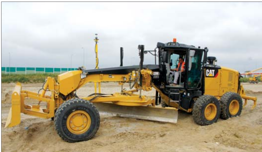
Budimex realizujący kompleksowe prace ziemne na terenie MOP-ów Krzyżanów wykorzystywał nowej generacji równiarkę Caterpillar 140M3 AWD wyposażoną w system sterowania maszynami Trimble GCS900 Grade Control System 3D UTS
