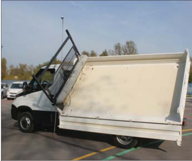
Mimo niewielkich rozmiarów, zabudowa F.X. Meiller została wyposażona plandekę zabezpieczającą przewożony ładunek. W podłodze skrzyni jest 6 składanych uchwytów ułatwiających mocowanie przedmiotów
