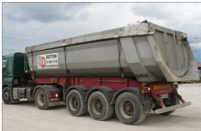
Oba rodzaje naczep Schwarzmüller wykorzystywanych przez firmę MD-Beton mają konstrukcję rynnową zapewniającą lepszą szczelność skrzyni i całkowity rozładunek
