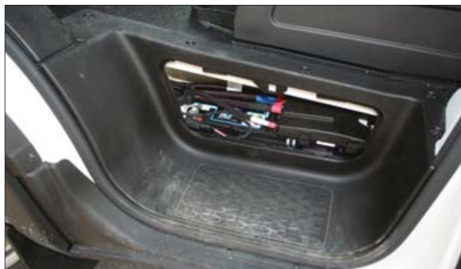
Dostęp do akumulatora znajdującego się pod fotelem kierowcy jest bardzo prosty. Wystarczy zdjąć niewielki panel lub odkręcić stopień
