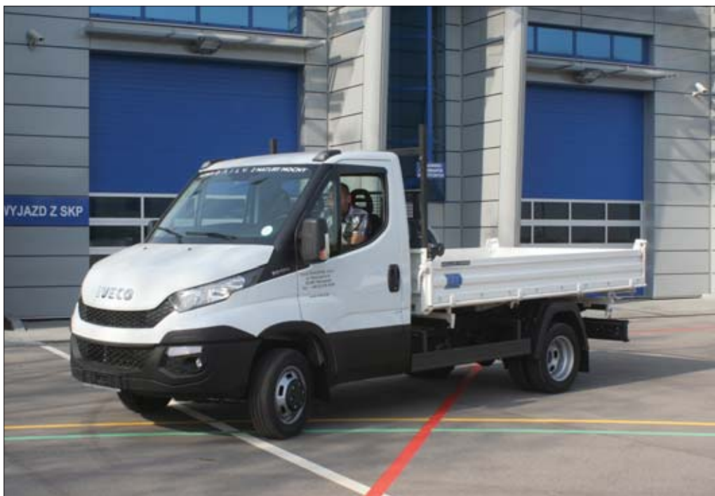
Przeprojektowana kabina nowego Daily nie tylko zwiększa atrakcyjność pojazdu, ale zapewnia też niższe opory powietrza i znacznie lepsze doświetlenie wnętrza
