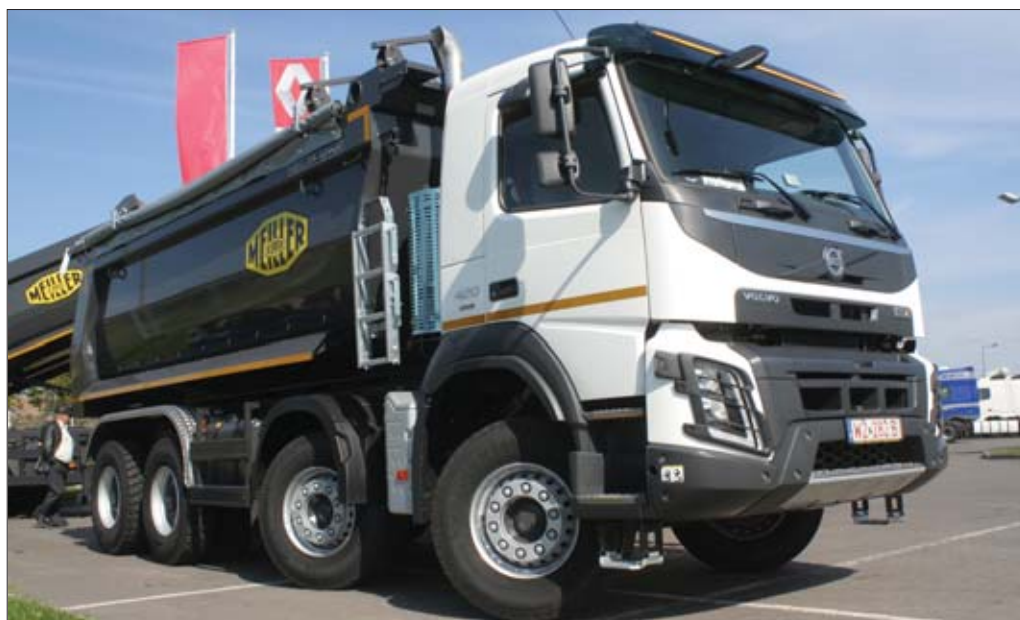
Wysokie osiągi i nowoczesny układ przeniesienia napędu, w połączeniu z dużym prześwitem i krótkim przednim zwisem, zapewniają znakomite właściwości terenowe modelu FMX
