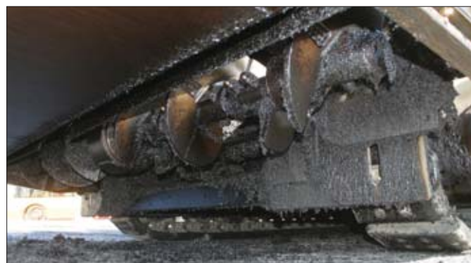
Rozścielacze BOMAG serii 600 są wyposażane w wytrzymałe, żeliwne przenośniki ślimakowe o średnicy 350 mm
