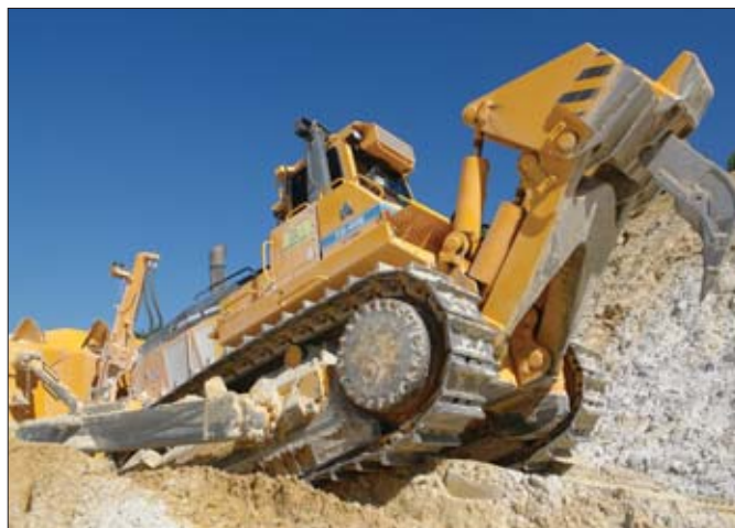
System urabiania złoża spycharkami wyposażonymi w zrywak zapewnia stabilność uformowanych skarp i zboczy oraz wyklucza groźbę powstania szkód górniczych
