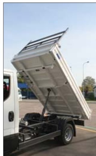
Solidne wzmocnienie podłogi w zabudowie samowyładowczej F.X. Meiller gwarantuje odpowiednią wytrzymałość konstrukcji, a tym samym możliwość przewożenia ciężkich materiałów
