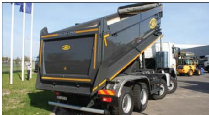
F.X. Meiller stosuje w swoich zabudowach własne układy hydrauliczne, co zwiększa niezawodność pojazdu i ułatwia serwisowanie
