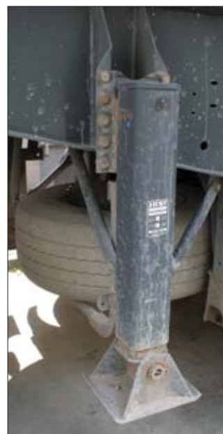
Należące do MD-Beton naczepy Schwarzmüller wyposażone są w bardzo wytrzymałe nogi podporowe. Jost opuszczane/podnoszone mechanicznie
