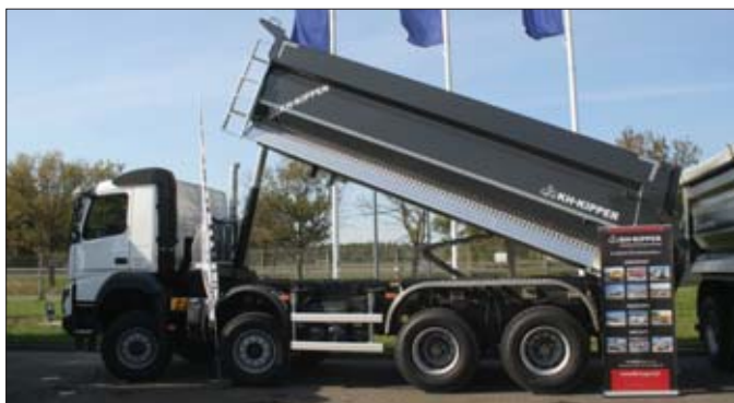
W najnowszych zabudowach KH-Kipper typu „rynnä” przeprojektowano m.in. tylną część podłogi skrzyni, eliminując pozostawianie resztek urobku
