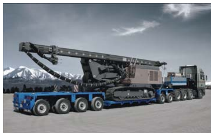
Technologia osi MPA poddana została wielomiesięcznym testom teoretycznym i praktycznym. Ich wynik sprawił, że Goldhofer zdecydował o wykorzystaniu najlżejszych na świecie osi w seryjnej produkcji swych pojazdów
