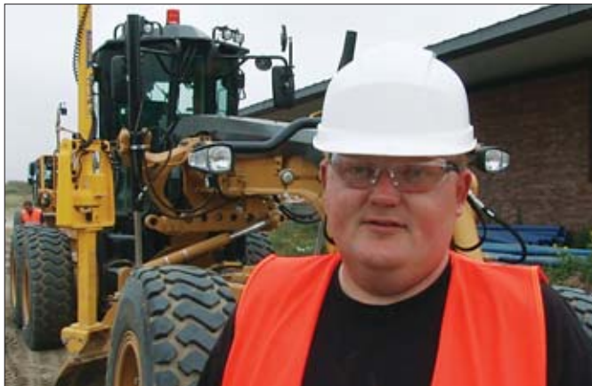
Inżynier Łukasz Bętkowski podkreśla zwiększoną efektywność równiarki wyposażonej w system sterowania pracą Trimble GCS900 3D UTS
