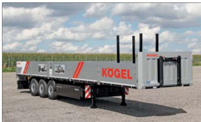
W naczepie Kögel Multi cała rama pojazdu jest chroniona przed korozją technologią nanoceramiczną oraz powłoką KTL, pokrytą dodatkowo lakierem UV
