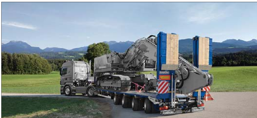
Technologia osi MPA poddana została wielomiesięcznym testom teoretycznym i praktycznym. Ich wynik sprawił, że Goldhofer zdecydował o wykorzystaniu najlżejszych na świecie osi w seryjnej produkcji swych pojazdów
