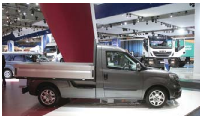
Prezentowana wersja Work-Up ma fabryczną skrzynię ładunkową o powierzchni 4,2 m 2 , z podłogą wyłożoną sklejką wodoodporną i trzema burtami otwieranymi do pionu
