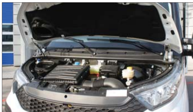
W nowym Daily pokrywa silnika nie ma podpórki, bo jej rolę pełnią dwie sprężyny śrubowe, które jednocześnie wspomagają otwieranie maski
