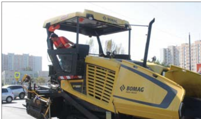
Opatentowany system SIDEVIEW pozwala na wysunięcie kabiny poza obrys zasadniczej części rozścielacza o maksymalnie 600 mm w obie strony
