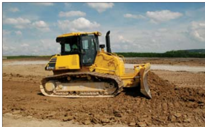
System iMC stanowiący seryjne wyposażenie spycharek D61EXi/PXi-23 pozwala na pełną automatyzację całego procesu niwelacji
