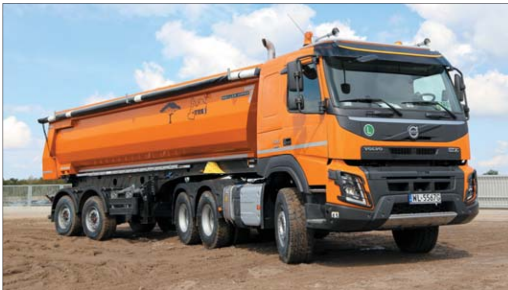
Napęd dwóch osi w ciągniku Volvo FMX zamówionym przez Tree Polska ułatwia manewrowanie na grząskich podłożach. Dzięki temu nie ma problemu z podjazdem pod pracującą koparkę czy ładowarkę
