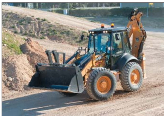
Flagowy model Case 695ST jest koparko-ładowarką o wszystkich kołach skrętnych (trzy tryby skrętu) jednakowej wielkości
