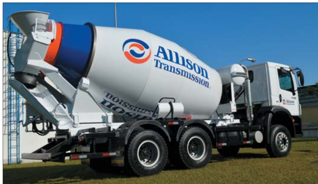
Betonomieszarka z automatyczną skrzynią biegów jest tańsza w eksploatacji, bo nie ma sprzęgła podlegającego zużyciu i spala mniej paliwa. Natomiast praca kierowcy jest znacznie bardziej wydajna, bezpieczniejsza i przyjemniejsza
