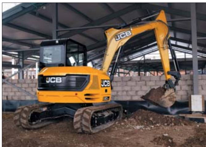
Nowa 9-tonowa koparka gąsienicowa średniej wielkości 90Z-1 jest cięższa od modelu 85Z-1, ale ma te same wymiary główne. Wyróżnia ją zmodyfikowane podwozie w układzie H z dłuższymi gąsienicami
