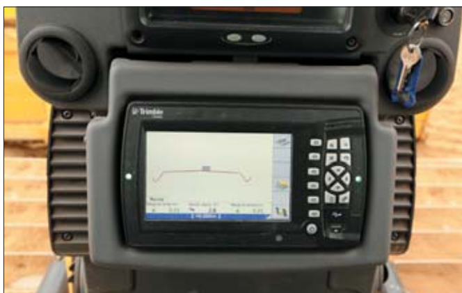
W przypadku TMN operator „komunikuje” się z systemem za pomocą jednostki sterującej Trimble CB460 z czytelnym wyświetlaczem LED o przekątnej 7 cali. Jest on idealnie wpasowany w centralną konsolę spycharki, dzięki czemu nie ogranicza widoczności i nie zajmuje dodatkowego miejsca w kabinie
