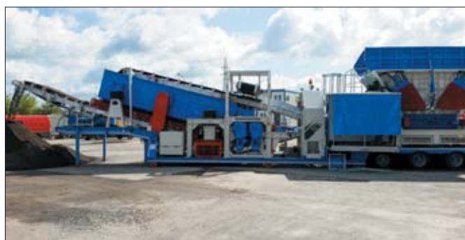
Celem konstruktorów granulatora MBRG 2000 było zapewnienie możliwości kruszenia dużych kawałków nawierzchni bitumicznej i rozdrobnienie jej do rozmiarów produktu recyklingowego, jednakże bez podwyższania udziału frakcji drobnej
