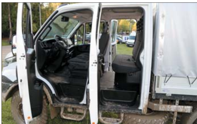
Kabina brygadowa Daily 4x4 wygodnie mieści siedem osób, nawet w grubych ubraniach. Duża przestrzeń za przednimi fotelami ułatwia wchodzenie i opuszczanie wnętrza
