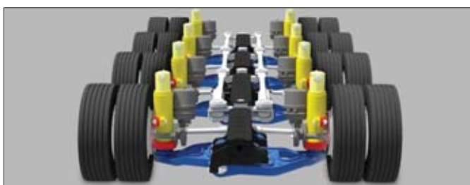
Cylinder układu hamulcowego osi MPA został umieszczony za amortyzatorem, dzięki czemu nie ogranicza skrętu kół, a jednocześnie jest chroniony przed uszkodzeniami
