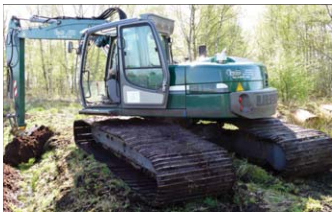
Podczas pracy na torfowisku nacisk na grunt koparki musiał być ograniczony do minimum, w przeciwnym razie maszynie groziłoby utopienie
