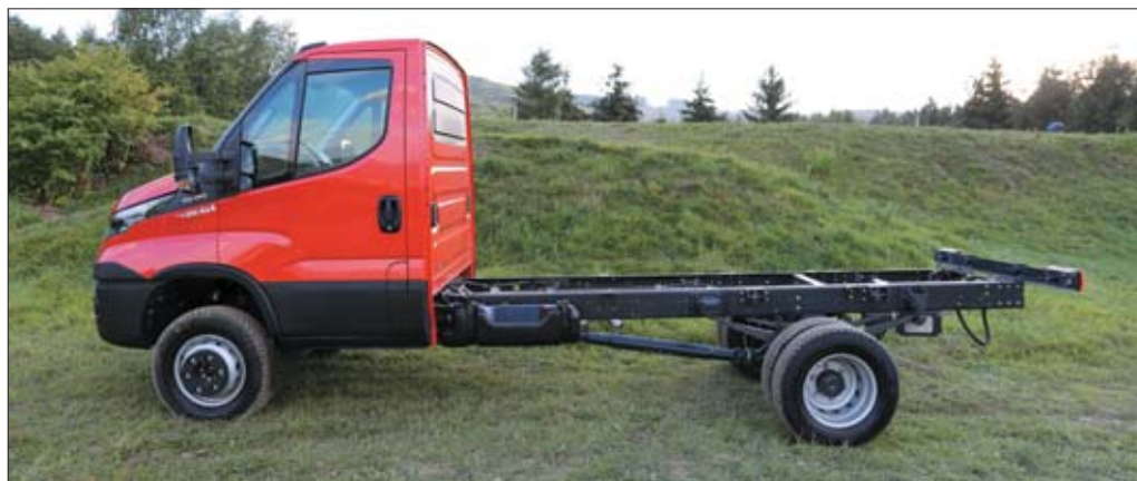
Podwozia modernizowane przez firmę Achleitner są chętnie wyposażane w duże podnośniki koszowe, które w przypadku Daily 4x4 powodują przekroczenie dopuszczalnej masy całkowitej
