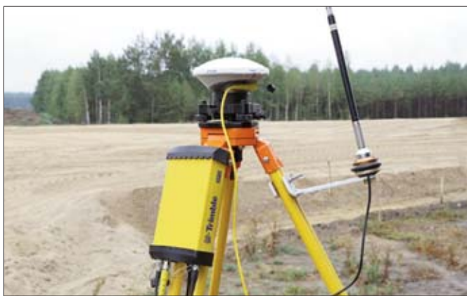
Zasadniczymi elementami urządzenia SPS855 jest odbiornik GNSS z radiem oraz antena zewnętrzna. Dzięki wykorzystaniu technologii Trimble Autotrack, każdy z pracowników budowy może dokonać codziennej konfiguracji takiej stacji referencyjnej tylko przy użyciu jednego przycisku
