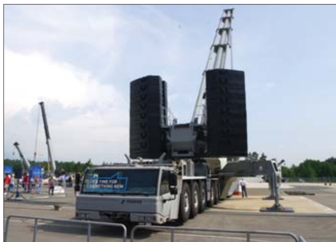
Najnowszy dźwig Tadano odznacza się bardzo zwartą konstrukcją. Dzięki temu może dojechać i pracować w bardzo ciasnych miejscach
