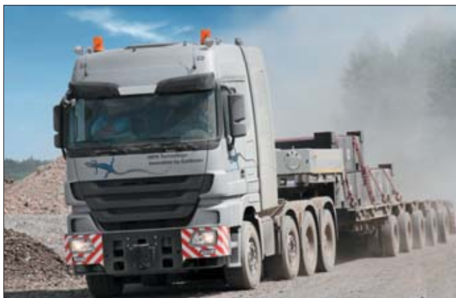
Bezobsługowe osie MPA stosowane w naczepach Goldhofer pozwalają osiągnąć kąt skrętu kół równy 60° i skok zawieszenia wynoszący 350 mm
