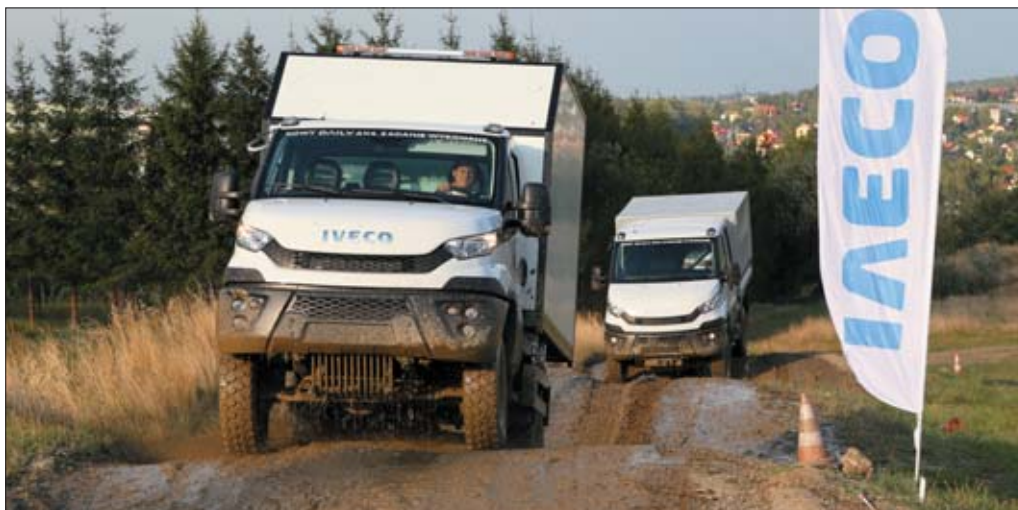
Stalowy zderzak nowego Daily 4x4 bez trudu poradzi sobie z przyzmami piachu czy śniegu, a jeśli dojdzie do jego uszkodzenia, to naprawa nie będzie droga, ponieważ jest on trzyczęściowy
