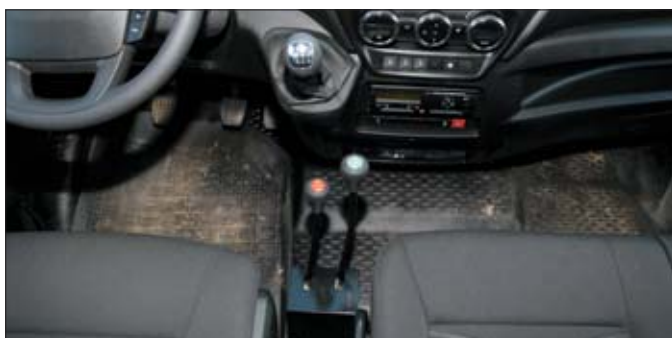
Oba reduktory zastosowane w Daily 4x4 są obsługiwane za pomocą dwóch dodatkowych dźwigni zamontowanych z prawej strony fotela kierowcy
