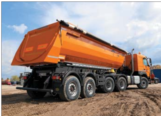
Prezentowana naczepa F.X. Meiller ma skrzynię wykonaną ze stali Hardox 450 o pojemności 25 m 3 . Grubość ścian wynosi pięć, a podłogi osiem milimetrów
