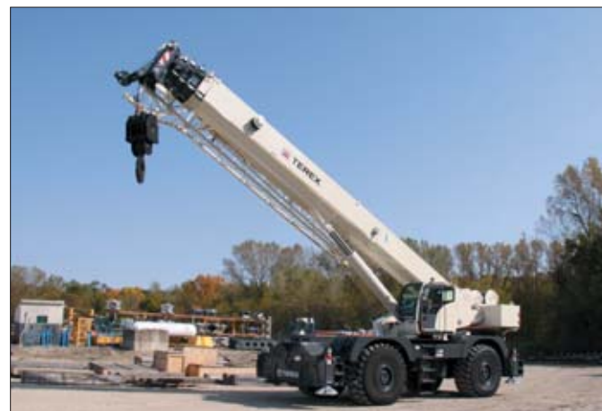
Żurawie samojezdne TEREX Quadstar są przeznaczone do pracy w trudnych warunkach terenowych. Prezentowany model Quadstar 1100 po zamontowaniu przedłużek zapewnia maksymalny wysięg ponad 67 metrów
