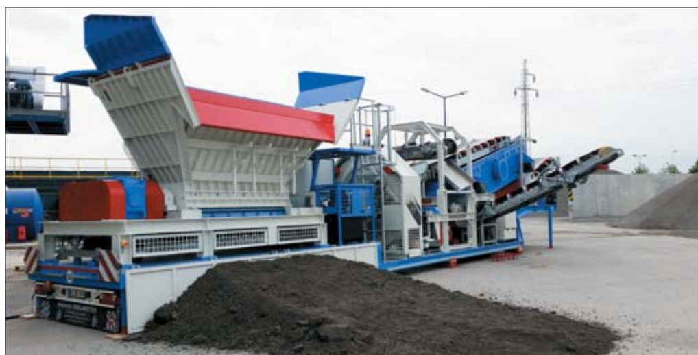
Wstępne rozdrobnienie materiału odbywa się pomiędzy specjalnym profilem łamacza, a ścianą kosza zasypowego. Napęd bębna frezującego granulatora Benninghoven MBRG 2000 został skonstruowany w sposób, który umożliwia użytkownikowi bezproblemowe uruchomienie maszyny nawet przy w pełni załadowanym koszu
