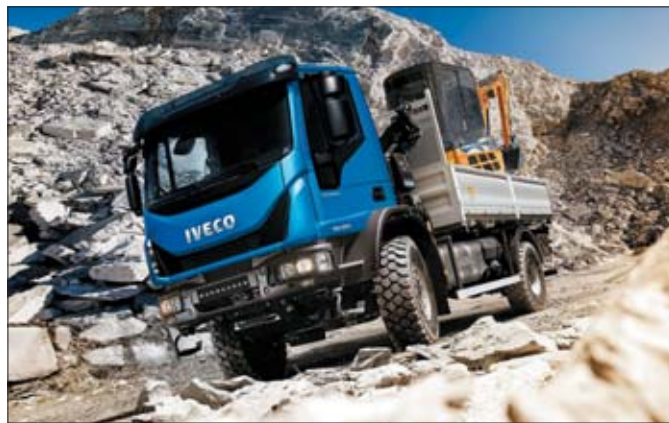
Imponujący kąt skreślenia kół nowego Eurocargo 4x4 (od 40 do 48 stopni w zależności od zastosowanego ogumienia) ułatwia manewrowanie na placu budowy w terenie miejskim
