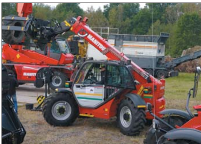
Kopalnianą wersję ładowarki już na pierwszy rzut oka rozpoznać można po oznakowaniu żółtą folią odbłaskową i stopniach wejściowych
