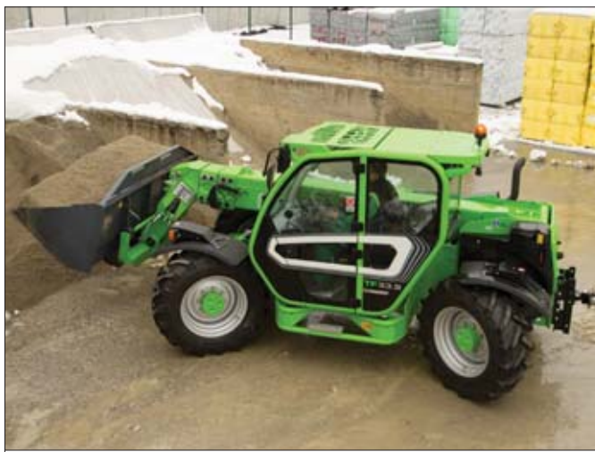
Ładowarki gamy Turbofarmer Medium Duty z silnikiem o mocy 120 KM będą standardowo wyposażane w nowe chłodnice poziome Fan-Drive z funkcją odwrotnego ciągu wentylatora dla łatwego czyszczenia wymiennika ciepła
