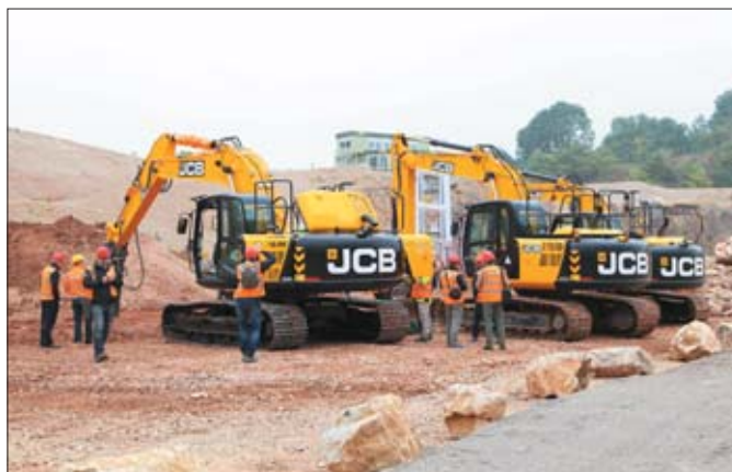
Ciężkie koparki gąsienicowe JCB spełniają normy emisji spalin Tier 4 Final/Stage IV bez filtra cząstek stałych – tylko przy zastosowaniu układu SCR i katalizatora utleniającego DOC
