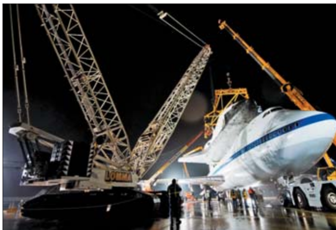
Żurawie TEREX w klasie udźwigu 650 ton znajdują zastosowanie przy najcięższych, a zarazem najbardziej spektakularnych zadaniach, jak np. posadowienie wahadłowca na grzbiecie Jumbo Jeta
