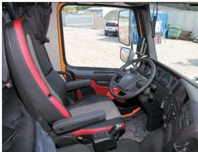
W takim wnętrzu aż chce się pracować. Skrzynia biegów I-Shift jest obsługiwana za pomocą niewielkiego drążka z prawej strony fotela kierowcy
