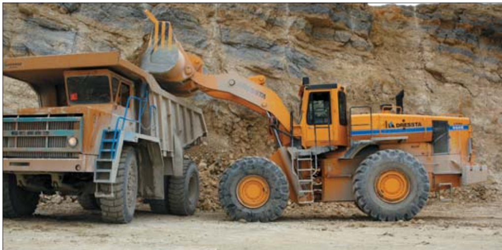
W Zakładzie Górniczym Cementowni „Małogoszcz” stosuje się metodę urabiania skał z wykorzystaniem robót wiertniczo-strzałowych. Skruszona skała ładowana jest na czterdziestotonowe wozidła przy pomocy ładowarek kołowych
