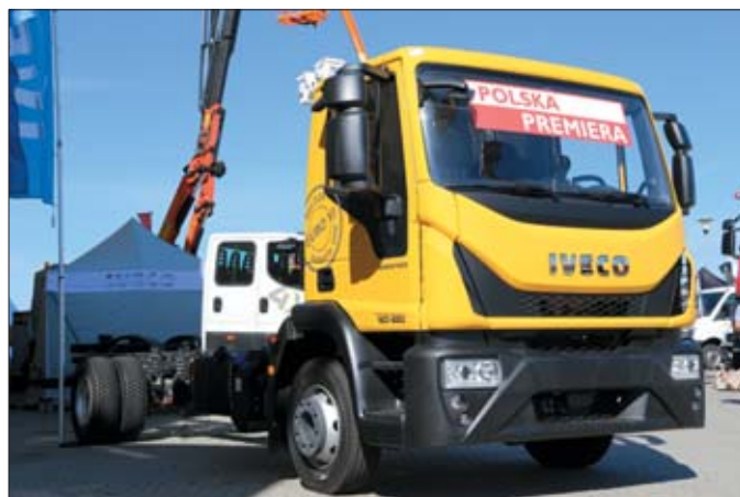
Nowy Eurocargo łatwo rozpoznać po szerokim uśmiechu i przeprojektowanych deflektorach, które lepiej zapobiegają brudzeniu się klamek drzwi
