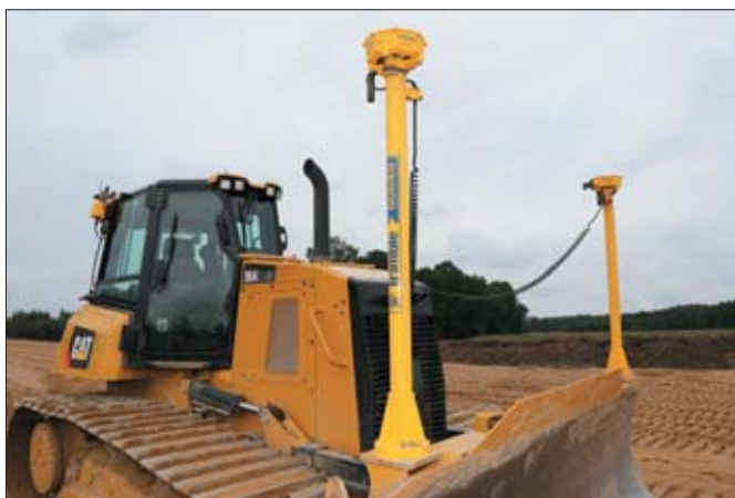
Zastosowanie dwóch anten pozwala na błyskawiczne wyznaczanie pozycji lemiesz, a tym samym szybszą pracę maszyny. Oba odbiorniki są wyposażone w zaawansowany procesor Trimble RTK skracający czas inicjalizacji systemu oraz polepszający jego działanie w pobliżu przeszkód
