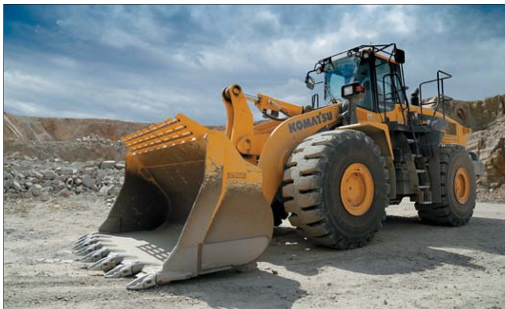
Testowana w Doboszowicach ładowarka kołowa Komatsu WA500-7 to maszyna do ciężkich zastosowań. Kolos Komatsu o masie eksploatacyjnej 35 ton napędzany jest najnowszą generacją silnika o mocy 362 KM
