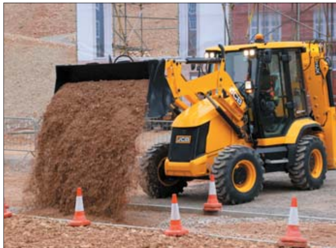
Całkowicie nowa koparko-ladowarka JCB 3CX Compact ma obie osie skrętne i jest 35% mniejsza od modelu 3CX, co rozszerza jej zastosowanie w miejscach niedostępnych dla typowych maszyn tego typu
