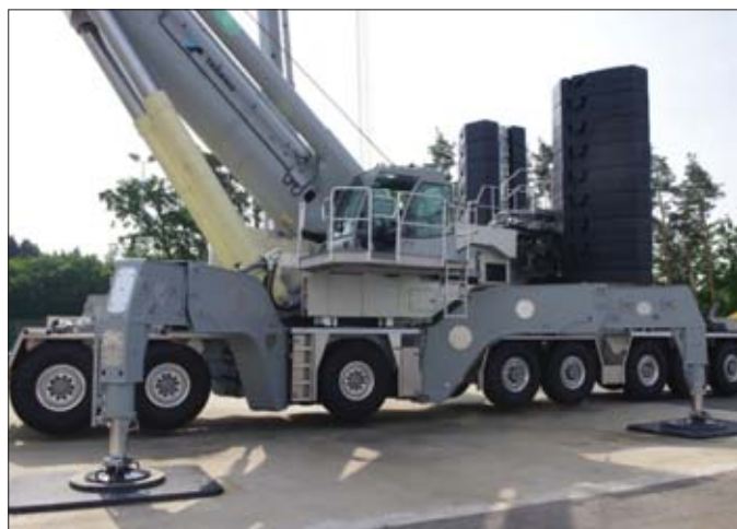
Triple-Boom-System to rewolucja w branży dźwigowej chroniona licznymi patentami. Wzmacnia on główne ramię dźwigu, czyli zwiększa udźwig
