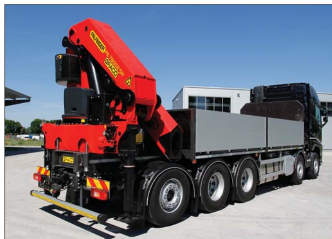
Firma Graco wyposażyla podwozie Volvo FH w przestronną skrzynię ładunkową. Jej dzielone burtę wykonano z aluminium, a podłogę wyłożono wodoodporną sklejką
