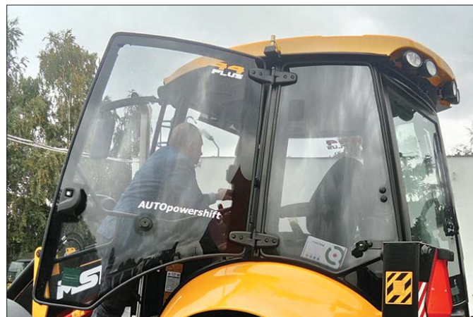
Duża powierzchnia przeszkleń kabiny, klimatyzacja, pneumatycznie zawieszony fotel i joysticki zamiast dźwigni zdecydowanie poprawiają komfort pracy operatora
