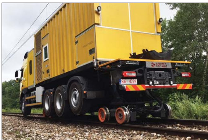
Kompleksy zgrzewające KCM 007 umieszczone na pojazdach specjalnych dwudrogowych o roboczej nazwie ZDS-7 K poddane zostały całemu szeregowi testów
