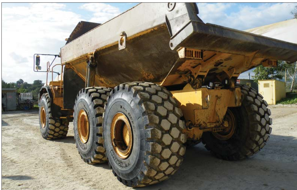
W oponie MICHELIN X-TRA DEFEND zastosowano specjalny bieżnik o zwiększonej głębokości, w którym ilość gumy przeznaczonej do zużycia jest większa niż w konkurencyjnych produktach
