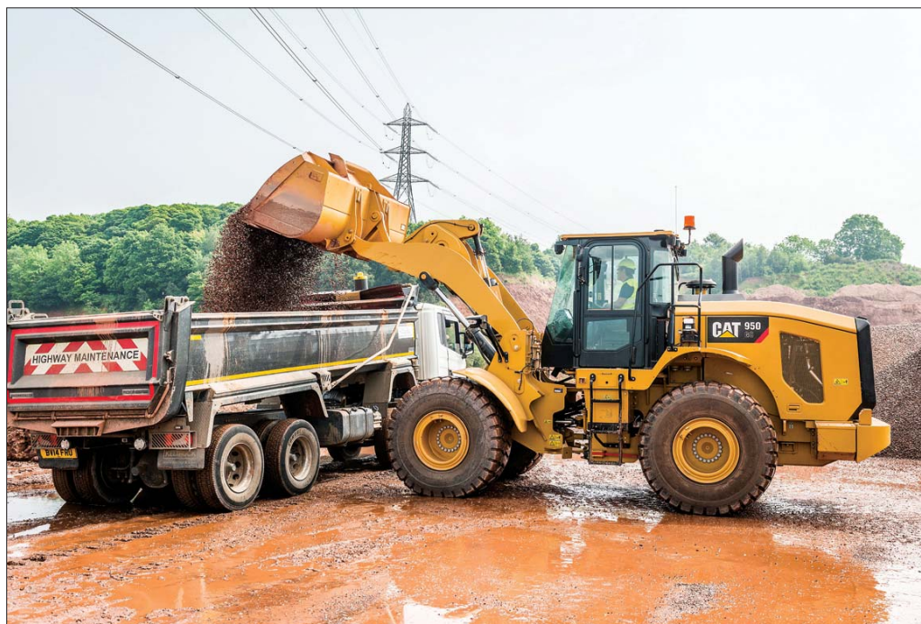
Ładowarka 950 GC wyróżnia się najlepszą w swojej klasie wysokością sworznia przegubu łyżki oraz prześwietlonym ramieniem wysięgnika, co ułatwia załadunek pojazdów ze skrzyniami o wysokich burtach
