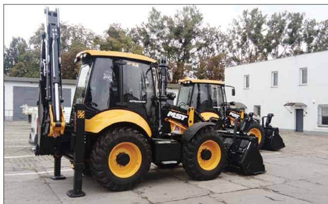
Ramiona wysięgników ładowarkowego i koparkowego imponują solidnością wykonania. Dzięki wzmocnieniu profili bocznych elementy te zyskały wyższą odporność
