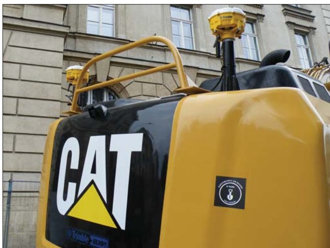
Poza czujnikami kontrolującymi wraz z żyroskopem położenie ramienia i łyżki koparki, w skład systemu wchodzi dwa odbiorniki umieszczone w tylnej części maszyny
