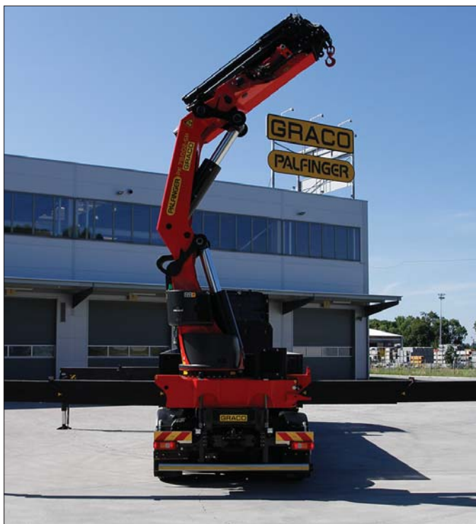
Zakres obrotu urządzenia jest nieograniczony, co oznacza możliwość wielokrotnego obracania kolumny w jedną stronę bez konieczności ruchu powrotnego
