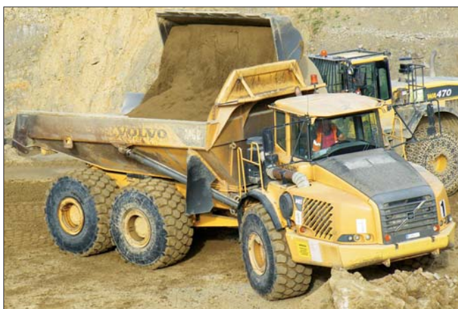
Eksploatowane w ŚKSM Sp. z o.o. wozidło Volvo A40, pracuje niezwykle intensywnie, przewozi urobek w wyjątkowo ciężkich warunkach terenowych
