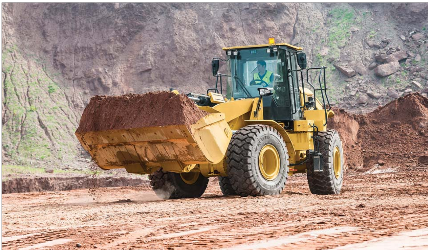
Konstrukcja ładowarki Cat 950 GC łączy w sobie wydajność i łatwość obsługi z niezawodnością i trwałością. Możliwość wykorzystania szerokiej gamy osprzętu roboczego sprawia, że maszyna znajduje bardzo dużo możliwości zastosowań w robotach ziemnych i przemyśle wydobywczym
