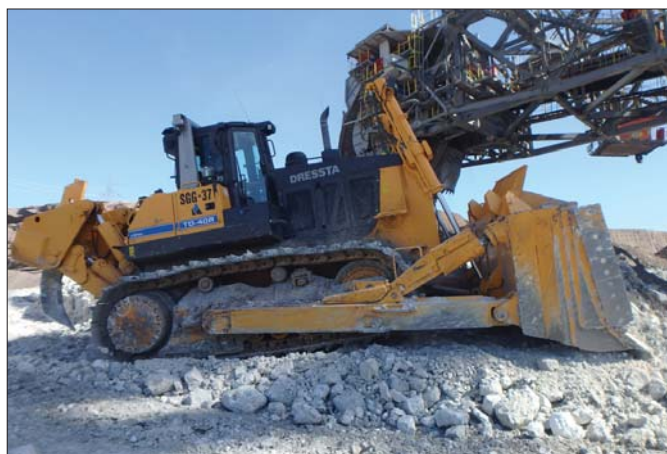
Odpowiednio wyposażone „czterdziestki” doskonale radzą sobie z urabianiem wapiennego podłoża broniącego dostępu do warstw węgla brunatnego
