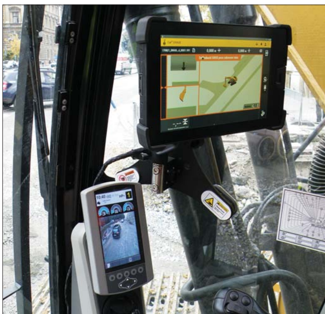
System Earthworks umożliwia bezprzewodowe, automatyczne przesyłanie danych, które są natychmiast widoczne na dużym, dziesięciocalowym, dotykowym ekranie
