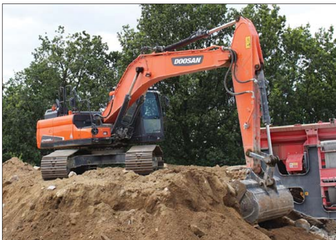
Maksymalny zasięg kopania Doosana DX255LC-5 wynosi ponad dziesięć metrów, a głębokość 6,81 metra. To jedno z lepszych parametrów w tej klasie maszyn
