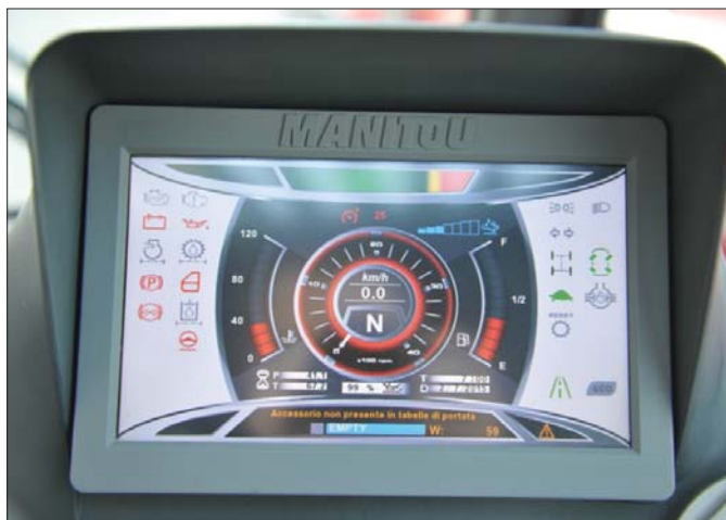
Możliwość korzystania ze wskazań pojawiających się na dużym, czytelnym ekranie w znacznym stopniu ułatwia pracę operatora ładowarki
