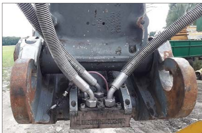
Zalety systemu Likufix stają się szczególnie widoczne, gdy operator maszyny korzysta z wielu narzędzi roboczych
