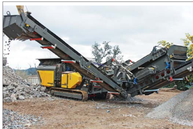
Ważąca zaledwie 29 ton kruszarka RM 100GO! imponuje cichą pracą, mocą i wydajnością. W ciągu godziny jest w stanie poradzić sobie z nawet 250 tonami materiału
