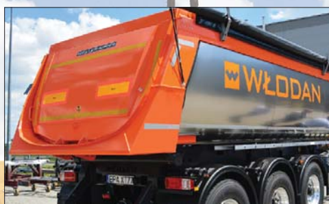
◀ 50. Termoizolowana wywrotka MEILLER do budowy dróg
