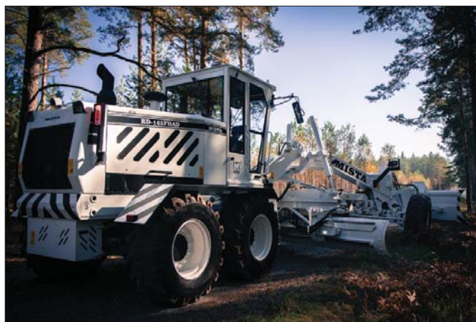
Hydrostatyczny układ napędu jazdy na wszystkie koła jest wprost nieodzowny podczas wykonywania zadań wymagających utrzymywania stabilnej prędkości
