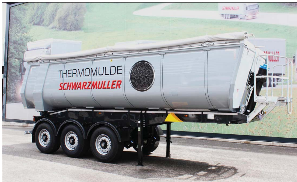
Do przewożenia płynnej masy bitumicznej Schwarzmüller oferuje trzyosiową naczepę wywrotkę z poszyciem termoizolacyjnym. Pojazd, którego ramę i skrzynię wykonano w całości z aluminium, cieszy się bardzo dobrą opinią użytkowników
