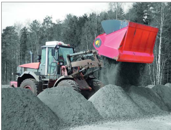
Za pomocą łyżki ALLU zamontowanej na ładowarce operator może jednocześnie przesiewać, kruszyć, mieszać i rozdrabniać urobek
