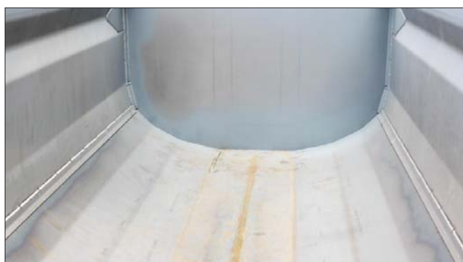
Podłogę skrzyni ładunkowej wzmocniono stalową powłoką. Rozwiązanie to pozwala na wykorzystywanie pojazdu do transportu kruszywa czy odpadów po frezowaniu nawierzchni
