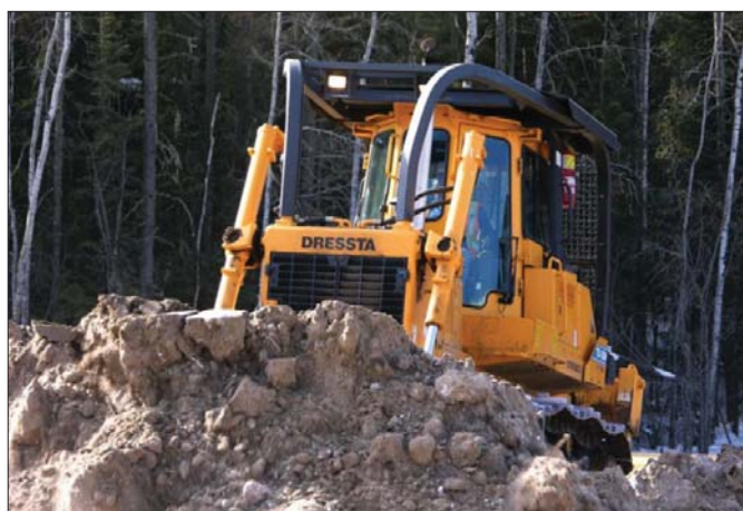
Spycharka TD-20 dostępna jest w kilku wariantach. W wersji podstawowej maszyna ma masę eksploatacyjną 24,2 tony i jest napędzana silnikiem o mocy 240 KM
