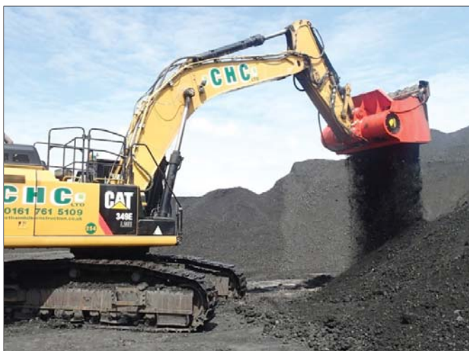
Łyżki przesiewająco-kruszące stosowane na wszelkiego rodzaju koparkach hydraulicznych imponują skutecznością i ekonomiczną eksploatacją
