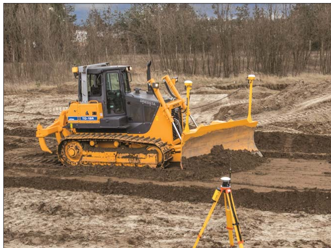
Spycharka TD-15R Extra wyposażona w system sterowania pracą Trimble to najnowszy spośród „średniaków” produkowanych w Stalowej Woli
