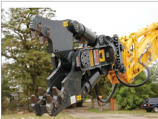
Nożyce MA 25 wyróżniają się niekonwencjonalną budową umożliwiającą bardzo głęboką penetrację elementów konstrukcyjnych już na pierwszym etapie wyburzeń
