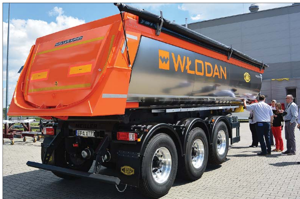
Skrzynia wywrotki jest całkowicie izolowana, jej spód i boki pokryte zostały piankami hydrofobowymi. Wykonane ze stali szlachetnej zewnętrzne pokrycie muldy ze stali szlachetnej podzielono na segmenty, co ułatwia dostęp do czujników temperatury
