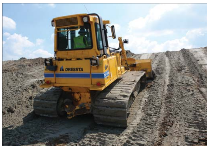
Maszyna TD-14M Extra na podwoziu w wersji LGP i z zamontowanym lemiem uniwersalnym (6-way) z łatwością radzi sobie ze wzniesieniami terenu
