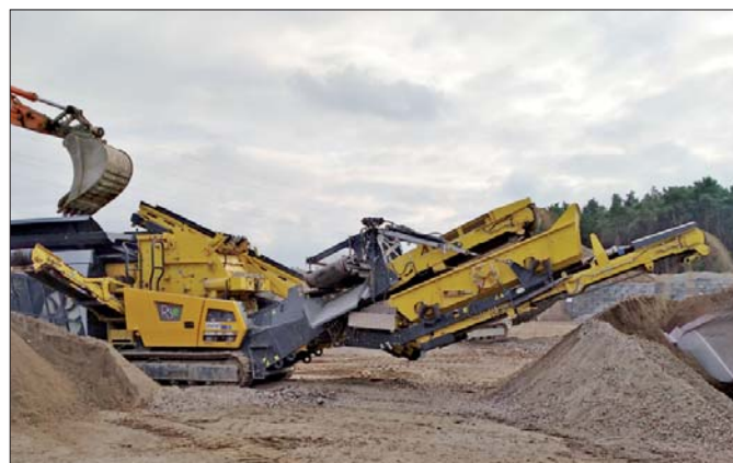
Dzięki zastosowaniu innowacyjnego układu napędowego oraz elektrycznych przenośników i przesiewaczy kruszarki Keestrack wyróżniają się niskimi kosztami utrzymania
