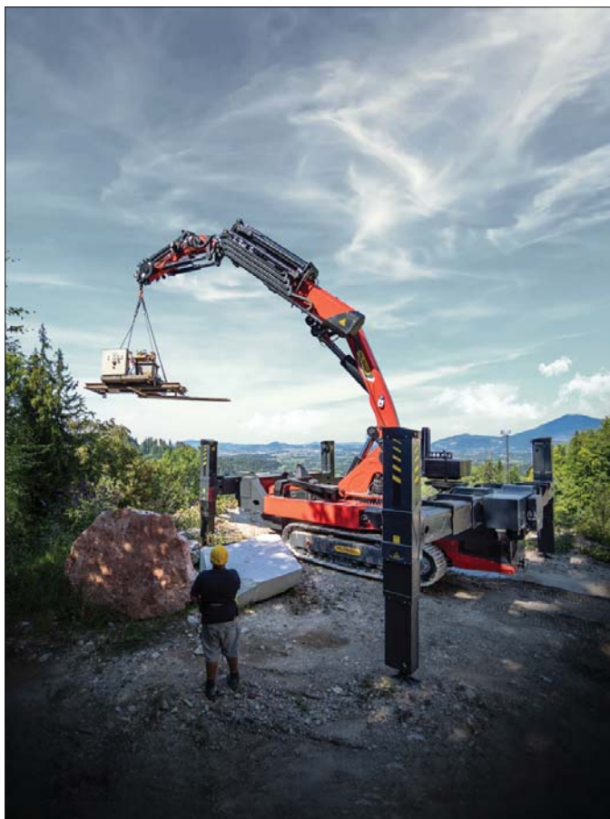
Podczas wykonywania prac w trudnym terenie, w zależności od szerokości rozstawienia podpór, można zniwelować różnice wzniesień od 8 do nawet 20 stopni
