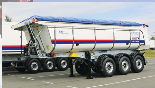
Naczepa termiczna Schmitz Cargobull S.KI 48. ▶
