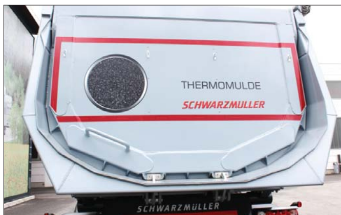
Tylna kłapa jest otwierana automatycznie podczas wywrotki. Masa bitumiczna może też trafiać do rozścielacza przez specjalny otwór spustowy
