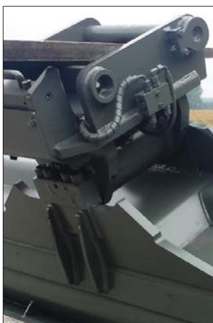
Likufix jest w pełni automatycznym systemem szybkiej wymiany osprzętu
