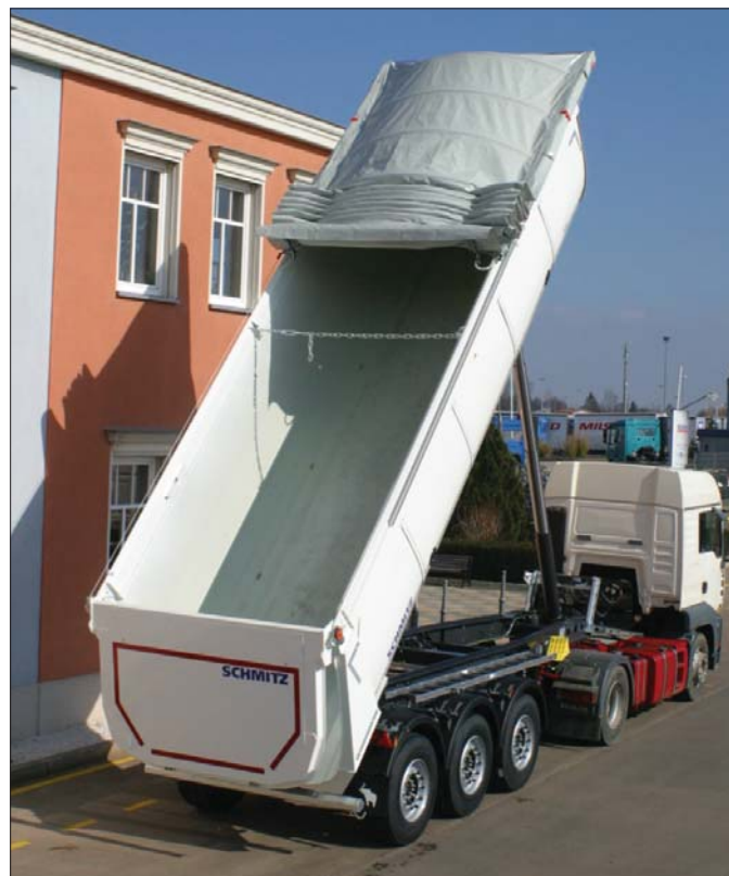
Zredukowanie wysokości całkowitej pozwoliło obniżyć środek ciężkości pojazdu, co poprawiło stabilność jazdy oraz bezpieczeństwo w fazie wywrotu
