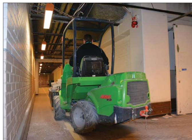
Atutem elektrycznego napędu jest zerowa emisja spalin, co pozwala na pracę w zamkniętych pomieszczeniach i miejscach, gdzie wymagana jest niska emisja hałasu
