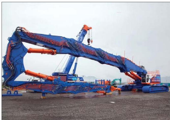
Konstruktorzy koparki wyburzeniowej SK3500D zbudowali ją na bazie całkowicie zmodyfikowanego, ważącego dwieście ton mobilnego żurawia gaśnicowego Kobelco
