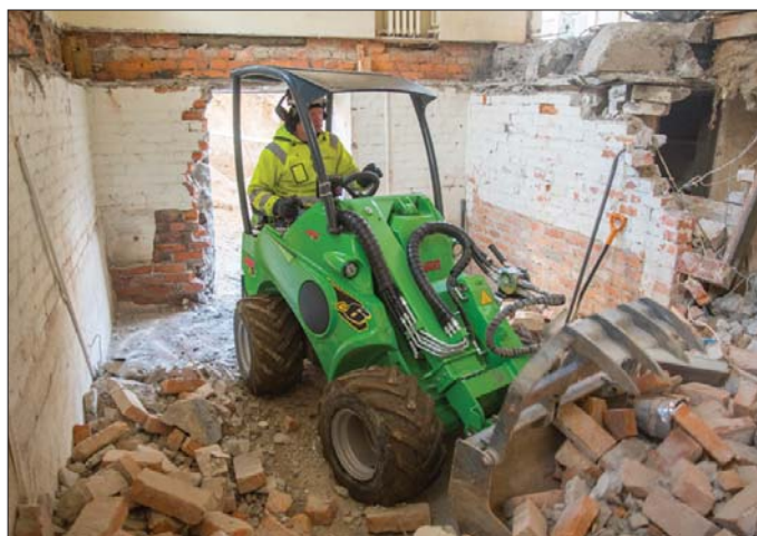
Maszyny wyróżnia montaż siedziska i panelu obsługowego do przedniej osi, dzięki czemu operator ma bardzo dobrą widoczność na cały obszar roboczy
