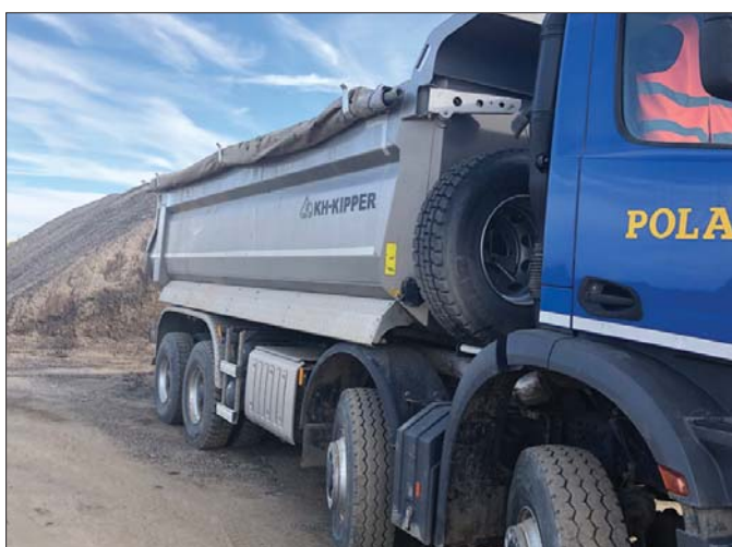
Umieszczenie koła zapasowego za kabiną, zamiast na przedniej burcie, sprawia że nie podnosi się ono razem ze skrzynią podczas wyładunku
