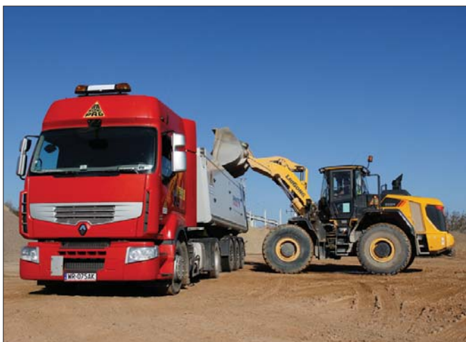
Ładowarka obsługująca należącą do PRD Kutno wytwórnię mas bitumicznych wyposażona została w łyżkę o pojemności 3,3 m 3
