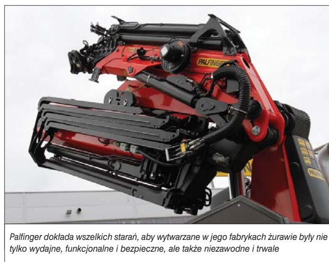
Palfinger PK65002 SH – jeden z większych żurawi oferowanych przez firmę Graco – został zabudowany na podwoziu Volvo FH 16 500. Ponieważ podstawa żurawia została zintegrowana z ramą pośrednią pojazdu, wysokość transportowa zestawu nie przekracza czterech metrów
