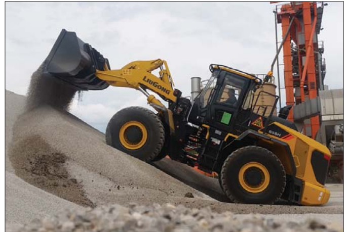
Ładowarka wyposażona została w zmodernizowany wysięgnik typu „Z”, zaawansowany system hydrauliczny oraz elastyczną przekładnię Powershift
