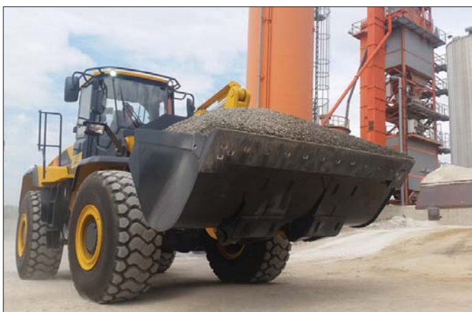
Aby zapobiec „galopowaniu” maszyny i wysypywaniu się ładunku, operator może podczas przejazdów korzystać z układu automatycznej amortyzacji łyżki
