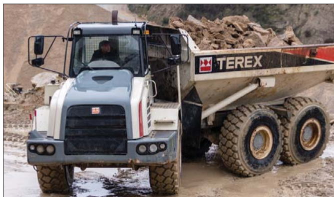
Opona Galaxy HTSR 400 skonstruowana została z myślą o zastosowaniu w wozidlach transportujących ciężkie ładunki w ekstremalnych warunkach terenowych
