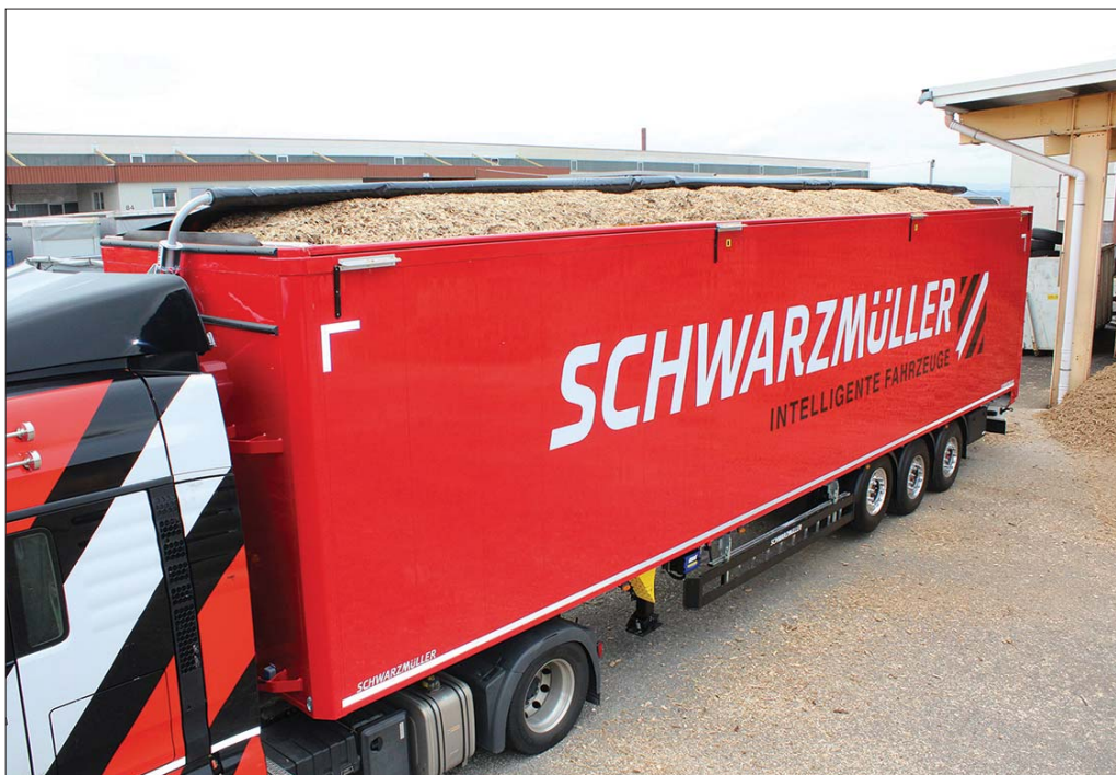
Do sieci sprzedaży firmy Schwarzmüller trafiła ostatnio zmodyfikowana naczepa z ruchomą podłogą. Oprócz stosowanego dotychczas hydraulicznie sterowanego dachu, wprowadzono teraz również wersję elektryczną
