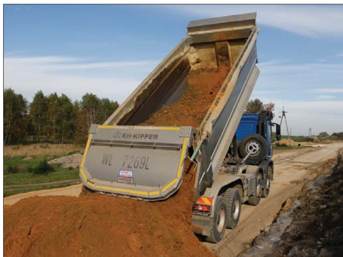
Pochylna przednia burta zabudowy oraz unikatowy kształt u-shape ułatwia optymalny wyładunek. Lepki materiał nie przykleja się do burty przedniej i łatwiej się zsypuje
