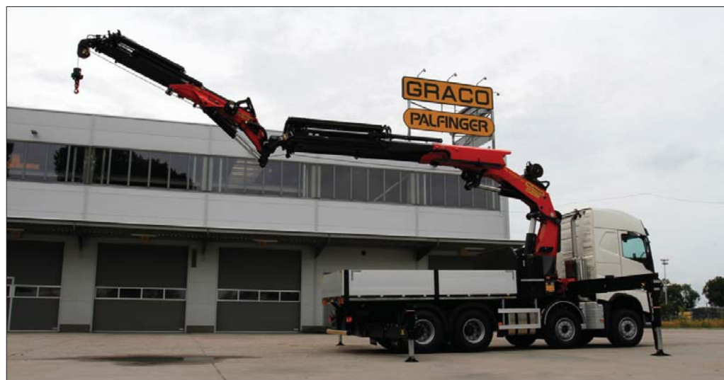
Palfinger PK65002 SH – jeden z większych żurawi oferowanych przez firmę Graco – został zabudowany na podwoziu Volvo FH 16 500. Ponieważ podstawa żurawia została zintegrowana z ramą pośrednią pojazdu, wysokość transportowa zestawu nie przekracza czterech metrów
