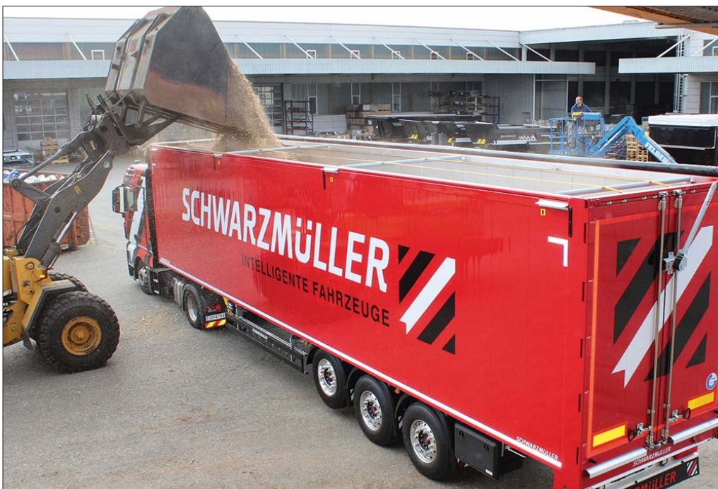
Elektrycznie sterowany składany dach naczepy jest otwierany i zamykany za pomocą pilota zdalnego sterowania. Załadunek i rozładunek odbywa się więc wygodnie przez naciśnięcie klawisza
