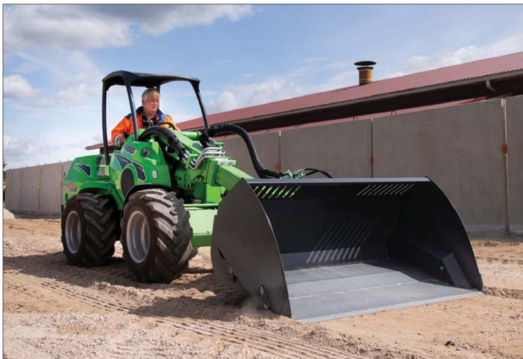
Avant stosuje liczne rozwiązania techniczne niespotykane w ładowarkach innych producentów. Przemysłowa przegubowa konstrukcja, sprawiająca że operator zajmuje miejsce w przedniej części maszyny i ma doskonały widok na osprzęt i obszar roboczy
