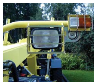
Światła maszyn pracujących w lasach są zabezpieczone przed uszkodzeniem
