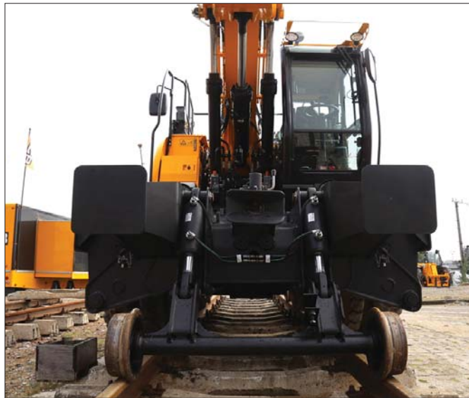
Wózki, zderzaki, w jakie wyposażono maszynę, sprawiają, że pracując na torach staje się ona specjalistycznym pojazdem kolejowym
