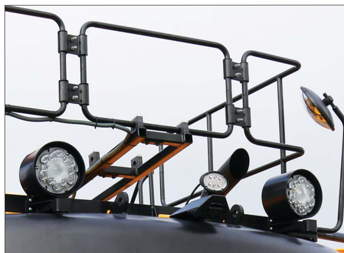
Maszyna pracująca na otwartym torze musi być wyposażona w przewidziane przepisami specjalne oświetlenie robocze dla pojazdów kolejowych
