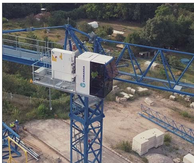
Istotną innowacją w nowej generacji żurawi Comansa jest zmodernizowana, zintegrowana ze zmienioną i przeprojektowaną platformą kabina CUBE w rozmiarze „M”
