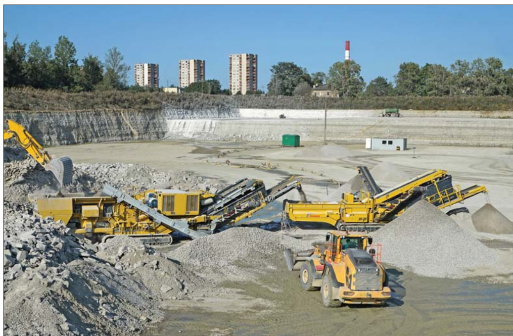
W pełni elektryczny zakład przesiewająco-kruszący Keestrack eksploatowany jest na wyrobisku, które przesuwa się coraz bliżej w kierunku liczącej aż sto dwadzieścia tysięcy mieszkańców dzielnicy mieszkaniowej Lasnamäe w Tallinie
