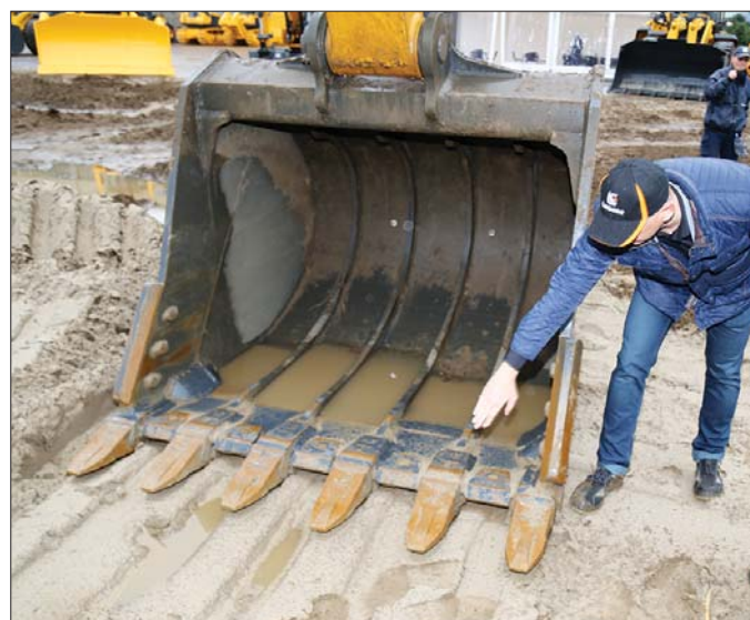
Niezwykle istotną kwestią dla wydajności maszyny jest dobór osprzętu. Podczas pokazów koparka 950E pracowała z łyżką skalną o specjalnej konstrukcji
