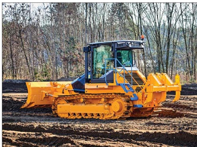
TD-16N jest jedyną spycharką w swojej klasie z „bezgąsienicowym” dostępem do kabiny. Stopnie ułatwiają też dostęp do punktów obsługi serwisowej
