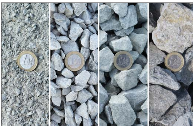
Bezpośrednio na wyrobisku tallińskiego kamieniołomu produkowane jest kruszywo w czterech frakcjach: 0/4, 4/16, 16/32 oraz 32/63
