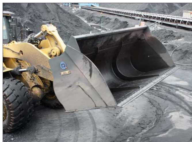
Łyżki skonstruowane z myślą o zastosowaniu w Porcie Północnym mają imponujące parametry, każda z nich może pomieścić aż jedenaście tysięcy litrów ładunku
