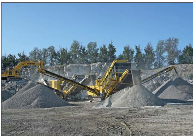
Przesiewacz C6e dzięki pojemnemu koszowi zasypowemu oraz wytrzymałemu podawaczowi i szerokiemu przenośnikowi taśmowemu wyróżnia się optymalną wydajnością
