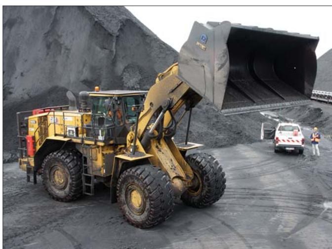
Wyzwaniem dla konstruktorów było zwiększenie pojemności łyżki przy jednoczesnym zachowaniu jej wagi. Chodziło o to, by zredukować liczbę przejazdów ładowarek
