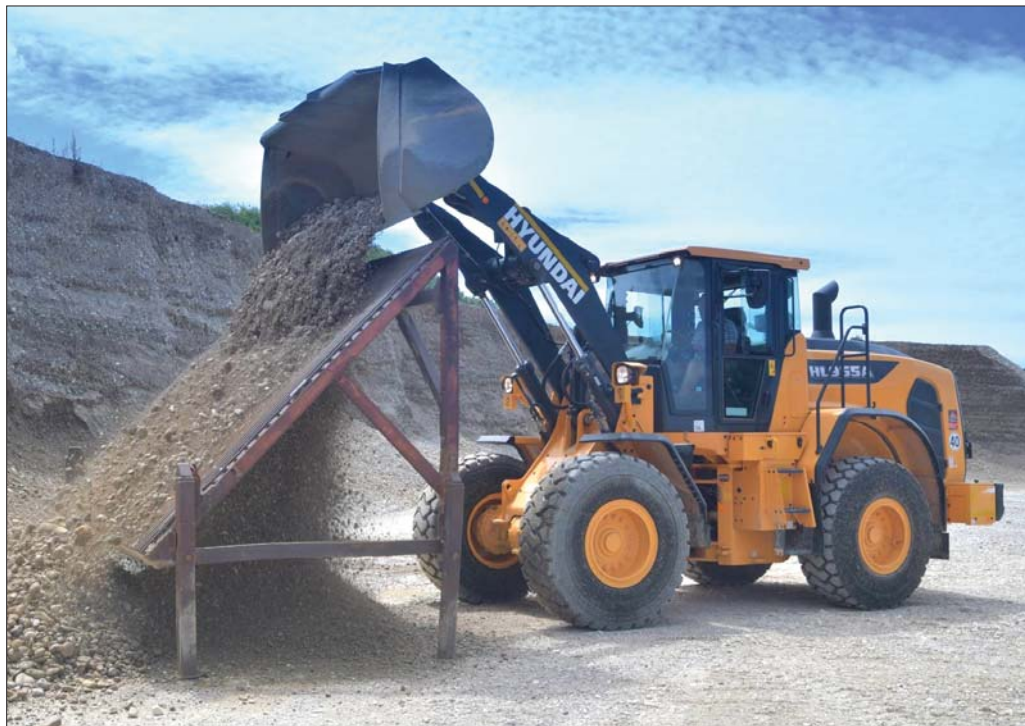
Cieżar roboczy ładowarki HL955 wynosi piętnaście ton, co pozwala dodatkowo zwiększyć stopień jej wykorzystania. Parametr ten sprawia, że łatwo przewozić ją na przyczepie niskopodwozowej bez konieczności uzyskania specjalnych pozwoleń
