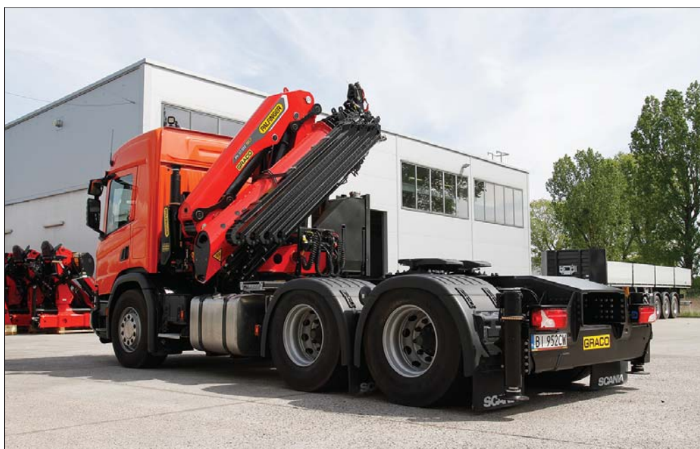
Jednym z bardziej nietypowych zleceń realizowanych przez Graco była instalacja żurawia Palfinger PK 37.002 TEC 7 na trzyosiowym ciągniku siodłowym Scania XT P400 w zestawie z naczepą do transportu materiałów budowlanych
