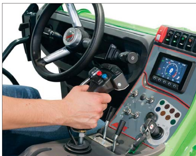
W wyposażeniu ładowarki Avant 860i znajduje się wielofunkcyjny wyświetlacz z informacjami o obrotach silnika, godzinach pracy czy zużyciu paliwa
