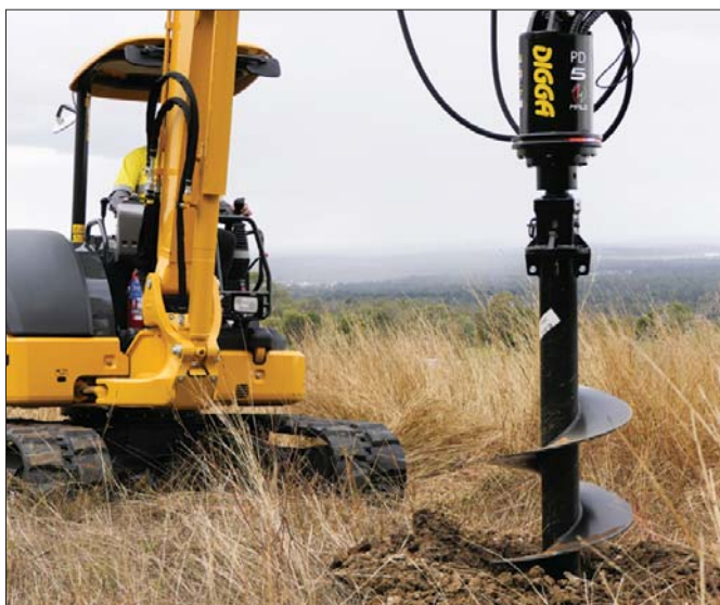
Operator korzystający z naprowadzania HALO może być pewien, że wykonywany odwiert będzie równomierny i prosty na całym swoim przebiegu
