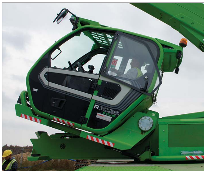
Obrotowa kabina to unikatowe rozwiązanie stosowane tylko w ładowarce Merlo. Ułatwia operatorowi pełną kontrolę ładunku na każdej wysokości
