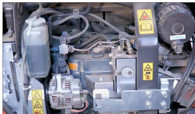
Zasilane gazem LPG nowej generacji silniki Kubota Spark Ignition są identyczne, jak minikoparki KX019-4 z silnikiem Diesla rozwijającym moc 16 KM
