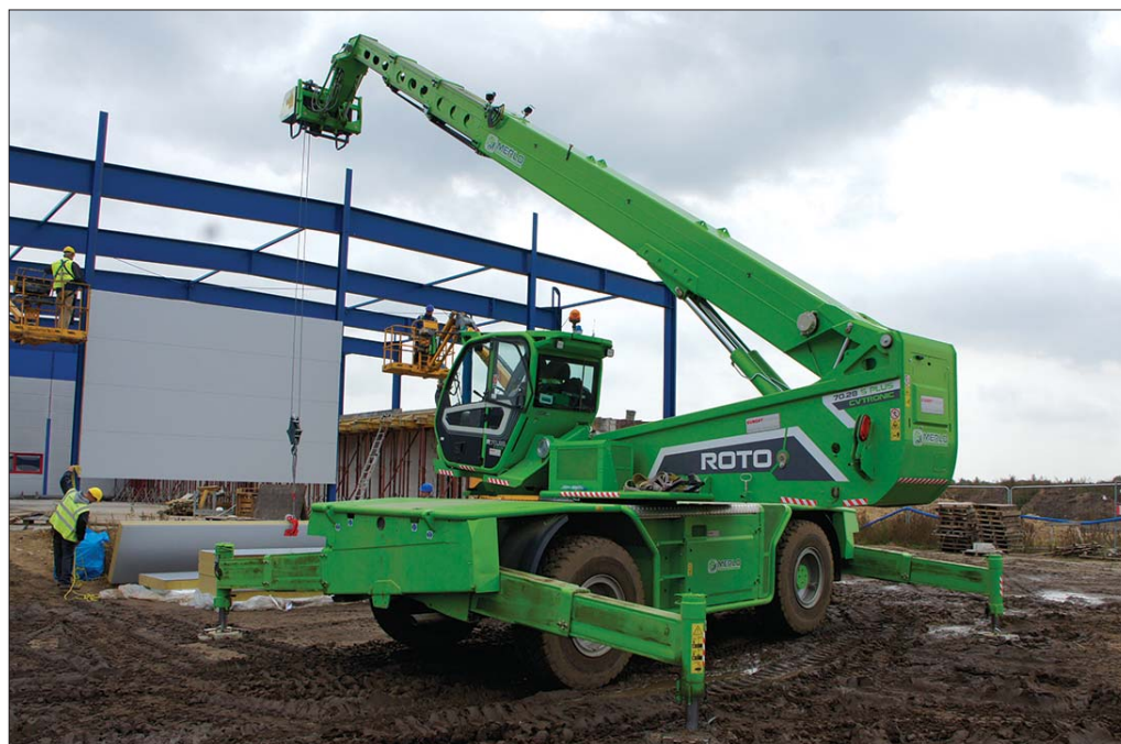
Imponujący udźwig i zasięg umożliwia operatorowi ładowarki teleskopowej Merlo ROTO70.28S Plus-CVTronic transport ładunków ważących nawet 7 ton na wysokość dochodzącą do 28 metrów
