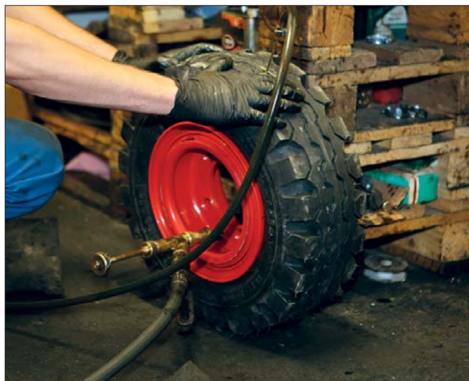
Elastomer zastępuje powietrze i sprawia, że opony stają się całkowicie odporne na oddziaływanie gwoździ, kołców, odłamków skalnych czy innych ostrych przedmiotów
