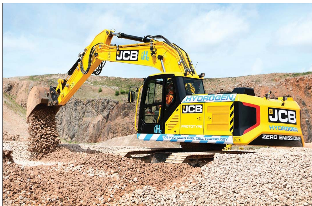
Prototypowa dwudziestotonowa koparka 220X zasilana najnowszej generacji wodorowym ogniwem paliwowym przez ponad rok przechodziła testy praktyczne w jednym z brytyjskich kamieniołomów
