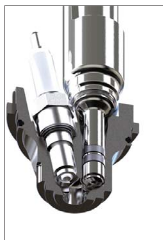
System aktywny wykorzystuje mały wtryskiwacz oraz świecę zapłonową
