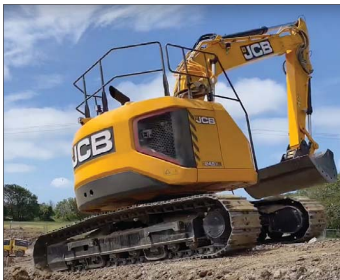
W standardzie nowa koparka została wyposażona we wzmacniane gąsienice o szerokości od 600 do 900 milimetrów
