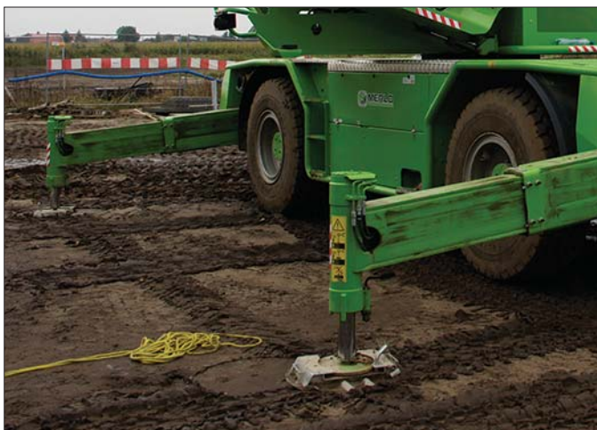
Zastosowany w ładowarce system podpór szybko przygotowuje ją do działania w nowym miejscu i umożliwia pracę w każdych warunkach terenowych
