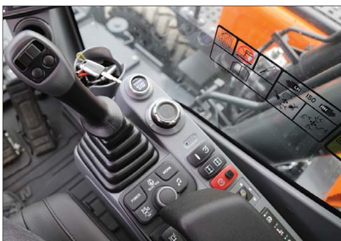
Jedną z opcji dodatkowych jest możliwość kierowania maszyną za pomocą pokrętła joysticka, bez użycia kierownicy, zarówno podczas pracy, jak i jazdy w trybie roboczym
