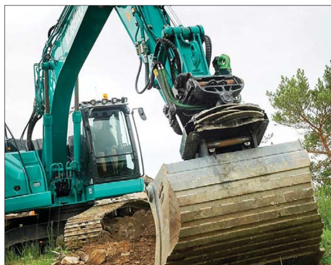
Głowice obrotowo-uchylne Steelwrist pozwalają pracować efektywniej i bezpieczniej, nie zaś dziwnego, że zdobywają sobie coraz więcej zwolenników
