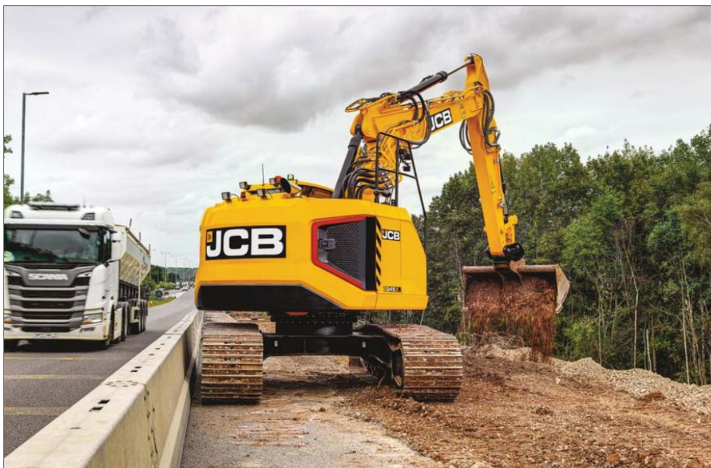
Koparka 245XR stanowi istotne wzbogacenie oferty ciężkich koparek JCB. Maszyna ze ściętym tyłem przeznaczona jest do wykonywania zadań na placach budowy o ograniczonej przestrzeni, na przykład pasach drogowych
