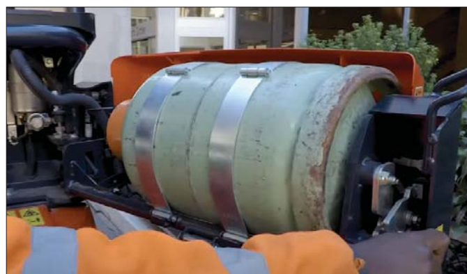
Niewątpliwą zaletą innowacyjnej koparki jest zastosowanie jako zbiornika paliwa standardowych powszechnie dostępnych butli gazowych
