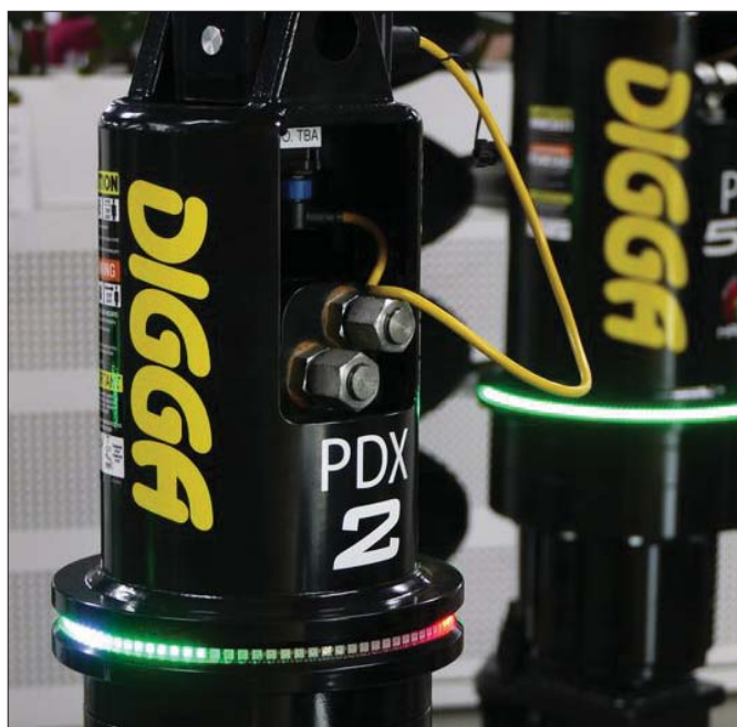
Pasek z diodami LED wkomponowany został w pierścień obudowy, dzięki temu przez cały czas jest świetnie widoczny dla operatora
