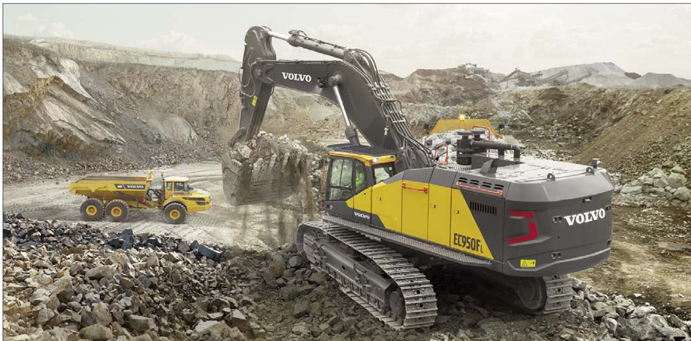
Potężna, dziewięćdziesięcotonowa koparka gąsienicowa Volvo EC950F jest przeznaczona do wykonywania najcięższych prac w ekstremalnie trudnych warunkach. Jej głównymi obszarami działania są kamieniołomy i kopalnie surowców skalnych
