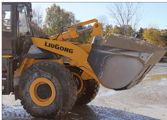
Zoptymalizowany wysięgnik typu „Z” wraz z odpowiednio dobraną łyżką zapewnią skrócenie cykli pracy, a tym samym podnosi wydajność ładowarki
