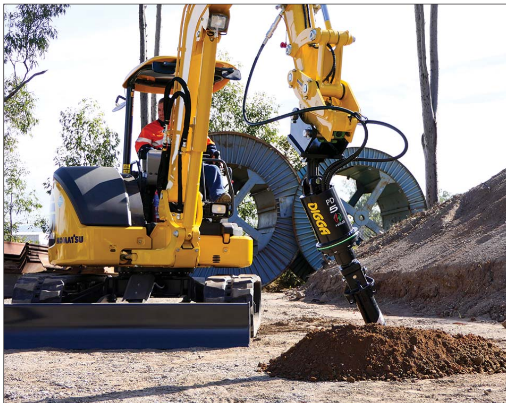
System HALO umożliwia utrzymanie prostego odwiertu pod wybranym kątem. Służy temu specjalna funkcja ZERO, dzięki której można dokonać ustawień napędu i wiertła, a następnie „wyzerować” położenie względem podłoża i korzystać z naprowadzania HALO
