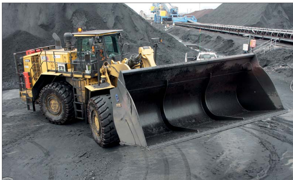
Na potrzeby prac wykonywanych na terenie Portu Północnego konstruktorzy Dekpol Steel zaprojektowali specjalistyczną łyżkę o dużej pojemności i zwiększonej odporności na trudne warunki robocze
