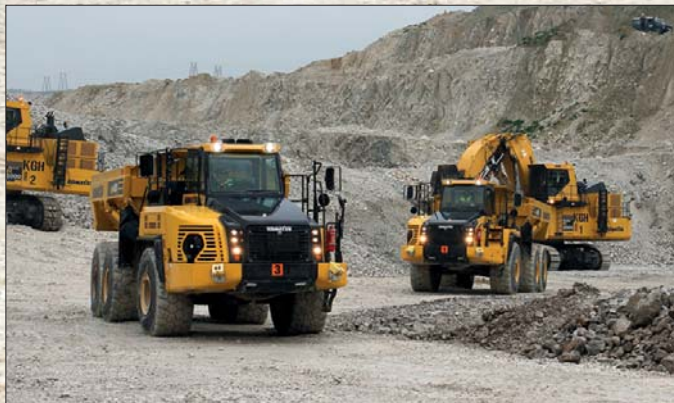
Bez transportu nie ma wydobywania, to żelazna zasada obowiązująca w każdej kopalni. Nie inaczej jest w Bełchatowie, gdzie wozidła przegubowe Komatsu HM400 niestrudzenie kursują po wyrobisku z ciężkim urobkiem
