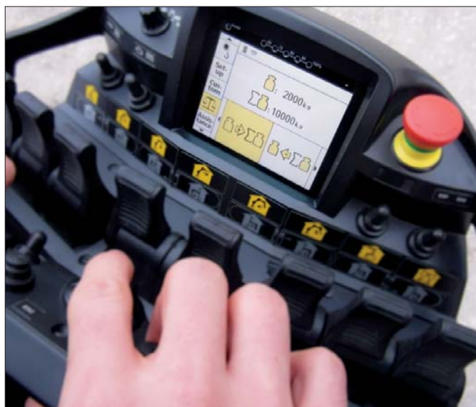
Dokładny ciężar przenoszonego ładunku pojawia się na czytelnym wyświetlaczu pilota zdalnego sterowania PALcom P7
