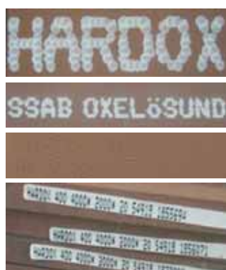
Znaki identyfikacyjne umieszczone na blachach produkowanych przez SSAB Oxelösund ułatwiają ich jednoznaczną identyfikację
