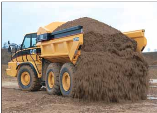
Wozidło Caterpillar 730 Ejector wyposażono w układ zsuwający materiał poza skrzynię ładunkową
