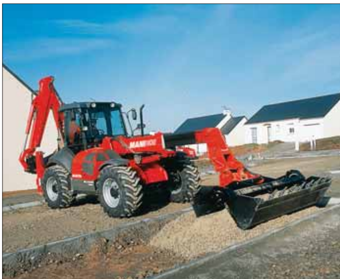
Koparko-ładowarka MANITOU MLB 625 T dzięki zastosowaniu teleskopu może przemieścić ładunek na wysokość powyżej pięciu metrów
