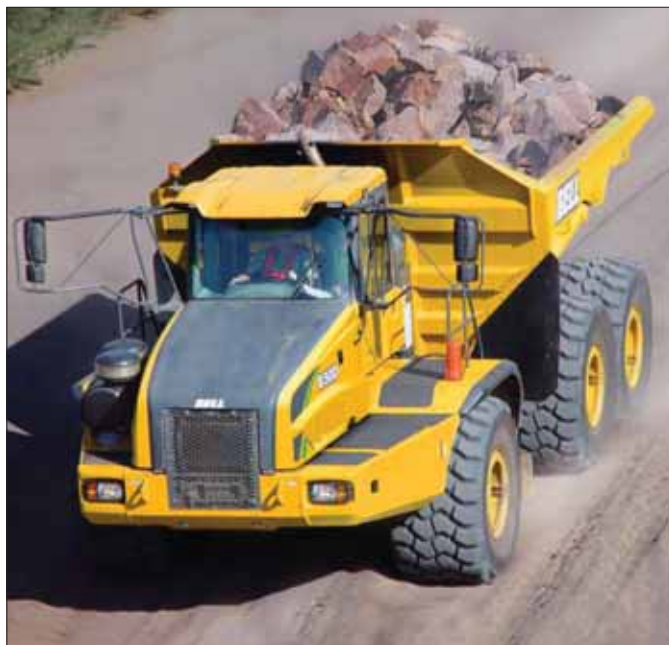
Bell może poszczycić się produkcją największego pod względem ładowności wozidła przegubowego. Pojazd oznaczony symbolem B50D może przewieźć ładunek o wadze 45,4 ton metrycznych i najprawdopodobniej długo jeszcze utrzyma status rekordzisty
