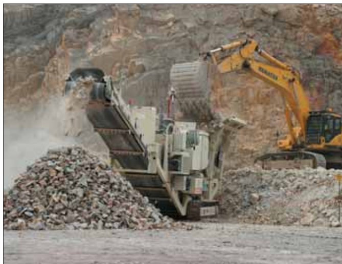
Jednym z głównych obszarów zastosowań przejezdnych instalacji kruszenia Lokotrack LT są produkcja kruszyw i górnictwo odkrywkowe
