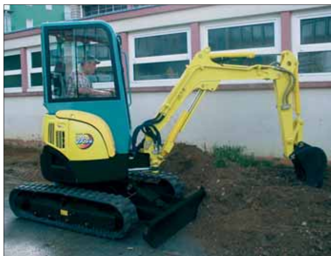
Minikoparka ViO25 w wersji z kabiną. Miejsce pracy operatora spełnia jedno z najbardziej restrykcyjnych norm bezpieczeństwa: ROPS, FOPS1 oraz TOPS
