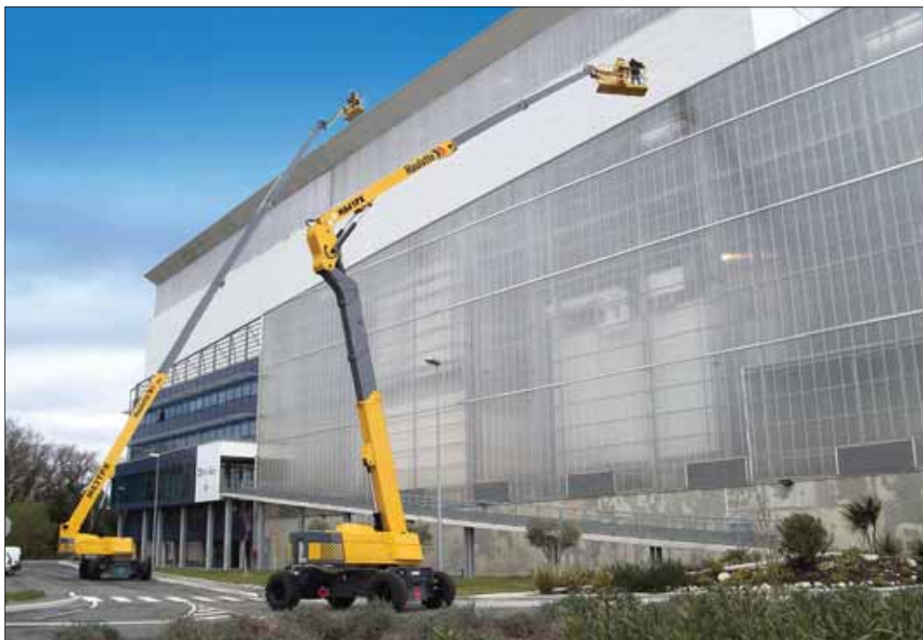
HA41PX o wysokości roboczej 41 metrów i H 43 TPX o wysokości roboczej 43 metrów to najwyższe produkowane przez Pinguely Haulotte podesty ruchome
