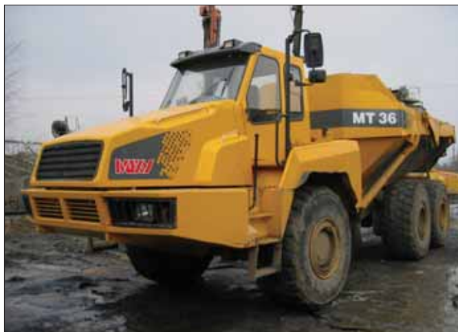
MT 36 jest rekordzistą w jeździe do tyłu. Wozidło produkowane przez Moxey może przemieszczać się wstecz z prędkością do 32 km/h. Walor ten ma szczególne znaczenie na specyficznych placach budowy, na których nie ma możliwości zawracania
