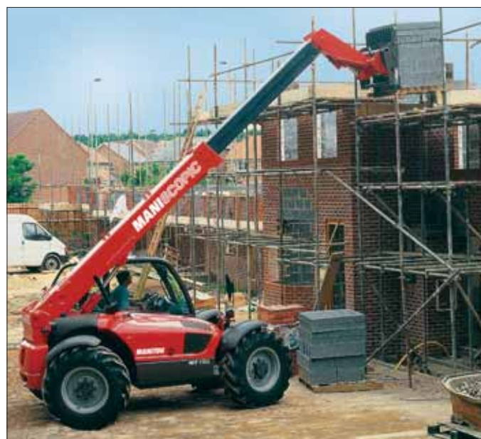
Manitou MT 732 dzięki zastosowaniu ramienia teleskopowego stała się maszyną o wiele bardziej funkcjonalną w porównaniu z tradycyjną ładowarką
