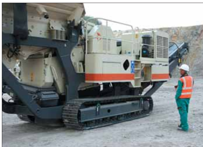
Instalacje serii Lokotrack na podwoziach gąsienicowych mogą pracować z wydajnością w zakresie od 55 do 1.800 t/h
