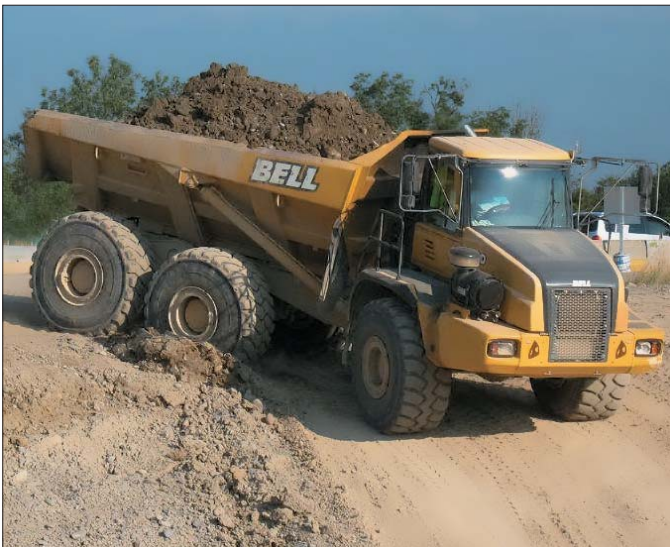
Wszystkie wozidła Bell wyposażone są w hamulce silnikowe i w wysokiej klasy przekładnie ze zintegrowanym opóźniaczem pozwalającym na zjazd ze stromych zboczy bez narażania hamulców na przeciążenia
