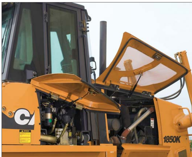
Spycharki CASE imponują niezawodnością. Szerokie klapy pozwalają na lepszy dostęp do niewygodnych podzespołów maszyny ułatwiając prowadzenie prac serwisowych
