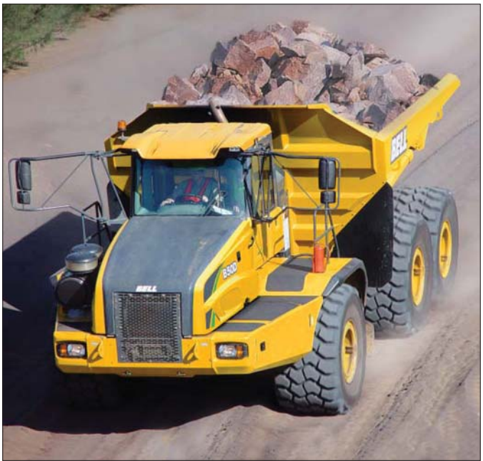
Bell, jako pierwszy podjął produkcję pięćdziesięciotonowych wozideł. Pojazd oznaczony symbolem B50D o ładowności 45,4 tony długo utrzymywał status światowego rekordzisty...
