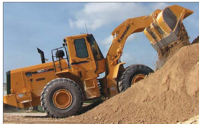
W ładowarkach Kawasaki zastosowano kinematykę wysięgnika typu „Z”, który zapewnia ponadprzeciętną wydajność maszyn
