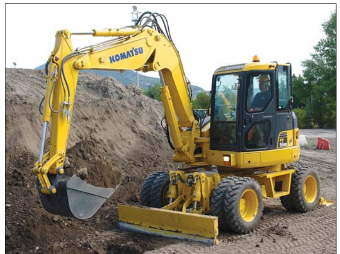
Budowa nadwozia koparki sprawia, że doskonale spisuje się ona podczas prac na ograbionej przestrzeni mogąc pracować bardzo blisko ścian i innych przeszkód
