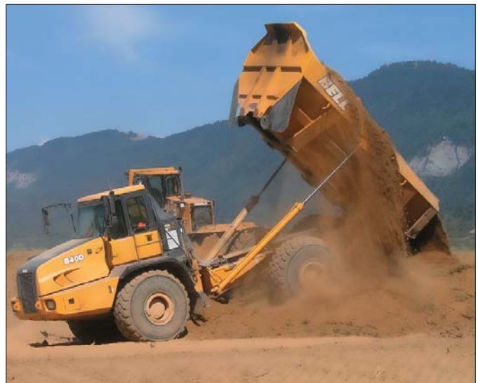
W celu ułatwienia wyladunku konstruktorzy firmy Bell odpowiednio dobrali geometrię skrzyni zapobiegając w ten sposób przywieraniu do jej ścianek transportowanego materiału
