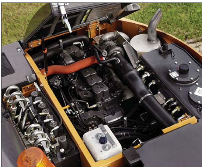
Wszyscy producenci koparek kołowych starają się zapewnić jak najłatwiejszy dostęp do niewralgicznych podzespołów i punktów serwisowych
