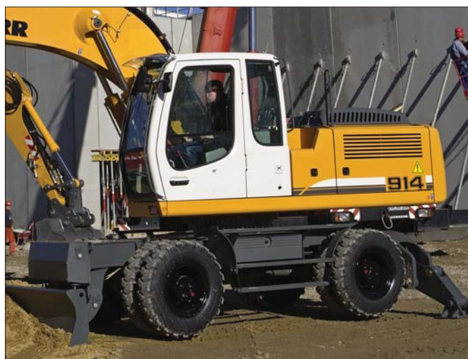
Coraz większym zainteresowaniem cieszą się maszyny wyposażone w nadający się do zamontowania zarówno z tyłu, jak i z przodu maszyny lemieś i system podpór zwiększające stabilność i zakres stosowania osprzętu roboczego
