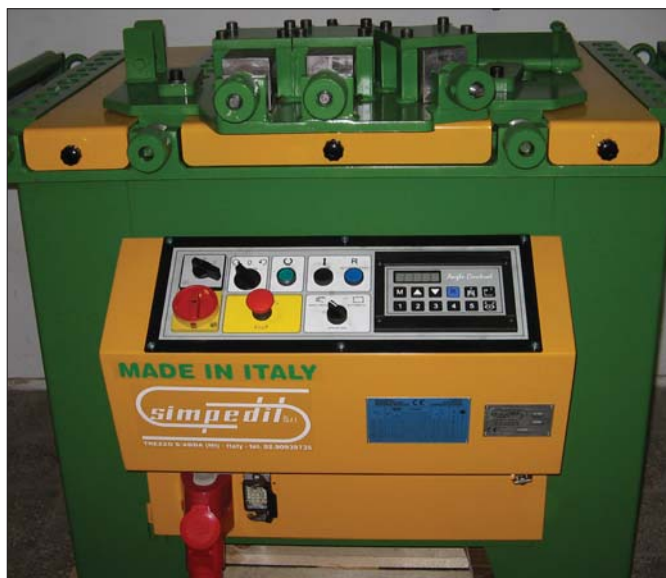
Giętarkę P 55 Special wyposażono w elektroniczny programator
