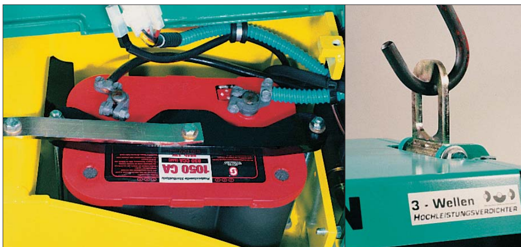
Konstruktorzy Ammanna dbają o wygodę użytkowników swych maszyn. Podukowany wyłącznie na potrzeby firmy akumulator został dodatkowo zabezpieczony przed wibracjami, a specjalny hak transportowy znacznie ułatwia przemieszczanie maszyny
