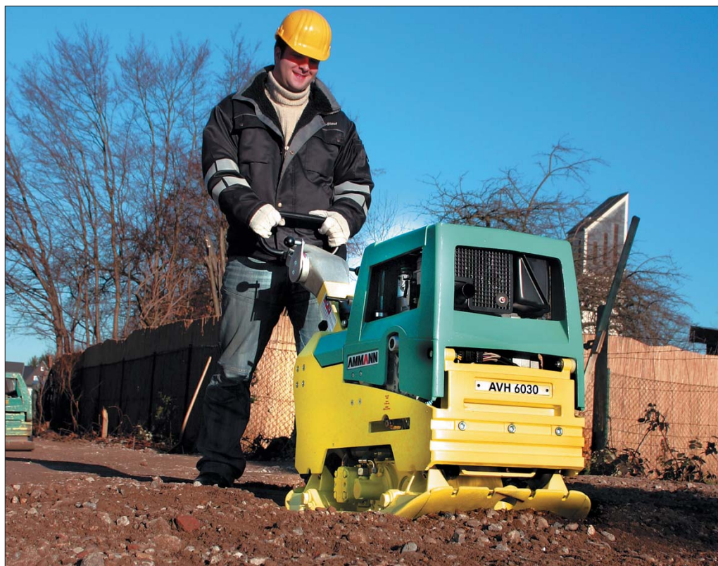
Trzywałowy wibrator stosowany w ciężkich płytach wibracyjnych Ammann stał się znakiem firmowym tej marki
