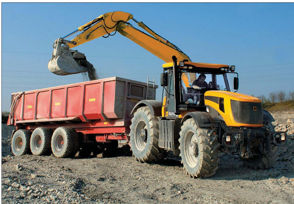
Fastrac 8250 ciągnący przyczepę spotykany jest coraz częściej na dużych placach budowy w branży drogowej oraz przy przemieszczaniu olbrzymich mas ziemnych. Roboty tego rodzaju stanowiły do tej pory domenę wozideł i pojazdów ciężarowych
