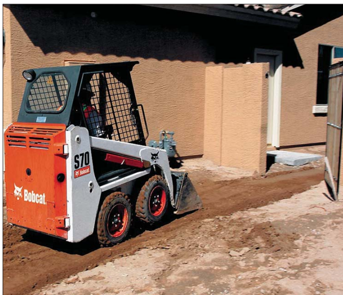
Dzięki zwartym gabarytom miniładowarka S70 z łatwością przechodzi przez otwory o szerokości poniżej 92 i wysokości 182 centymetrów
