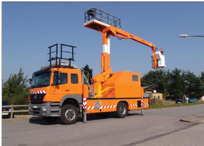
Versalift poszerzył ofertę o podnośniki do budowy oraz konserwacji sieci trakcyjnej
