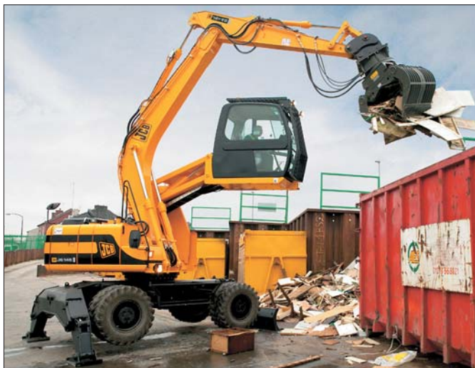
Coraz częściej głównym przeznaczeniem „kotłówek” nie jest kopanie. Odpowiedzią konstruktorów na zmieniające się potrzeby są maszyny wyposażone w kabinę o regulowanej wysokości. Rozwiązanie to ułatwia operatorowi prace przeładunkowe
