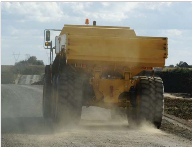
Wozidło wyposażone w zawieszenie FS jest w stanie rozwijać znacznie większe prędkości nawet do 57 km/h. Podczas pokazów pod Grudziądzem przekonaliśmy się o tym sami
