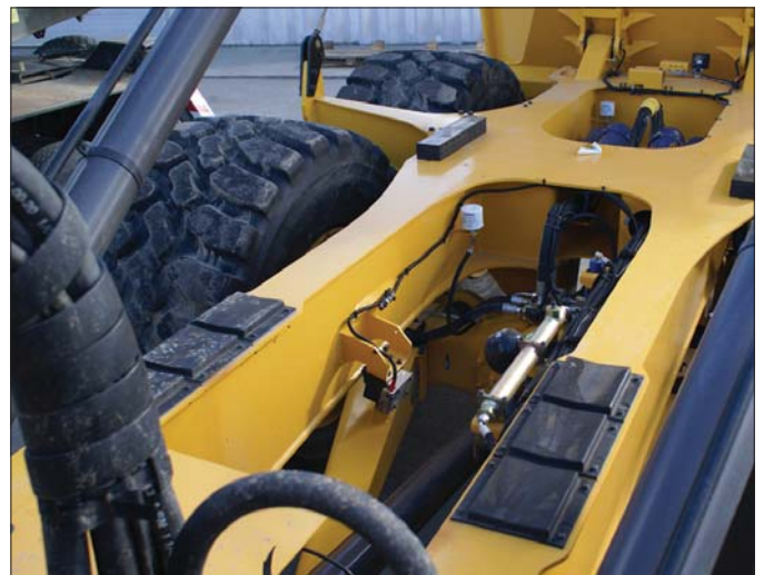
Solidna, wysokiej jakości konstrukcja ramy typu skrzynkowego równomiernie przenosi obciążenia, co znacznie wydłuża żywotność wozidła
