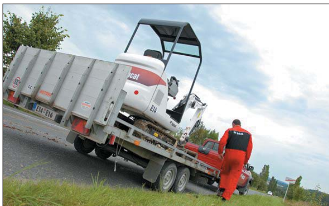
Dzięki niewielkiej masie model E14 może zostać z łatwością przetransportowany na przyczepie ciągniętej przez mały samochód ciężarowy
