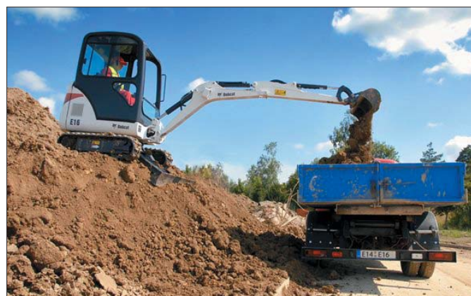
Zastosowanie długiego ramienia wysięgnika pozwala nie tylko zwiększyć udźwig i głębokość kopania, ale także usprawnia prace załadunkowe
