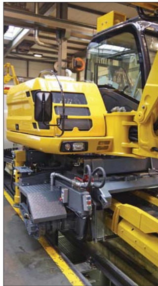
Serce specjalistycznej maszyny AVW-1 stanowi koparka kołowa Case WX125-2 umieszczona bezpośrednio na ponad dwudziestometrowej platformie kolejowej wyposażonej w przenośnik taśmowy
