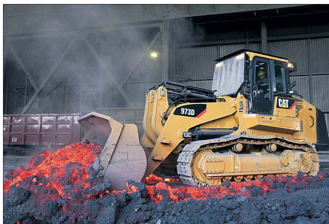
Ładowarka gaśnicowa Caterpillar 973 D poddawana jest codziennej próbie ognia
