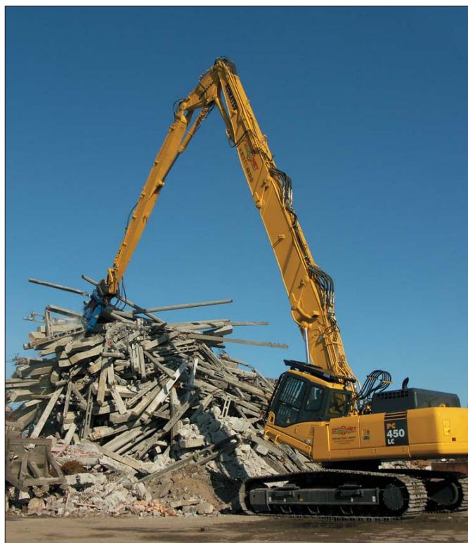
Koparka PC 450 LC w konfiguracji do robót wyburzeniowych na dużych wysokościach
