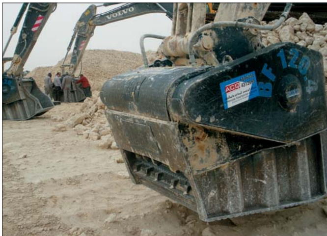
Czerpaki kruszące MB S.p.A są idealnym narzędziem ułatwiającym prowadzenie prac ziemnych, rozbiórkowych i rekultywacyjnych oraz robót w kamieniołomach
