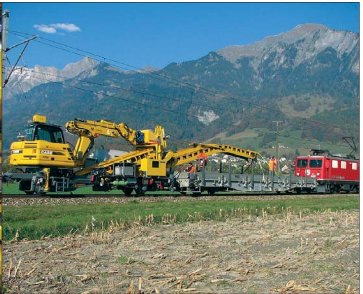
Serce specjalistycznej maszyny AVW-1 stanowi koparka kołowa Case WX125-2 umieszczona bezpośrednio na ponad dwudziestometrowej platformie kolejowej wyposażonej w przenośnik taśmowy
