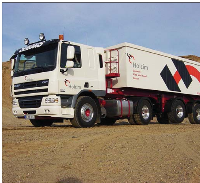
DAF CF 75.360 w konfiguracji dwuosiowej skonfigurowano z myślą o intensywnej eksploatacji przy przewozach ładunków sypkich
