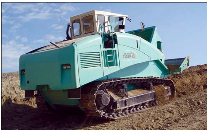
Tiger SR3000 mimo, że jest ciężką maszyną może poruszać się z prędkością 20 km/h
