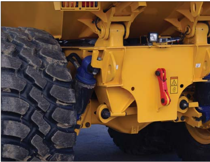
Każde z kół wozidła Volvo FS wyposażono w osobny w hydrauliczny cylinder połączony z akumulatorami niskiego ciśnienia do jazdy bez ładunku oraz wysokiego w stanie załadowanym
