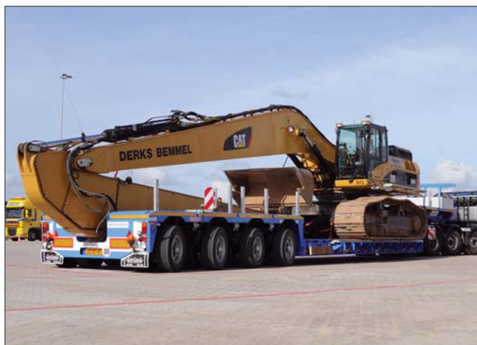
Naczepy z zagłębionym pokładem Euro Pendel-X2 przeznaczone są do transportu ciężkiego sprzętu budowlanego
