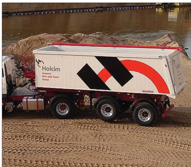
Dwuosiową naczepę wywrotkę SKA 20 Kompakt firmy Langendorf o masie własnej 4,7 tony wybrano z myślą o zapewnieniu zestawowi maksymalnej ładowności
