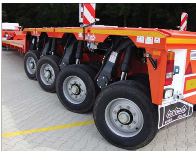
W razie konieczności wymiany koła wewnętrznego odpada konieczność demontowania osi, wsporników i siłowników. Wystarczy tylko podniesienie wózka i skrócenie kół
